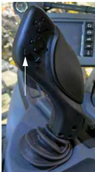
Comutator de gestionare rând final (pe maneta de comandă a transmisiei hidrostatice - Versiunea 1) - Vedere tipică
