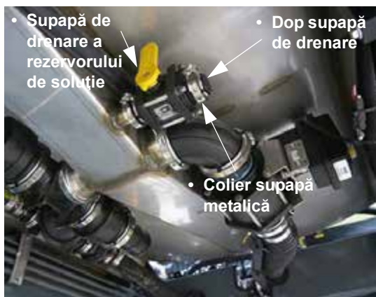
Ansamblu supapă de drenare rezervor de soluție (sub rezervorul de soluție de sub utilaj) - Vedere tipică
