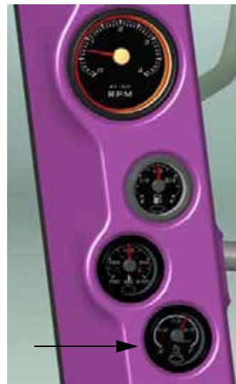
Indicator DEF (amplasate pe stâlpul parbrizului din cabină) - Vedere tipică
