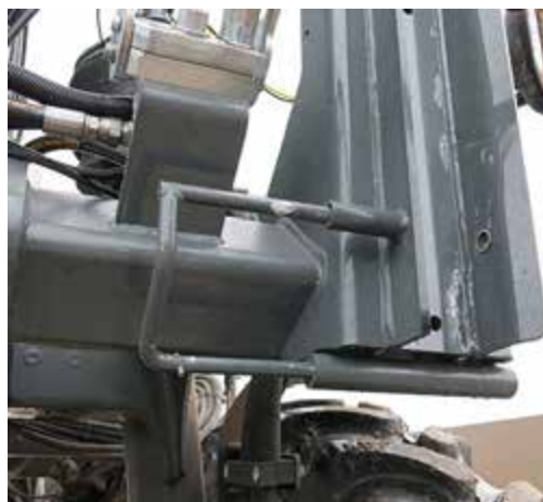
Știft de blocare (pe partea din stânga și dreapta pe partea dreaptă a utilajului) - Vedere tipică
