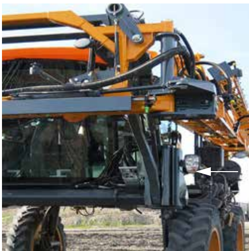
Lumini de avarie/avertizare (amplasate pe fiecare parte din față și din spate a utilajului și a capotei) - Vedere tipică
