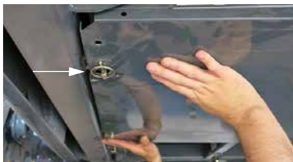
Știft de fixare (instalat în știftul barei de suspendare) - Vedere tipică
