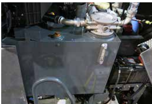
Rezervor de ulei hidraulic (pe partea stângă a utilajului - deschideți capota pentru accesare) - Vedere tipică
