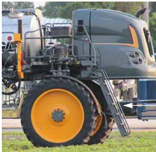
Scară - Vedere tipică * Se ilustrează poziția coborâtă
