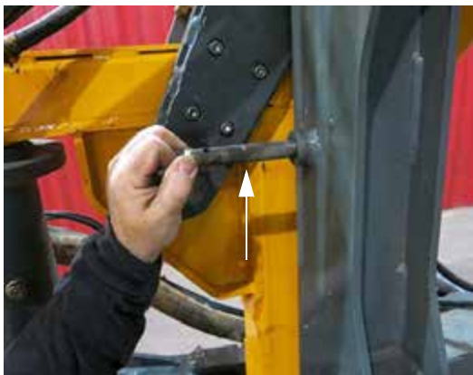
Șurub de prindere (pe partea exterioară a șasiului traversei) - Vedere tipică
