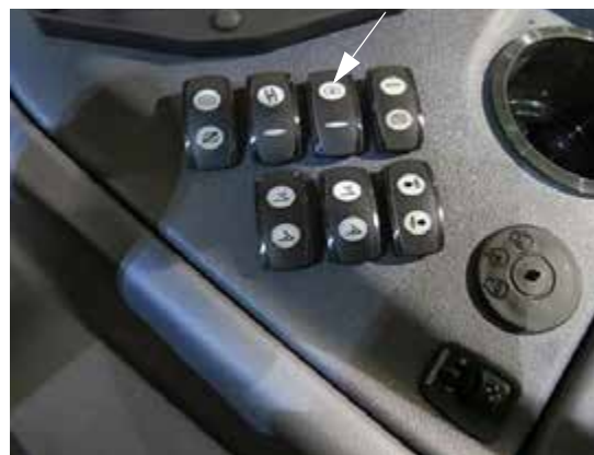
Comutator supapă de agitare (pe consola laterală) - Vedere tipică
