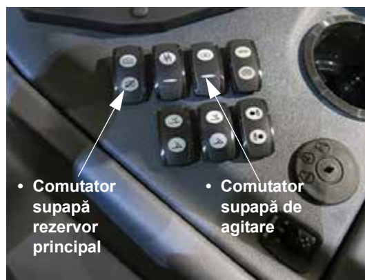
Comutatoarele supapei de agitare și rezervorului principal (pe consola laterală) - Vedere tipică
