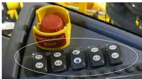
Comutatoare NTB 60' (pe consola laterală) - Vedere tipică
