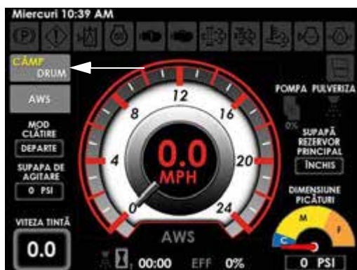
Buton Câmp/Drum (pe Pagina inițială - modul Drum și Câmp)
