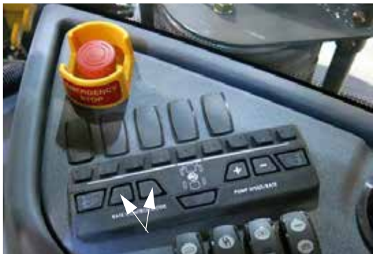
Comutatoare de control debit (pe consola laterală) - Vedere tipică
