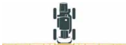
Lățime de stropire de 70' cu brațul pliat la secțiunea mobilă a extensiei de 70/120'
