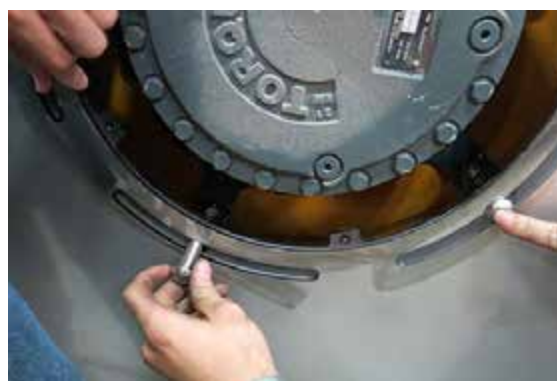
Instalare șurub de montare capac de roată - Vedere tipică
