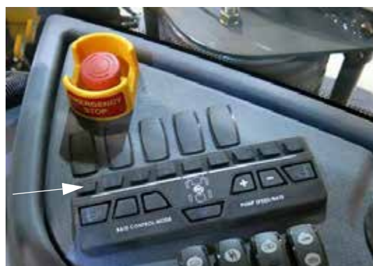
Comutatoare supape de soluție de pe brațe (pe consola laterală) - Vedere tipică
