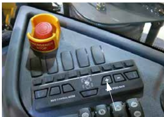
Comutator de debit/turație pompă „+” (pe consola laterală) - Vedere tipică
