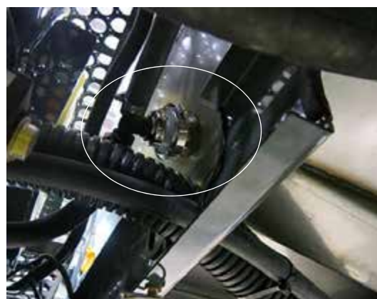
Agitatoare de jet (pe fiecare capăt al rezervorului de soluție) - Vedere tipică
