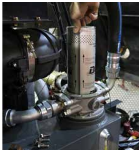
Filtru de retur (în carcasa filtrului, pe partea stângă a utilajului) - Vedere tipică
