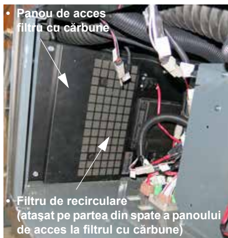
Panou de acces filtru cu cărbune Filtru de recirculare (atașat pe partea din spate a panoului de acces la filtrul cu cărbune) Panou de acces filtru cu cărbune (amplasat în spatele panoului de revizie exterior, pe partea dreaptă a cabinei) - Vedere tipică
