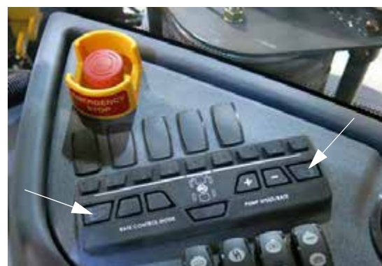
Comutatoare rânduri de margine (pe consola laterală) - Vedere tipică
