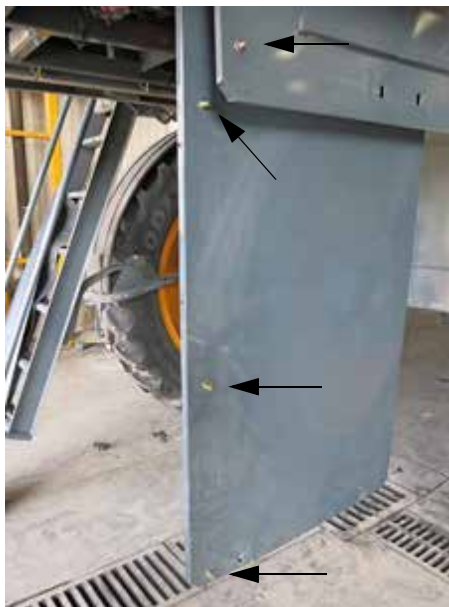
Știfturi bară de suspendare (instalați trei știfturi pe panoul 4 și un știft pe panoul 5, după cum este indicat) - Vedere tipică
