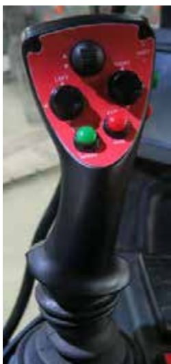
Manetă de comandă transmisie hidrostatică (Versiunea 2) - Vedere tipică
