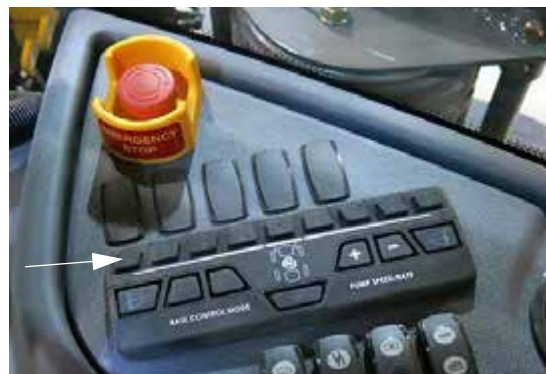
Comutatoare supape de soluție de pe brațe (pe consola laterală) - Vedere tipică
