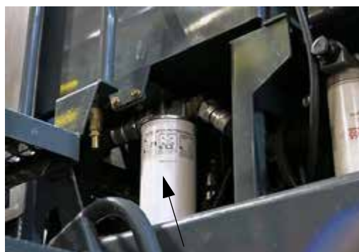
Filtru de drenare a carcasei (pe partea stângă a utilajului) - Vedere tipică
