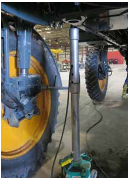
Aliniați cricul cu inelul de izolare a punctului de ridicare - Vedere tipică
