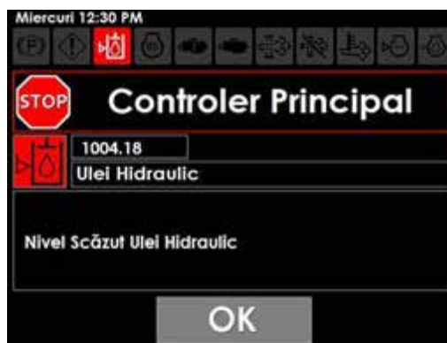
Mesaj de avertisment de nivel scăzut al uleiului hidraulic (pe afișajul utilajului)
