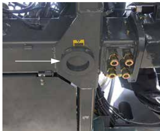
Inel de izolare punct de ridicare (pe cadru, aproape de fiecare picior) - Vedere tipică
