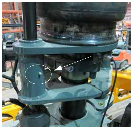
Gresor Zerk lagăr turn (amplasat pe picioarele față și spate) - Vedere tipică
