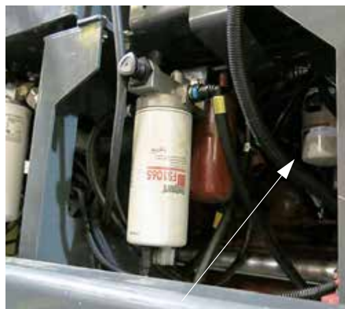
Filtru ulei de motor (pe partea stângă a utilajului - deschideți capota pentru accesare) - Vedere tipică
