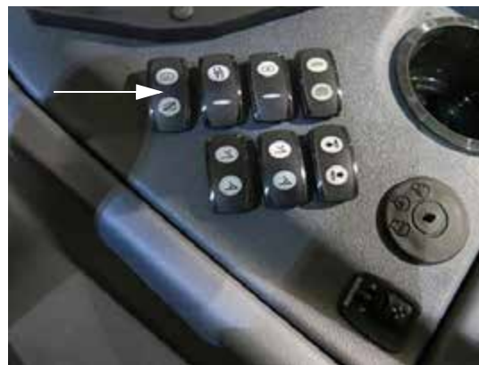
Comutator supapă rezervor principal (pe consola laterală) - Vedere tipică
