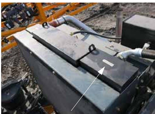
Răcitor de ulei (în apropierea părții din spate a utilajului - deschideți capota pentru accesare) - Vedere tipică
