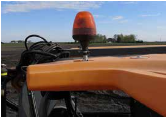
Girofar (pe fiecare parte laterală a cabinei) - Vedere tipică
