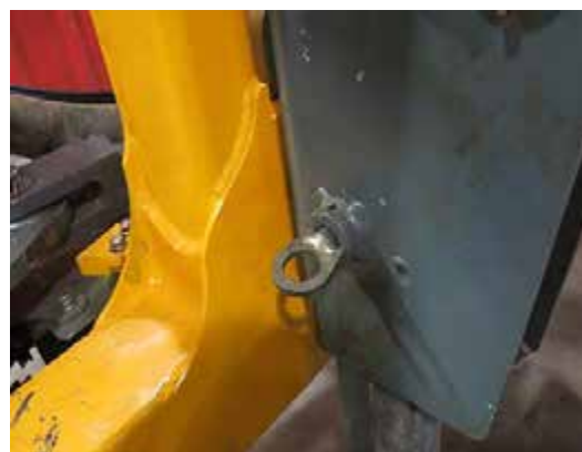
Știft de blocare demontat - Vedere tipică
