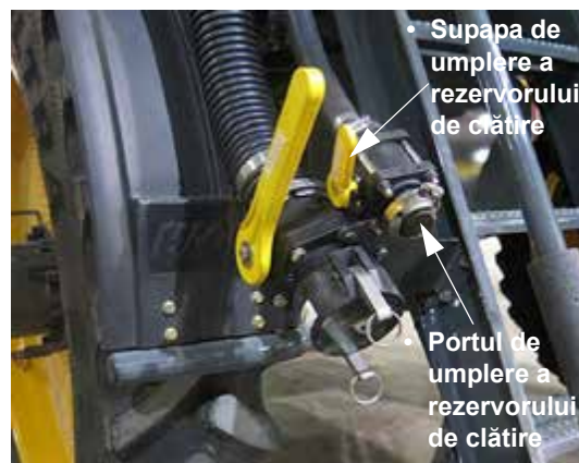
Ansamblul de umplere spate (în spatele roții din stânga spate) - Vedere tipică
