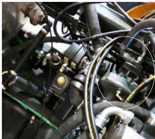
Pompă de soluție (în apropierea centrului utilajului) - Vedere tipică * Vedere de sus a utilajului
