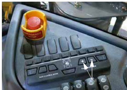
Comutatoare de debit/turație pompă (pe consola laterală) - Vedere tipică
