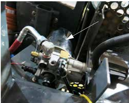
Uscător de aer (sub partea dreaptă a utilajului) - Vedere tipică
