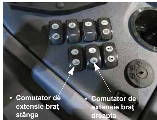
Comutatoare de extensie brațe din stânga și din dreapta (pe consola laterală) - Vedere tipică
