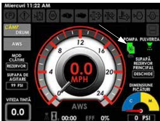
Indicator pompă de soluție (pe afișajul utilajului, Pagina inițială - Field Mode (mod câmp))
