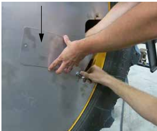
Panou de acces tijă ventil - Vedere tipică
