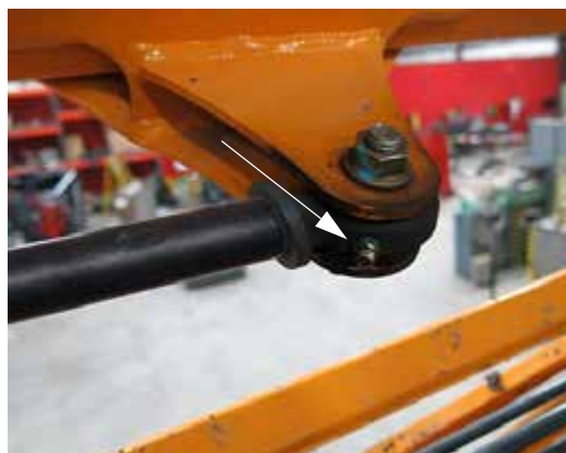
Capăt bielă cilindru de acțiune braț - Vedere tipică
