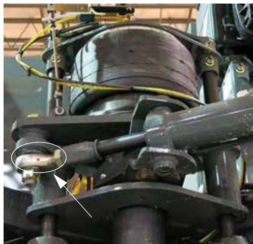
Gresor Zerk rotulă bielă (pe picioarele față) - Vedere tipică
