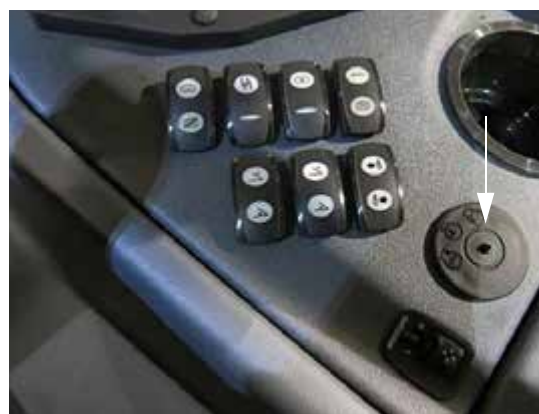
Contact de pornire (pe consola laterală) - Vedere tipică
