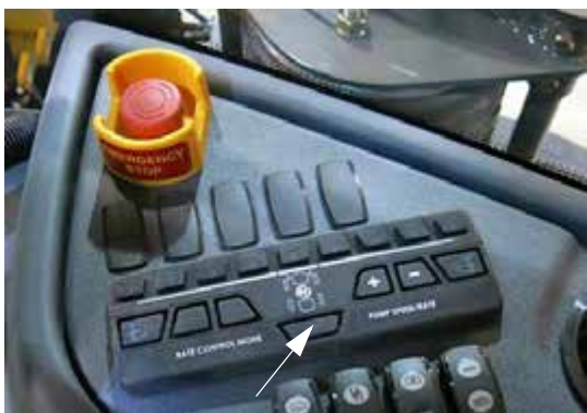
Comutator duză spate (pe consola laterală) - Vedere tipică
