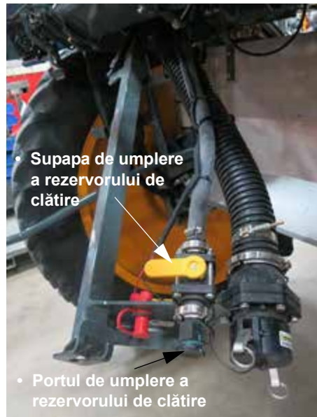
Ansamblul de umplere frontală (poziție coborâtă afișată) - Vedere tipică
