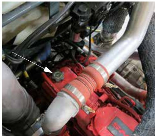
Gură de umplere cu ulei de motor (Amplasat în apropierea părții frontale a motorului) - Vedere tipică
