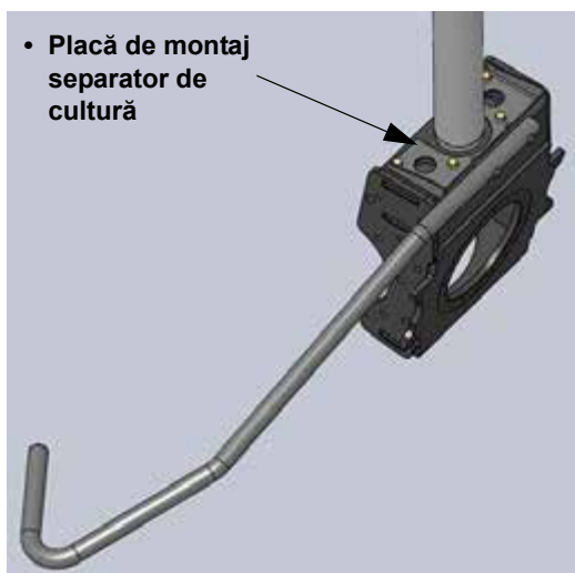
Instalare șurub/placă de montaj (Opțiune picior pentru condiții foarte dificile) - Vedere tipică
