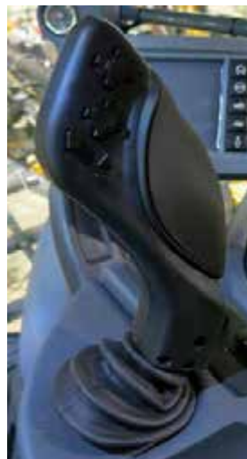
Manetă de comandă transmisie hidrostatică (Versiunea 1) - Vedere tipică
