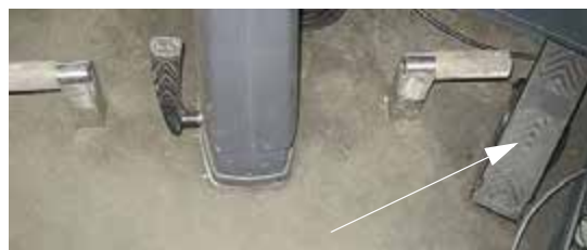
Pedală de decelerare (pe partea din dreapta jos a coloanei de direcție) - Vedere tipică
