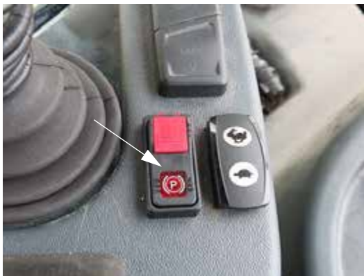
Comutator frână de parcare (lângă maneta de comandă a transmisiei hidrostatice) - Vedere tipică
