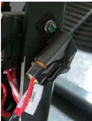
Siguranță actuator capotă (aproape de spate, pe partea stângă a utilajului) - Vedere tipică
