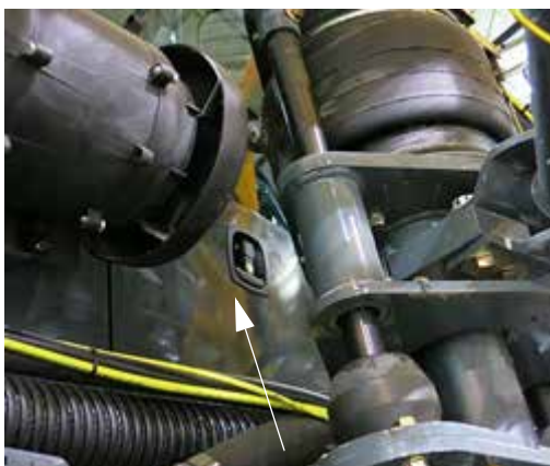
Panou de service exterior (amplasat pe partea dreaptă a cabinei) - Vedere tipică
