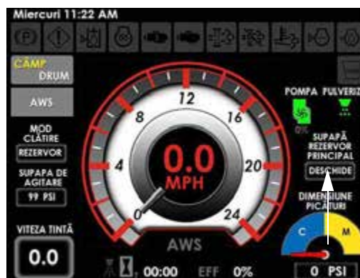
Indicator stare supapă rezervor principal (pe afișajul utilajului, Pagina inițială - Field Mode (mod câmp))
