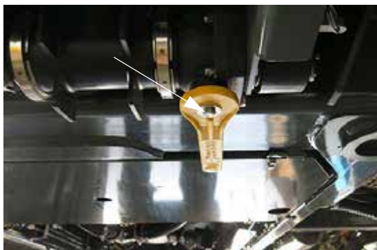
Șurub supapă de umplere față - Vedere tipică
