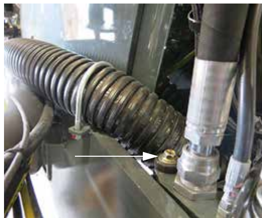
Șuruburi de fixare (2) - față/spate (pe suportul de prindere a ansamblului furtunului pe traversa din dreapta) - Vedere tipică *Șurub spate indicat
