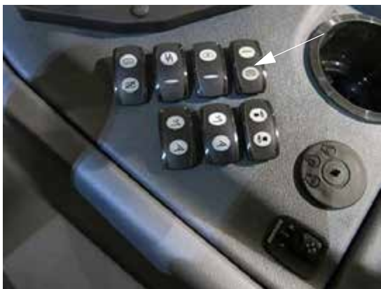
Comutator de clătire (pe consola laterală) - Vedere tipică
