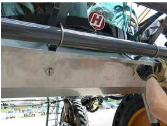
Instalarea scutului față - Vedere tipică
