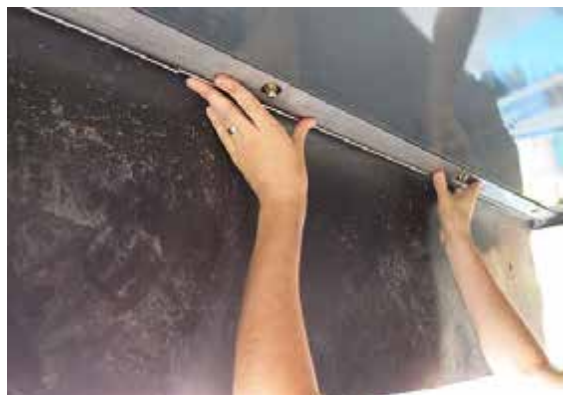
Instalare cortină de periere - Vedere tipică
