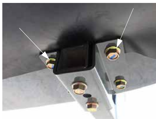
Șuruburi de prindere (două amplasate pe fiecare parte a suportului capotei) - Vedere tipică
