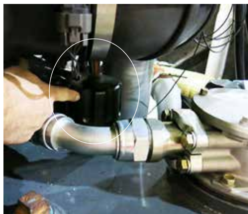
Capac supapă de aerisire (pe partea stângă a utilajului - lângă carcasa filtrului de retur) - Vedere tipică
