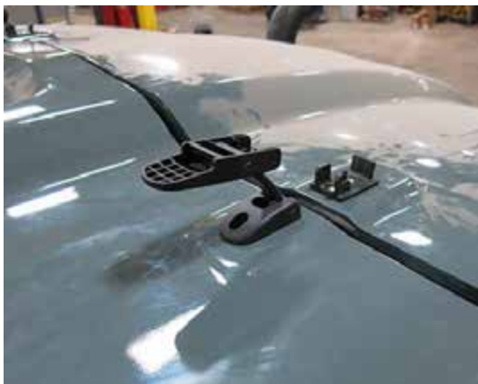
Clapetă de siguranță capotă (2) (pe ambele părți ale capotei superioare) - Vedere tipică
