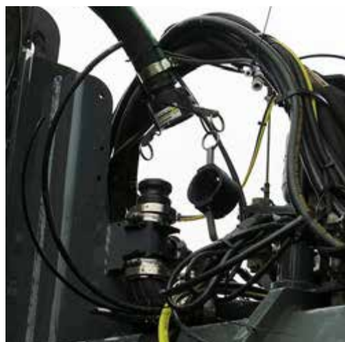
Conexiune pentru soluție (în față, pe partea dreaptă a utilajului) - Vedere tipică
