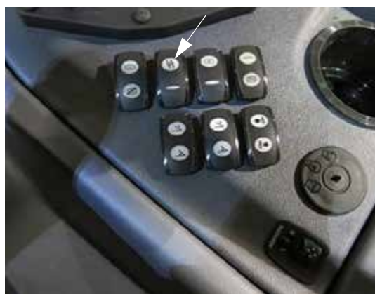
Comutator pompă de soluție (pe consola laterală) - Vedere tipică
