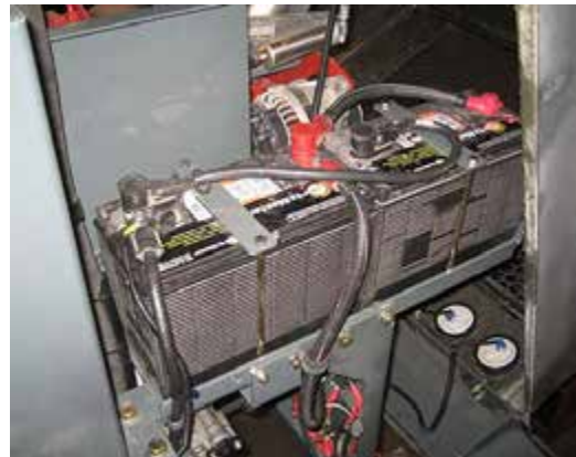
Acces la baterie (amplasat pe partea stângă a utilajului - deschideți capota pentru accesare) - Vedere tipică
