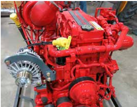
Motor diesel final de Nivelul 4 (amplasat în apropierea părții din spate a utilajului - deschideți capota pentru acces) - Vedere tipică
