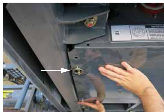
Știft de fixare (instalat în știftul barei de suspendare) - Vedere tipică
