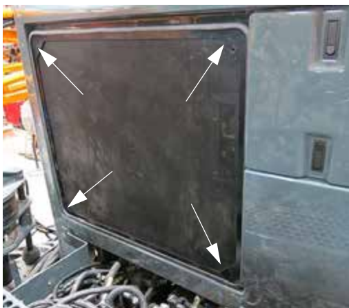
Clapete de siguranță sită radiator (la fiecare colț al sitei) - Vedere tipică
