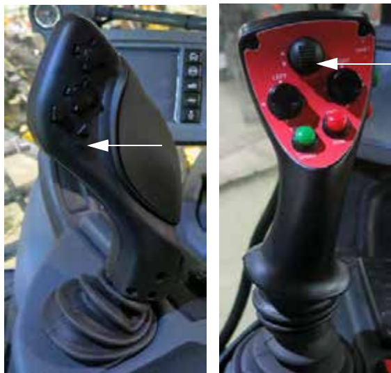
Comutator traversă - JOS (pe maneta de comandă a transmisiei hidrostactice) - Vedere tipică
