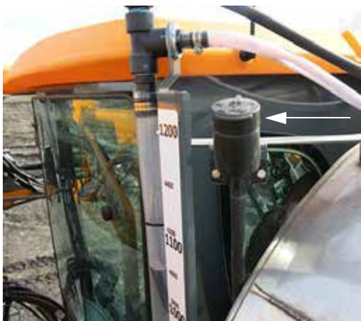
Rezervorul pentru lichid de spălare a parbrizului (amplasat în spatele părții din stânga a cabinei) - Vedere tipică
