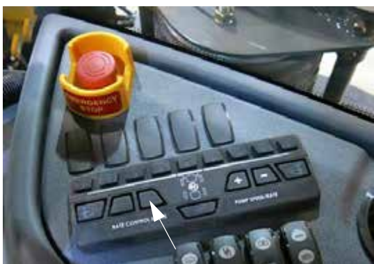
Comutatorul de control al debitului „MAN” (manual) (pe consola laterală) - Vedere tipică
