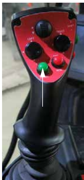
Comutator pulverizator principal (pe maneta de comandă a transmisiei hidrostatice - Versiunea 2) - Vedere tipică
