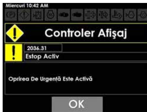
Mesaj activ E-Stop (pe afișajul utilajului)
