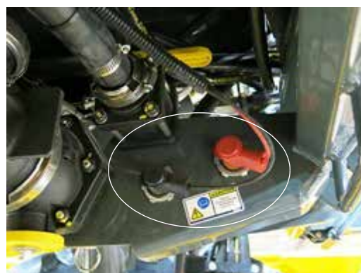
Porturi de alimentare (în apropierea ansamblului de umplere frontală) - Vedere tipică
