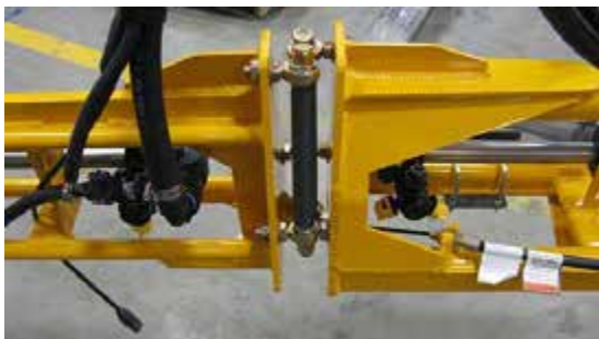
Acționare secțiune exterioară - Vedere tipică
