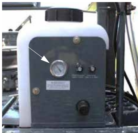
Manometru de spumă (pe partea laterală a rezervorului marcatorului cu spumă, montat pe partea dreaptă a utilajului) - Vedere tipică
