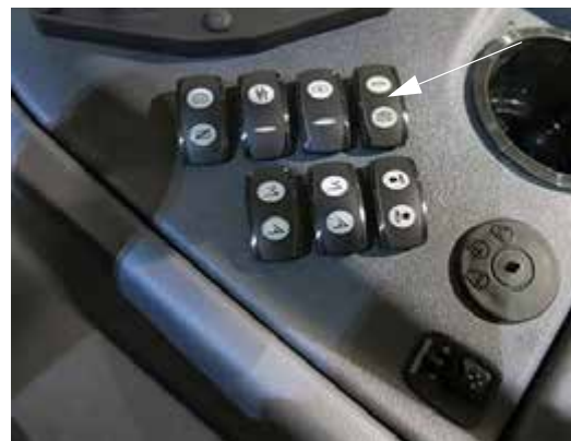
Comutator de clătire (pe consola laterală) - Vedere tipică
