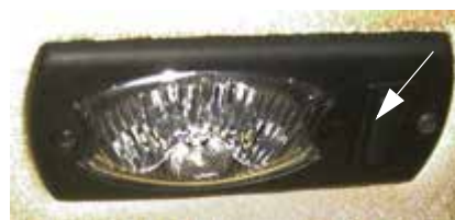
Comutator lampă interioară de lucru - Vedere tipică
