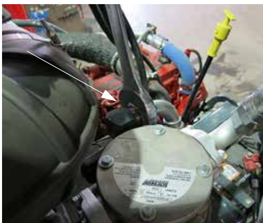
Furtun de drenare a carcasei (lângă partea superioară a rezervorului hidraulic) - Vedere tipică
