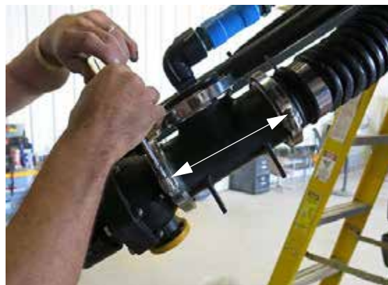
Coliere galerie de umplere față - Vedere tipică
