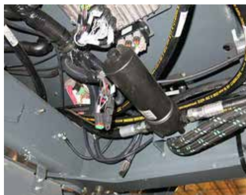
Filtru de presiune (sub partea dreaptă a utilajului - coborâți scutul metalic pentru accesare) - Vedere tipică
