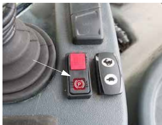
Comutator frână de parcare - dacă este prevăzut cu această componentă (lângă maneta de comandă a transmisiei hidrostatice) - Vedere tipică
