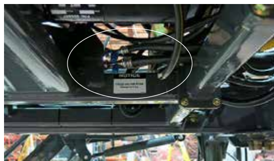
Porturi de încărcare sistem de aer condiționat (amplasate sub cadrul principal de mijloc) - Vedere tipică
