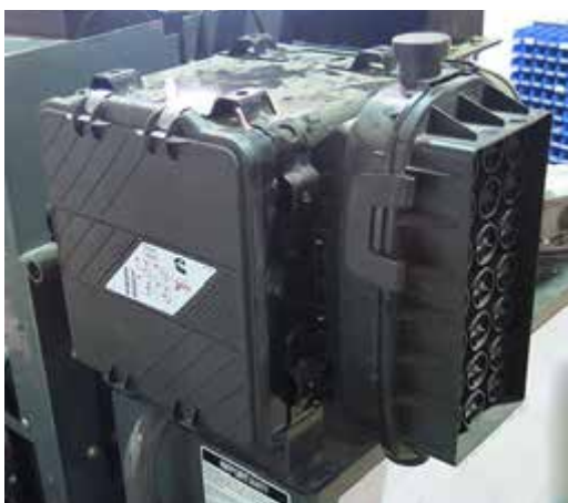
Filtrul de aer de admisie al motorului (de-a lungul punții de acces de pe partea stângă a utilajului - deschideți capota pentru accesare) - Vedere tipică
