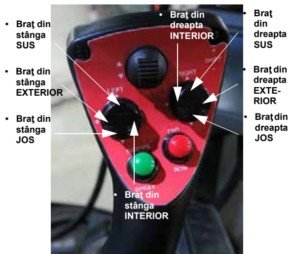
Comutatoare brațe stânga și din dreapta (pe maneta de comandă a transmisiei hidrostatice - Versiunea 2) - Vedere tipică
