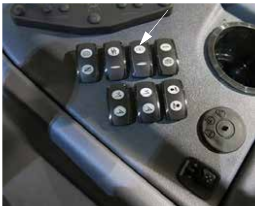
Comutator supapă de agitare (pe consola laterală) - Vedere tipică
