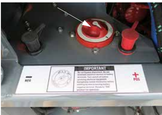
Comutatorul de deconectare a bateriei (pe cadrul principal din spate) - Vedere tipică
