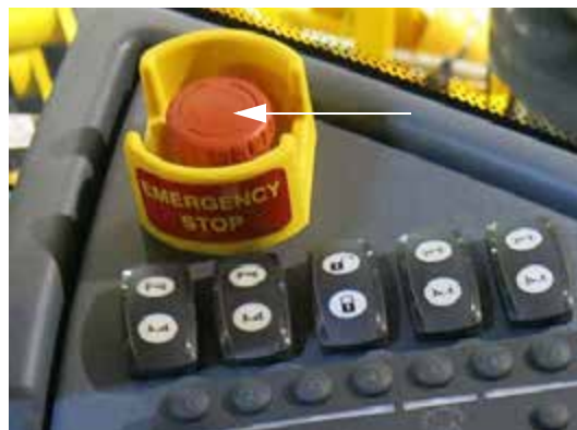
Comutator E-Stop (pe consola laterală) - Vedere tipică
