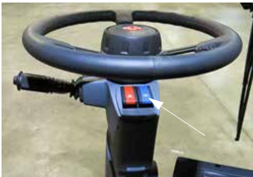
Comutator Lumini de poziție pentru drumuri publice (pe coloana de direcție) - Vedere tipică
