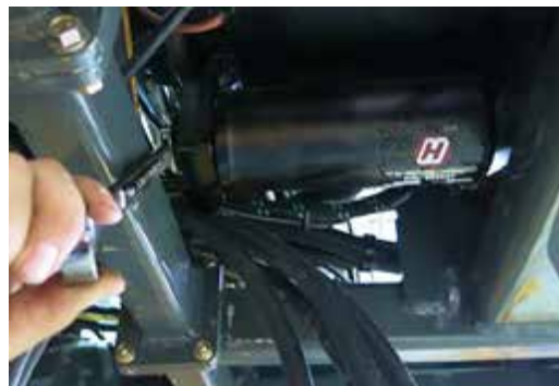
Filtru pompă de încărcare (sub pompa de transmisie) - Vedere tipică
