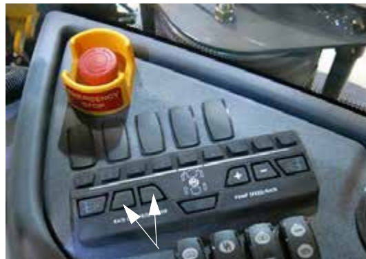
Comutatoare de control debit (pe consola laterală) - Vedere tipică
