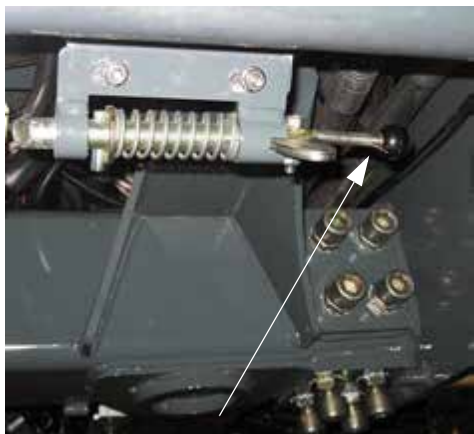
Manetă de eliberare ansamblu de umplere frontală (sub partea din față a utilajului) - Vedere tipică
