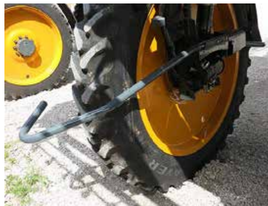
Separator de cultură instalat - Vedere tipică
