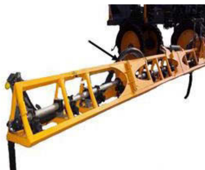
Șurub de fixare (pe partea din spate a brațului) - Vedere tipică
