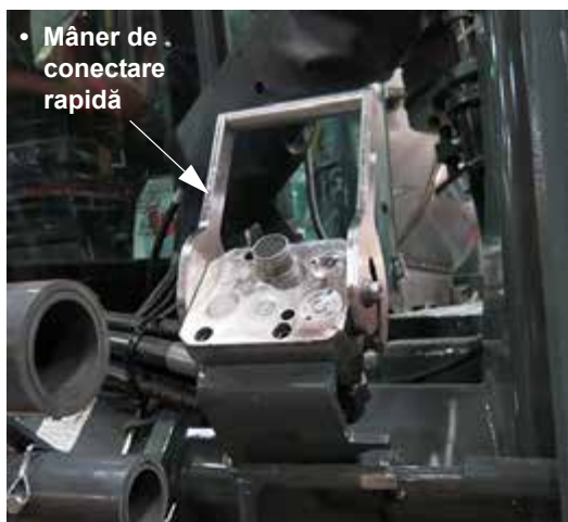
Ansamblu cuplaj multiplu hidraulic/electric - dacă este prevăzut cu această componentă (în față, pe partea stângă a utilajului)
