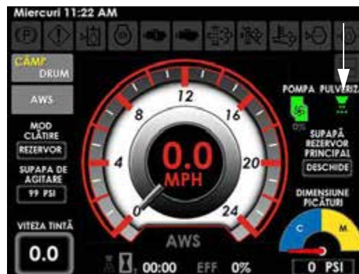
Indicator Pulverizator principal (pe afișajul utilajului, Pagina inițială - Field Mode (mod câmp))
