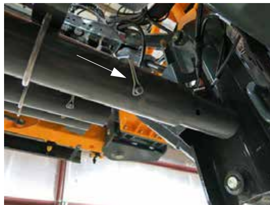
Clemă de reglare protecție de perie (la capătul fiecărui tub) - Vedere tipică
