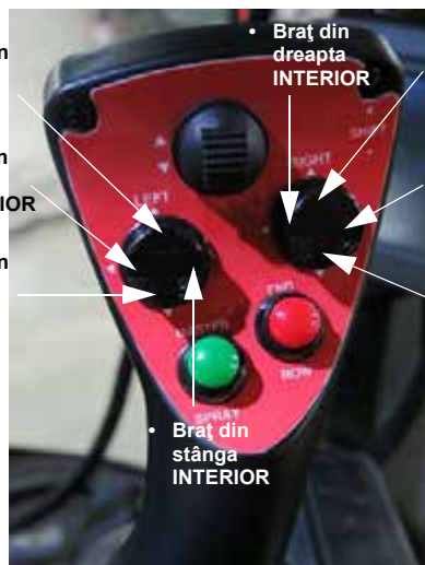
Comutatoare brațe stânga și din dreapta (pe maneta de comandă a transmisiei hidrostatice - Versiunea 2) - Vedere tipică
