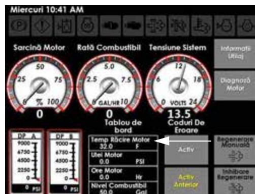
Indicatorul de temperatură pentru agentul de răcire a motorului (pe pagina Diagnostică utilaj)
