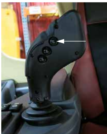
Comutator pulverizator principal (pe partea din spate a manetei de comandă a transmisiei hidrostatice - Versiunea 1) - Vedere tipică
