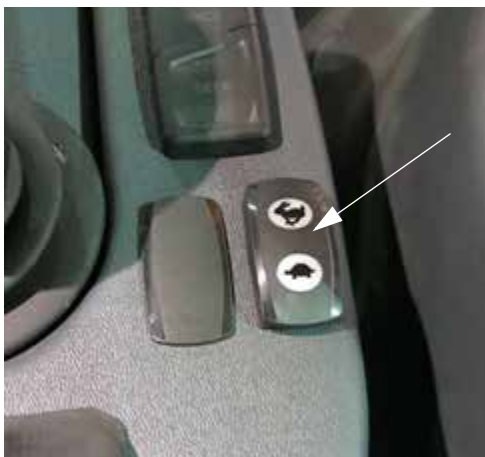
Comutator Acclerație (lângă maneta de comandă a transmisiei hidrostatice) - Vedere tipică
