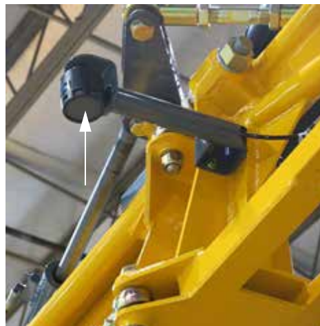
Garnitură spongioasă senzor NORAC (pe partea inferioară a fiecărui senzor) - Vedere tipică
