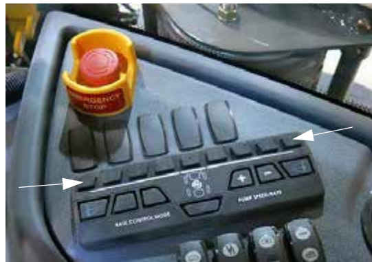
Comutatoare supapă de soluție de pe brațe - secțiunile 1 și 9 (pe consola laterală) - Vedere tipică
