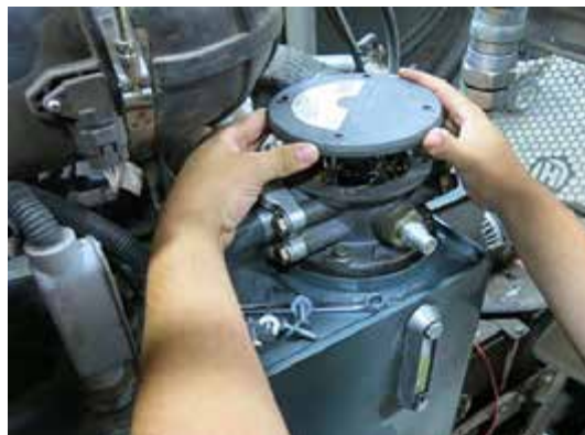
Umplerea rezervorului prin carcasa filtrului de retur hidraulic - Vedere tipică
