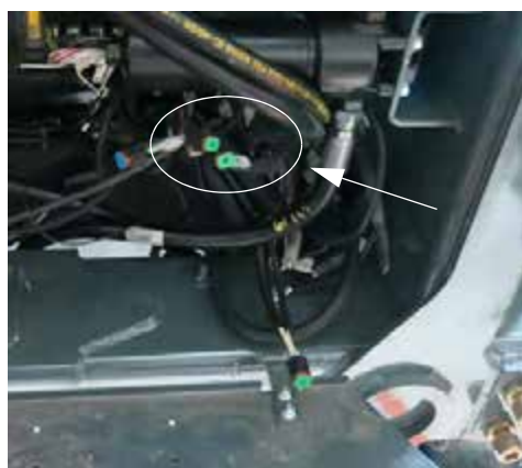
Conexiuni de intrare cameră video (sub cabină - demontați panoul frontal pentru acces) - Vedere tipică
