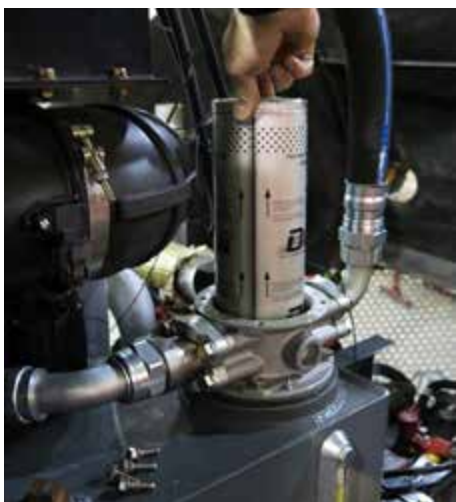
Filtru de retur (amplasat în interiorul carcasei filtrului) - Vedere tipică
