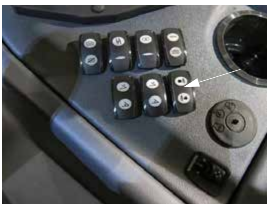
Comutator marcator cu spumă (pe consola laterală) - Vedere tipică
