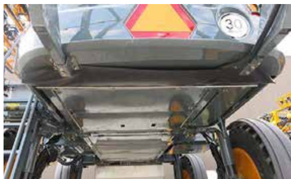
Instalarea scutului inferior/cortinei de periere - Vedere tipică
