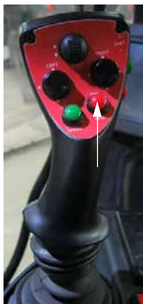
Comutator de gestionare rând final (pe maneta de comandă a transmisiei hidrostatice - Versiunea 2) - Vedere tipică
