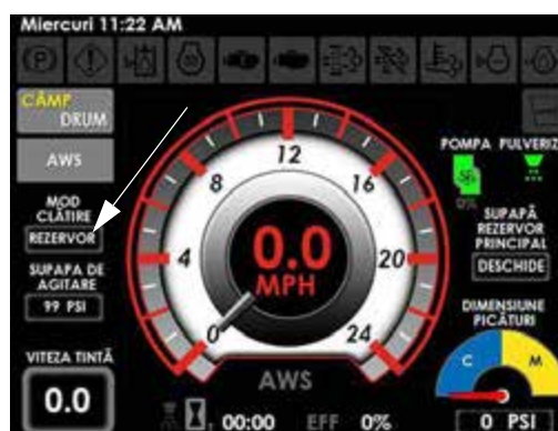
Indicator Mod clătire (pe afișajul utilajului, Pagina inițială - Field Mode (mod câmp))
