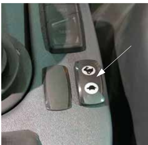
Comutator Accelație (lângă maneta de comandă a transmisiei hidrostatice) - Vedere tipică
