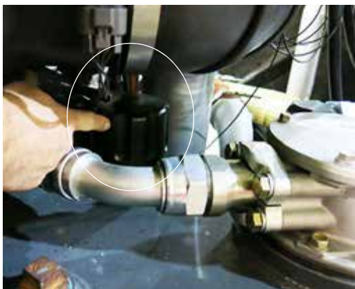
Capac supapă de aerisire (pe partea stângă a utilajului - lângă carcasa filtrului de retur) - Vedere tipică
