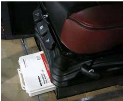
Trusă de prim-ajutor (amplasată sub scaunul operatorului) - Vedere tipică
