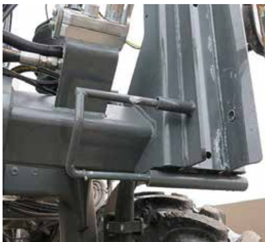
Știft de blocare (pe partea din stânga și dreapta partea dreaptă a utilajului) - Vedere tipică * Poziție decuplată afișată
