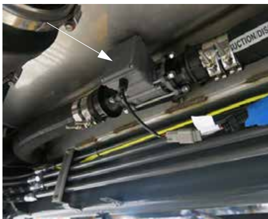
Debitmetru (sub partea dreaptă a utilajului) - Vedere tipică
