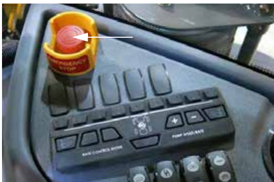
Comutator E-Stop (pe consola laterală) - Vedere tipică
