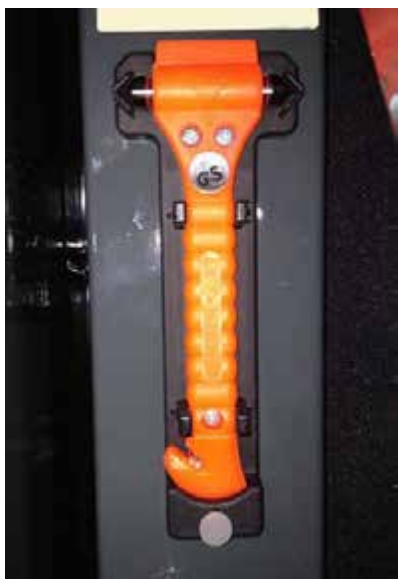
Instrument pentru ieșire de urgență (de-a lungul părții drepte a cabinei) - Vedere tipică
