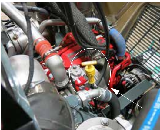
Joja pentru ulei de motor (pe partea stângă a motorului - deschideți capota pentru accesare) - Vedere tipică
