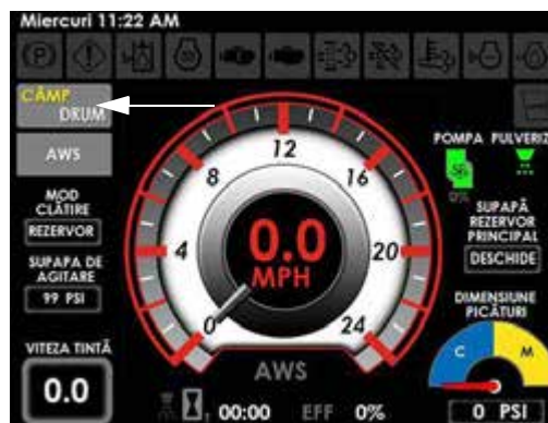
Buton Câmp/Drum (pe Pagina principală a afișajului utilajului)
