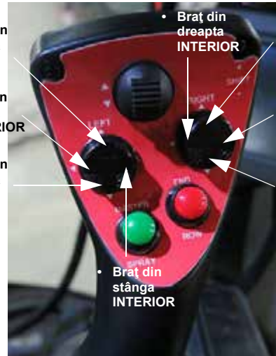
Comutatoare brațe stânga și din dreapta (pe maneta de comandă a transmisiei hidrostatice - Versiunea 2) - Vedere tipică
