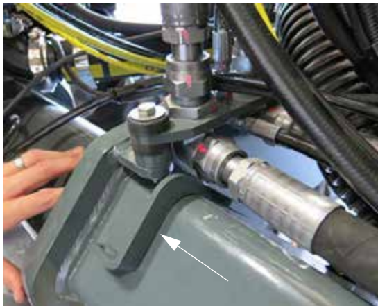
Suport de prindere protecție perie (este prezentată partea dreaptă a utilajului) - Vedere tipică
