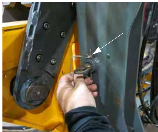
Știft de blocare (pe partea exterioară a șasiului traversei) - Vedere tipică
