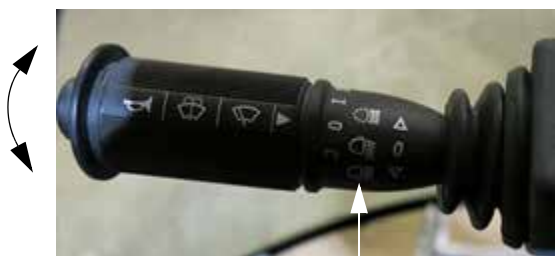
Fază lungă (pe maneta de semnalizare) - Vedere tipică
