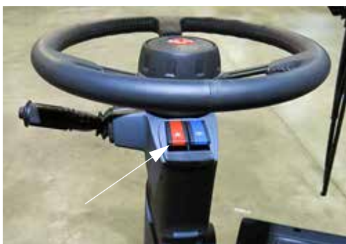
Comutator lumini de avarie/avertizare (pe coloana de direcție) - Vedere tipică
