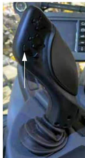
Comutator de gestionare rând final (pe maneta de comandă a transmisiei hidrostactice - Versiunea 1) - Vedere tipică
