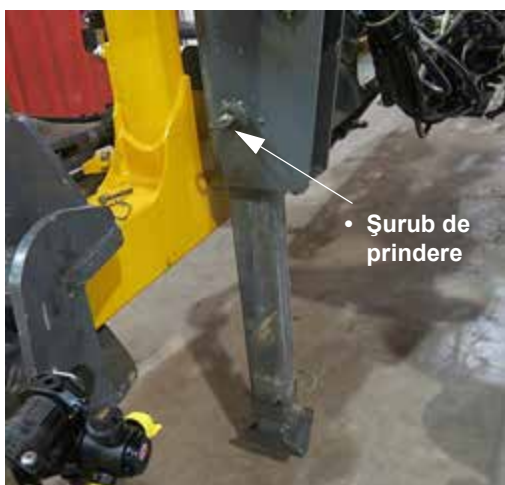
Suport de braț (poziție extinsă afișată) - Vedere tipică
