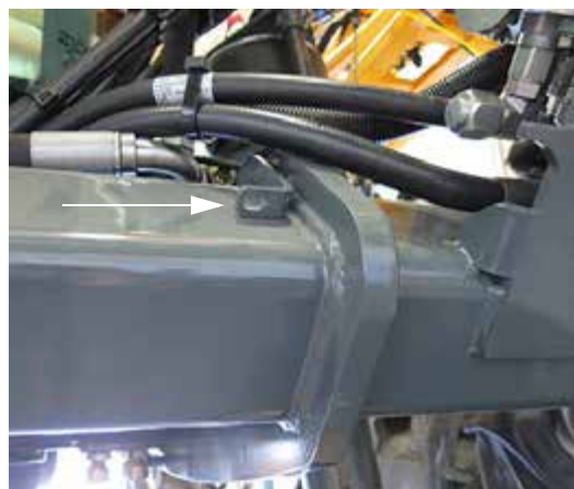
Suport de prindere protecție perie (este prezentată partea stângă a utilajului) - Vedere tipică
