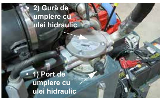
Opțiuni de umplere cu ulei hidraulic - Vedere tipică
