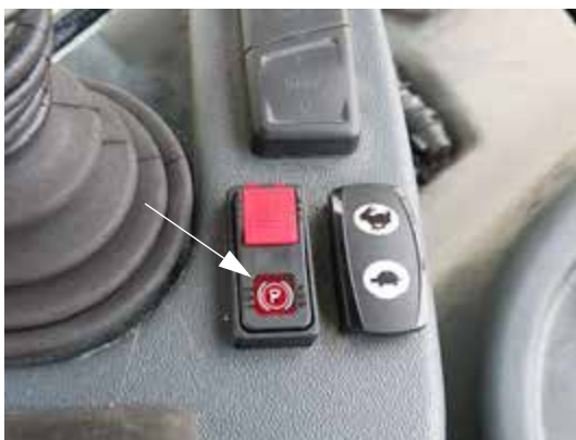
Comutator frână de parcare (lângă maneta de comandă a transmisiei hidrostactice) - Vedere tipică
