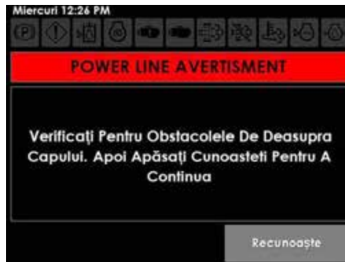
Mesaj de avertizare privind liniile de alimentare cu energie electrică (pe afișajul utilajului)
