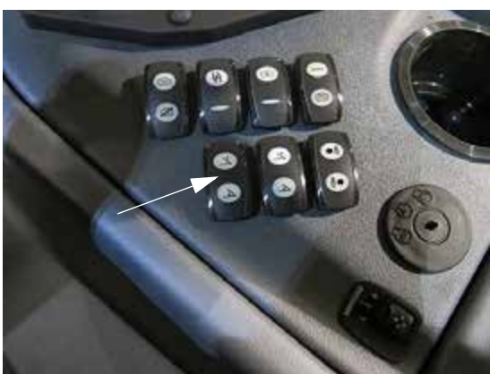
Comutator de extensie braț * Brațe de stropit de 90' (pe consola laterală) - Vedere tipică
