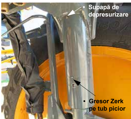
Gresor Zerk pe tub picior și Supapă de depresurizare (pe picioarele față și spate) - Vedere tipică
