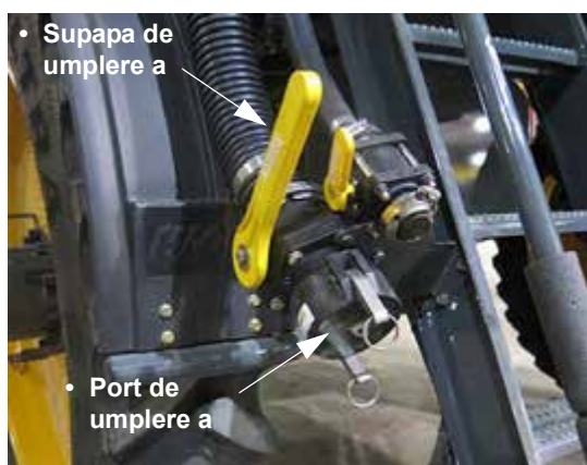
Ansamblul de umplere spate (în spatele roții din stânga spate) - Vedere tipică
