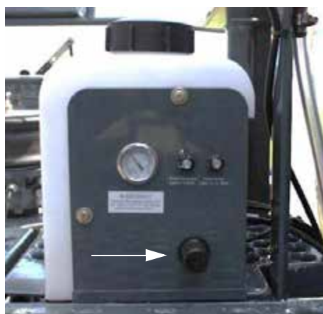
Cadran de presiune a spumei (pe partea laterală a rezervorului marcator cu spumă) - Vedere tipică
