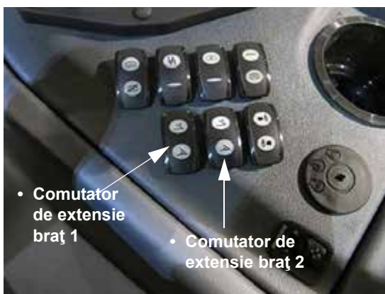
Comutatoare de extensie brațe (pe consola laterală) - Vedere tipică
