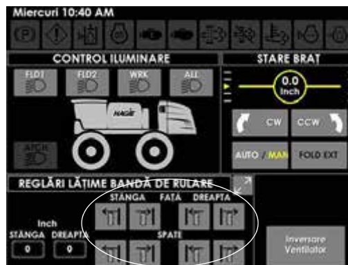
Butoane de reglare lățime bandă de rulare (pe afișajul utilajului, pagina Comenzi auxiliare)
