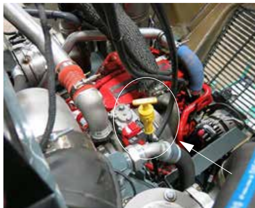
Motorolaj nivópálca (a motor bal kéz felőli oldalán van elhelyezve – a hozzáféréshez nyissa fel a motorháztetőt) – Tipikus nézet
