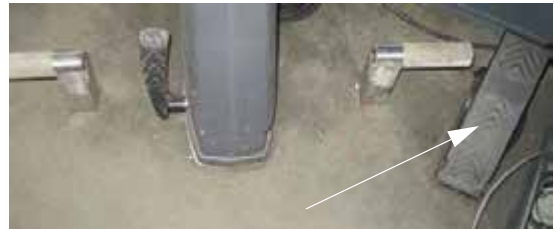
Lassító pedál (a kormányoszlop jobb kéz felőli oldalán alul) – Tipikus nézet
