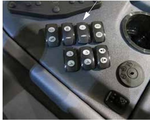
Keverőszelep kapcsolója (oldalsó vezérlőpulton) – Tipikus nézet
