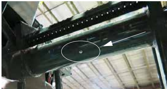
Létra, forgástengely hüvely – Tipikus nézet
