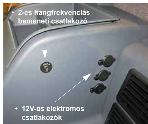
2-es hangfrekvenciás bemeneti csatlakozó • 12V-os elektromos csatlakozók 12V-os elektromos csatlakozók és 2-es hangfrekvenciás bemeneti csatlakozó (az oldalkonzol belső borításán) – Tipikus nézet
