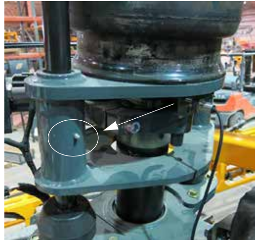
Támasz csapágy Zerk zsír (az első és hátsó lábokon található) – Tipikus nézet
