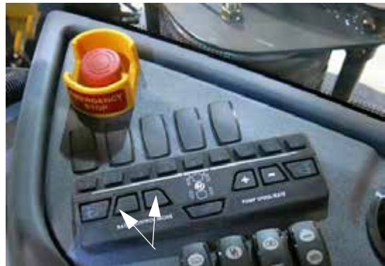
Mérték szabályzó kapcsolók (oldalsó vezérlőpulton) – Tipikus nézet
