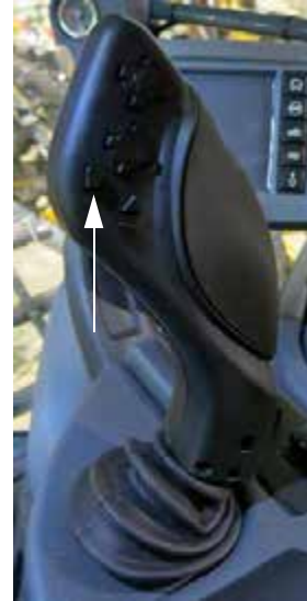
Sorvég kezelés kapcsoló (A hidrosztatikus vezérlést irányító kar 1-es változatán) – Tipikus nézet
