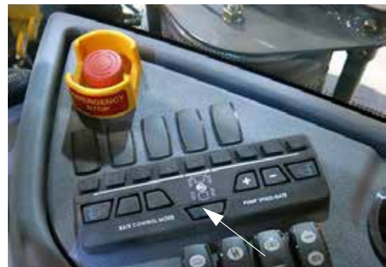
Hátsó fúvóka kapcsoló (oldalsó vezérlőpulton) – Tipikus nézet
