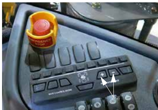
Szivattyú sebesség/Arány kapcsolók (oldalsó vezérlőpulton) – Tipikus nézet
