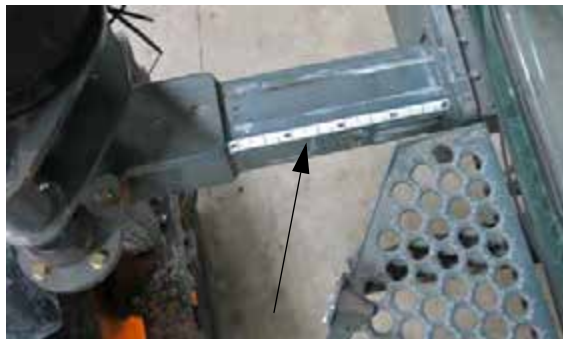
Nyomtáv beállítás jelzőmatrica (Első lábak) - Tipikus nézet
