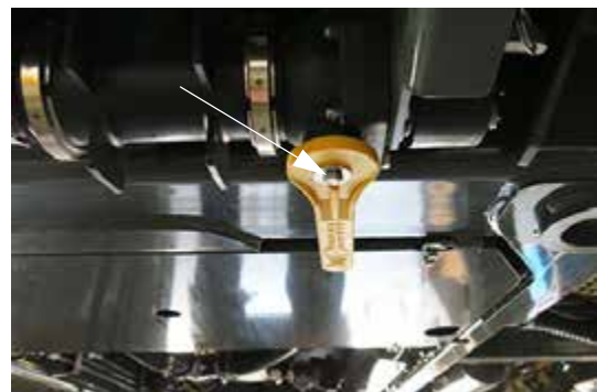
Homlokoldali töltő szelep csavar – Tipikus nézet
