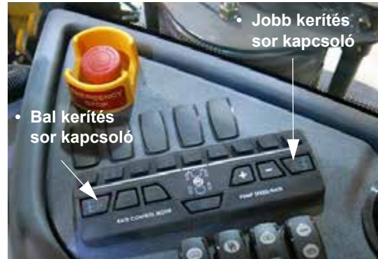
Kerítéssor kapcsolók – Bal és jobb (oldalsó vezérlőpulton) – Tipikus nézet
