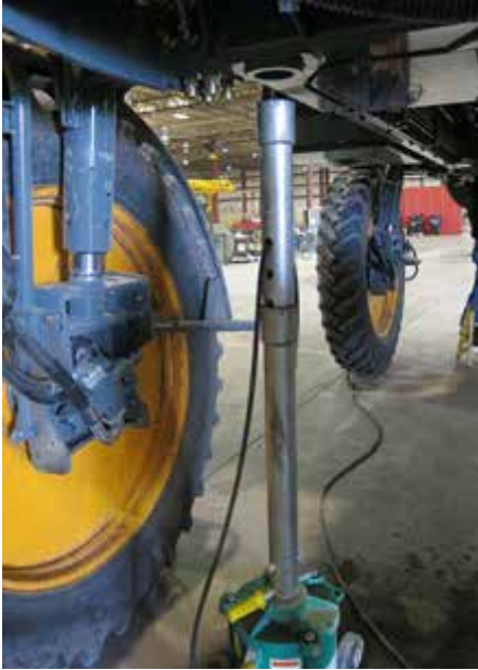
Igazítsa az emelőrudat az emelési pont támasz gyűrűjére – Tipikus nézet
