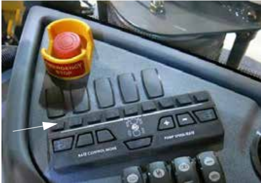
Gém permetlé szelep kapcsolók (oldalsó vezérlőpulton) - Tipikus nézet
