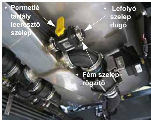
Permetlé tartály leeresztő szelep összeszerelés (a gépezet alsó oldalán a permetlé tartály alatt) - Tipikus nézet
