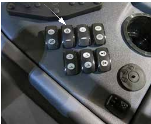
Permetlé oldat szivattyú kapcsolója (oldalsó vezérlőpulton) – Tipikus nézet
