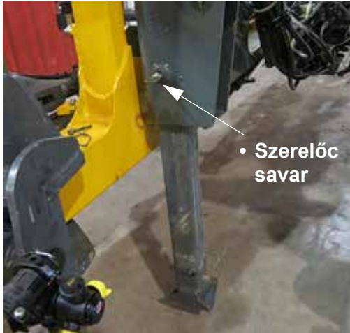
Gém állvány (Kihajtott pozíciót mutatja) – Tipikus nézet
