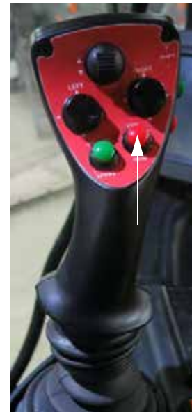
Sorvég kezelés kapcsoló (A hidrosztatikus vezérlést irányító kar 2-es változatán) – Tipikus nézet
