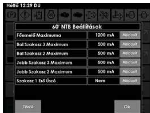
A 60' NTB finom beállítás képernyője - Tipikus nézet
