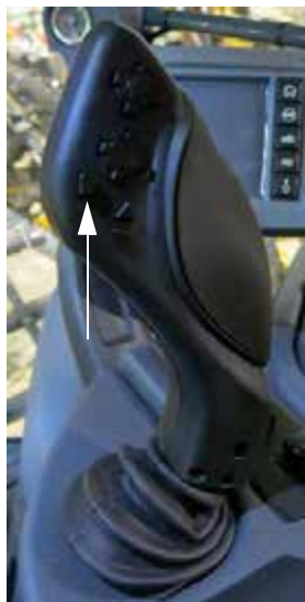
Sorvég kezelés kapcsoló (A hidrosztatikus vezérlést irányító kar 1-es változatán) – Tipikus nézet
