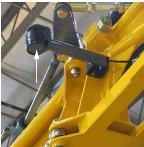
NORAC érzékelő habzivacs (a NORAC érzékelőn van elhelyezve) – Tipikus nézet
