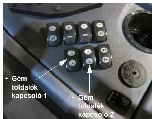
Gém toldalék kapcsolók (oldalsó vezérlőpulton) – Tipikus nézet
