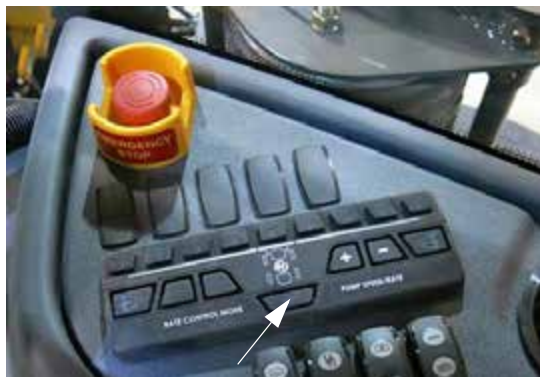
Hátsó fúvóka kapcsolója (oldalsó vezérlőpulton) – Tipikus nézet
