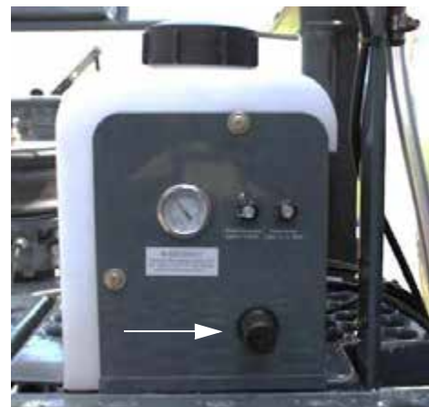
Hab nyomás jelző tárcsa (a habzás jelző tartály oldalánál van) – Tipikus nézet
