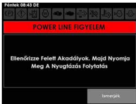
Elektromos vezeték figyelmeztető üzenet (munkagép képernyőjén található)
