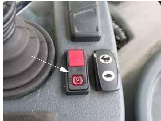
Rögzítőfék kapcsoló - ha van (a hidrosztatikus vezérlést irányító kar közelében) - Tipikus nézet
