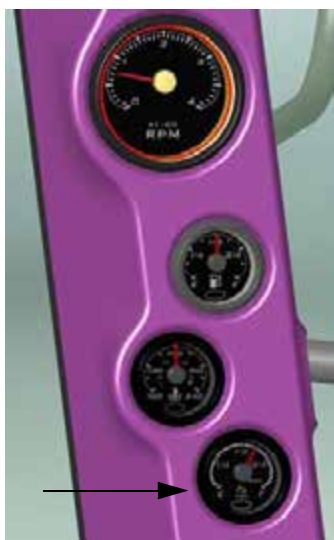
DEF műszer (a fülke a oszlopán) - Tipikus nézet
