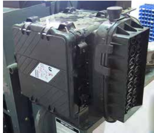
Motor levegőbeszívó szűrő (a gép bal-kéz felőli oldalán lévő járópalló mentén – hozzáféréshez nyissa fel a motorháztetőt) – Tipikus nézet
