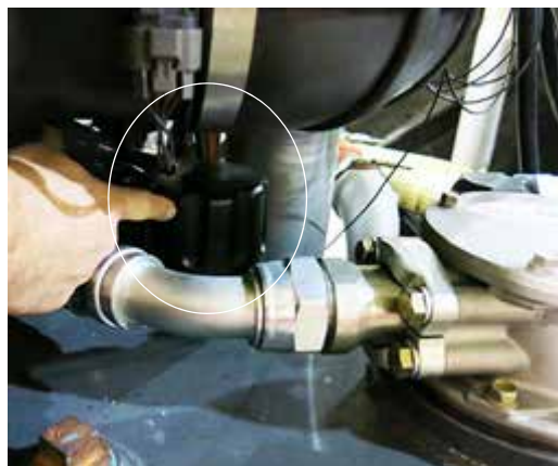
Légzősapka (a gép visszatérő vezeték szűrő házának bal oldalán van elhelyezve) – Tipikus nézet
