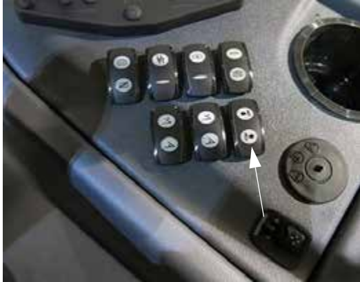
Habjelölő kapcsolója (oldalsó vezérlőpulton) – Tipikus nézet
