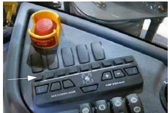
Keritéssor kapcsolók (oldalsó vezérlőpulton) – Tipikus nézet
