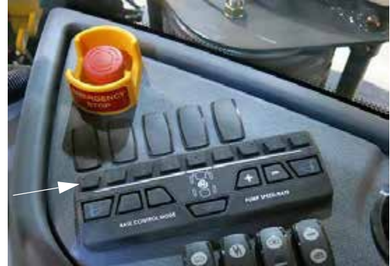
Gém permetlé szelep kapcsolók (oldalsó vezérlőpulton) – Tipikus nézet
