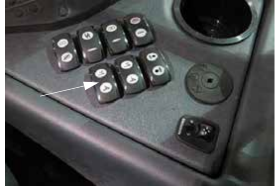
Gém toldalék kapcsoló * 90 láb permetező gémek (oldalsó vezérlőpulton) – Tipikus nézet
