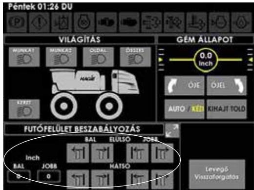
Nyomtáv beállító gombok/jelzések (a Segédvezérlések oldalán)
