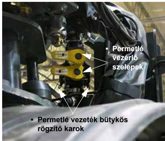
Permetlé vezeték szelepek, és bütykös rögzítő karok (a munkagép elülső bal és jobb oldalán) – Tipikus nézet
