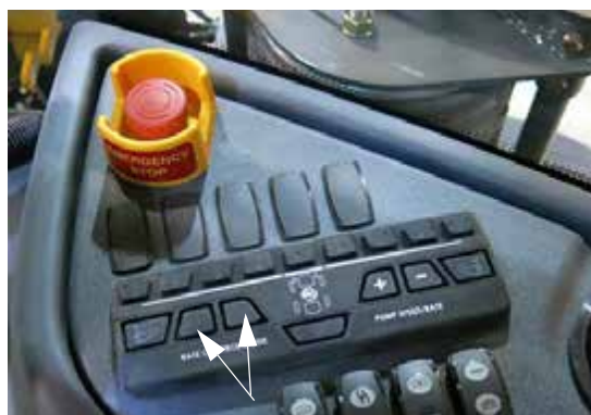
Mérték szabályzó kapcsolók (oldalsó vezérlőpulton) – Tipikus nézet
