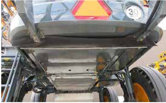
Alvázvédelmi szerelvény/súrlódásvédelmi gumifüggöny telepítés – Tipikus nézet
