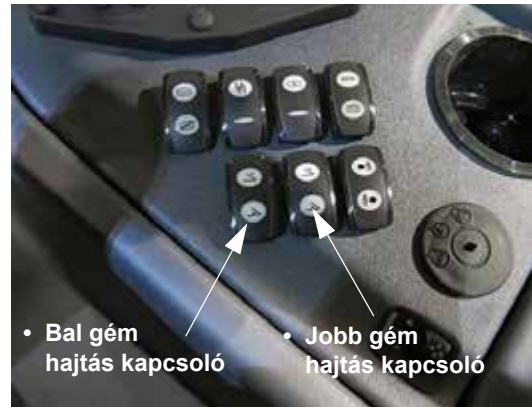
Bal és jobb gém toldalék kapcsolók (oldalsó vezérlőpulton) – Tipikus nézet
