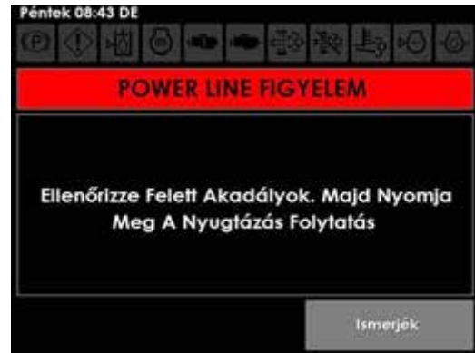
Elektromos vezeték figyelmeztető üzenet (munkagép képernyőjén található)
