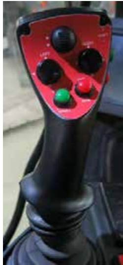
Hidrostatikus vezérlést irányító kar (2-es változat) - Tipikus nézet
