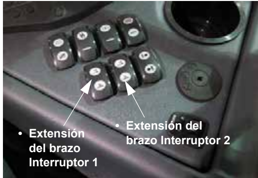
Interruptores de extensión del brazo (ubicados en la consola lateral) -Vista típica
