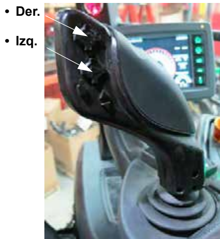
Interruptores del brazo izquierdo y derecho (ubicados en la manilla del control de la transmisión hidrostática) -Vista típica
