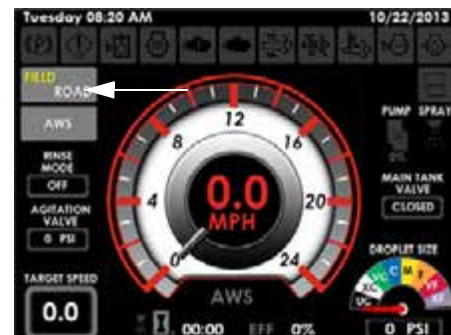
Botón de campo/carretera (ubicado en la página principal – modo de carretera y campo)
