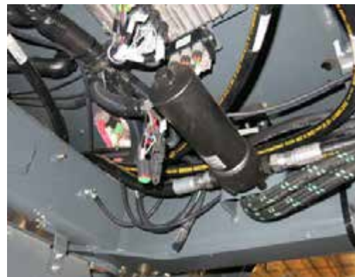
Filtro de presión (ubicado en el lado izquierdo de la máquina; baje el protector metálico para tener acceso) -Vista típica
