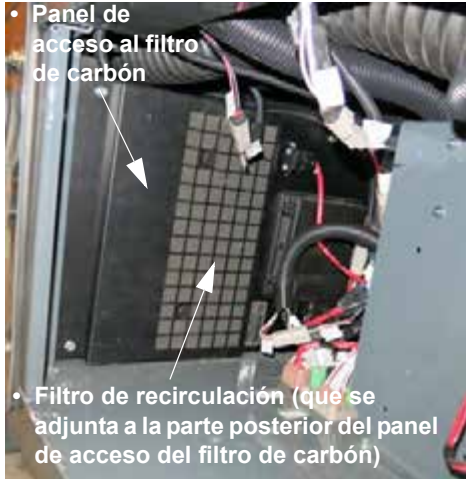
Panel de acceso del filtro de carbón (ubicado detrás de panel de servicio exterior en el lado derecho de la cabina) -Vista típica
