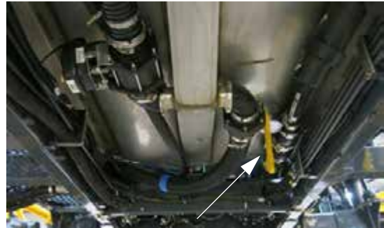
Válvula de sumidero (situada debajo del tanque de solución en el lado derecho de la máquina) -Vista típica
