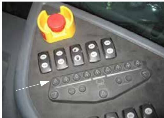
Interruptores de las válvulas de solución del brazo (ubicados en la consola lateral) -Vista típica
