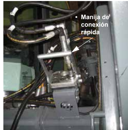
Conjunto del acoplador múltiple hidráulico/eléctrico - (si está instalado) (situado en la parte delantera izquierda de la máquina)
