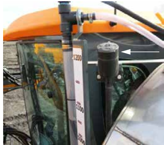
Depósito de líquido del lavaparabrisas (situado detrás del lado izquierdo de la cabina) -Vista típica
