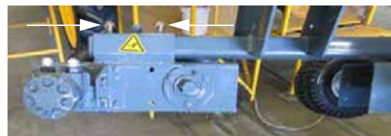
Pernos del extractor cuádruple (ubicados en cada tubo de montaje del extractor cuádruple) -Vista típica
