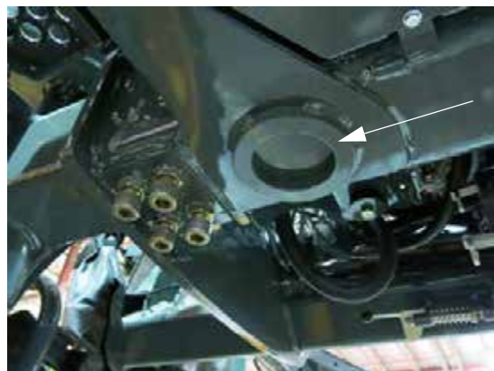
Anillos de contención del punto de elevación (situados en el bastidor cerca de cada pata) -Vista típica
