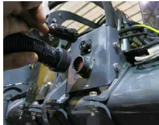
Conexiones eléctricas (en el lado derecho de la máquina) -Vista típica
