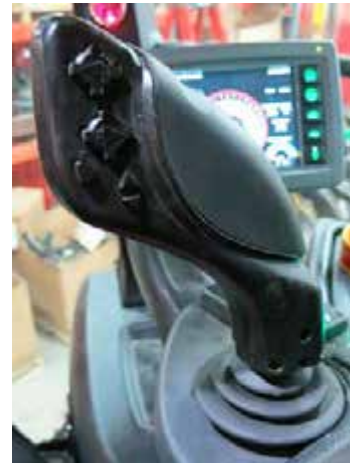
Manilla de control de la transmisión hidrostática (ubicada en la consola lateral) -Vista típica
