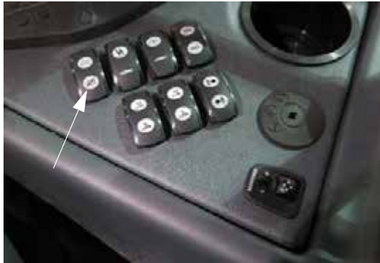
Interruptor de la válvula del tanque principal (ubicado en la consola lateral) -Vista típica
