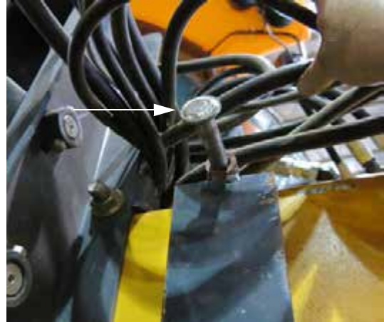
Pasador de fijación (situado en el lado interno de cada soporte del accesorio combinado) -Vista típica
