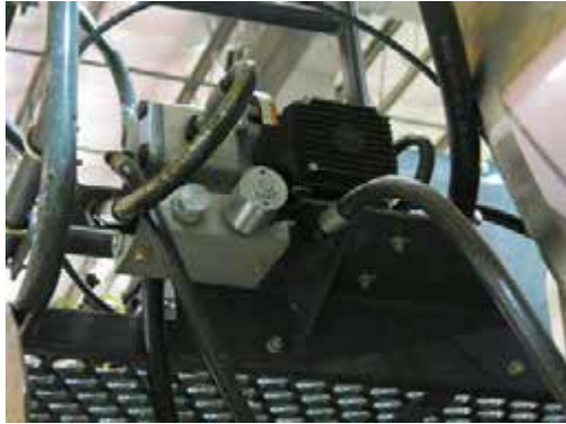
Bomba de la lavadora a presión (ubicada en el lado posterior derecho de la máquina) -Vista típica
