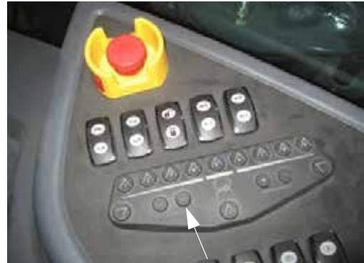
Interruptor manual de control de tasa "MAN" (ubicado en la consola lateral) -Vista típica
