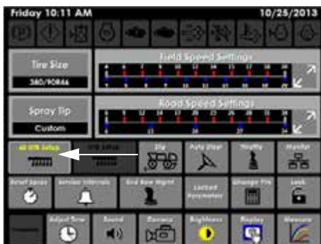
Botón de preparación de la barra de herramienta de nitrógeno de 60 pies (ubicado en la página de ajustes) - Vista típica
