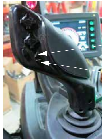
Interruptores todo arriba/abajo (ubicados en la manija de control de la transmisión hidrostática) -Vista típica
