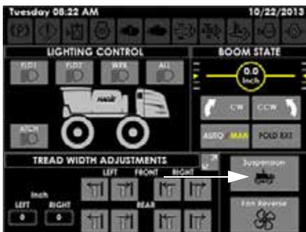
Botón de la suspensión (ubicado en la página de controles auxiliares de la pantalla de la máquina)
