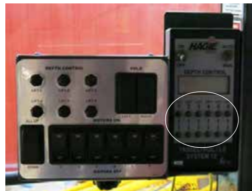
Interruptores de subida/bajada (situados en el panel de control de Tasselrol) -Vista típica
