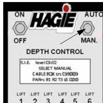
Interruptor automático/manual (situado en el panel de control de Tasseltrol)
