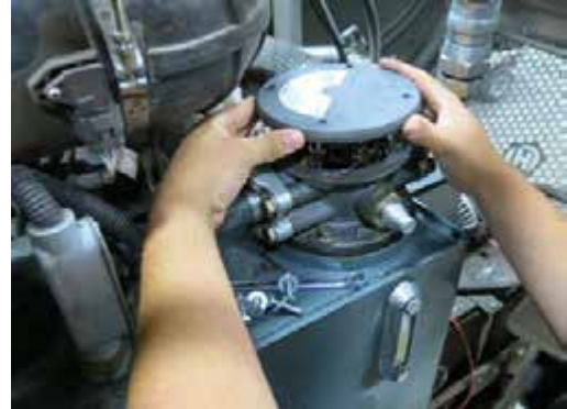
Llenar el depósito a través del alojamiento del filtro de retorno hidráulico -Vista típica
