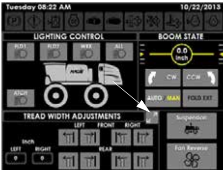
Botón de la página de distancia entre neumáticos (ubicado en la página de controles auxiliares de la pantalla de la máquina)
