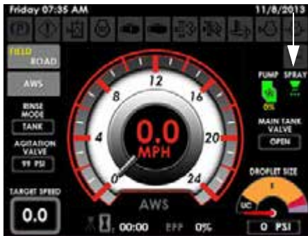
Indicador de aspersión principal (ubicado en la parte superior derecha de la página de inicio de la pantalla de la máquina - modo de campo)
