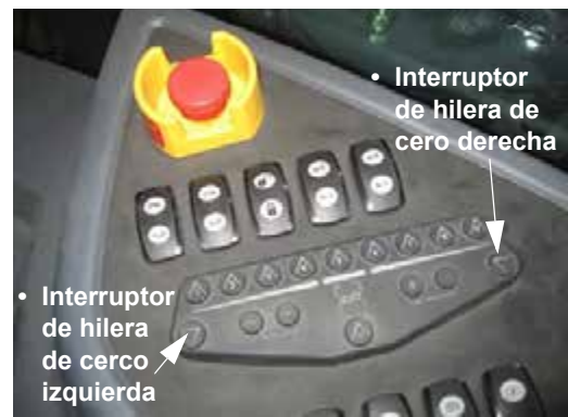
Interruptores de hilera de cerco - derecha e izquierda (ubicado en la consola lateral) -Vista típica
