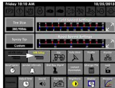
Botón de preparación de la barra de herramienta de nitrógeno (ubicado en la página de ajustes) - Vista típica
