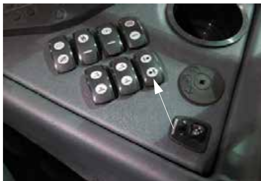
Interruptor para marcador con espuma (ubicado en la consola lateral) -Vista típica
