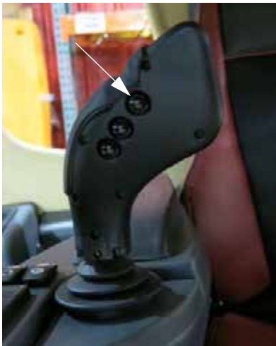
Interruptor de control principal (situado en la parte posterior de la manija de control de la transmisión hidrostática) -Vista típica
