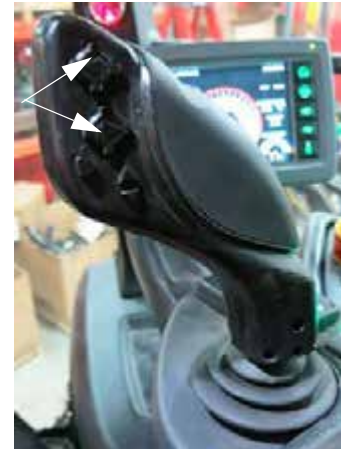
Interruptores del brazo izquierdo y derecho (ubicados en la manija de control de la transmisión hidrostática) -Vista típica
