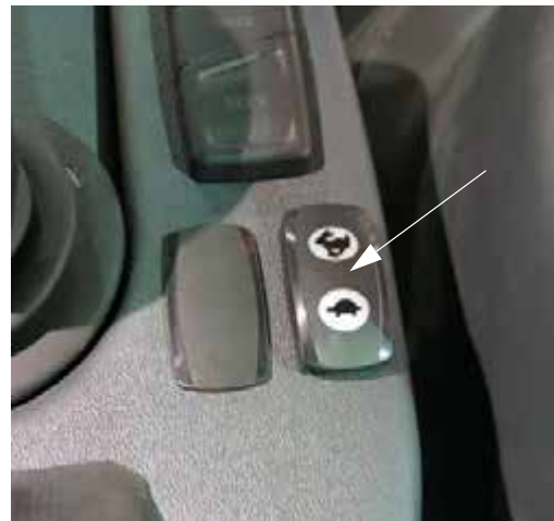
Interruptor del acelerador (situado cerca de la manija de control de la transmisión hidrostática) -Vista típica
