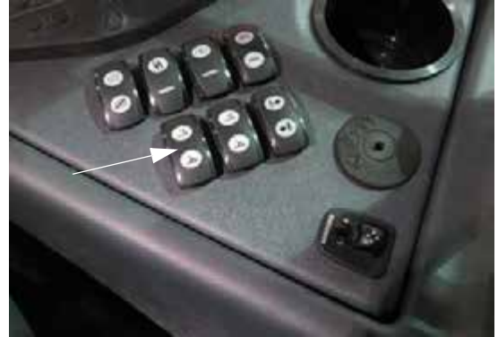
Interruptor de extensión del brazo * Brazos de aspersión de 90 pies (ubicado en la consola lateral) -Vista típica
