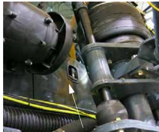
Panel de servicio exterior (situado en el lado derecho de la cabina) -Vista típica
