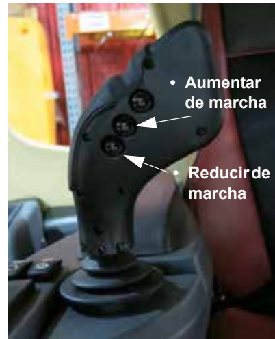
Interruptores para aumentar la marcha/reducir la marcha (ubicados en la parte posterior de la manilla de control de la transmisión hidrostática) -Vista típica.
