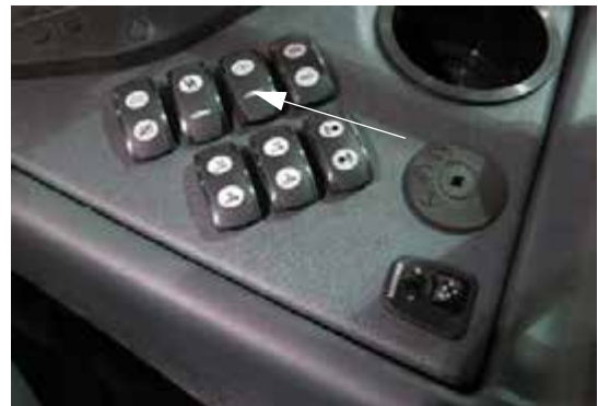
Interruptor de agitación (ubicado en la consola lateral) -Vista típica
