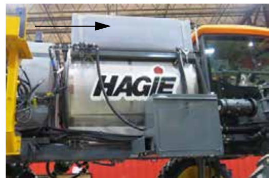
Tanque de lavado -Vista típica
