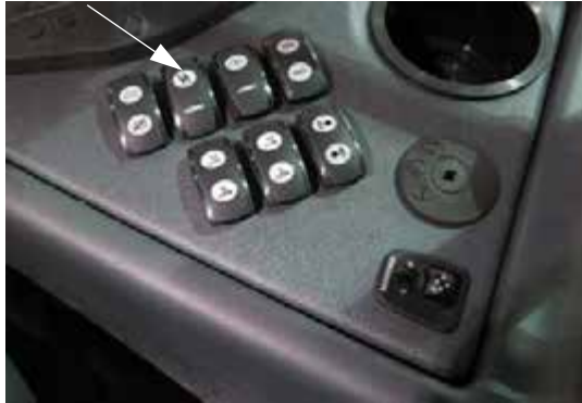
Interruptor de la bomba de solución (ubicado en la consola lateral) -Vista típica
