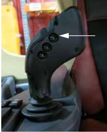
Interruptor de aspersión principal (ubicado en la parte posterior de la manija de control de la transmisión hidrostática) -Vista típica
