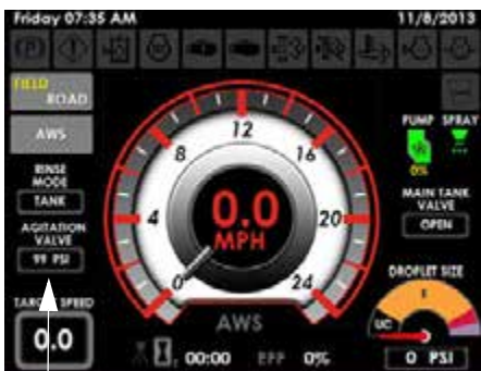
Indicador de presión de la válvula de agitación (ubicado en la página de inicio de la pantalla de la máquina - modo de campo)
