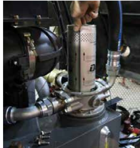
Filtro de retorno (ubicado en el interior del alojamiento del filtro en el lado izquierdo de la máquina) -Vista típica
