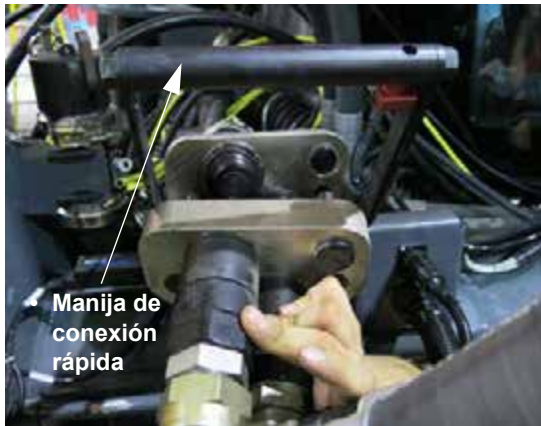
Manija de conexión rápida Conjunto de acoplador múltiple hidráulico (en el lado derecho de la máquina) -Vista típica
