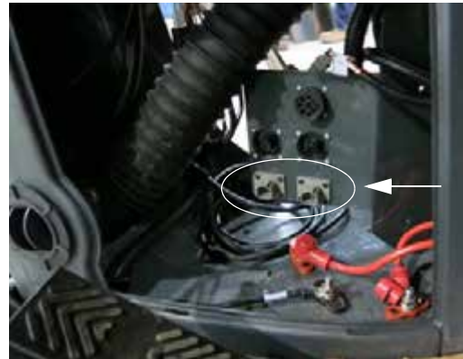
Conectores de alimentación de 4 pines (2) (ubicados dentro de la consola lateral- retire el panel frontal para acceder) -Vista típica
