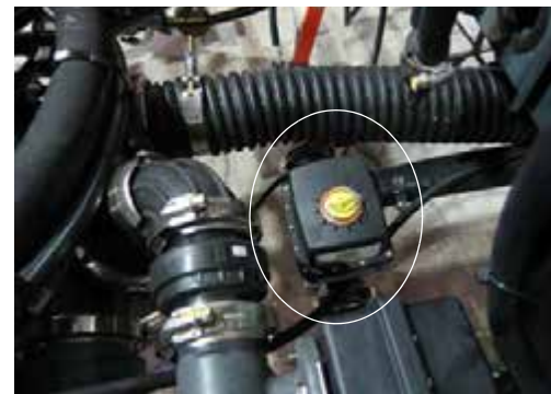
Válvula de agitación (ubicada cerca del centro de la máquina) -Vista típica
