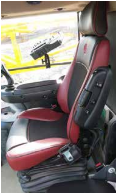
Interruptor de presencia del operador (OPS) (ubicado dentro del asiento del operador) -Vista típica
