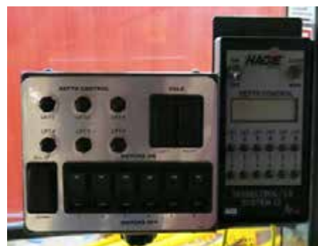
Panel de control del sistema 12 Tasselrol/LS -Vista típica
