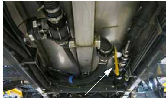
Válvula de sumidero (situada debajo del tanque de solución en el lado derecho de la máquina) -Vista típica
