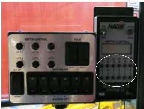
Interruptores de subida/bajada (situados en el panel de control de Tasselrol) -Vista típica
