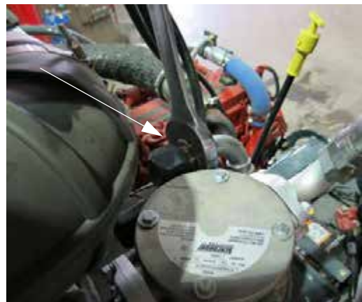
Manguera de drenaje de la carcasa (situada cerca de la parte superior del depósito hidráulico) -Vista típica
