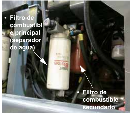
Filtros de combustible principal y secundario (situados a lo largo del lado izquierdo de la máquina) -Vista típica
