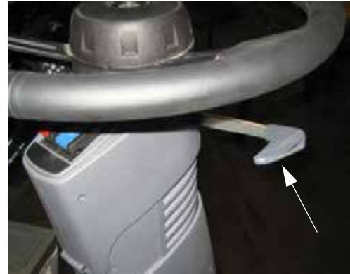
Palanca de ajuste telescópico del volante (ubicada a la derecha de la columna de dirección) -Vista típica
