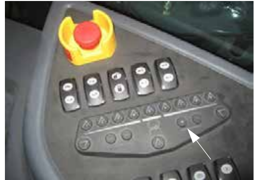
Interruptor de tasa/velocidad de la bomba “+” (ubicado en la consola lateral) -Vista típica
