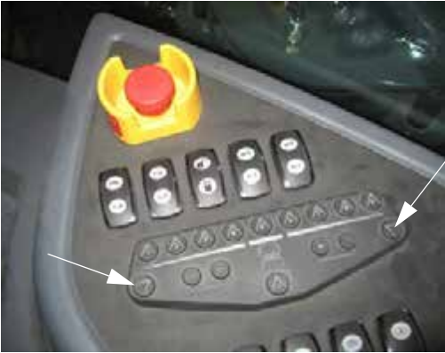
Interruptores de hilera del cerco (ubicados en el lado de la consola) -Vista típica
