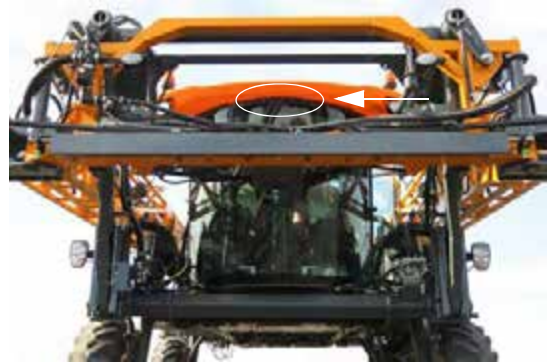
Boquilla de pulverización del líquido del lavaparabrisas (situada cerca de la parte superior de la cabina exterior) -Vista típica
