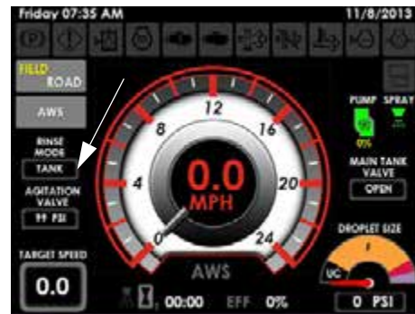
Indicador del modo de lavado (ubicado en la página principal de la pantalla de la máquina – modo de campo)
