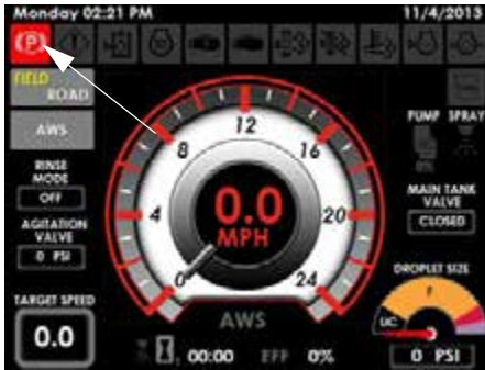
Indicador del freno de mano (ubicado en el lado izquierdo superior de cada página en la pantalla de la máquina)
