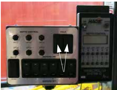
Interruptores de plegado izquierdo/derecho (situados en panel de control de despenachado) -Vista típica
