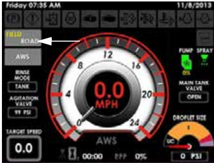
Botón de campo/carretera (ubicado en la página de inicio de la pantalla de la máquina)
