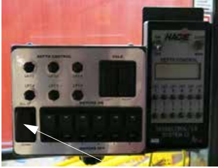
Interruptores todo arriba/abajo (ubicados en el panel de control de despenchado) -Vista típica
