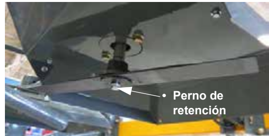
Conjunto de cuchilla de corte (montado en la parte inferior del cabezal de corte) -Vista típica
