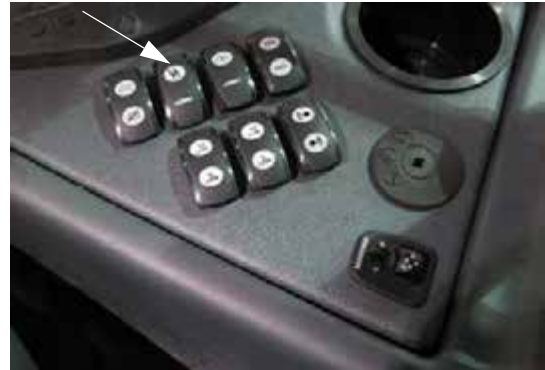
Interruptor de la bomba de solución (ubicado en la consola lateral) -Vista típica
