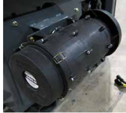
Sistema de filtrado de la cabina (ubicado al lado derecho del exterior de la cabina) -Vista típica
