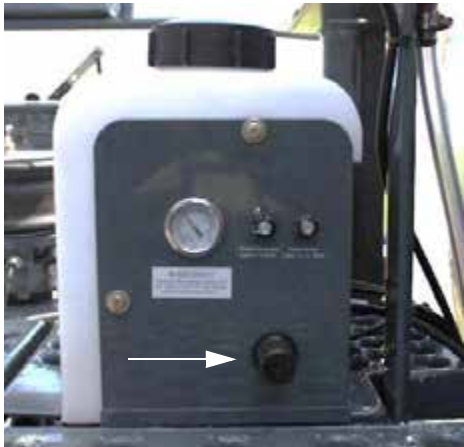
Selector de presión de espuma (ubicado en la parte lateral del tanque del marcador de espuma) -Vista típica
