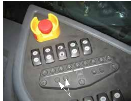
Interruptores de control de flujo (ubicados en la consola lateral) -Vista típica
