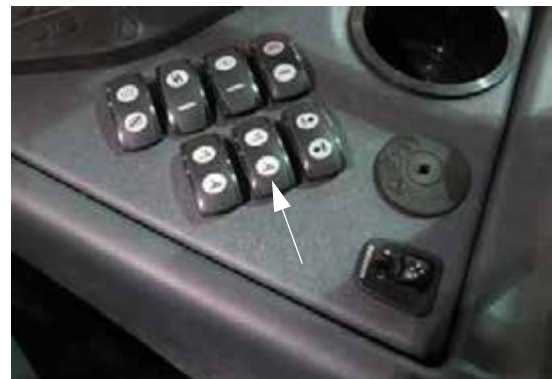
Interruptor de extensión del brazo - “desenganche del brazo” (ubicado en la consola lateral) -Vista típica
