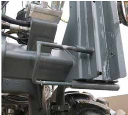
Pasador de bloqueo (situado en la parte delantera izquierda y derecha de la máquina)
