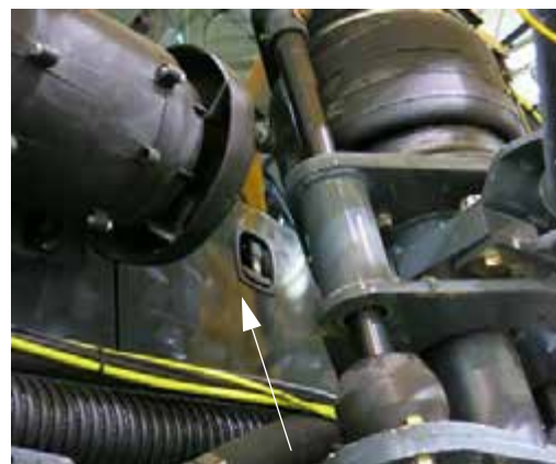
Panel de servicio exterior (ubicado en el lado derecho de la cabina) -Vista típica
