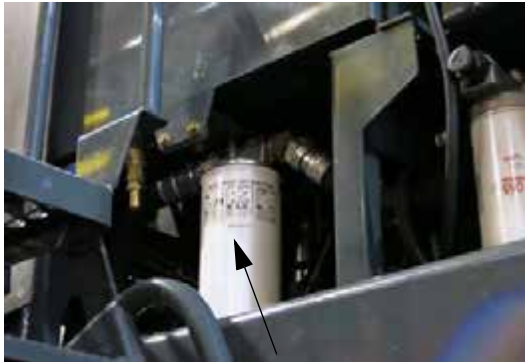
Filtro de drenaje de la carcasa (ubicado en el lado izquierdo de la máquina) -Vista típica
