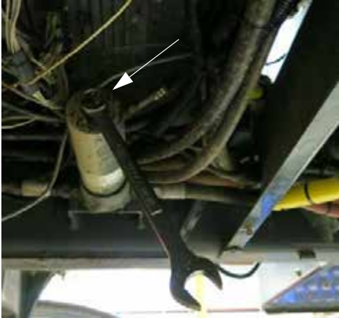
Carcasa del filtro de presión (ubicado debajo del lado derecho de la máquina; mueva hacia abajo el protector metálico para acceder) -Vista típica
