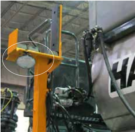
Luces de trabajo (ubicadas en cada lado de los receptáculos de los brazos) -Vista típica
