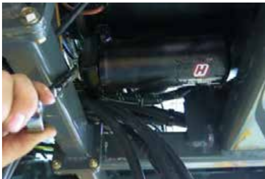
Filtro de la bomba de carga (situado debajo de la bomba impulsora) -Vista típica
