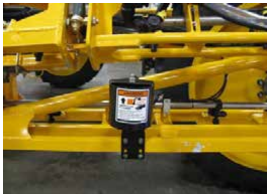
Garnitură de burete senzor Norac (amplasată pe fiecare senzor Norac) - Vedere tipică
