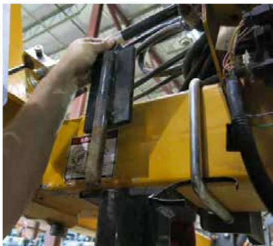
Placă opritoare (amplasat pe partea interioară a fiecărui suport de atașament combinat) - Vedere tipică
