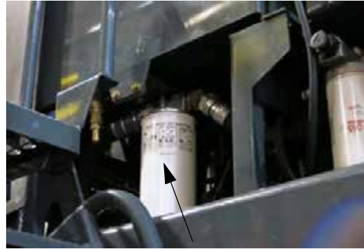
Filtru de drenare a carcasei (Amplasat pe partea stângă a utilajului) - Vedere tipică
