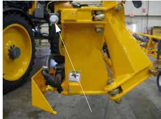
Senzori de proximitate - Vedere tipică
