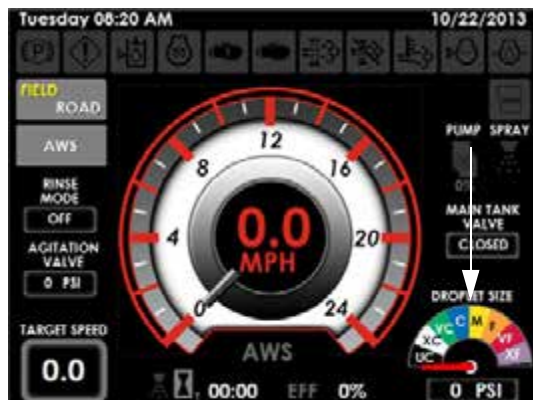
Indicador Dimensiune picături (amplasat pe Pagina inițială a afișajului utilajului - modul Câmp)
