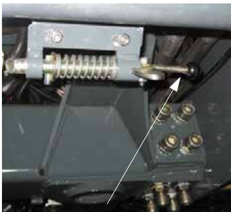
Manetă de eliberare gură de umplere frontală (amplasată sub partea din față a utilajului) - Vedere tipică
