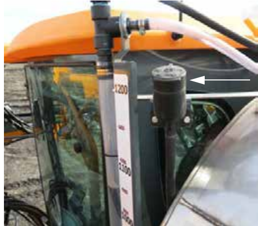
Rezervorul pentru lichid de spălare a parbrizului (amplasat în spatele părții din stânga a cabinei) - Vedere tipică
