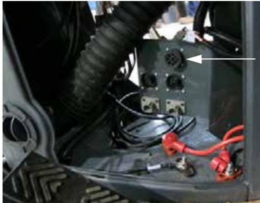
Port Diagnoză motor (amplasat în interiorul consolei laterale - demontați panoul frontal pentru acces) - Vedere tipică
