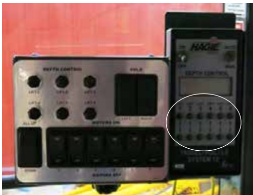
Comutatoare elevator sus/jos (pe panoul de comandă Tasselrol) - Vedere tipică
