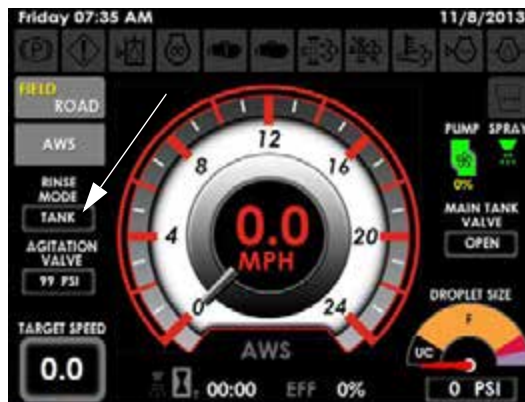
Indicator Mod clătire (amplasat pe Pagina inițială a afișajului utilajului - modul Câmp)
