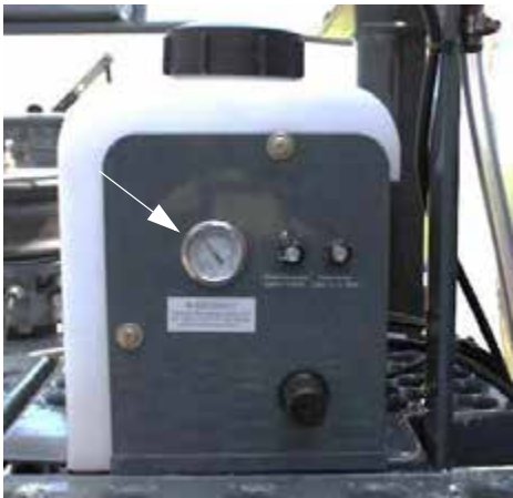
Manometru de spumă (amplasat pe partea laterală a rezervorului marcatorului cu spumă, montat pe partea dreaptă a utilajului) - Vedere tipică
