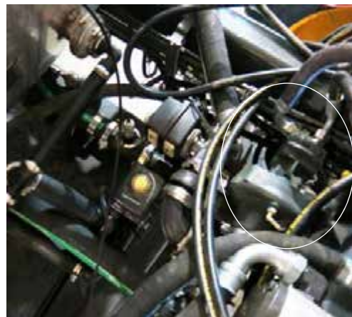
Pompă de soluție (amplasată în apropierea centrului utilajului) - Vedere tipică * Vedere de sus a utilajului
