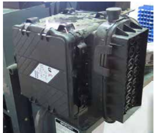
Filtrul pentru aerul de admisie al motorului (amplasat de-a lungul punții de acces pe partea stângă a utilajului - deschideți capota pentru acces) - Vedere tipică
