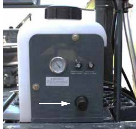
Cadran de presiune a spumei (amplasat pe partea laterală a rezervorului marcator cu spumă) - Vedere tipică
