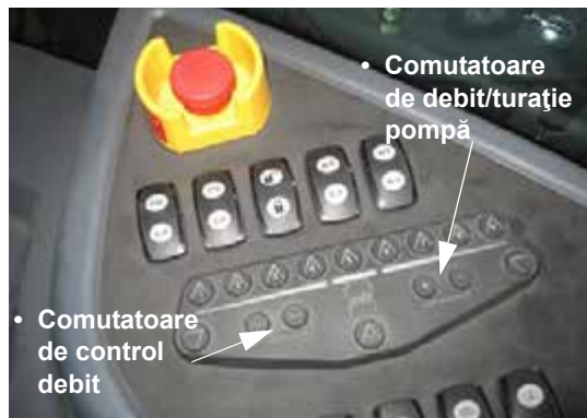
Comutatoare de debit/turație pompă și control debit (amplasate pe consola laterală) - Vedere tipică
