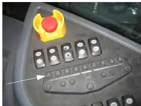
Comutatoare supape de soluție de pe brațe (amplasat pe consola laterală) - Vedere tipică
