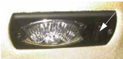
Comutator lampă interioară de lucru - Vedere tipică
