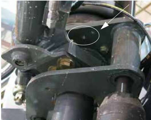
Gresor Zerk colier (amplasat sub fiecare placă de montaj a pernei de aer) - Vedere tipică
