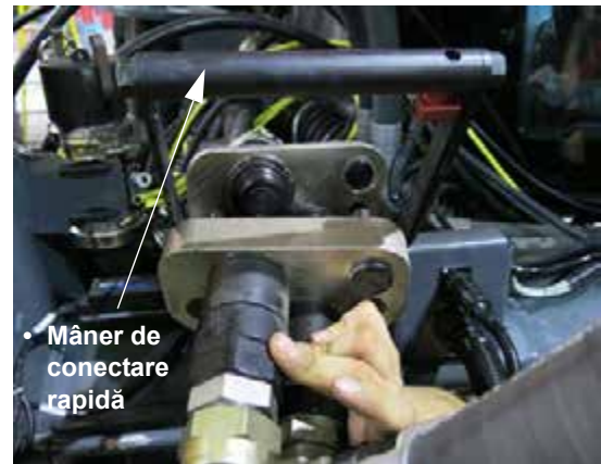
Ansamblu cuplaj multiplu hidraulic (este prezentată partea dreaptă a utilajului) - Vedere tipică
