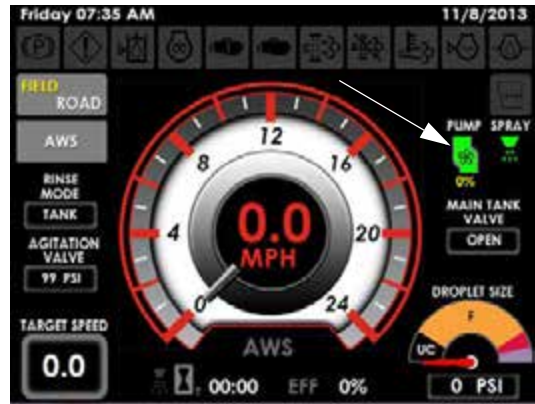
Indicator pompă de soluție (amplasat Pagina inițială a afișajului utilajului - modul Câmp)
