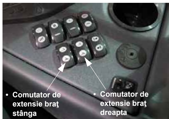
Comutatoare de extensie brațe din stânga și din dreapta (Pe consola laterală) - Vedere tipică
