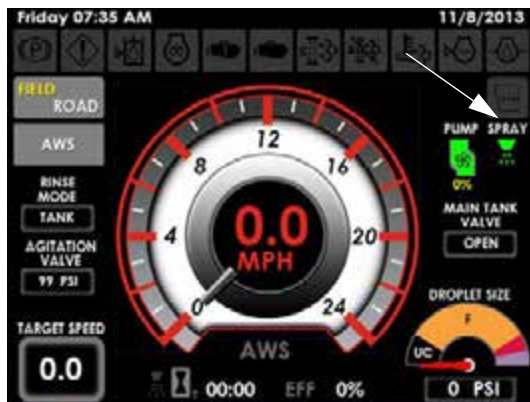
Indicator Pulverizator principal (amplasat pe Pagina inițială a afișajului utilajului - modul Câmp)
