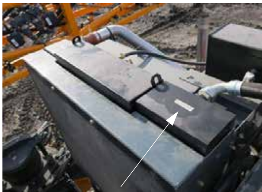
Răcitor de ulei (amplasat în apropierea părții din spate a utilajului - deschideți capota pentru accesare) - Vedere tipică
