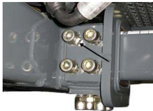
Piuliță de blocare (amplasată pe fiecare șurub al suportului pentru reglarea benzii de rulare) - Vedere tipică
