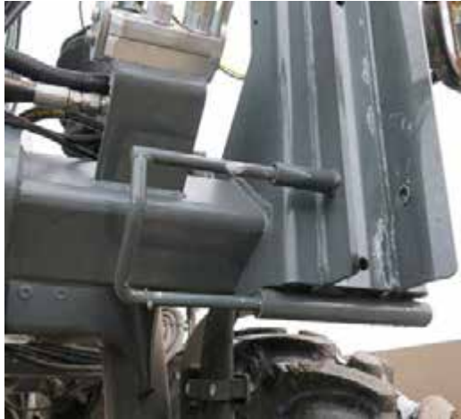
Știft de blocare (amplasat pe partea din stânga și dreapta față a utilajului)
