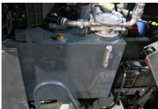
Rezervor de ulei hidraulic (amplasat pe partea stângă a utilajului - deschideți capota pentru accesare) - Vedere tipică
