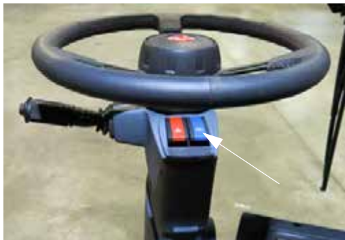
Comutator Lumini de poziție pentru drumuri publice (amplasat pe coloana de direcție) - Vedere tipică
