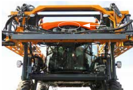
Duza de pulverizare a lichidului spălător de parbriz (amplasat lângă partea superioară a cabinei exterioare) - Vedere tipică
