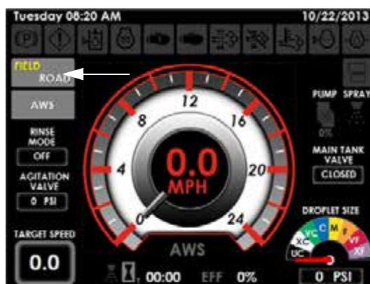
Buton Field/Road (Câmp/Drum) (amplasat pe Pagina inițială a afișajului utilajului - modul Drum și Câmp)
