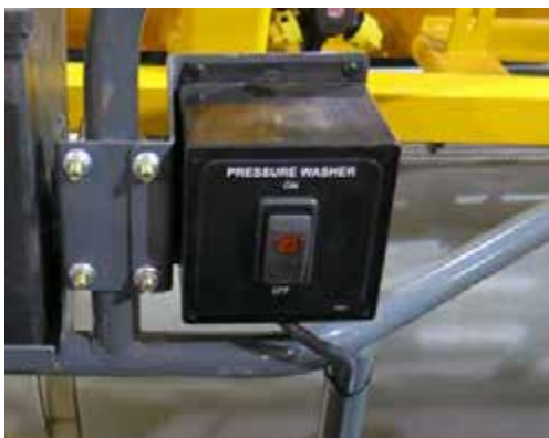
Nagynyomású tisztító kapcsoló (a gép bal oldalán a fogódkodó mentén) – Tipikus nézet
