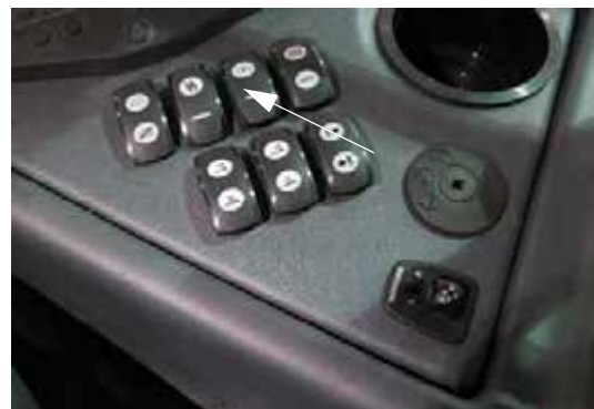
Keverőszelep kapcsolója (oldalsó vezérlőpulton) – Tipikus nézet
