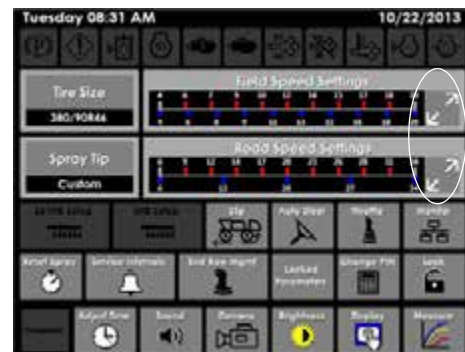
Beszabályozás gombok - Mezői/Országúti sebesség beállítások (a beállítások oldalon)
