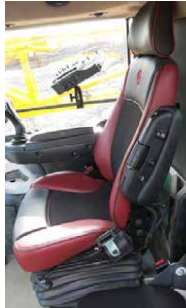
Kezelőjelenlét kapcsoló (a kezelő ülésében) - Tipikus nézet
