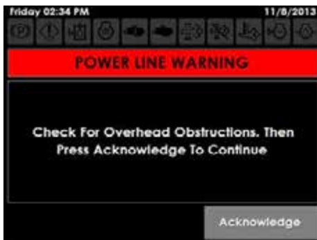
Elektromos vezeték figyelmeztető üzenet (munkagép képernyőjén található)
