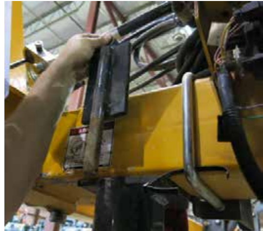
Ütközőlap (minden egyes kombinált szerelvény állvány belső oldalánál helyezkedik el) – Tipikus nézet
