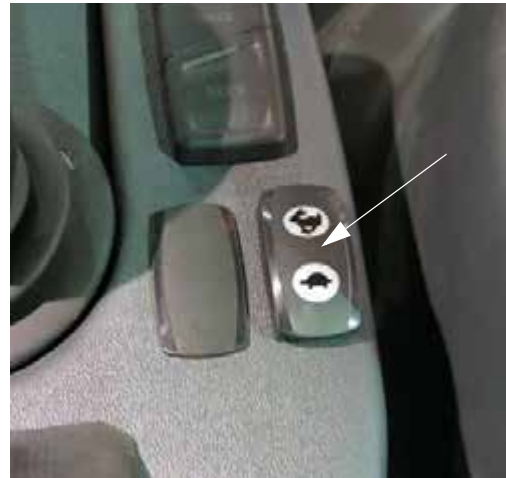
Fojtás kapcsoló (a hidrosztatikus hajtás vezérlőkarja mellett) – Tipikus nézet
