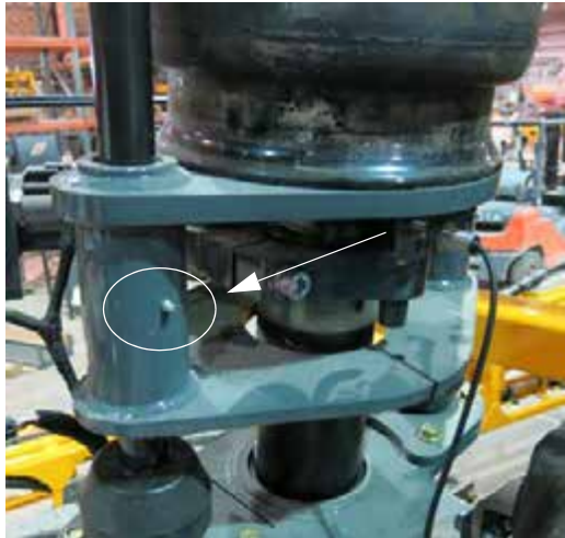
Támasz csapágy Zerk zsír (az első és hátsó lábakon található) – Tipikus nézet
