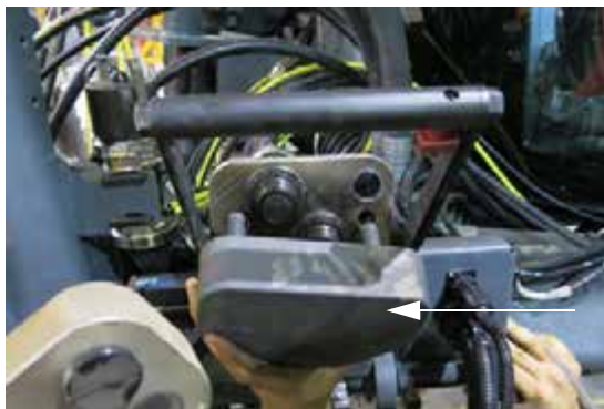
Hidraulikus csatlakozó sapka (a gép jobb oldalánál helyezkedik el) – Tipikus nézet
