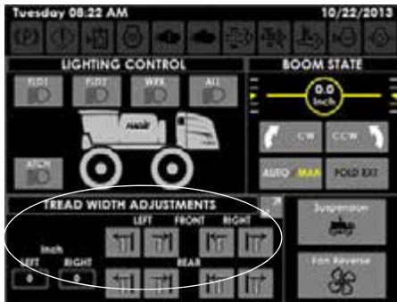
Nyomtáv beállítás gombok (jobb kéz felőli oldalt a munkagép képernyőjének Segédvezérlések oldalán)
