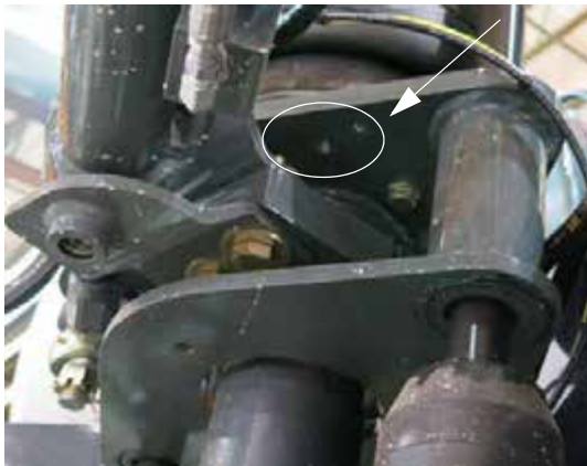
Gallér zsírozószem (a légzsák szerelőlapja alatt helyezkedik el) – Tipikus nézet
