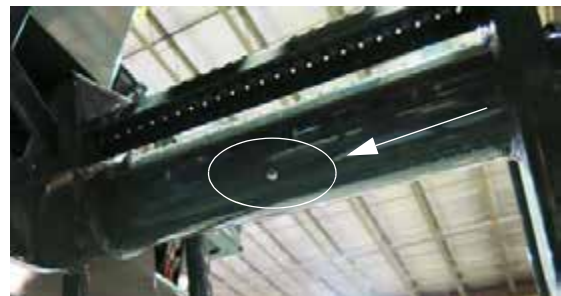
Létra, forgástengely hüvely – Tipikus nézet
