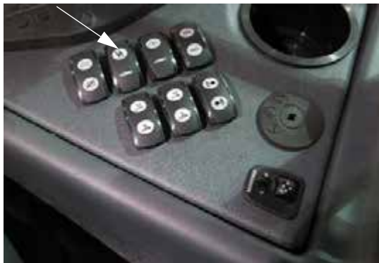
Permetlé szivattyú kapcsoló (oldalsó vezérlőpult) – Tipikus nézet
