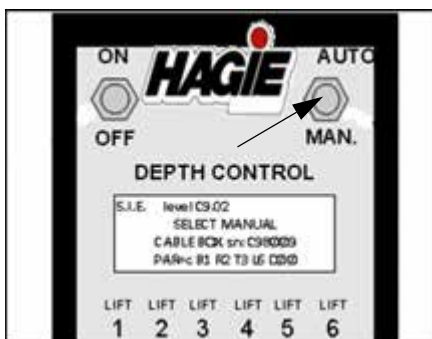
Auto/kézi kapcsoló (a Tasselrol vezérlőpanelen található)
