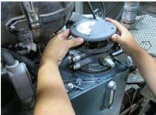
Tartály töltése a hidraulikus visszatérő szűrőházon keresztül –Tipikus nézet
