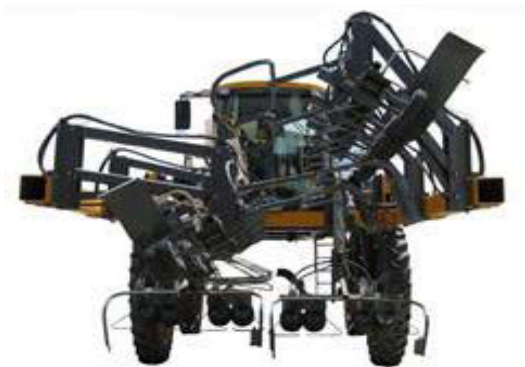
Címerező fejek lépcsőzetes elrendezése – Tipikus nézet
