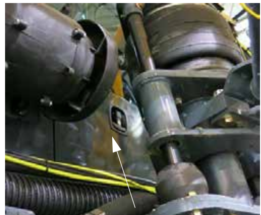
Külső szerviz panel (a vezetőfülke jobb oldalán helyezkedik el) – Tipikus nézet
