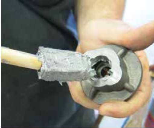
Beragadás gátló kenőanyag alkalmazása – Tipikus nézet
