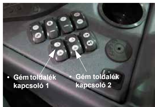
Gém toldalék kapcsolók (oldalsó vezérlőpulton) – Tipikus nézet
