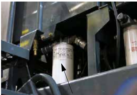
Tartály leeresztő szűrője (a gép bal oldalánál van elhelyezve) – Tipikus nézet
