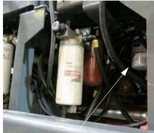
Motorolajszűrő (a gép bal oldala mentén van elhelyezve) – Tipikus nézet
