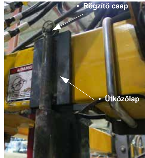
Ütközőlap/rögzítő csap összeszerelés – Tipikus nézet
