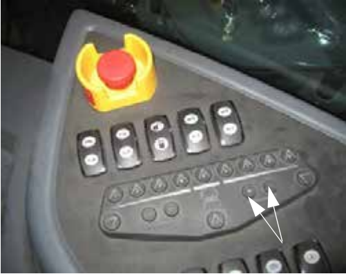
Szivattyú sebesség/Arány kapcsolók (oldalsó vezérlőpulton) – Tipikus nézet
