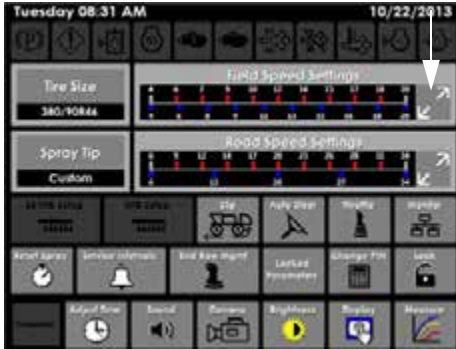
Mezei sebesség beállításának beszabályozás gombja (a beállítások oldalán)
