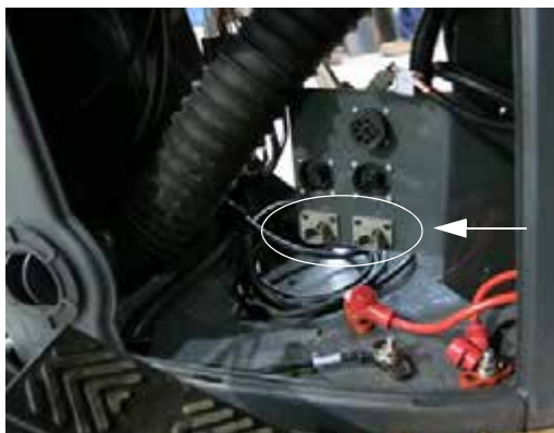
4 tűs elektromos csatlakozó (2) (az oldalkonzol belsejében – a panel levételével férhet hozzá) – Tipikus nézet
