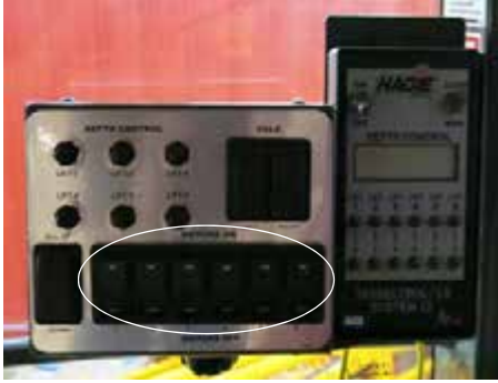
Motor vezérlő kapcsolók (a címerező vezérlő paneljén van elhelyezve) – Tipikus nézet
