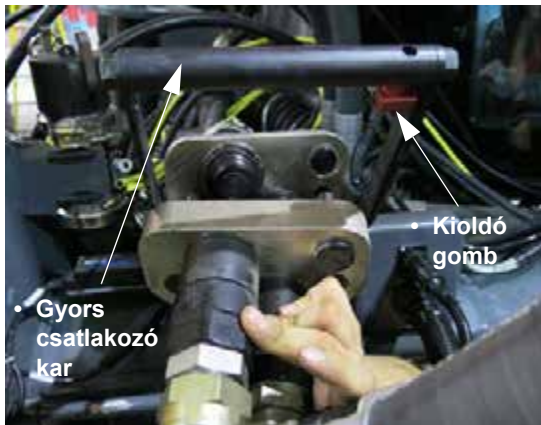
Hidraulikus multi-csatlakozó összeszerelés (a gép jobb oldalánál helyezkedik el) – Tipikus nézet
