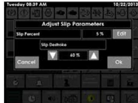
Csúszási értékek be szabályozása képernyő
