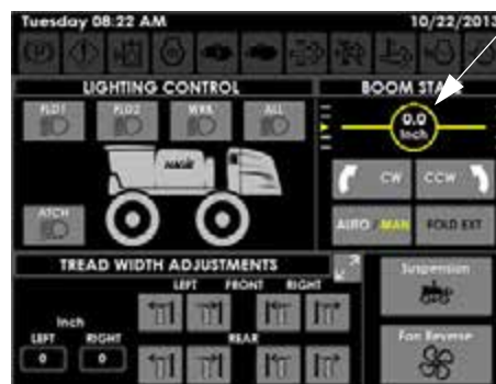
Gém igazítási érték (a Kiegészítő vezérlők oldal jobb oldalán)
