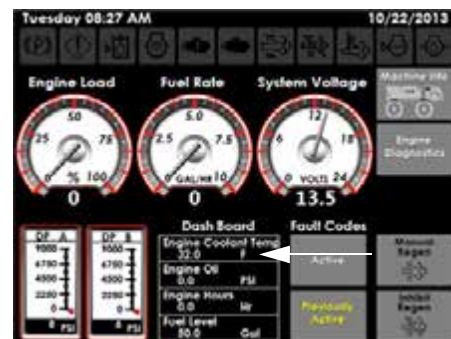
Motor hűtőfolyadék hőmérsékletét kijelző (Elhelyezve a gémen) Gépdiaosztika oldal
