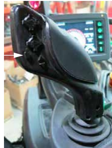
Sorvég kezelés kapcsolója (a hidrosztatikus hajtás vezérlőkarján) – Tipikus nézet
