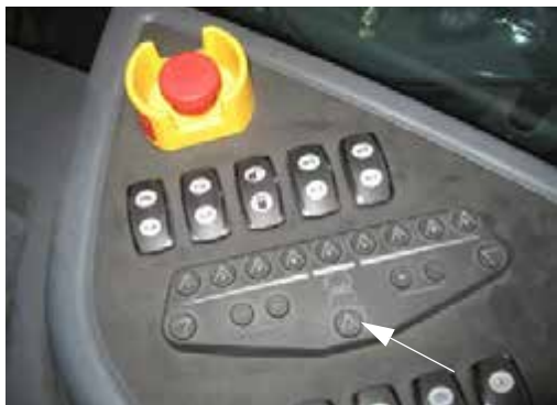
Hátsó fúvóka kapcsoló (oldalsó vezérlőpulton) – Tipikus nézet
