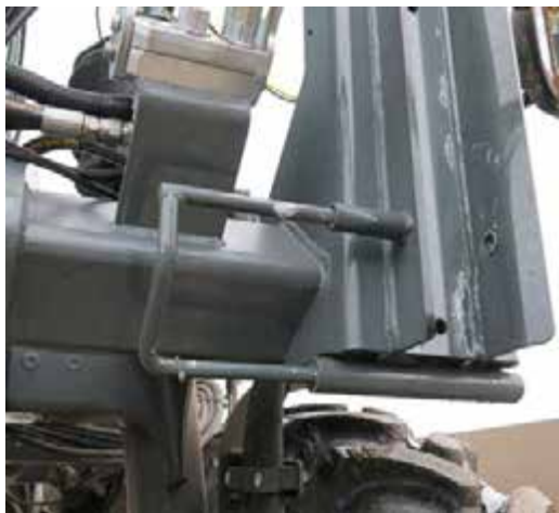
Záró csapszeg (A gép elülső bal, és jobb oldalánál helyezkedik el) – Tipikus nézet
