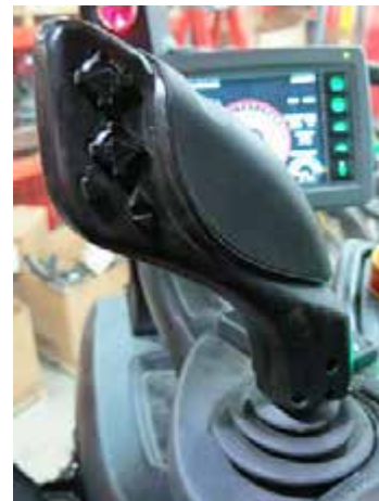
Hidrosztatikus hajtás vezérlőkarja (oldalsó vezérlőpulton) – Tipikus nézet
