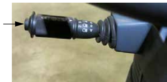
Kürt gomb (az irányjelző kapcsolókar végén) – Tipikus nézet
