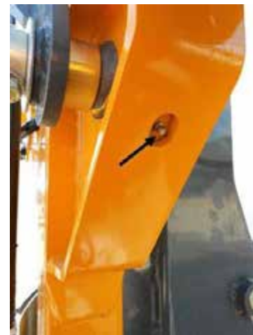
Forgástengelyes támasztómű gömbcsukló – Tipikus nézet
