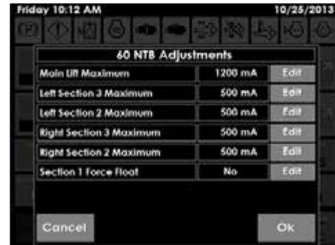
A 60' NTB finom beállítás képernyője - Tipikus nézet
