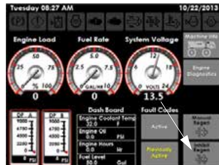
Regeneráló gátlása gomb (a gépdiagnosztika oldal jobb oldalán)
