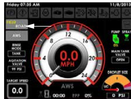
Mezei/Közúti üzemmód gomb (a munkagép képernyőjének kezdőoldalán)
