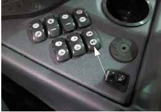
Habjelölő kapcsolója (oldalsó vezérlőpulton) – Tipikus nézet
