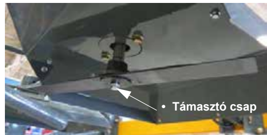
Vágó penge összeszerelés (a vágófej alsó oldalára van rögzítve) – Tipikus nézet
