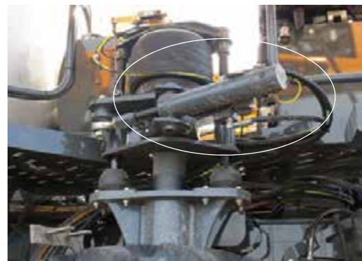
Kormány munkahenger (a hátsó lábakon) – Tipikus nézet
