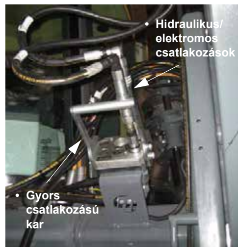
Hidraulikus/elektromos multi-csatlakozó összeszerelés – „ha fel van szerelve” (a gép elülső, bal oldalánál helyezkedik el)
