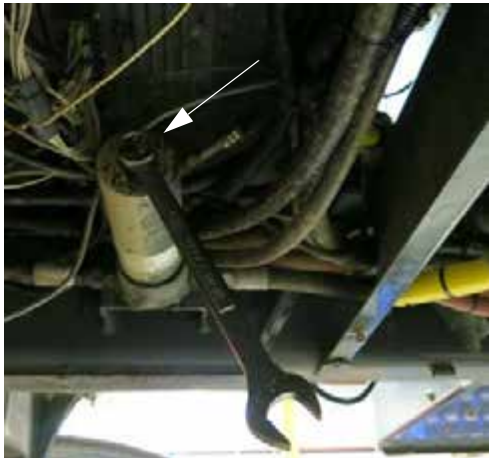
Nyomóági szűrő háza/burkolata (a gép jobb oldala alatt - a fém lemez levételével férhet hozzá) – Tipikus nézet
