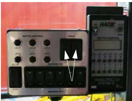
Bal/jobb behajtó kapcsolók (a címerező vezérlőpaneljén található) – Tipikus nézet
