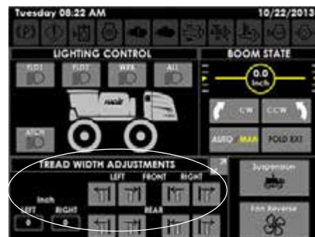
Nyomtáv beállítás gombok/kijelzők (a Segédvezérlések oldalán)
