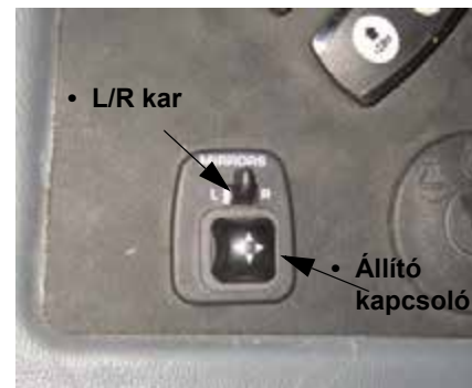
Motoros visszapillantó tükrök kapcsolója (oldalsó vezérlőpulton) – Tipikus nézet
