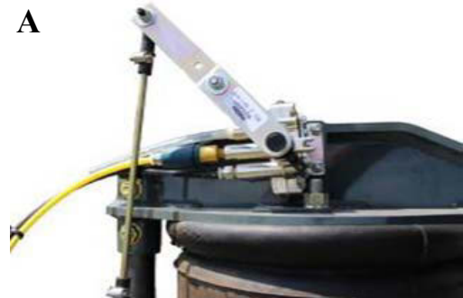
A Gyorsürítő szelep (egy-egy szelep van elhelyezve minden egyes lábnál) – Tipikus nézet
