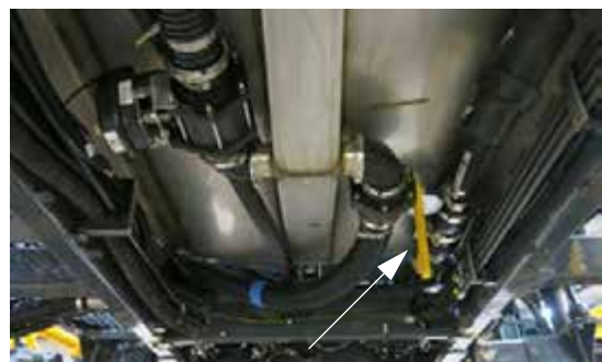
Elvezető szelep (a gépezet jobb kéz felőli oldalán a permetlé tartály alatt) – Tipikus nézet
