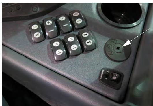
点火开关 (位于侧控制台上) - 典型视图
