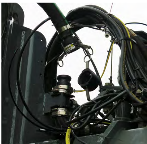
药液连接 (位于机器右前侧) - 典型视图
