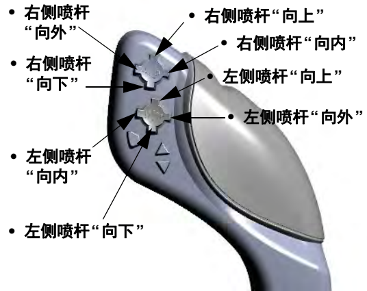
左/右喷杆开关方向 - 典型视图
