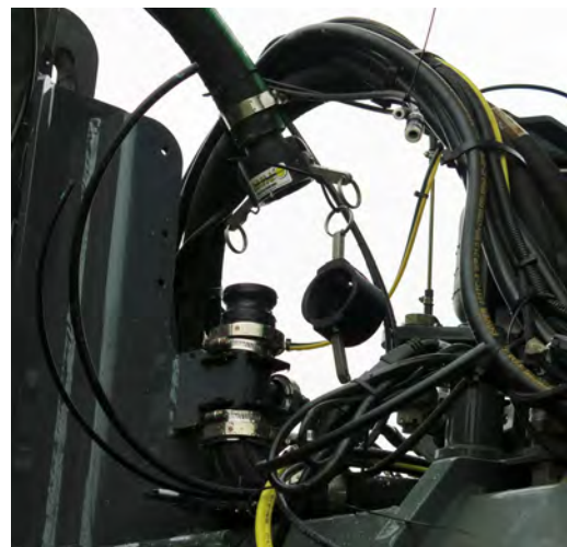
药液连接 (位于机器右前侧) - 典型视图
