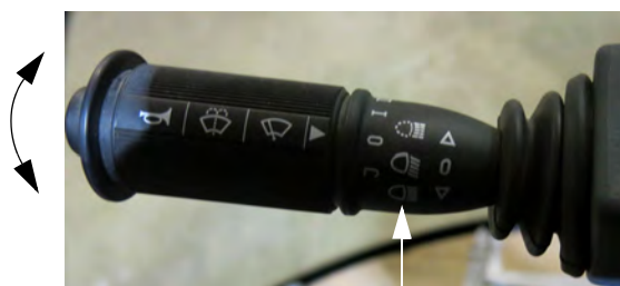
远光灯 (位于转向信号操纵杆上) - 典型视图
