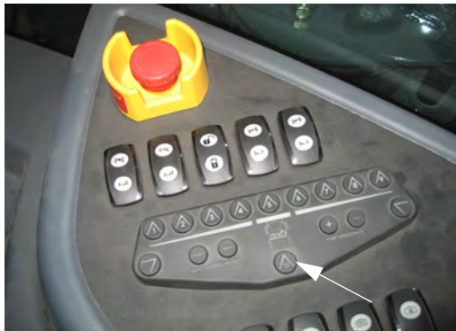
后喷嘴开关 (位于侧控制台上) -典型视图
