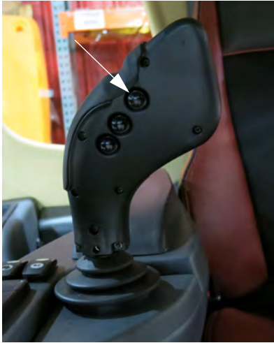
主控开关 (位于静液压驱动手柄的背侧) - 典型视图
