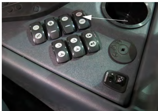
清洗开关 (位于侧控制台上) - 典型视图
