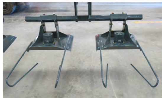
秸秆导向杆安装 - 典型视图
