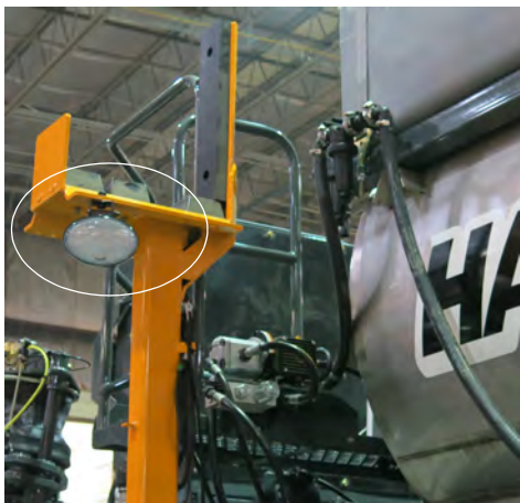
工作灯 (位于每个喷杆托架上) - 典型视图
