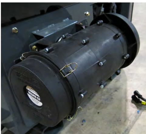
驾驶室过滤系统 (位于驾驶室室外的右侧) - 典型视图
