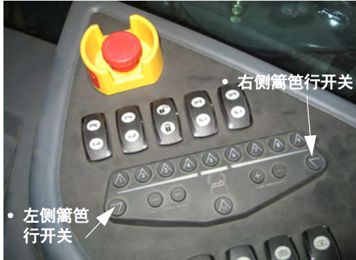
左侧和右侧篱笆行开关 (位于侧控制台上) -典型视图
