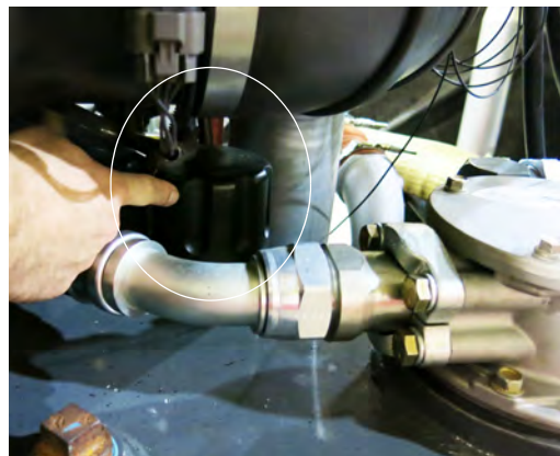
通气盖 (位于机器左手侧回油过滤器外壳的附近) - 典型视图
