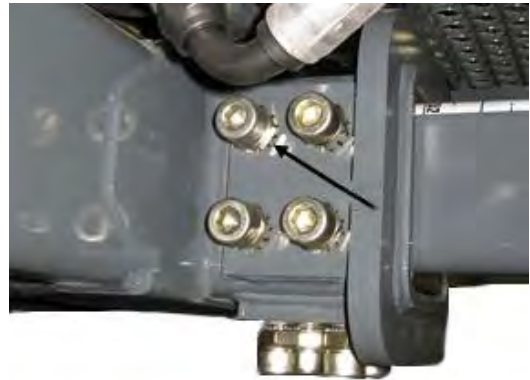
防松螺母 (位于每个胎面调整轴承螺栓上) - 典型视图
