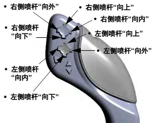
左/右喷杆开关方向 - 典型视图
