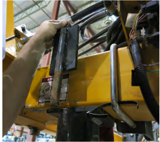
止动板 (位于每个组合式 附件支架向内侧) - 典型视图
