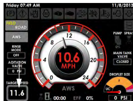
目标速度 (位于主页 – 道路和现场模式的左下侧)
