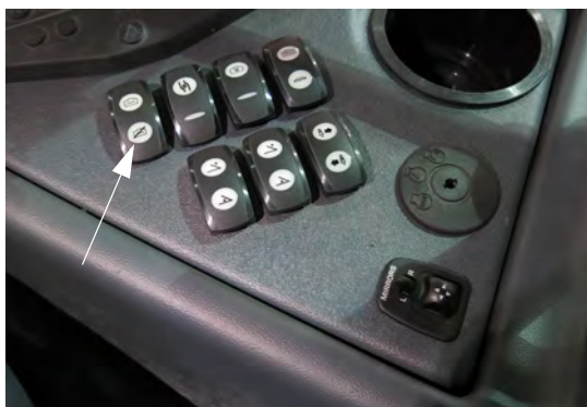
主箱阀开关 (位于侧控制台上) - 典型视图
