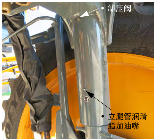
立腿管润润滑脂加油嘴和卸压阀 (位于前后立腿) - 典型视图
