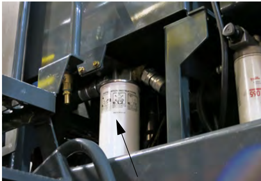
箱体排油管过滤器 (位于机器左手侧) - 典型视图
