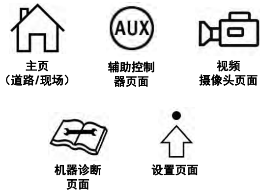
页面显示按钮 （位于机器显示屏的右侧）
