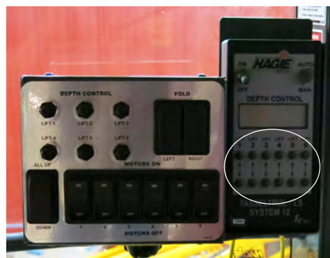
向上提升/下降开关 (位于 Tasseltrol 控制面板) - 典型视图
