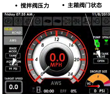
主箱阀门状态和搅拌阀压力指示器 (位于机器显示屏主页 - 现场模式)
