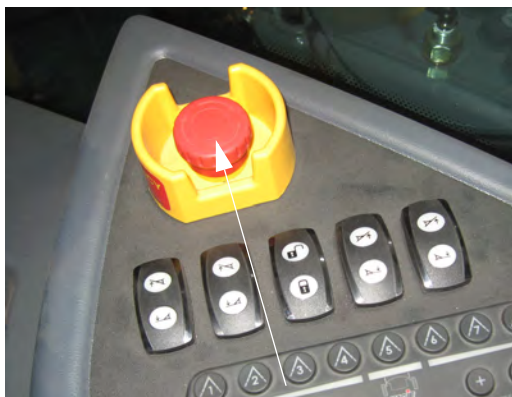
紧急停止按钮 （位于侧控制台上） - 典型视图
