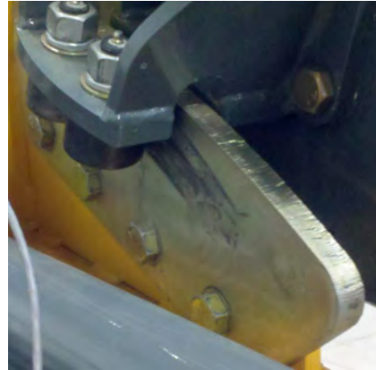
摩擦片 （位于固定连杆和转动连 杆之间的底角中） - 典型视图
