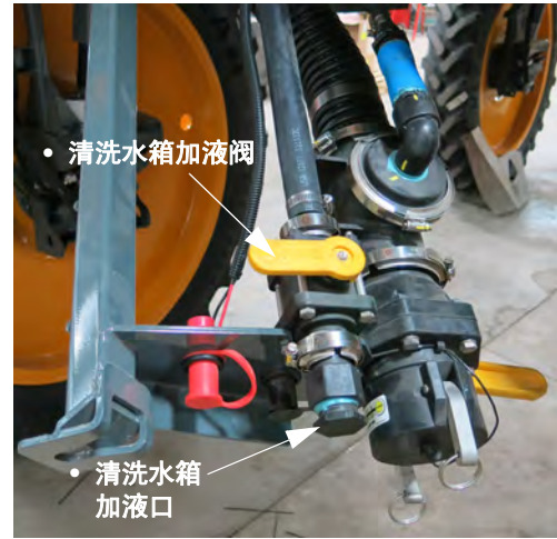
前加液口总成 (图示为降低后的位置) - 典型视图
