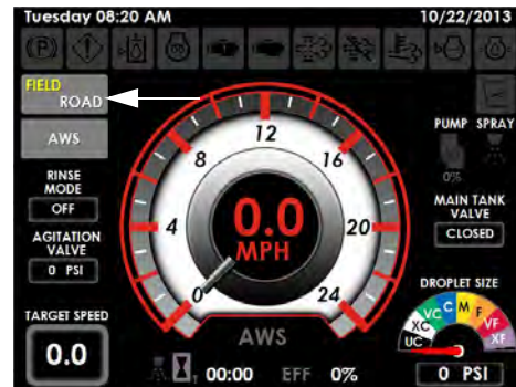
现场/道路按钮 (位于机器显示屏主页 – 道路和现场模式上)
