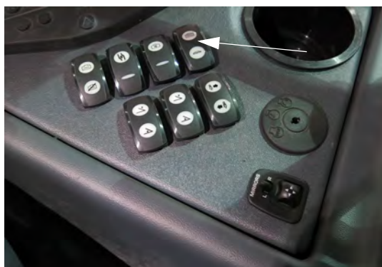
清洗开关 (位于侧控制台上) - 典型视图
