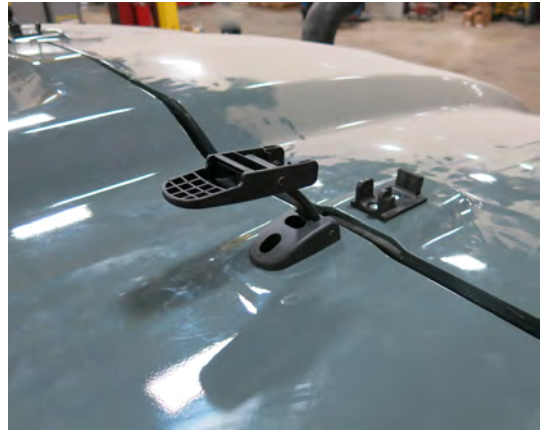
罩锁扣 (2) (位于顶罩两侧) - 典型视图
