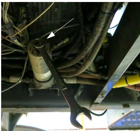
压力过滤器外壳 (位于机器右手侧 - 降低 金属护板可以够着) - 典型视图
