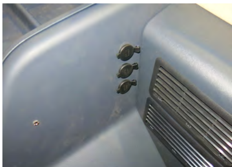
12V 电源接口 - 图示为典型安装
