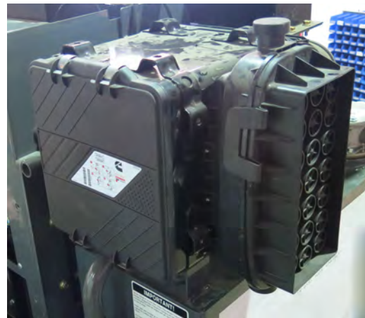
发动机进气过滤器 (位于机器左手侧通道—打开护罩后可以够着) - 典型视图
