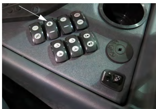
药液泵开关（位于侧控制台上） - 典型视图
