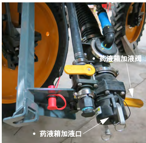
前加液口总成 (图示为降低后的位置) - 典型视图
