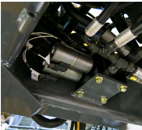
歧管阀 (位于机器的下方) - 典型视图
