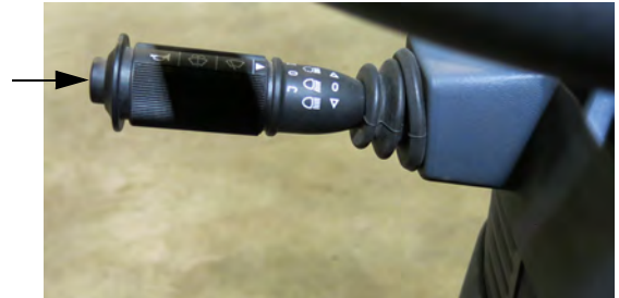
喇叭按钮 (位于转向信号操纵杆的端部) - 典型视图
