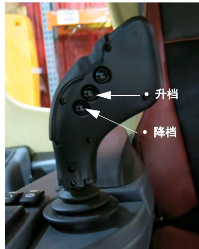
升档/降档开关 （位于静液压驱动控制柄的背侧） - 典型视图
