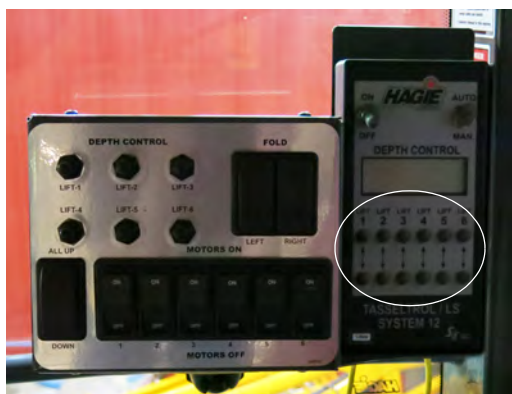
向上提升/下降开关 (位于 Tasselrol 控制面板) - 典型视图
