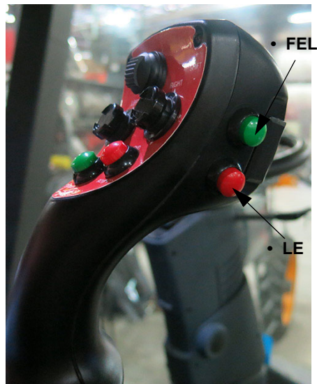
Felemelés/lesüllyesztés kapcsolók (a hidrosztatikus vezérlést irányító kar oldalán helyezkedik el) – Tipikus nézet
