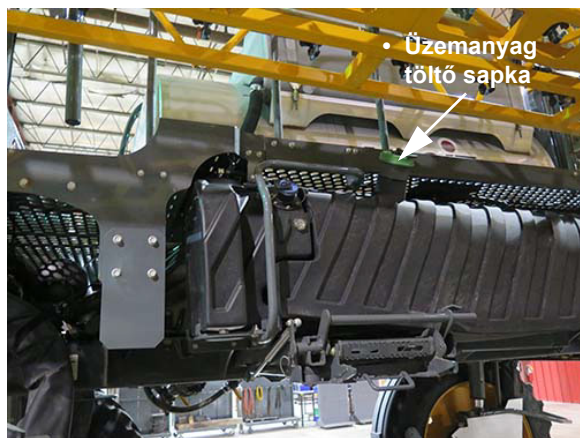
Motorolaj töltés (a gép jobb oldalán, az üzemanyag tartály tetején) – Tipikus nézet
