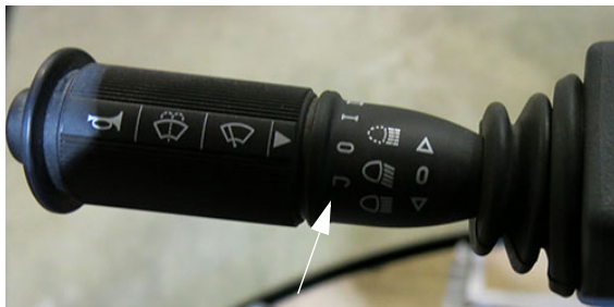
Ablaktörlő sebesség (az irányjelző kapcsolón) – Tipikus nézet
