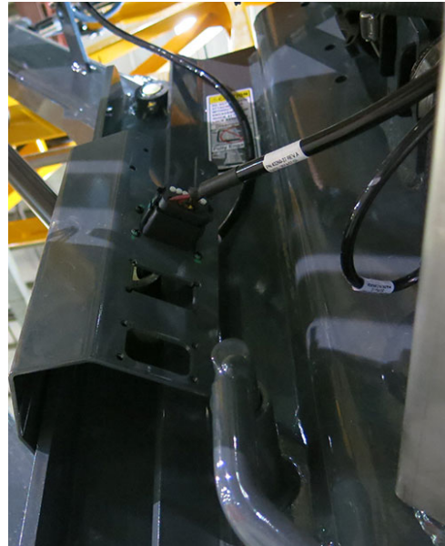
NORAC csatlakozás (a gép elülső bal és jobb oldalán található) – Tipikus nézet
