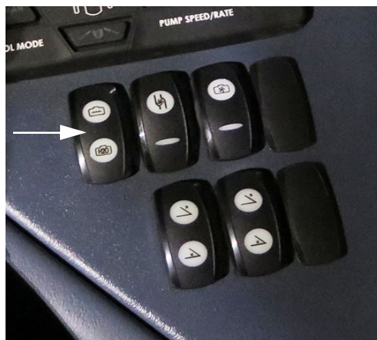
Tartály szelep választó kapcsoló (oldalkonzolon) – Tipikus nézet
