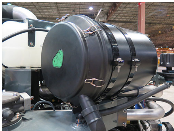
Motor levegőszűrő - STS14/STS16 (a munkagép bal hátsó található - a hozzáféréshez nyissa ki a motorháztetőt) – Tipikus nézet
