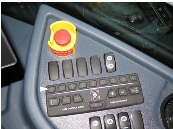
Gémpertlé szelep kapcsolók (oldalsó vezérlőpulton) – Tipikus nézet
