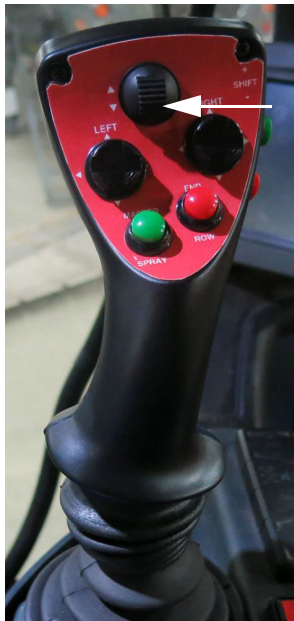
Támasztómű kapcsoló - LE (a hidrosztatikus vezérlést irányító karon) – Tipikus nézet
