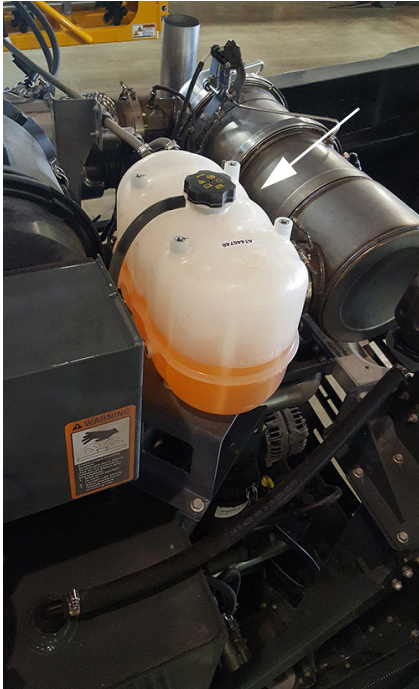
Kiegyenlítő tartály - STS10/STS12 (a gép hátulja mellett - a motorháztető kinyitásával férhet hozzá) - Tipikus nézet
