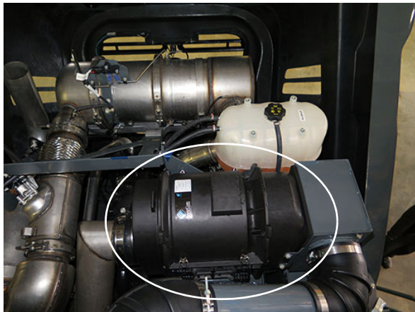
Motor levegőszűrő - STS10/STS12 (a munkagép bal hátsó található - a hozzáféréshez nyissa ki a motorháztetőt) – Tipikus nézet
