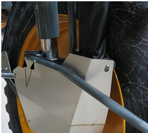
Terményterelő rögzítőcsavarok (2) – Tipikus nézet
