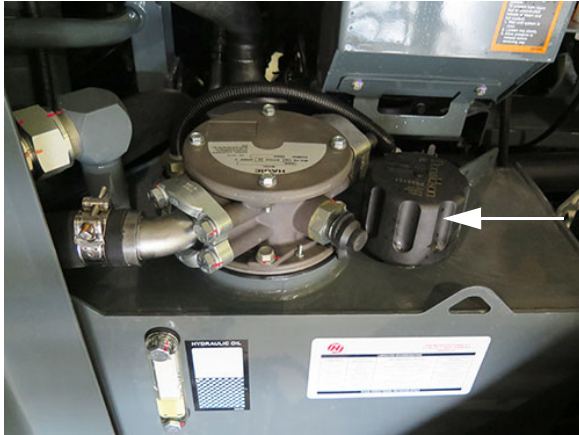
Légzősapka - STS10/STS12 (a hidraulika olaj tartály tetején helyezkedik el) – Tipikus nézet
