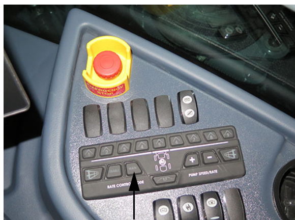
Kézi „KÉZI” arány szabályozó kapcsoló (oldalsó vezérlőpulton) – Tipikus nézet
