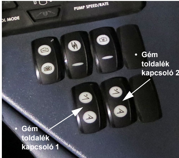
Gém toldalék kapcsolók - Bal/jobbr (oldalsó vezérlőpulton) – Tipikus nézet
