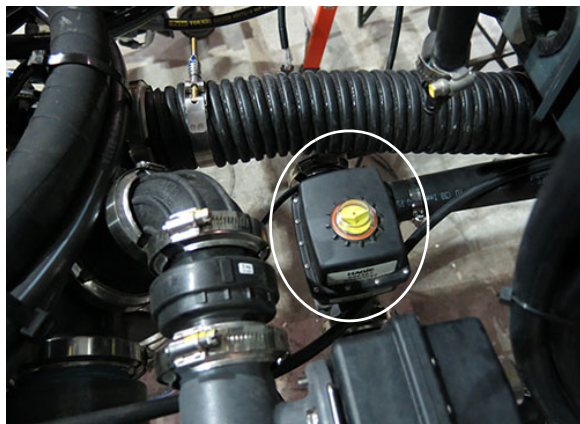
Keverőszelep (közel a gépezet közepéhez) – Tipikus nézet
