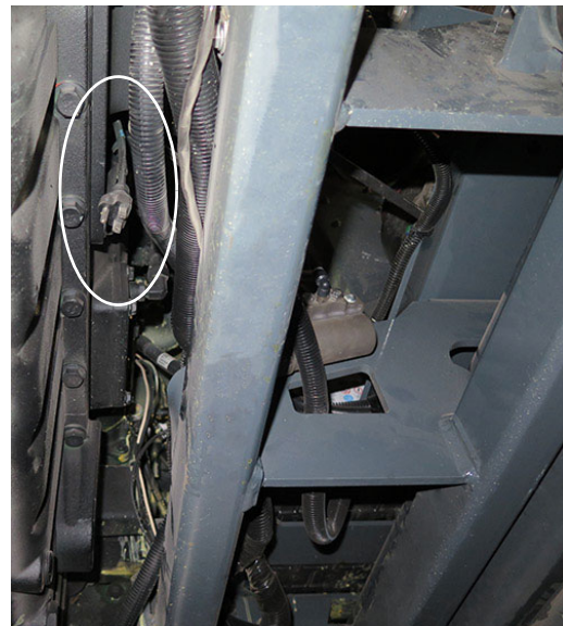
Motormelegítő tápkábel - STS14/STS16 (A munkagép alatt a motor jobb oldalánál található) – Tipikus nézet
