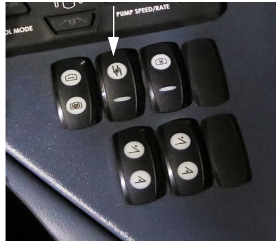
Tartály szivattyú kapcsoló (az oldalkonzolon) – Tipikus nézet
