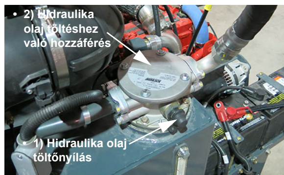
Hidraulika olaj töltés opciók – Tipikus nézet
