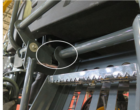
A létra kapcsolódik a sínütközőhöz (a létra bal oldala látható) – Tipikus nézet
