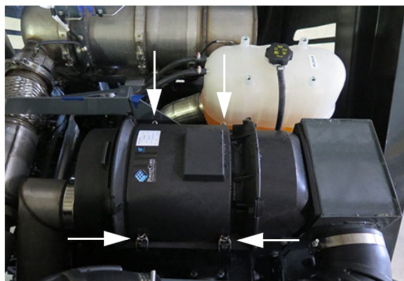
Biztonsági kapcsok (4) - STS10/STS12 (a szűrőház két oldalán található) – Tipikus nézet
