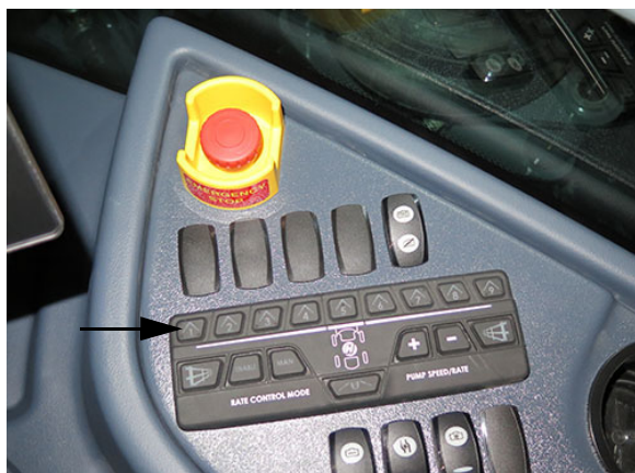
Gémpertmetlé szivattyú kapcsolók (oldalkonzolon) – Tipikus nézet
