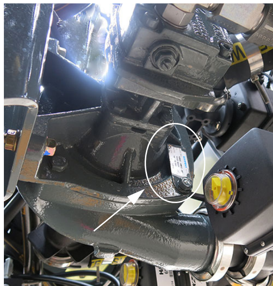
Permetlé szivattyú adattábla * A berendezés alulnézete – Tipikus nézet
