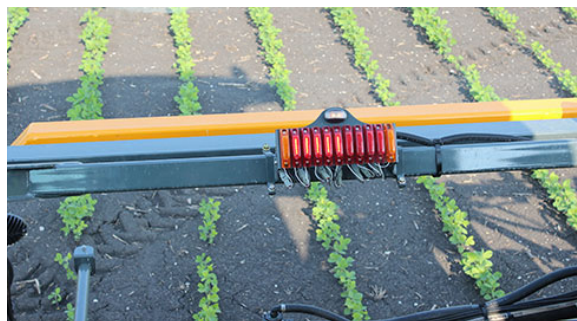
Gémpertlé szelep jelzőfények (a támasztóművön található) – Tipikus nézet
