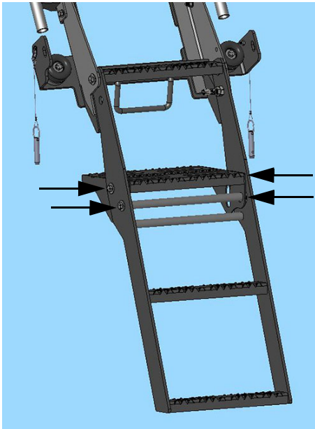
Alsó létra forgáspontok - platform (4) – Tipikus nézet
