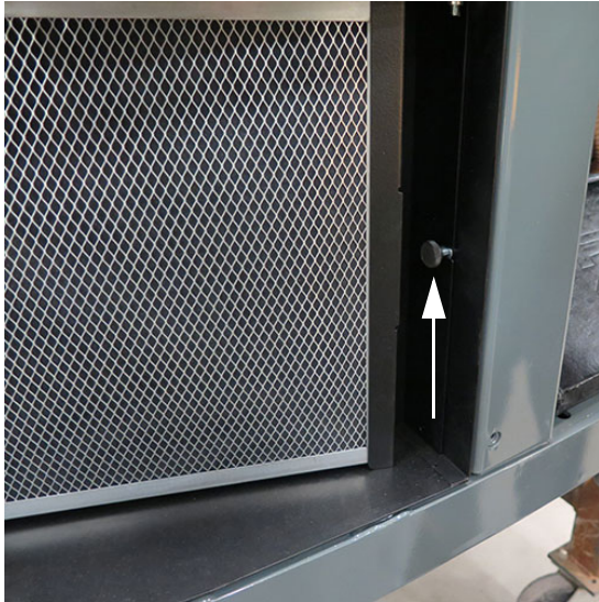
Szerelő csavar (A szűrő rekesz belsejében helyezkedik el) – Tipikus nézet
