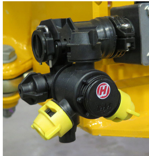
Fúvóka egység (a gém mentén helyezkedik el) – Tipikus nézet
