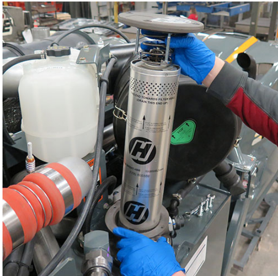
Visszatérő vezeték szűrő (a szűrőházon belül, a hidraulikaolaj tartály tetején található) – Tipikus nézet
