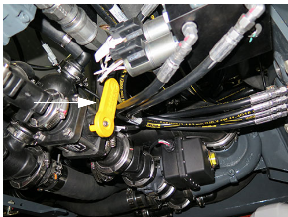
Keverés elzáró szelep (a gép hátuljának alja alatt) – Tipikus nézet
