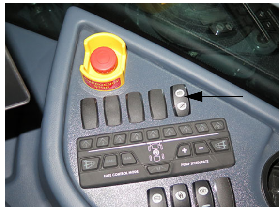
Tartály öblítés kapcsoló (oldalsó vezérlőpult) – Tipikus nézet
