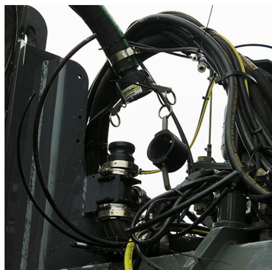
Permetezőszer vezeték csatlakoztatása - Alapfelszereltség (a gép elülső jobb oldalánál helyezkedik el) – Tipikus nézet
