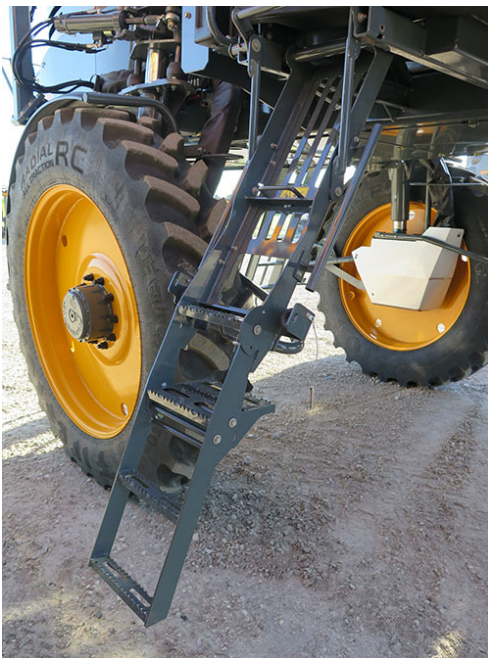
Üzemanyagtöltő létra (leengedett állapotot mutatja) – Tipikus nézet
