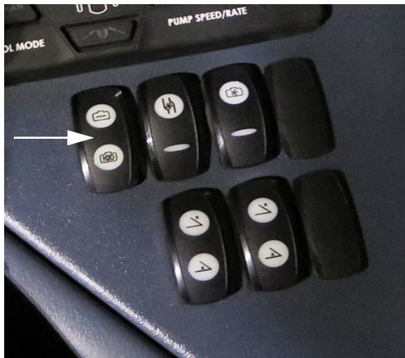
Tartály szelep választó kapcsoló (oldalsó vezérlőpulton) – Tipikus nézet
