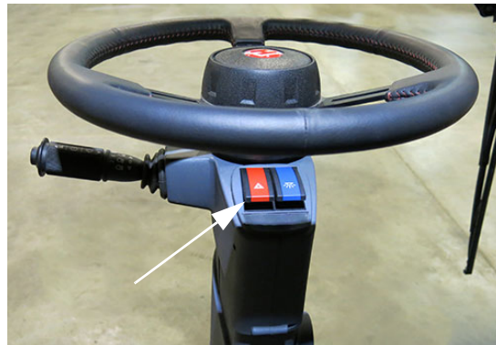
Vészjelző/figyelmeztető fények kapcsoló (a kormányoszlopon) – Tipikus nézet
