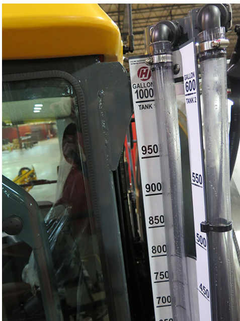
Kettős permetlé tartály oszlopos folyadékszintmérő (a vezetőfülke mögött bal kéz felől) – Tipikus nézet
