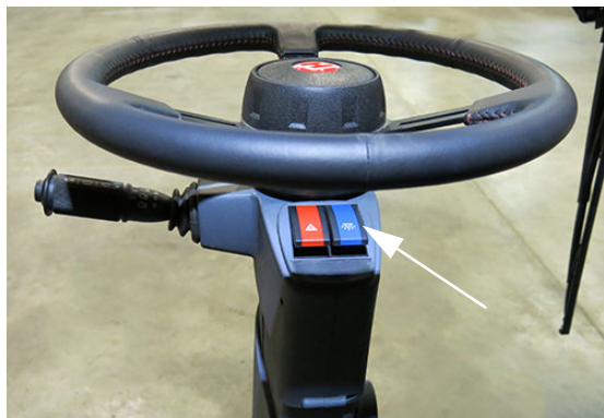
Közúti fényszórók kapcsoló (a kormányoszlopon) – Tipikus nézet
