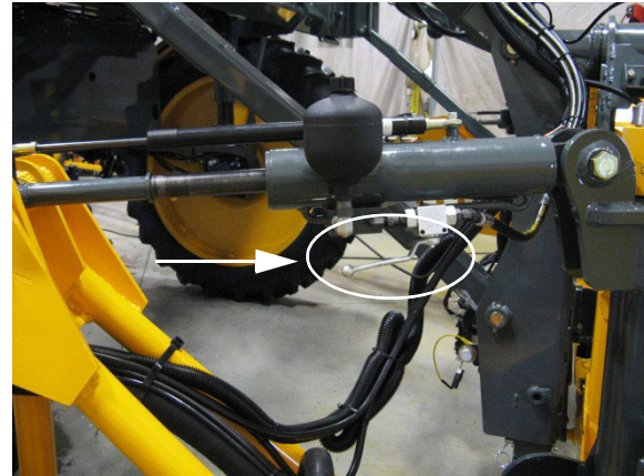
Szintező munkahenger zárószelepe (2) - 90/100' gép
