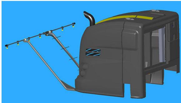
10. A hátsó permetezőgém üzemkész.
