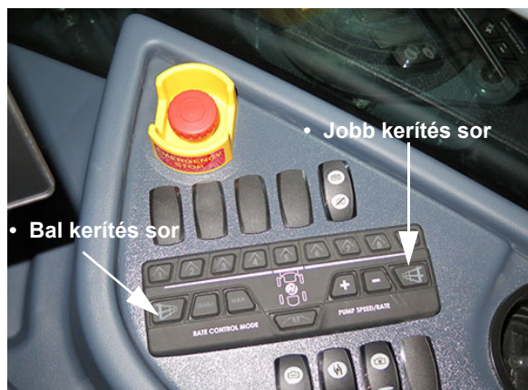
Kerítéssor kapcsolók - Bal/jobbsor (oldalsó vezérlőpulton) – Tipikus nézet
