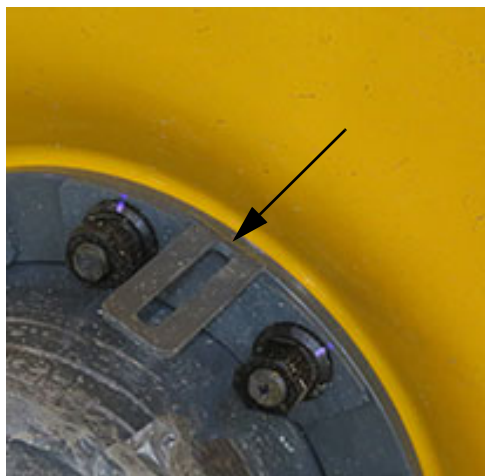
Kerékagy lemezsapkát rögzítő szerelvénylemez – Tipikus nézet
