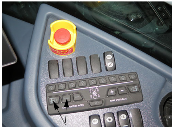
Mérték szabályzó kapcsolók (oldalsó vezérlőpulton) – Tipikus nézet
