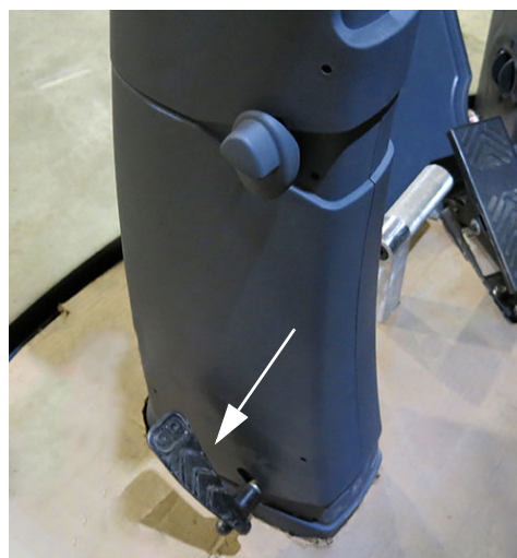
Kormányoszlop kioldó pedál (a kormányoszlop baloldalán alul) – Tipikus nézet
