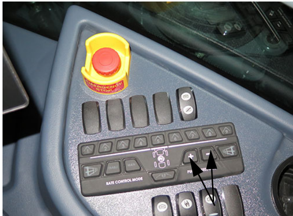
Szivattyú sebesség/Árány kapcsolók (oldalsó vezérlőpulton) – Tipikus nézet
