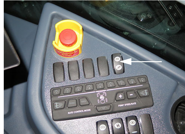
Tartály öblítés kapcsoló (oldalsó vezérlőpulton) – Tipikus nézet
