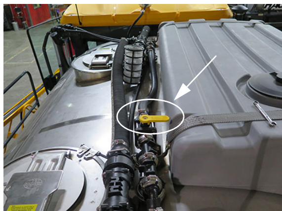
Kettős permetlé öblítő szelep (a permetlé tartály tetején) – Tipikus nézet
