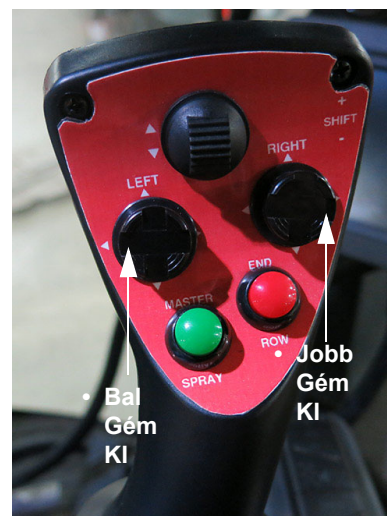
Bal és Jobb gép kapcsolók (a hidrosztatikus vezérlés irányító karon) - Tipikus nézet
