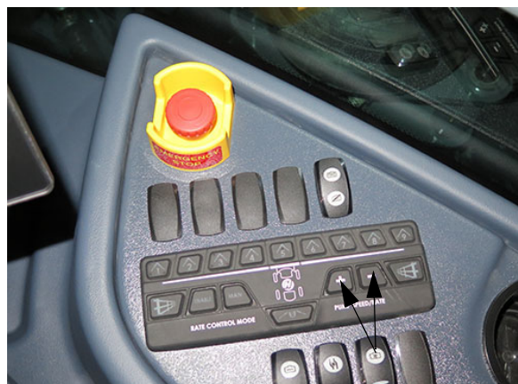
Szivattyú sebesség/arány kapcsolók (a vezérlőpult oldalán helyezkedik el) – Tipikus nézet
