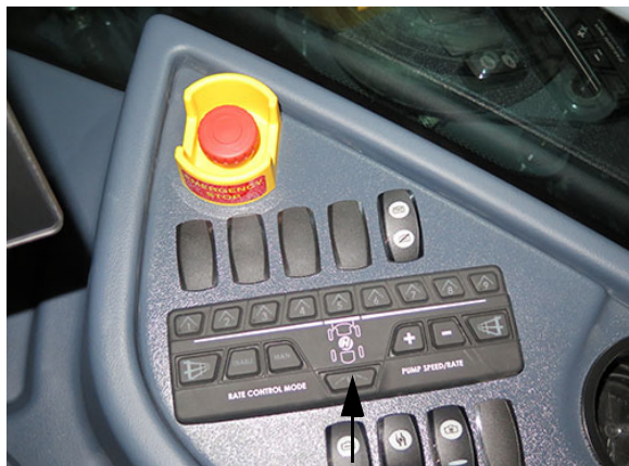
Hátsó fúvóka kapcsoló (oldalsó vezérlőpulton) – Tipikus nézet
