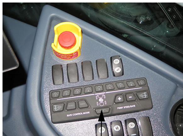
Hátsó fúvóka kapcsolója (oldalsó vezérlőpulton) – Tipikus nézet
