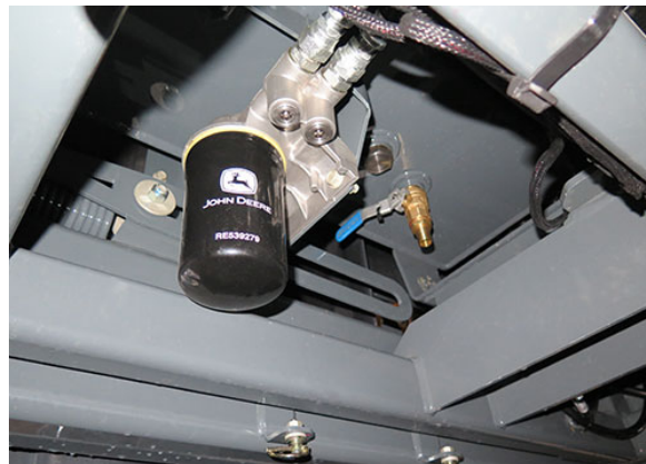
Motorolajsűrő (a munkagép bal hátsó részén, a hidraulikaolaj tartály alatt található) – Tipikus nézet
