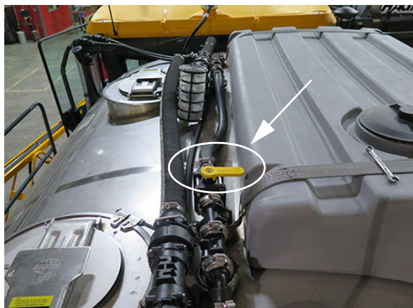
Kettős permetlé öblítő szelep (a permetlé tartály tetején) – Tipikus nézet * A kettős permetlé öblítő szelep ZÁR helyzetben látható
