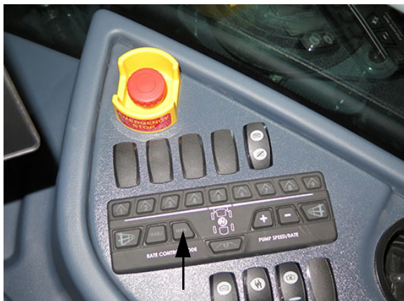
Kézi „MAN” arány szabályozó kapcsoló (az oldalkonzolon) – Tipikus nézet
