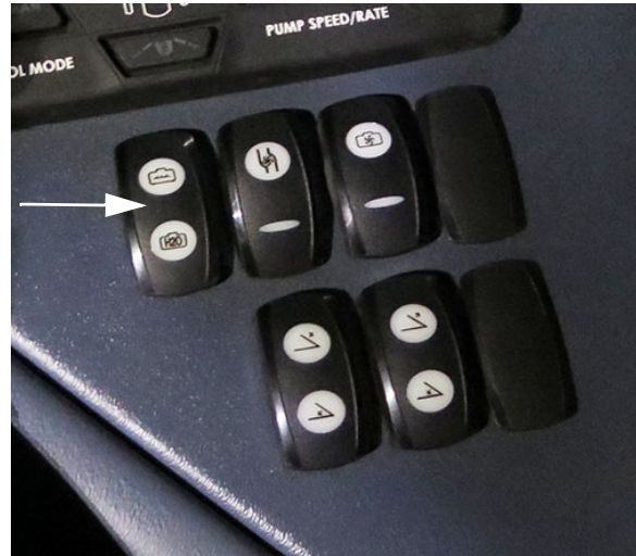
Tartály szelepválasztó kapcsoló (oldalsó vezérlőpulton) – Tipikus nézet
