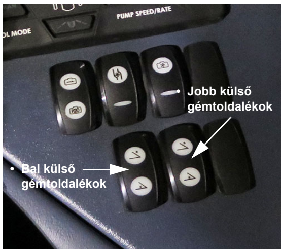
Gém toldalék kapcsolók - Bal/Jobb (oldalkonzolon) - Tipikus nézet
