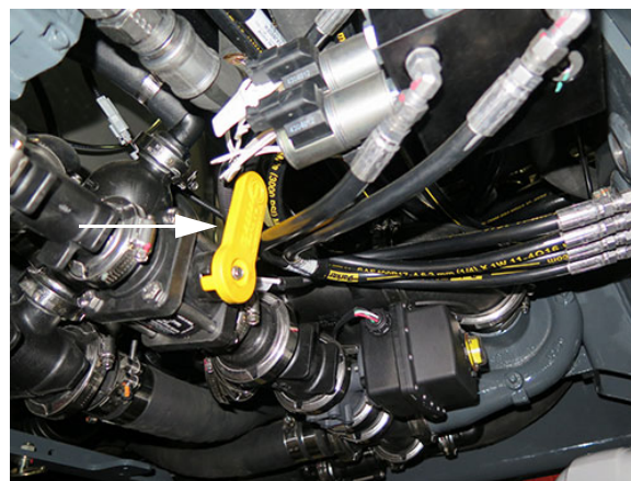
Keverés elzáró szelep (a gép hátuljának alja alatt) – Tipikus nézet
