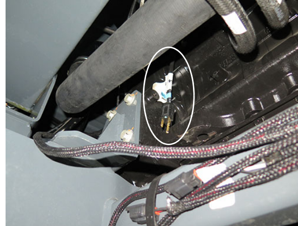
Motorblokk melegítő tápkábel - STS10/STS12 (a munkagép bal oldalán, a motor alatt található) – Tipikus nézet
