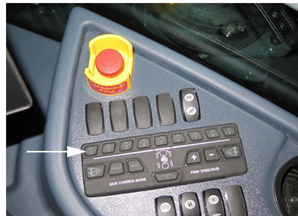
Gém permetlé szelep kapcsolók (oldalsó vezérlőpulton) – Tipikus nézet
