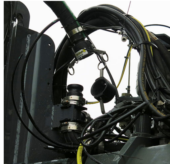
Permetezőszert vezeték csatlakoztatása - Alapfelszereltség (a gép elülső jobb oldalánál helyezkedik el) – Tipikus nézet
