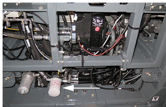
2. ház leeresztő szűrő (a munkagép bal oldalán, a motorház előtt található) – Tipikus nézet
