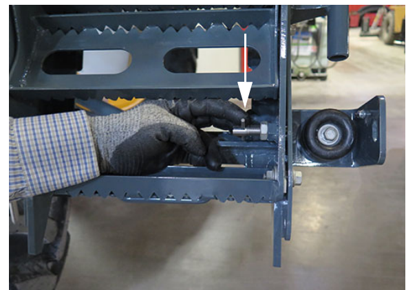
Biztosítócsap (a behajtott létra szerelvény jobb alsó részén található) – Tipikus nézet
