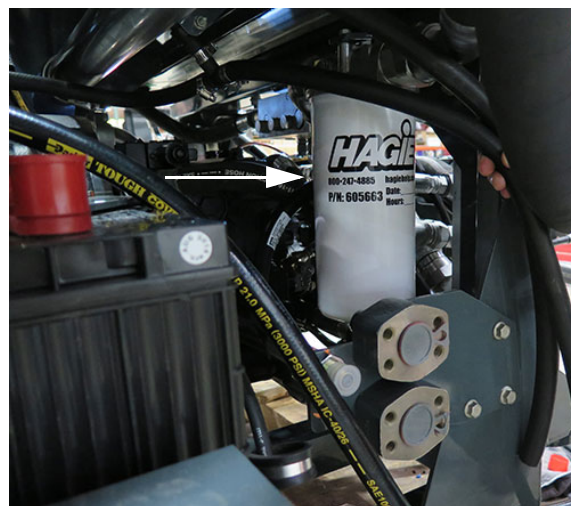
1. ház leeresztő szűrő (a munkagép jobb oldalán, az akkumulátorok közelében található) – Tipikus nézet
