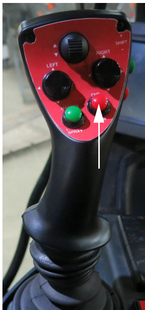
Sorvég kezelés kapcsoló (a hidrosztatikus vezérlést irányító karon)
