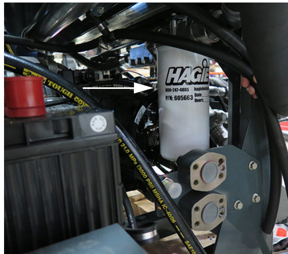
Filtru de golire a carcasei 1 (amplasat pe partea dreaptă a utilajului lângă baterii) - Vedere tipică
