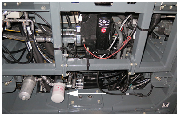
Filtru de golire a carcasei 2 (amplasat pe partea stângă a utilajului în fața cadrului motorului) - Vedere tipică
