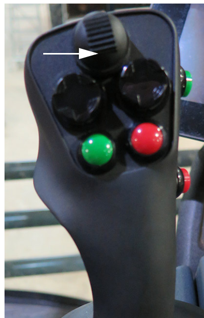
Comutator traversă - JOS (pe maneta de comandă a transmisiei hidrostatice) - Vedere tipică
