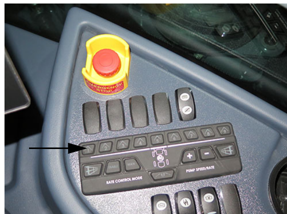
Comutatoare supape de soluție de pe brațe Tastatură secțiune produs simplu, Secțiunile 1-9 (pe consola laterală) - Vedere tipică
