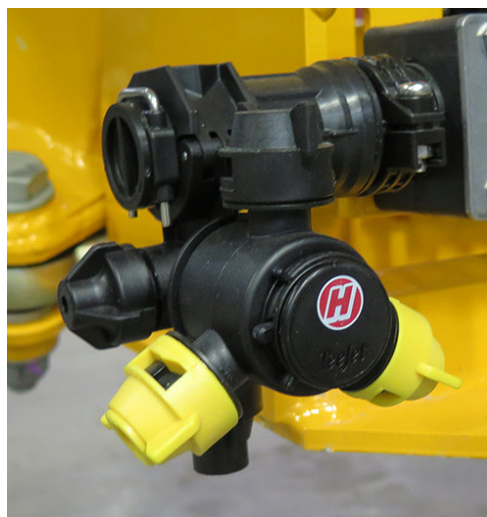
Corp duză (amplasat în braț) - Vedere tipică
