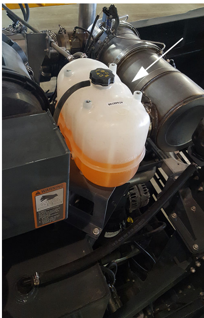
Rezervor de descărcare - STS10/STS12 (amplasat lângă partea stângă a utilajului - deschideți capota pentru acces) - Vedere tipică
