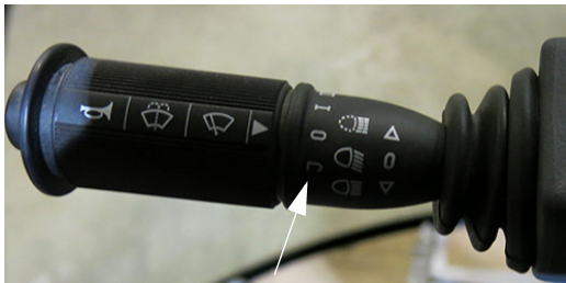
Viteze ștergător parbriz (pe maneta de semnalizare) - Vedere tipică
