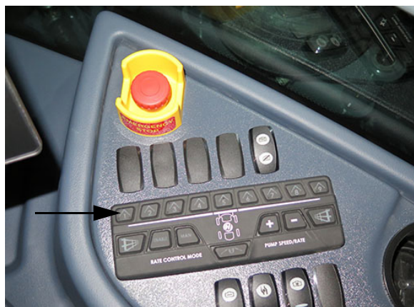
Comutatoare supape de soluție de pe brațe - Tastatură secțiune produs simplu, Secțiunile 1-9 (amplasată pe consola laterală) - Vedere tipică * Utilizat cu braț umed cu 9 secțiuni
