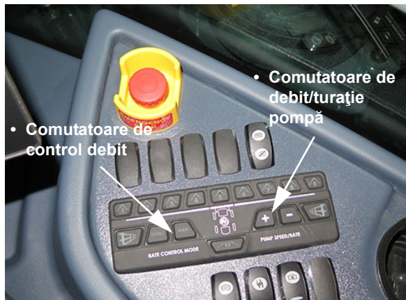
Comutatoare de control debit și Comutatoare de debit/turație pompă (pe consola laterală) - Vedere tipică
