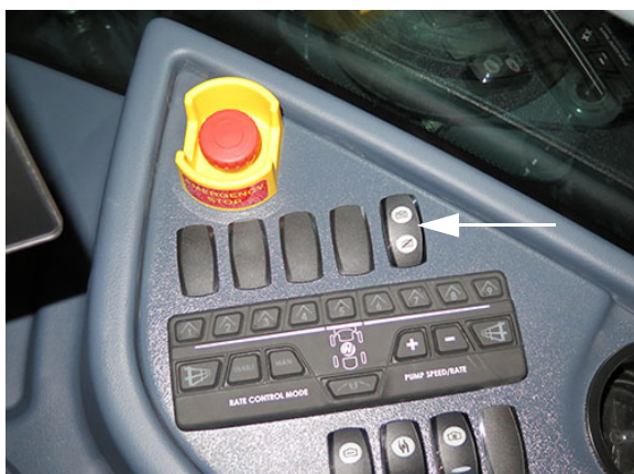
Comutator clătire rezervoare (pe consola laterală) - Vedere tipică
