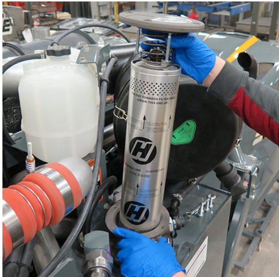
Filtru de retur (în carcasa filtrului, pe partea stângă a utilajului) - Vedere tipică
