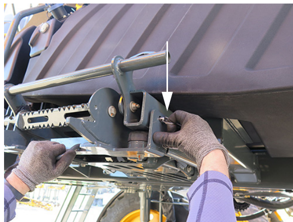
Știfturi de blocare (2) (amplasate pe fiecare parte laterală a ansamblului scării) - Vedere tipică
