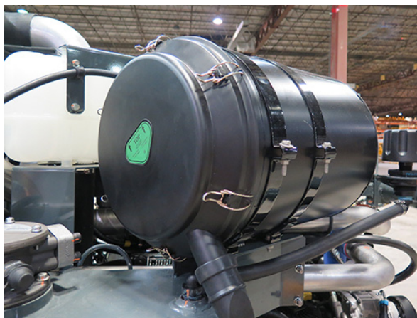
Filtrul de aer de admisie al motorului - STS14/STS16 (amplasat pe partea stânga spate a utilajului - deschideți capota pentru acces) - Vedere tipică
