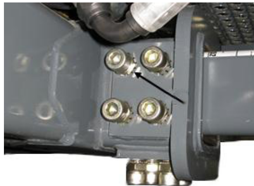
Piuliță de blocare (pe fiecare șurub al suportului pentru reglarea benzii de rulare) - Vedere tipică
