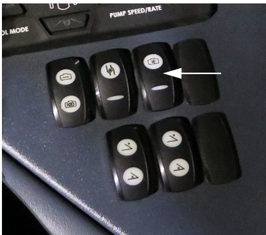
Comutator supapă de agitare (amplasat pe consola laterală) - Vedere tipică
