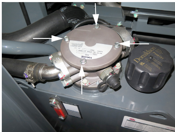
Filtrului de retur hidraulic (pe partea stângă a utilajului - lângă rezervorul de ulei hidraulic) - Vedere tipică
