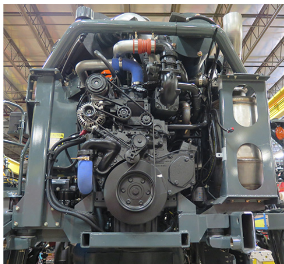
Motor diesel final de Nivelul 4 (PSS 9,0 l) - STS14/STS16 (amplasat în apropierea părții din spate a utilajului - deschideți capota pentru acces) - Vedere tipică
