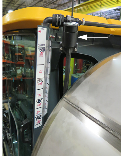
Rezervorul pentru lichid de spălare a parbrizului (amplasat în spatele părții din stânga a cabinei) - Vedere tipică
