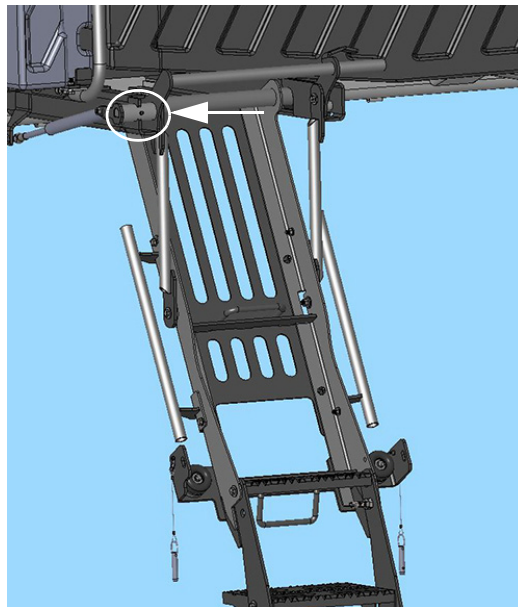
Gresor punte pneumatică (amplasat lângă partea stânga sus a scării) - Vedere tipică
