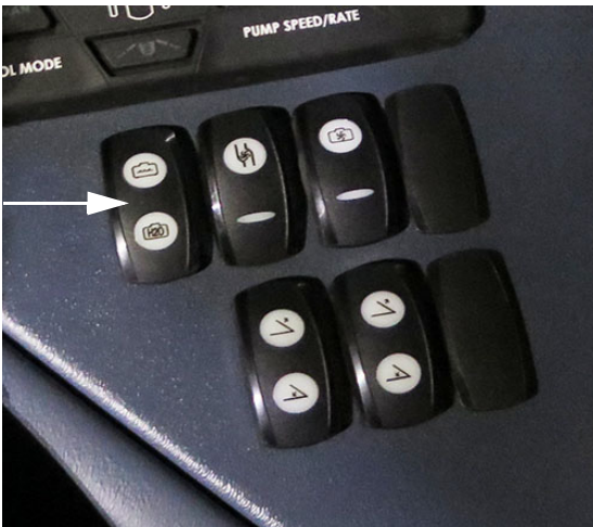
Comutator selector supapă rezervor (pe consola laterală) - Vedere tipică
