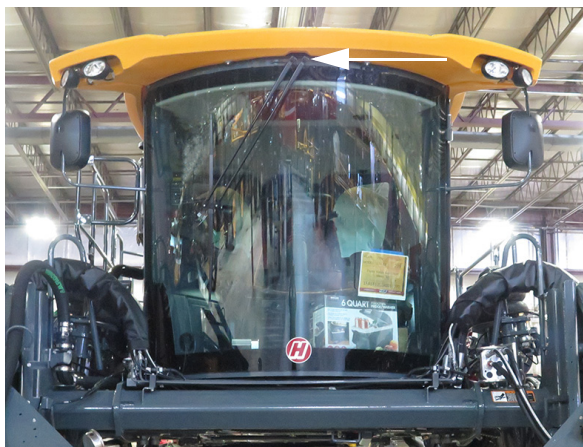
Duza de pulverizare a lichidului spălător de parbriz (lângă partea superioară a cabinei exterioare) - Vedere tipică
