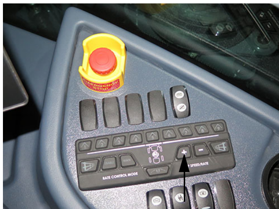
Comutator de debit/turație pompă „+” (amplasată pe consola laterală) - Vedere tipică
