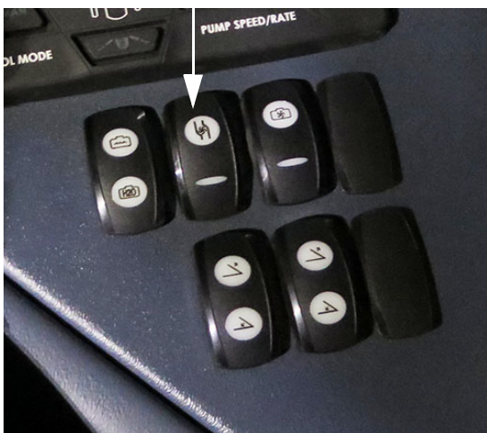
Comutator pompă de soluție (amplasat pe consola laterală) - Vedere tipică
