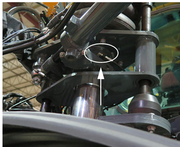
Gresor Zerk colier (4) (sub fiecare placă de montaj a pernei de aer) - Vedere tipică
