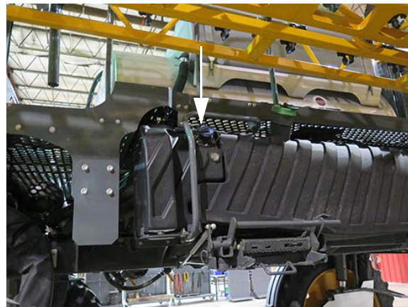
Capac de umplere cu DEF (amplasat pe partea din față a rezervorului DEF) - Vedere tipică
