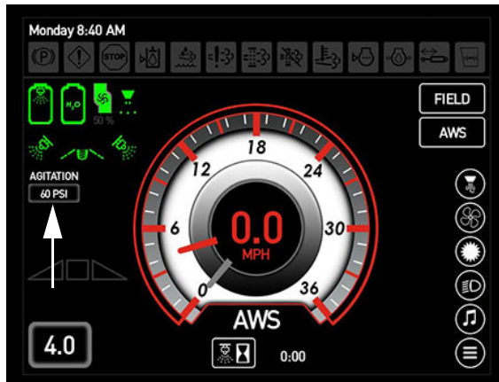
Indicator de presiune a supapei de agitare (pe afișajul utilajului, Pagina inițială - modul Drum și Câmp)
