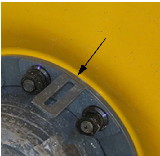
Placă adaptor capac butuc - Vedere tipică
