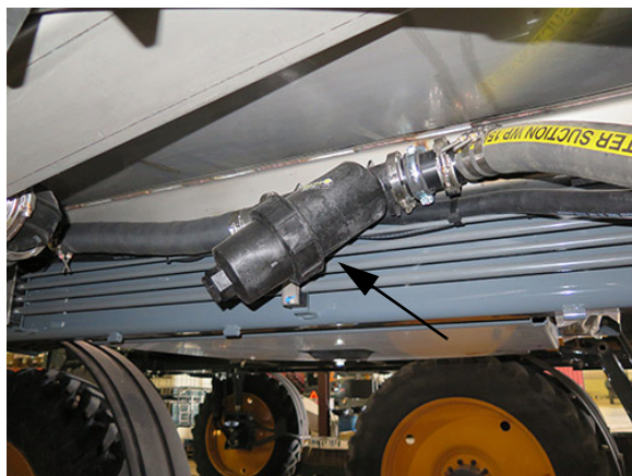
Sită linie de soluție (sub partea dreaptă a utilajului) - Vedere tipică
