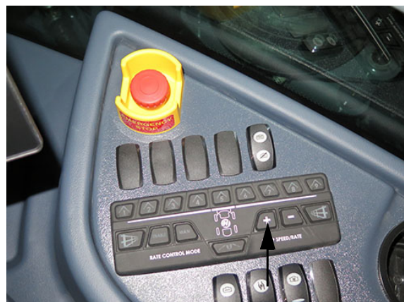
Comutator de debit/turație pompă „+” (pe consola laterală) - Vedere tipică
