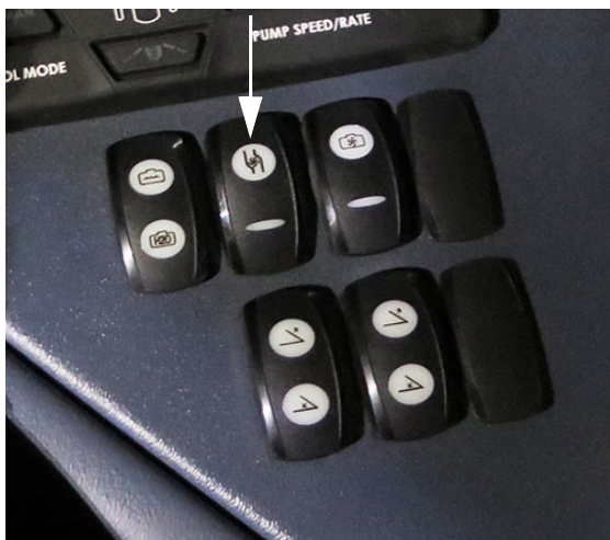
Comutator pompă de soluție (pe consola laterală) - Vedere tipică
