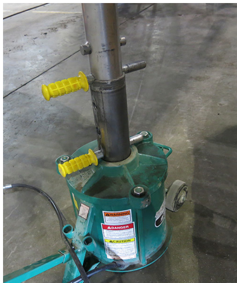
Instalare știft de blocare - Vedere tipică
