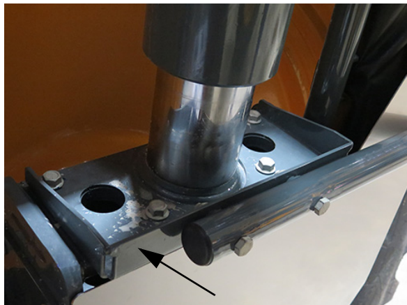
Placă de montare separator recoltă - Vedere tipică
