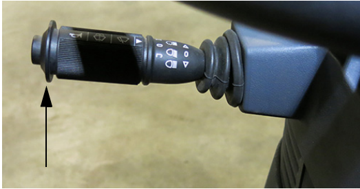
Comutator spălător parbriz (la capătul manetei de semnalizare) - Vedere tipică
