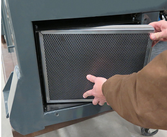
Filtru cu cărbune - Vedere tipică
