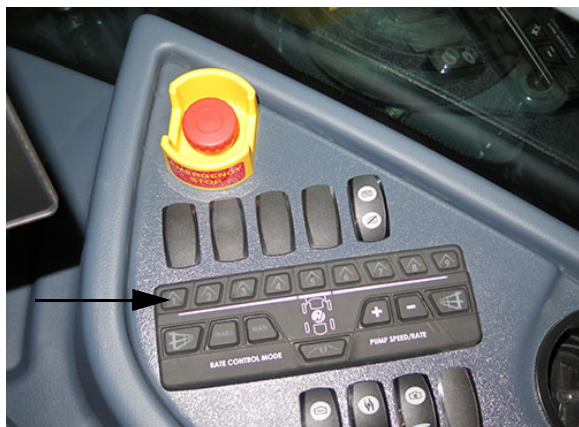
Comutatoare supape de soluție de pe brațe Tastatură secțiune produs simplu (pe consola laterală)
