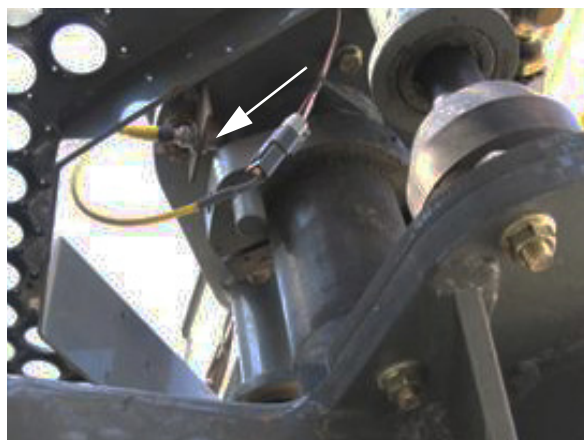
Senzor extern de proximitate - Vedere tipică
