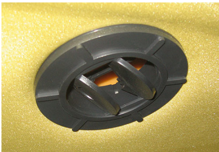
Orificiu de ventilare a cabinei - Vedere tipică
