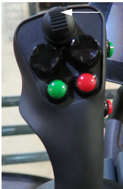
Comutator traversă - SUS (pe maneta de comandă a transmisiei hidrostactice) - Vedere tipică
