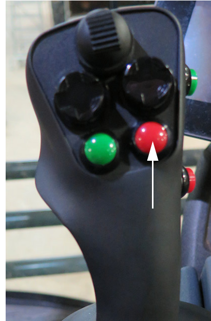
Comutator de gestionare rând final (pe maneta de comandă a transmisiei hidrostactice) - Vedere tipică
