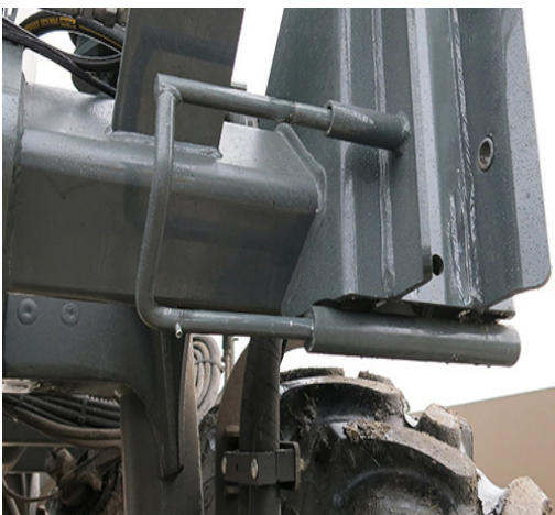
Știft de blocare (2) (pe partea din stânga și dreapta pe partea dreaptă a utilajului) - Vedere tipică * Poziție decuplată afișată
