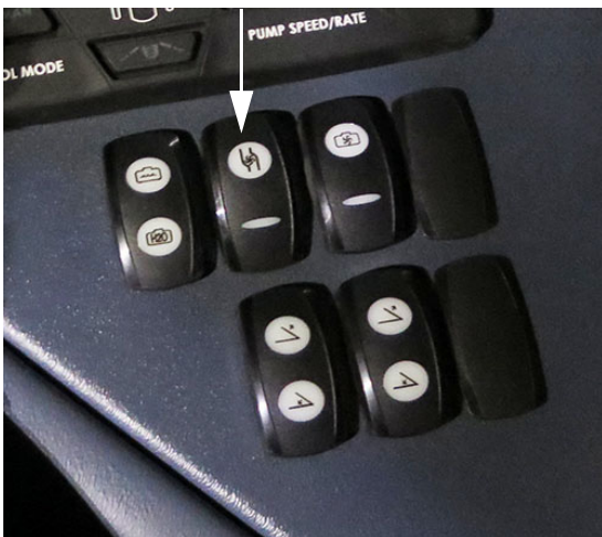
Comutator pompă de soluție - Principală (pe consola laterală) - Vedere tipică
