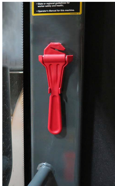
Instrument pentru ieșire de urgență (de-a lungul părții drepte a cabinei) - Vedere tipică
