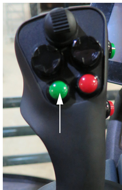
Comutator pulverizator principal (amplasat pe maneta de comandă a transmisiei hidrostactice) - Vedere tipică
