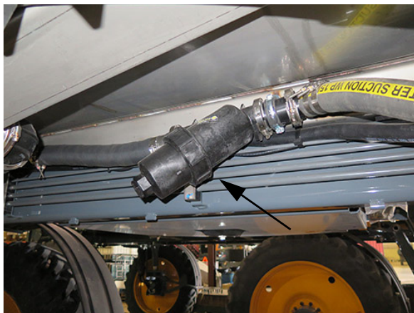
Sită linie de soluție (amplasată sub partea centrală dreapta a utilajului) - Vedere tipică
