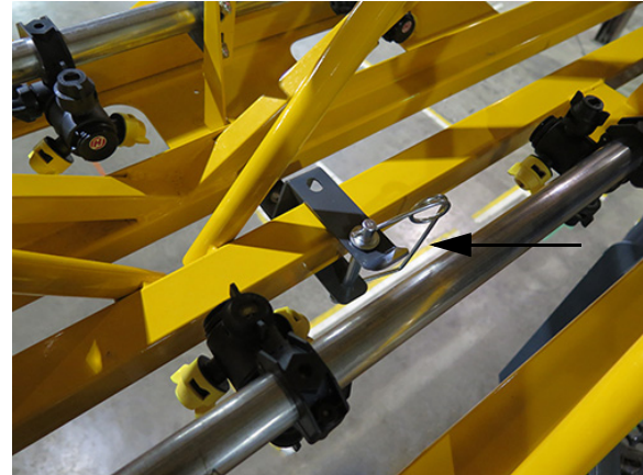
Știft de blocare pentru transport (ilustrat în poziția de „transport”) - Vedere tipică
