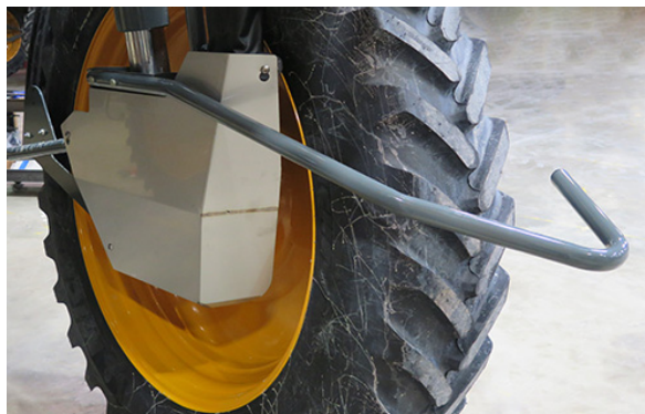
Separator de cultură instalat - Vedere tipică
