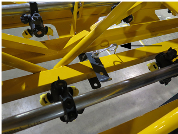
Știft de blocare pentru transport (ilustrat în poziția de „depozitare”) - Vedere tipică
