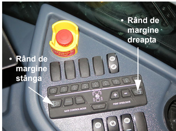
Comutatoare rânduri de margine (pe consola laterală) - Vedere tipică
