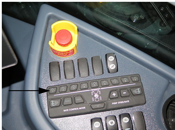
Comutatoare supape de soluție de pe brațe Tastatură secțiune produs simplu, Secțiunile 1-9
