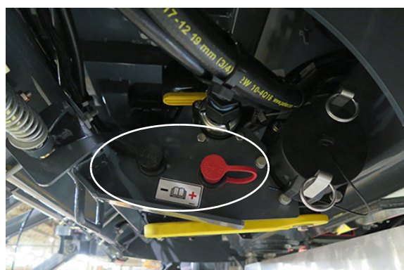
Porturi de alimentare (în apropierea ansamblului de umplere frontală) - Vedere tipică
