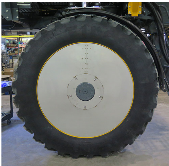
Instalare capac de roată - Vedere tipică
