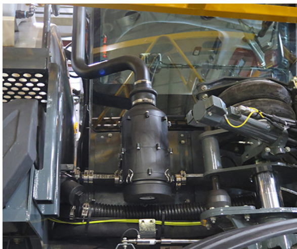
Sistem de filtrare al cabinei (amplasat pe partea dreaptă în exteriorul cabinei) - Vedere tipică
