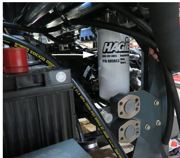
Filtru de drenare a carcasei 1 (amplasat pe partea dreaptă a utilajului lângă baterii) - Vedere tipică
