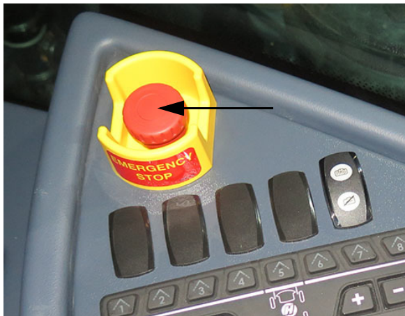
Comutator E-Stop (pe consola laterală) - Vedere tipică
