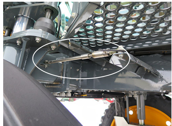
Senzor de reglare a benzii de rulare (4) (amplasat pe fiecare picior) - Vizualizare tipică
