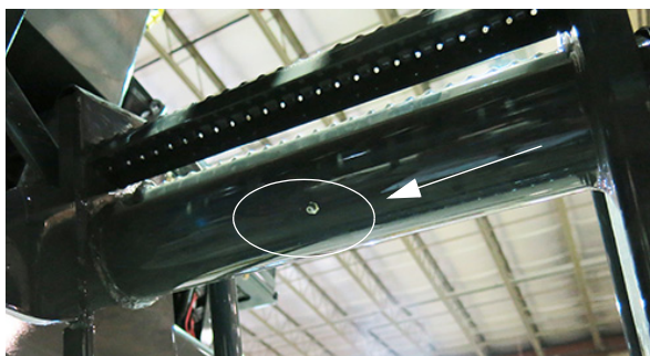
Tub pivot scară - Vedere tipică
