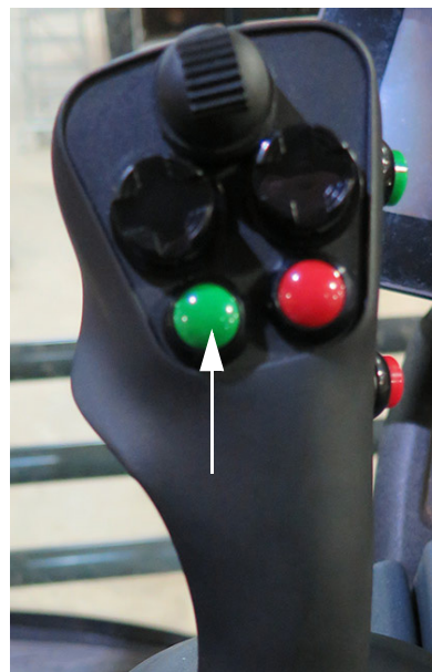
Comutator pulverizator principal (pe maneta de comandă a transmisiei hidrostatice) - Vedere tipică
