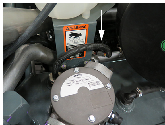
Senzor de nivel/temperatură (pe rezervorul de ulei hidraulic) - Vedere tipică
