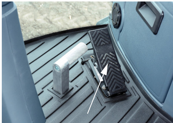
Pedală de decelerare (pe partea din dreapta jos a coloanei de direcție) - Vedere tipică
