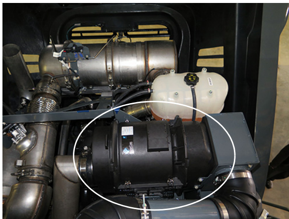
Filtrul de aer de admisie al motorului - STS10/STS12 (amplasat pe partea stânga spate a utilajului - deschideți capota pentru acces) - Vedere tipică
