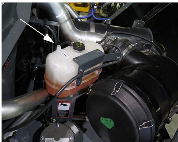
Rezervor de descărcare - STS14/STS16 (amplasat lângă partea stângă a utilajului - deschideți capota pentru acces) - Vedere tipică
