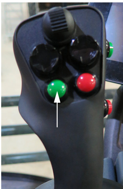
Comutator pulverizator principal (pe maneta de comandă a transmisiei hidrostactice) - Vedere tipică
