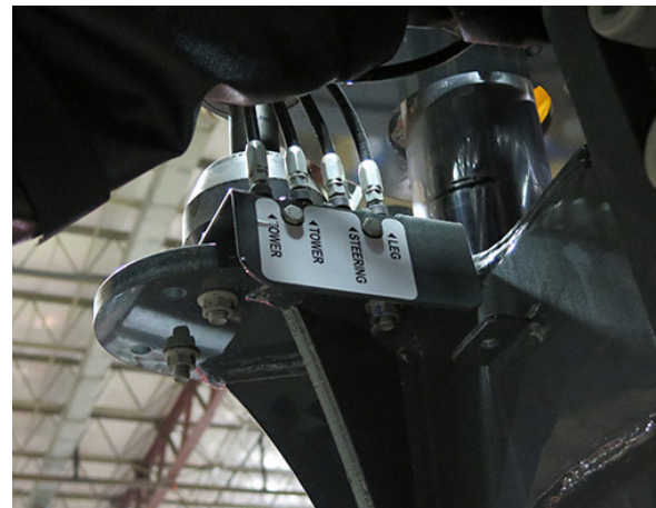
Banc de gresoare (4) (amplasat pe partea frontală a fiecărui picior) - Vedere tipică
