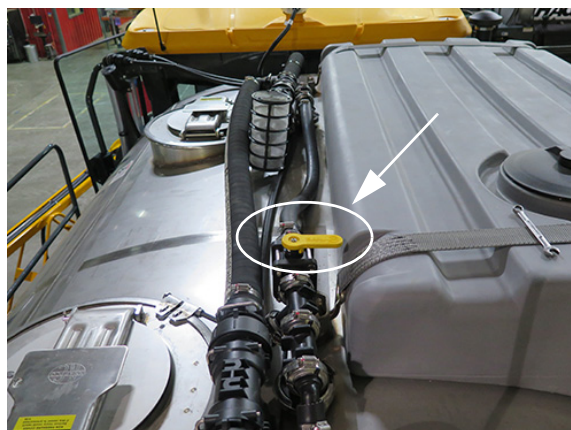
Supapă de clătire cu produs dual (amplasată pe partea superioară a rezervorului de soluție) - Vedere tipică
