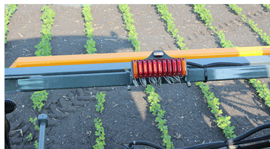
Indicatoare supape de soluție de pe brațe (amplasat pe traversă) - Vedere tipică
