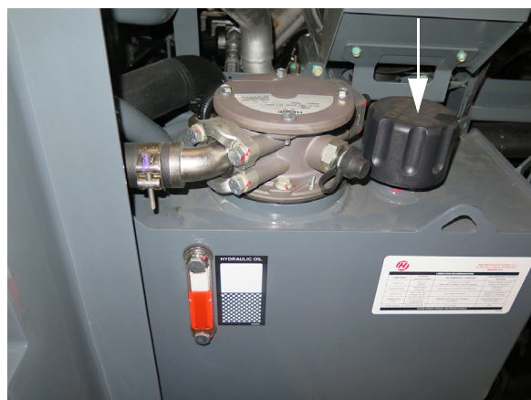
Capac supapă de aerisire - STS10/STS12 (amplasat deasupra rezervorului de ulei hidraulic) - Vedere tipică
