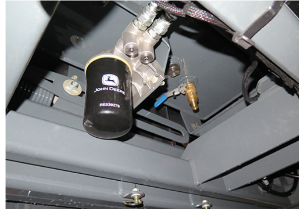
Filtru ulei de motor (amplasate pe partea stânga spate a utilajului sub rezervorul de ulei hidraulic) - Vedere tipică
