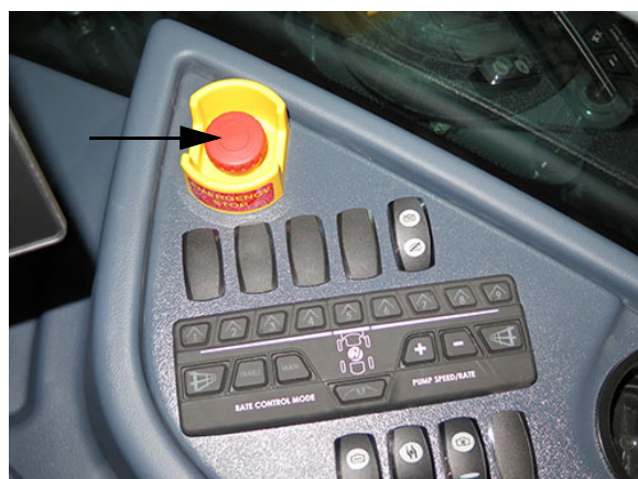
Comutator E-Stop (pe consola laterală) - Vedere tipică
