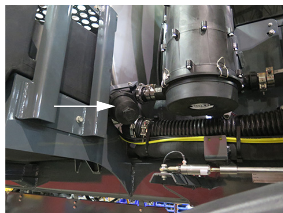
Sită linie de soluție - Secundară (amplasat lângă partea dreapta față a utilajului) - Vedere tipică
