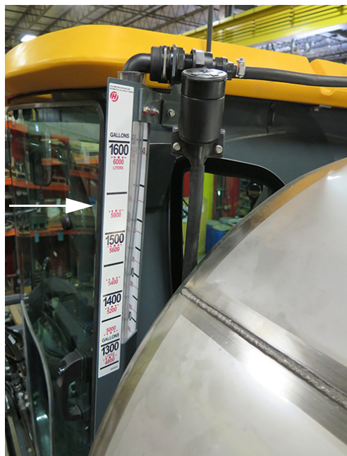
Vizor rezervor de soluție (amplasat în spatele părții din stânga spate a cabinei) - Vedere tipică
