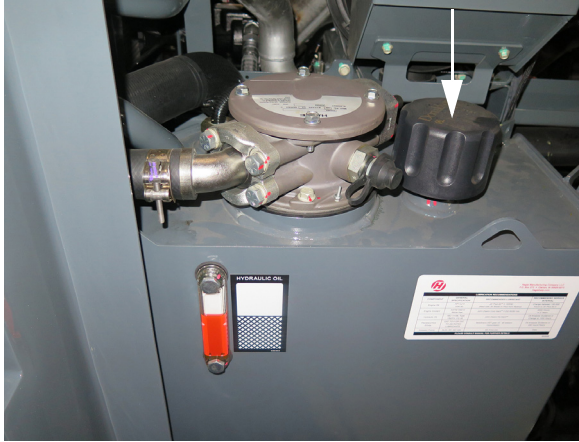
Capac supapă de aerisire - STS10/STS12 (amplasat deasupra rezervorului de ulei hidraulic) - Vedere tipică
