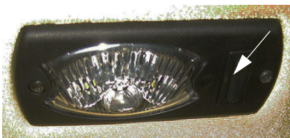
Comutator lampă interioară de lucru - Vedere tipică
