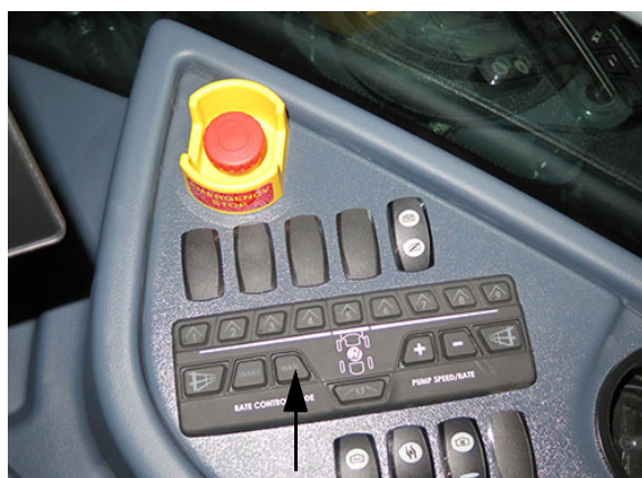
Comutatorul de control al debitului „MAN” (manual) (pe consola laterală) - Vedere tipică
