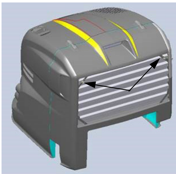
Cleme cu arc protecție radiator (2) (amplasate pe partea stânga și dreapta sus a protecției) - Vedere tipică
