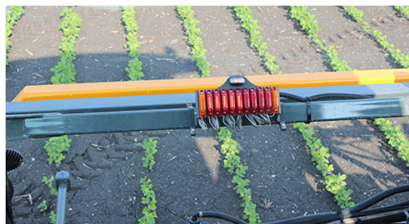
Indicatoare supape de soluție de pe brațe (amplasat pe traversă)
