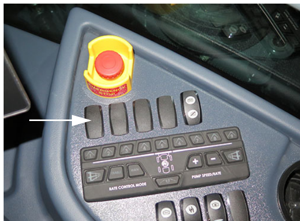
Comutator marcator cu spumă (pe consola laterală) - Vedere tipică
