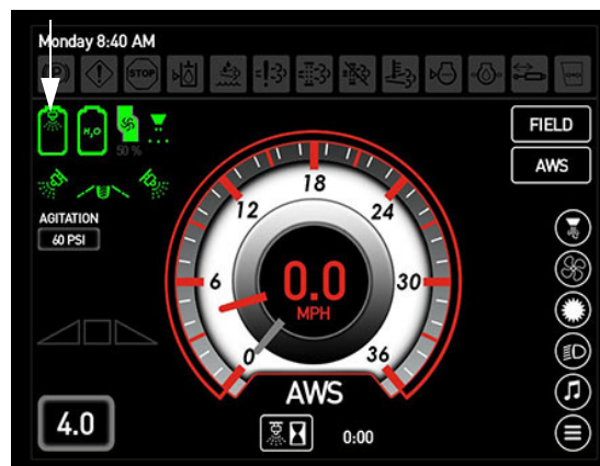
Indicator stare supapă rezervor principal (pe afișajul utilajului, Pagina inițială - modul Drum și Câmp)
