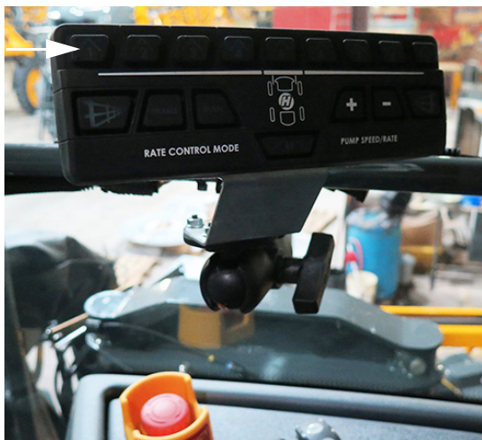
Comutatoare supape de soluție de pe brațe - Tastatură secțiune produs dual, Secțiunile 10-14
