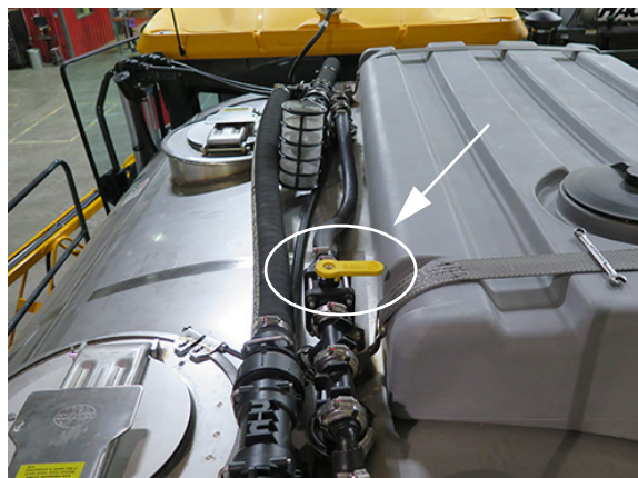
Supapă de clătire cu produs dual (amplasată pe partea superioară a rezervorului de soluție)
