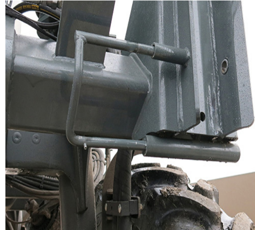
Știft de blocare (2) (pe partea din stânga și dreapta partea dreaptă a utilajului)
