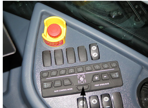
Comutator duză spate (pe consola laterală) - Vedere tipică
