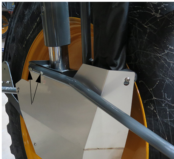
Șurub de montare separator de cultură (2) - Vedere tipică
