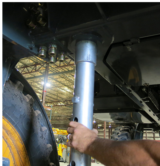
Introduceți cricul în inelul de izolare a punctului de ridicare - Vedere tipică
