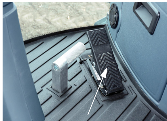
Pedală de decelerare (pe partea din dreapta jos a coloanei de direcție) - Vedere tipică
