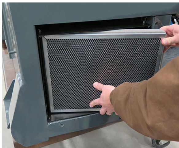
Filtru cu cărbune (amplasat în spatele panoului de service exterior pe partea dreaptă a cabinei) - Vedere tipică
