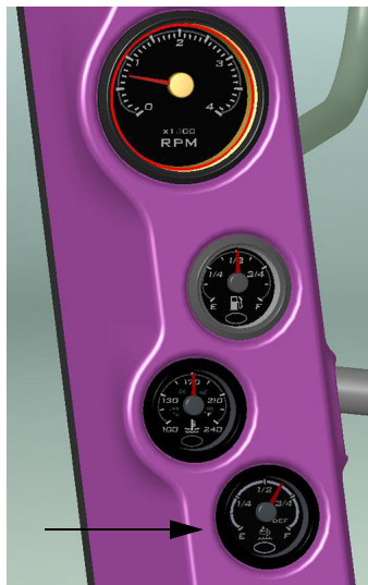
Indicator DEF (amplasate pe stâlpul parbrizului din cabină) - Vedere tipică
