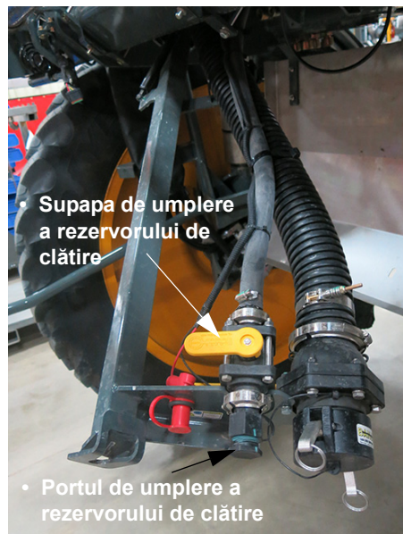
Ansamblul de umplere frontală (poziție coborâtă afișată) - Vedere tipică
