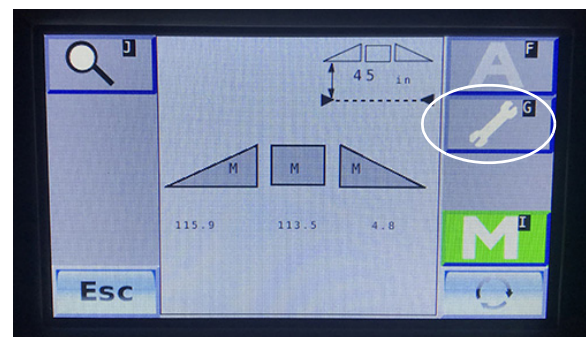
Buton Setări (amplasat pe ecranul de execuție principal de pe afișajul de precizie) - Vedere tipică
