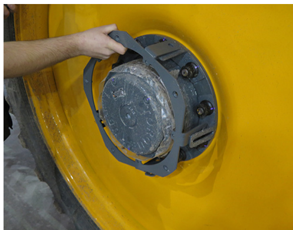
Sudură adaptor pentru capac de butuc - Vedere tipică
