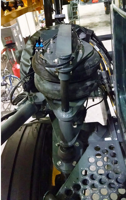
Pernă de aer (Amplasată pe fiecare picior) - Vedere tipică * Pernă de aer față ilustrată
