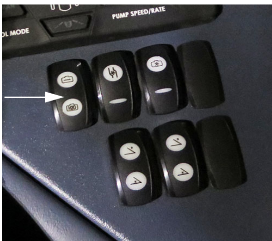
Comutator selector supapă rezervor (amplasată pe consola laterală) - Vedere tipică
