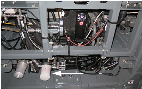
Filtru de drenare a carcasei 2 (amplasat pe partea stângă a utilajului în fața cadrului motorului) - Vedere tipică
