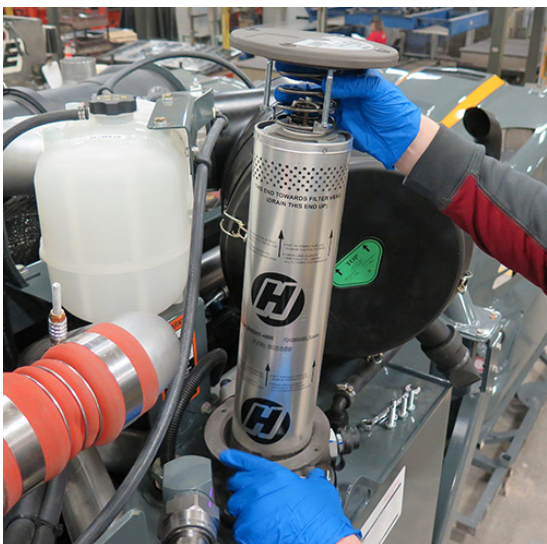
Filtru de retur (amplasat în interiorul carcasei filtrului) - Vedere tipică
