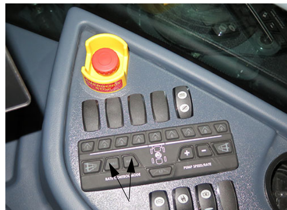
Comutatoare de control debit (pe consola laterală) - Vedere tipică
