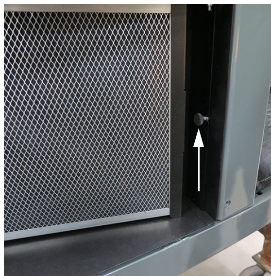
Șurub de siguranță (amplasat pe partea interioară a compartimentului filtrului) - Vedere tipică
