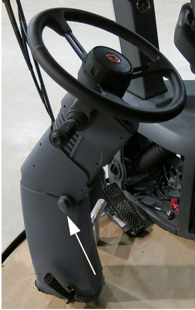
Buton de reglare a înclinării coloanei de direcție (pe partea stângă a coloanei de direcție) - Vedere tipică
