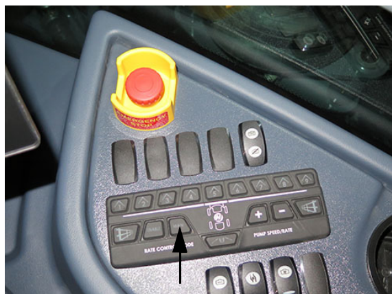
Comutator control rată „MAN” (amplasată pe consola laterală) - Vedere tipică
