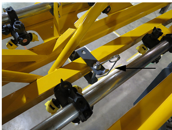
Știft de blocare pentru transport (2) (amplasat pe fiecare parte laterală a brațului - Secțiunea 2) - Vedere tipică
