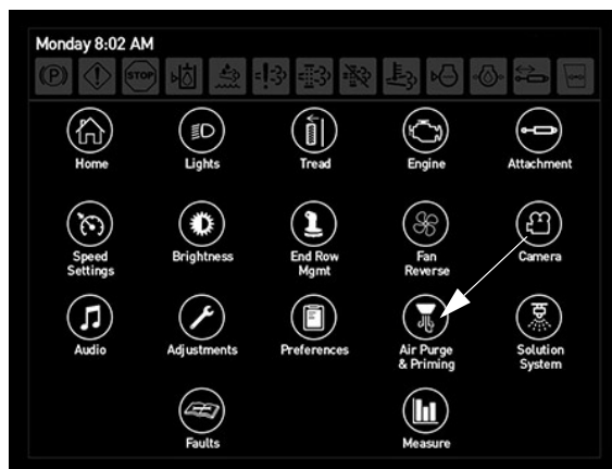
Buton Purjare aer/amorsare (amplasat pe meniul principal)
