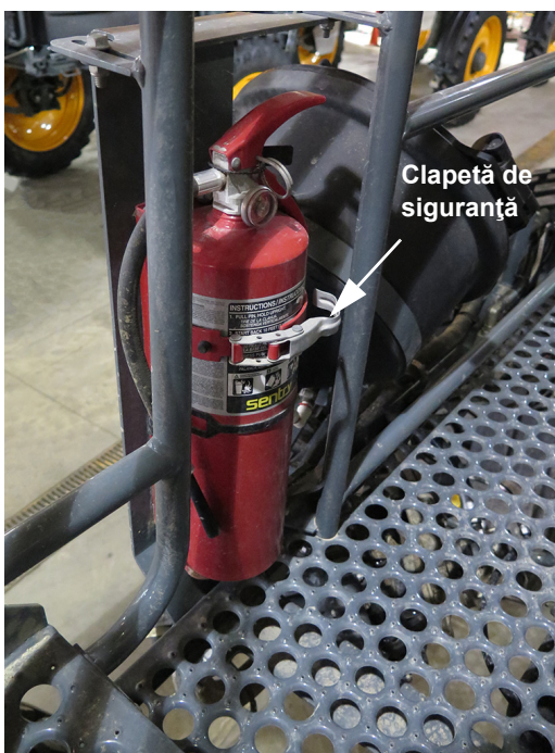
Extinctor (de-a lungul punții de acces, pe partea stângă a utilajului) - Vedere tipică
