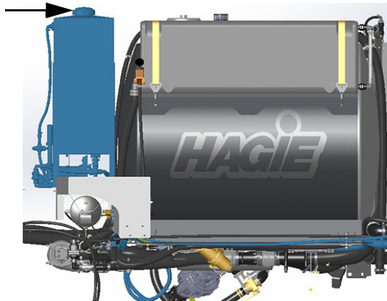
Capac gură de umplere (amplasat pe partea superioară a rezervorului de substanță chimică)
