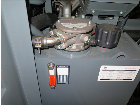
Rezervor de ulei hidraulic (pe partea stângă a utilajului - deschideți capota pentru accesare) - Vedere tipică
