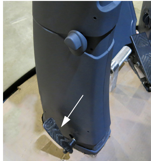
Pedală de eliberare coloană de direcție (amplasată pe partea din stânga jos a coloanei de direcție) - Vedere tipică
