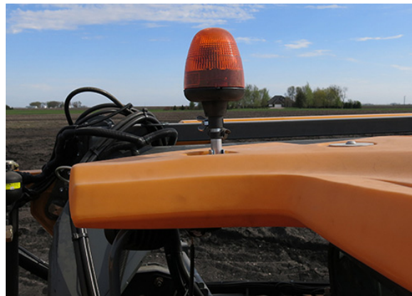
Girofar (amplasat pe capacul acoperișului față) - Vedere tipică
