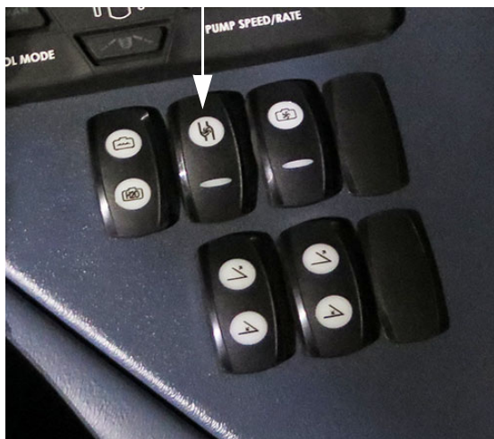
Spínač čerpadla roztoku (Nachádza sa na bočnej konzole) - Typický pohľad
