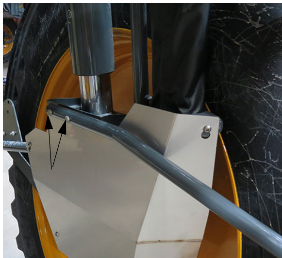
Montážne skrutky oddeľovača plodín (2) - Typický pohľad
