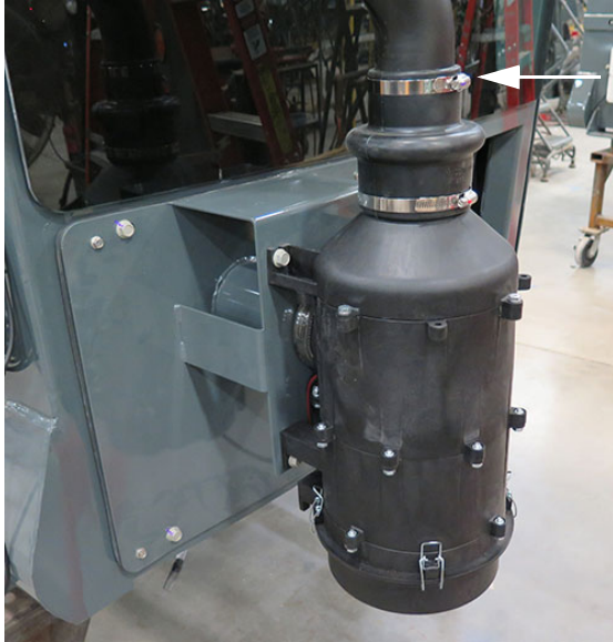
Prírubová svorka - horná (Nachádza sa blízko hornej časti filtračnej jednotky RESPA) - Typický pohľad
