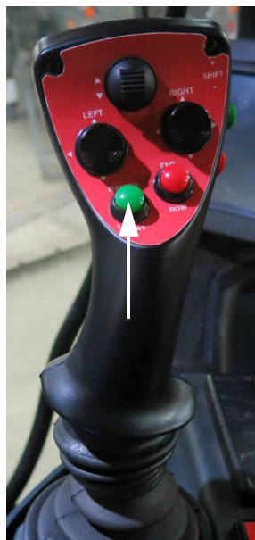
Spínač hlavného postrekovača (Nachádza sa na radiacej páke hydrostatického pohonu) - Typický pohľad
