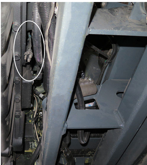
Napájací kábel ohrievača bloku motora - STS14/STS16 (Nachádza sa pod strojom na pravej strane motora) - Typický pohľad
