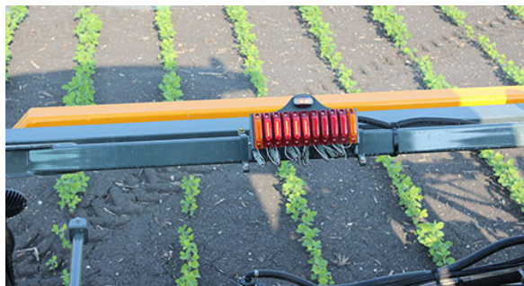
Indikátory ventilov roztoku výložníka (Nachádzajú sa na priechniku) - Typický pohľad
