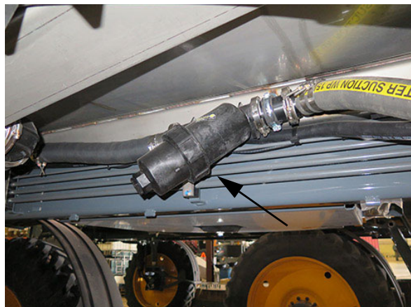
Filter vedenia roztoku (Nachádza sa pod pravou strednou stranou stroja) - Typický pohľad
