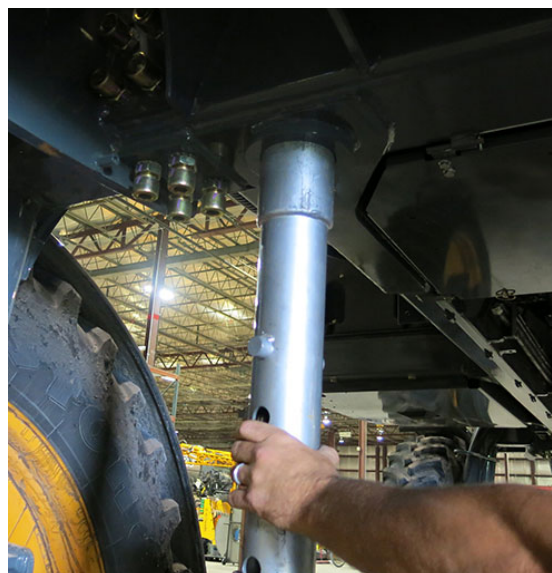
Zasuňte zdvihák do vymedzovacieho krúžku zdvíhacieho bodu - Typický pohľad
