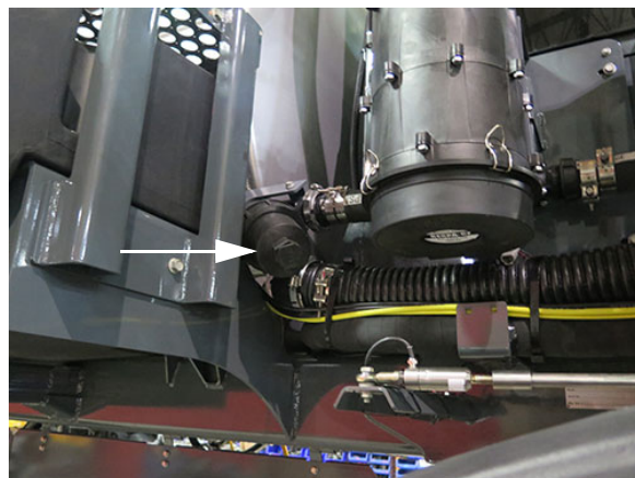
Filter vedenia roztoku - sekundárny (Nachádza sa blízko pravej prednej strany stroja) - Typický pohľad
