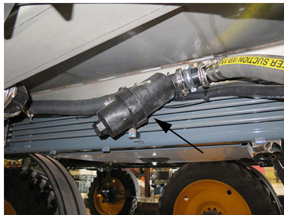
Filter vedenia roztoku (Nachádza sa pod pravou strednou časťou stroja) - Typický pohľad
