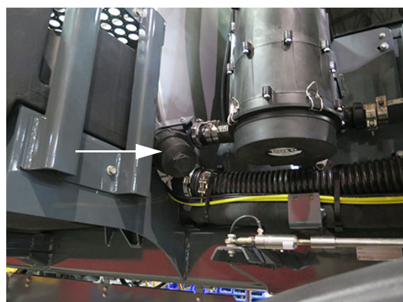
Filter vedenia roztoku - sekundárny (Nachádza blízko prednej pravej strany stroja) - Typický pohľad
