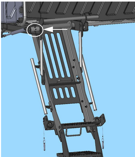
Maznica hriadeľa s pneumatickou pružinou (Nachádza sa blízko hornej ľavej strany rebríka) - Typický pohľad
