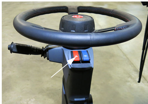
Spínač výstražných svetiel (Nachádza sa na stĺpiku riadenia) - Typický pohľad
