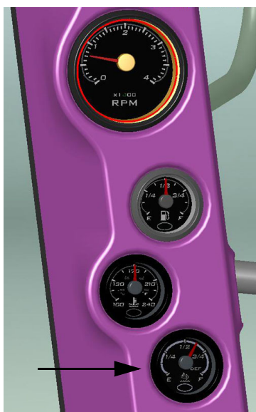
Merací prístroj kvapaliny DEF (Nachádza sa na stípike A kabíny) - Typický pohľad
