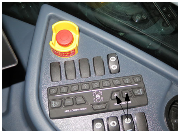
Spínače rýchlosti/dávkovania čerpadla (Nachádzajú sa na bočnej konzole) - Typický pohľad
