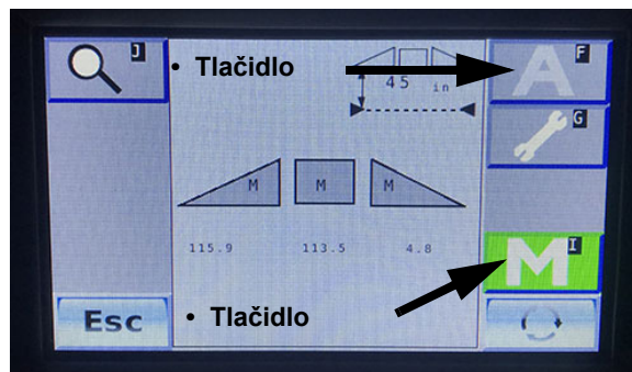
Tlačidlá Automatický/Manuálny režim (Nachádzajú sa na hlavnej obrazovke „Prevádzková obrazovka“ systému NORAC) - Typický pohľad
