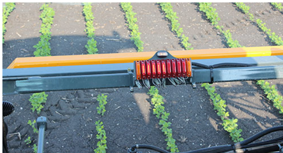
Indikátory ventilov roztoku výložníka (Nachádzajú sa na priečniku) - Typický pohľad
