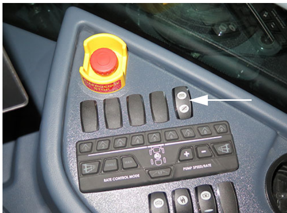
Spínač preplachovania z nádrže (Nachádzajú sa na bočnej konzole) - Typický pohľad
