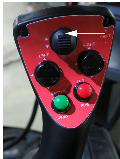
Spínač priečnika - hore (Nachádzajú sa na radiacej páke hydrostatického pohonu) - Typický pohľad
