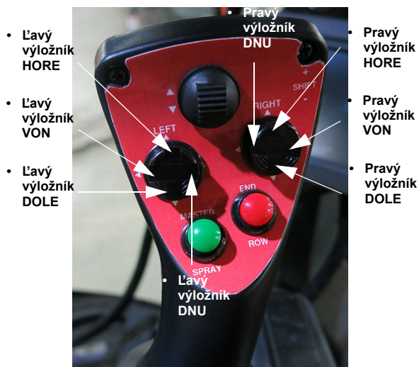
Ľavý a pravý spínač výložníka (Nachádzajú sa na radiacej páke hydrostatického pohonu) - Typický pohľad
