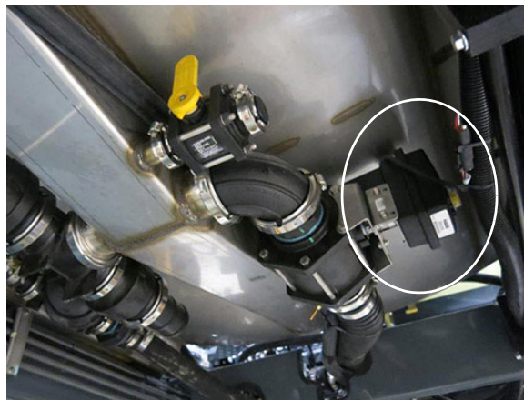
Ventil nádrže na roztok (Nachádza sa pod nádržou na roztok na spodnej strane stroja) - Typický pohľad
