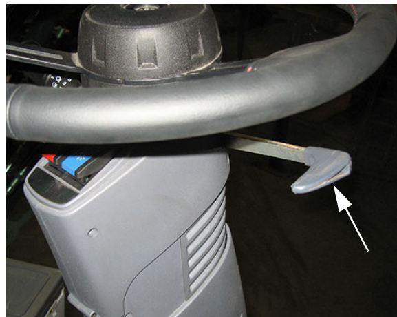
Rukoväť teleskopického nastavenia volantu (Nachádza sa na pravej strane stĺpika riadenia) - Typický pohľad
