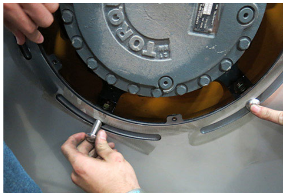
Inštalácia montážnej skrutky krytu kolesa - Typický pohľad
