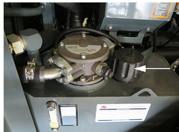
Odvzdušňovací uzáver - STS10/STS12 (Nachádza sa na hornej strane nádrže na hydraulický olej) - Typický pohľad
