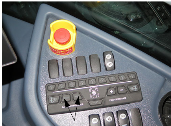
Spínače ovládania dávkovania (Nachádzajú sa na bočnej konzole) - Typický pohľad
