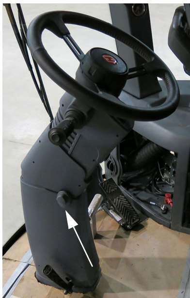
Tlačidlo nastavenia sklonu stĺpika riadenia (Nachádza sa na ľavej strane stĺpika riadenia) - Typický pohľad
