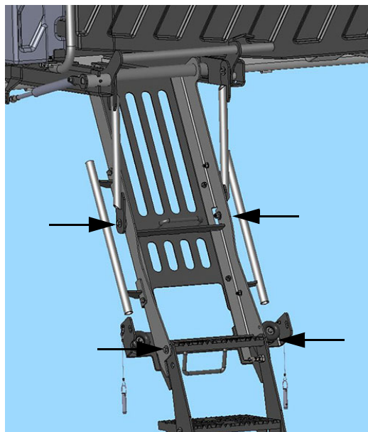
Vrchné body otáčania rebríka (4) - Typický pohľad
