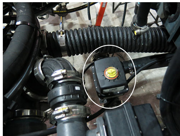
Ventil miešania (Nachádza sa pod strednou časťou stroja) - Typický pohľad * Pohľad zvrchu stroja
