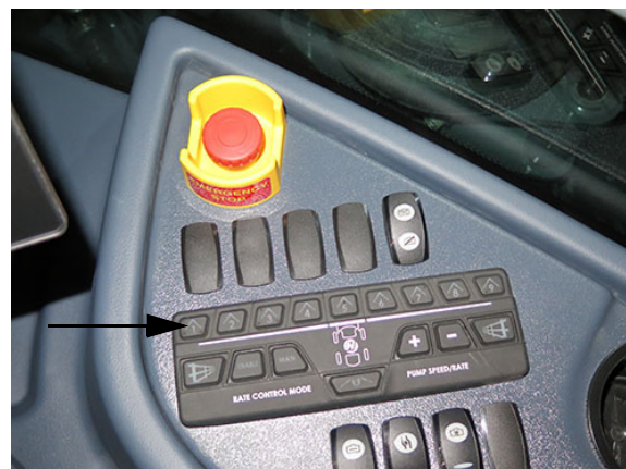
Spínače ventilov roztočú výložníka (Nachádzajú sa na bočnej konzole) - Typický pohľad
