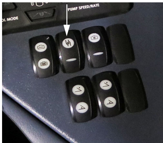
Spínač čerpadla roztoku (Nachádzajú sa na bočnej konzole) - Typický pohľad
