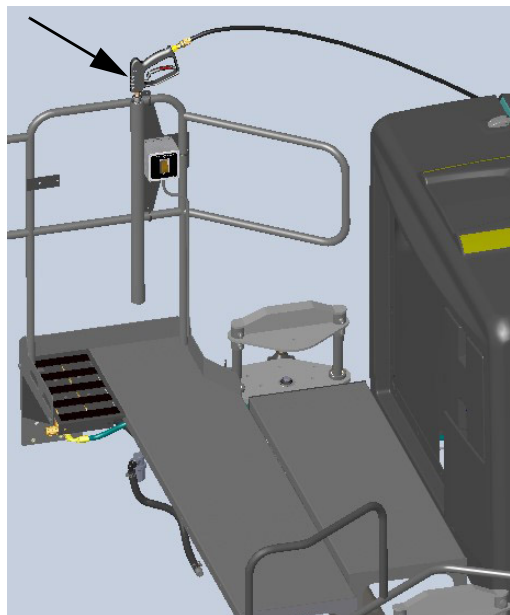
Dýzový nadstavec tlakovej umývačky (Namontovaný na zadnom pravom zábradlí) - Typický pohľad
