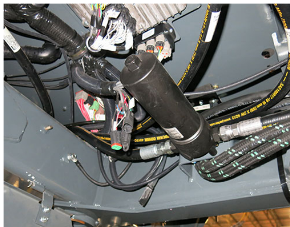
Tlakový filter (Nachádza sa pod pravou stranou stroja - na získanie prístupu zložíte kovový kryt) - Typický pohľad
