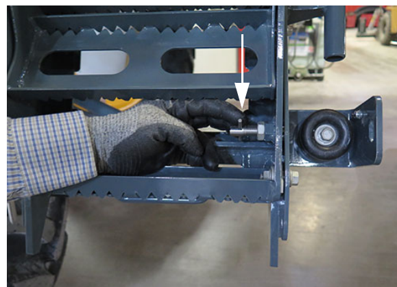
Poistný kolík (Nachádza sa na pravej spodnej strane zloženej zostavy rebríka) - Typický pohľad
