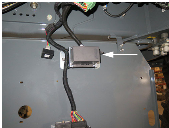
Reléová skrinka čerpadla roztoku (Nachádza sa pod predným koncom kabíny - zložte panel na získanie prístupu) - Typický pohľad
