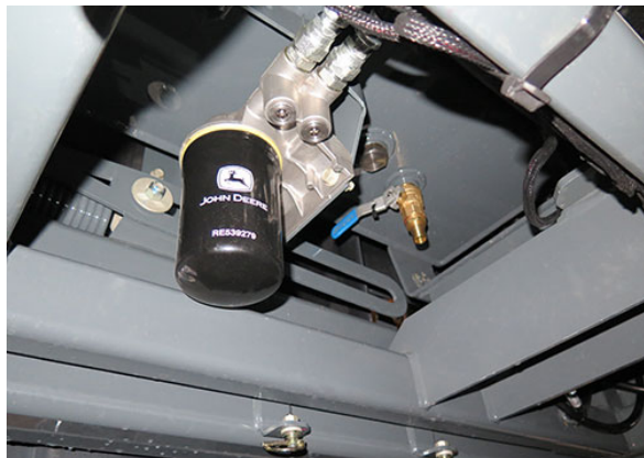
Filter motorového oleja (Nachádza sa na ľavej zadnej strane stroja pod nádržou na hydraulický olej) - Typický pohľad
