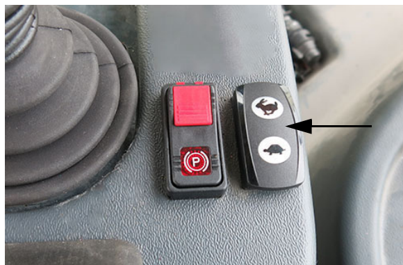
Spínač škrtiacej klapky (Nachádza sa blízko radiacej páky hydrostatického pohonu) - Typický pohľad
