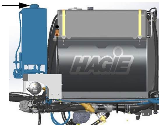
Veko plniaceho otvoru (Nachádza sa na hornej časti nádrže na chemikáliu) - Typický pohľad
