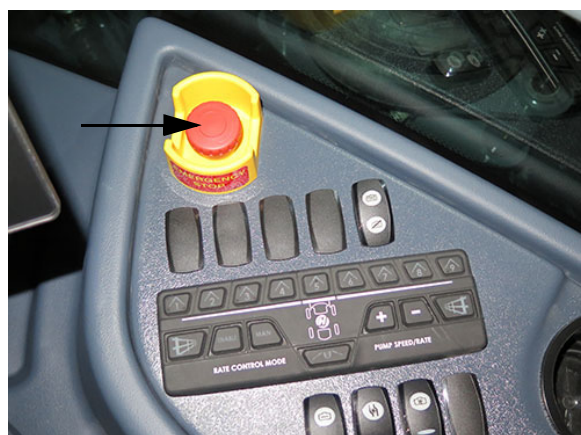
Spínač núdzového zastavenia E-Stop (Nachádza sa na bočnej konzole) - Typický pohľad
