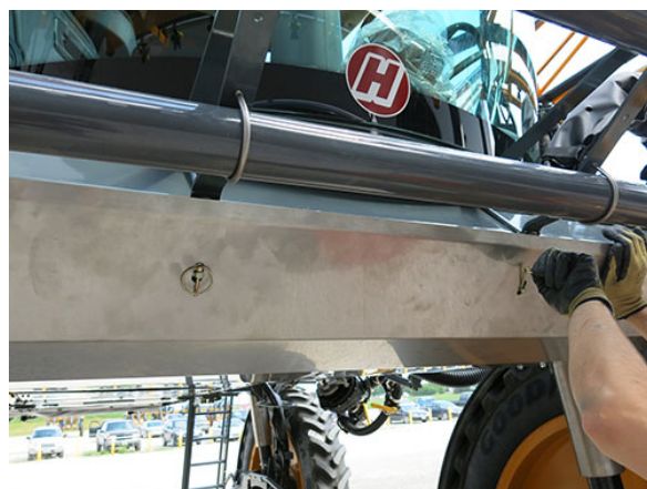
Inštalácia predného ochranného štítu - Typický pohľad
