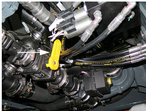
Uzatvárací ventil miešania (Nachádza sa pod zadnou časťou stroja) - Typický pohľad
