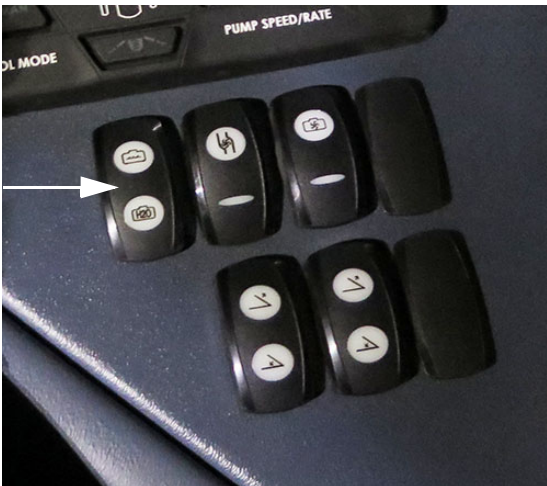
Voliaci prepínač ventilu nádrže (Nachádzajú sa na bočnej konzole) - Typický pohľad
