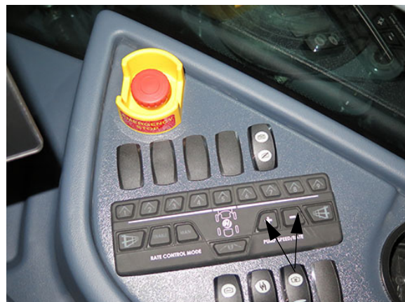
Spínače rýchlosti/dávkovania čerpáďa (Nachádzajú sa na bočnej konzole) - Typický pohľad
