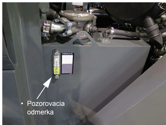
Nádrž na hydraulický olej (Nachádza sa na ľavej strane stroja - otvorte kapotu na získanie prístupu) - Typický pohľad
