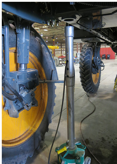
Zalicujte zdvihák s vymedzovacím krúžkom zdvíhacieho bodu - Typický pohľad
