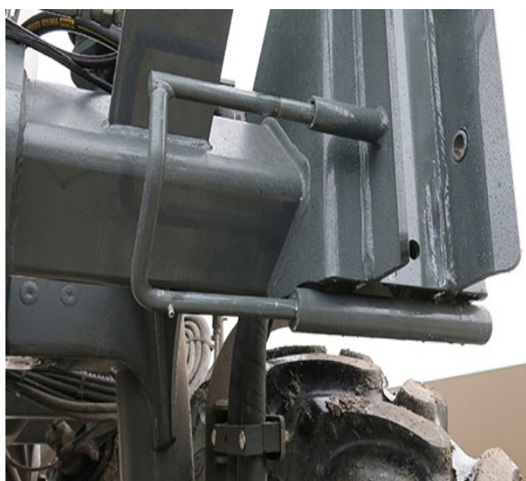
Poistný kolík (2) (Nachádza sa na prednej ľavej a pravej strane stroja) - Typický pohľad
