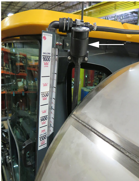
Nádrž na kvapalinu do ostrekovača (Nachádza sa za ľavou stranou kabíny) - Typický pohľad
