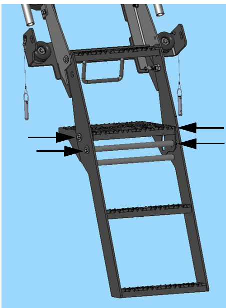
Spodné body otáčania rebríka - plošina (4) - Typický pohľad
