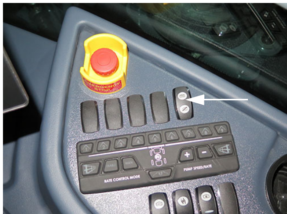
Spínač preplachovania z nádrže (Nachádza sa na bočnej konzole) - Typický pohľad
