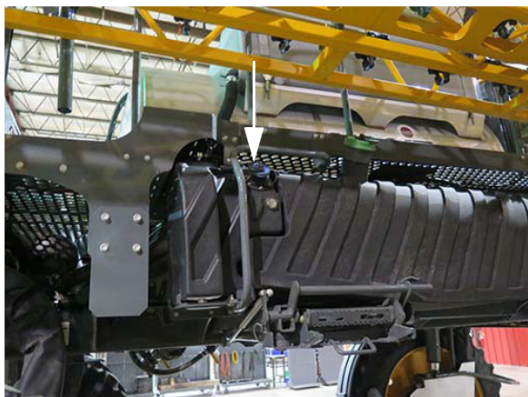
Plniaci uzáver kvapaliny DEF (Nachádza sa na prednej časti nádrže na kvapalinu DEF) - Typický pohľad
