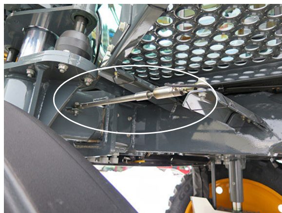
Snímač nastavenia rozchodu kolies (4) (Nachádza sa na každej z nôh) - Typický pohľad
