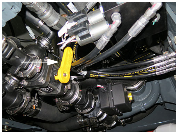
Uzatvárací ventil miešania (Nachádza sa pod zadnou časťou stroja)
