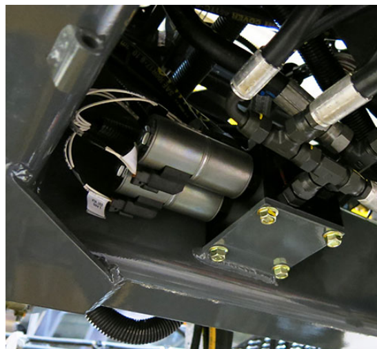
Ventilové potrubie (Nachádza sa na spodnej strane stroja) - Typický pohľad
