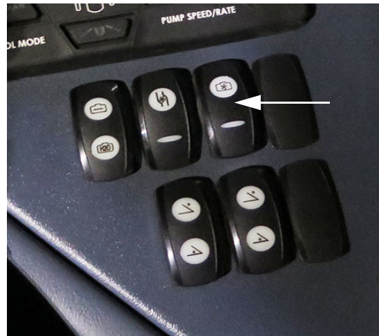
Spínač ventilu miešania (Nachádzajú sa na bočnej konzole) - Typický pohľad
