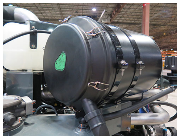
Filter prívodu vzduchu do motora - STS14/STS16 (Nachádza sa na ľavej zadnej strane stroja - otvorte kapotu na získanie prístupu) - Typický pohľad
