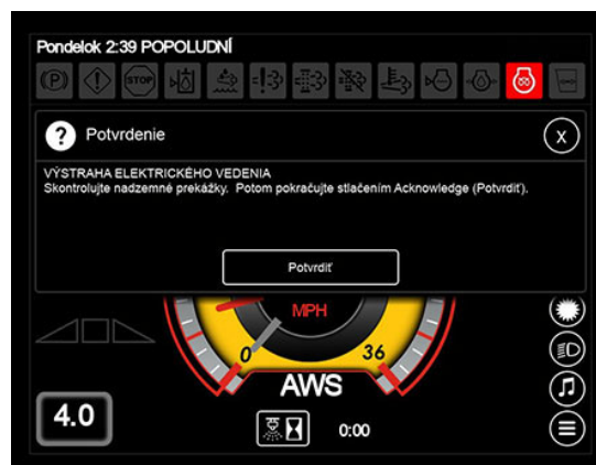
Výstražné hlásenie o elektrickom vedení (Nachádza sa na displeji stroja)
