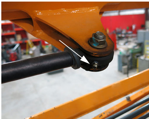
Koniec tyče valca vyklápacieho mechanizmu výložníka - Typický pohľad
