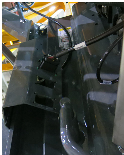
Pripojenie systému NORAC (Nachádza sa na prednej pravej strane stroja) - Typický pohľad
