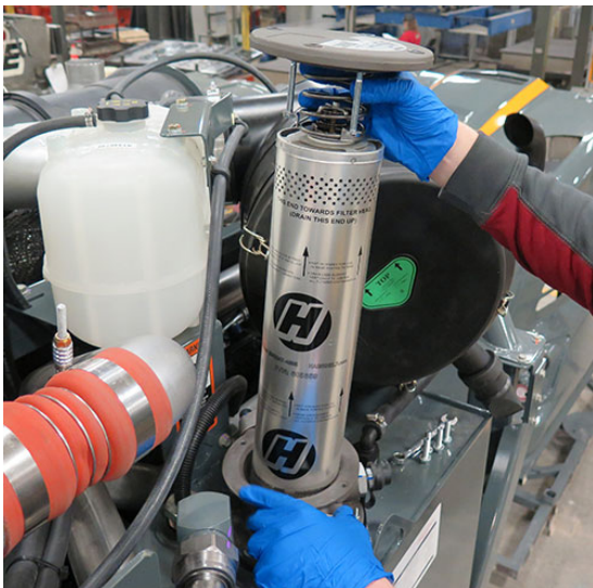
Spätný filter (Nachádza sa vo vnútri telesa filtra navrchu nádrže na hydraulický olej) - Typický pohľad
