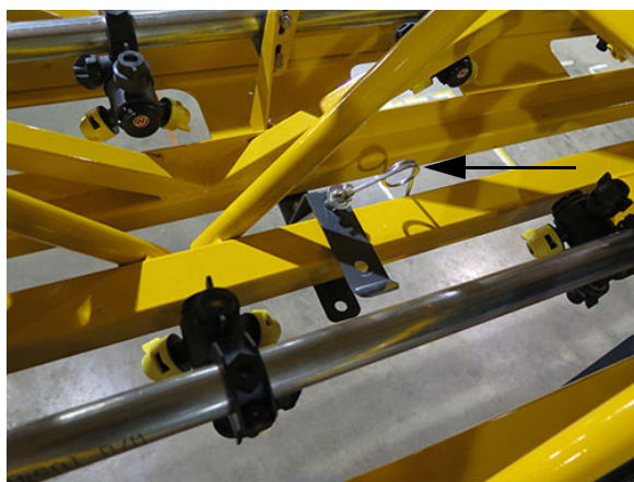
Prepravný poistný kolík (Zobrazený v „uloženej“ polohe) - Typický pohľad
