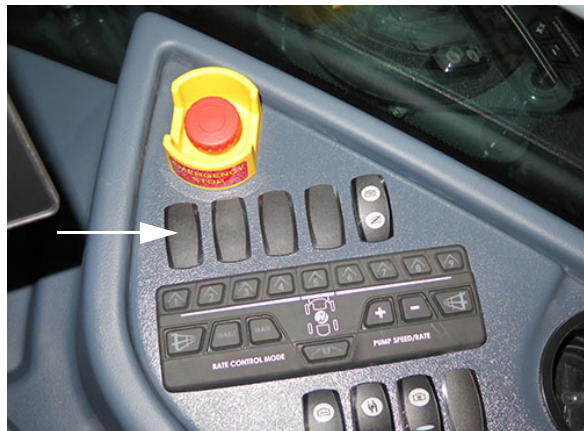
Spínač penového značkovača (Nachádza sa na bočnej konzole) - Typický pohľad
