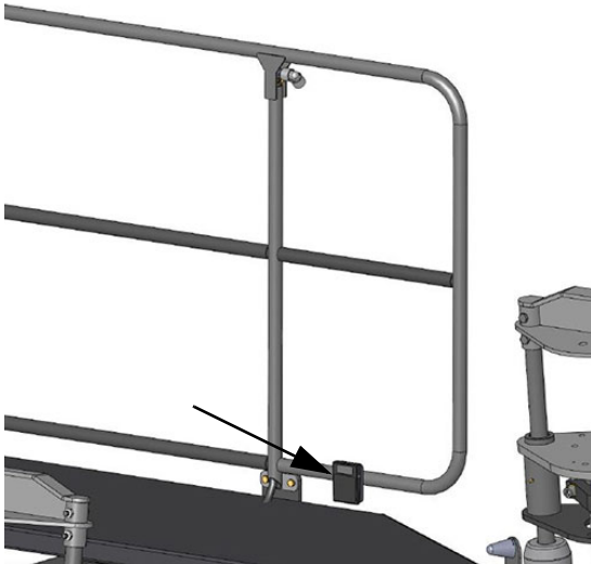
Pedál systému umývania rúk (Nachádza sa pozdĺž ľavého spodného zábradlia) - Typický pohľad
