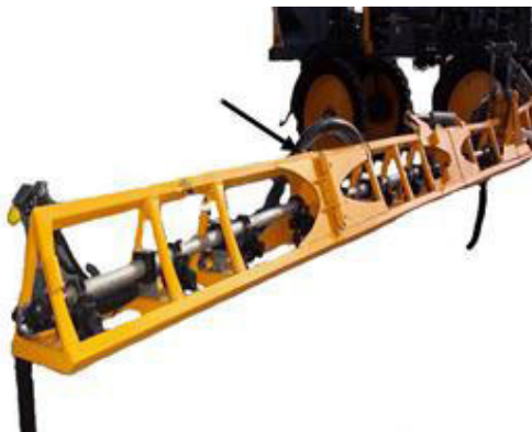
Poistná skrutka (Nachádza sa na zadnej strane výložníka) - Typický pohľad
