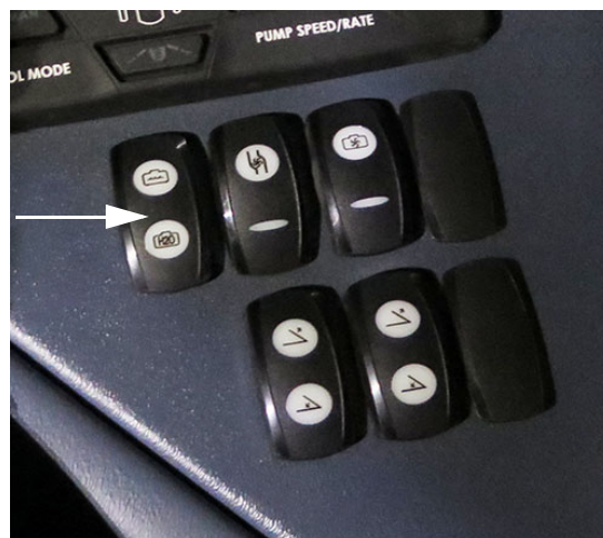
Voliaci prepínač ventilu nádrže (Nachádza sa na bočnej konzole) - Typický pohľad
