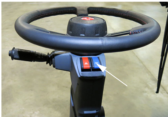
Spínač cestných prevádzkových svetiel (Nachádza sa na stĺpiku riadenia) - Typický pohľad
