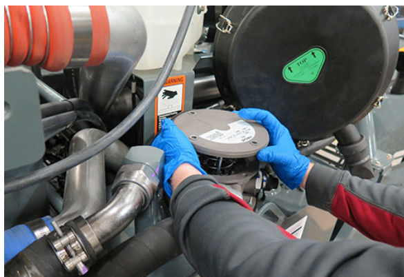
Dopĺňanie nádrže cez teleso hydraulického spätného filtra - Typický pohľad
