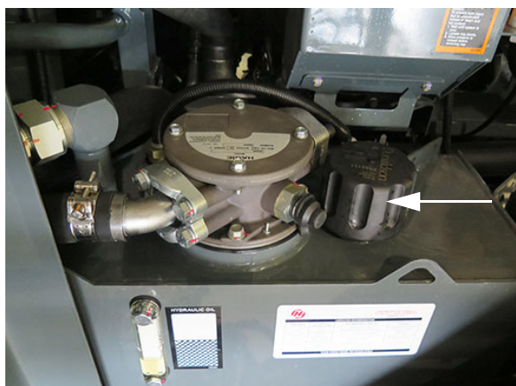
Odvzdušňovací uzáver - STS10/STS12 (Nachádza sa navrchu nádrže na hydraulický olej) - Typický pohľad
