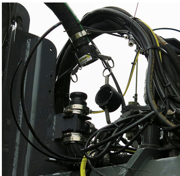
Pripojenie roztoku - štandardná výbava (Nachádza sa na prednej pravej strane stroja) - Typický pohľad
