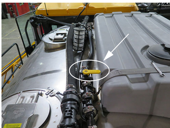
Preplachovací ventil dvojakého výrobku (Nachádza sa na hornej časti nádrže na roztok)
