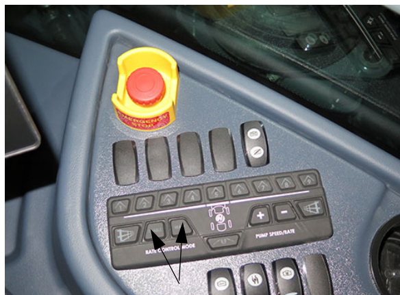
Spínače ovládania dávkovania (Nachádza sa na bočnej konzole) - Typický pohľad
