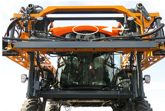
Dýza rozprašovania kvapaliny ostrekovača (Nachádza sa v blízkosti hornej vonkajšej časti kabíny) - Typický pohľad
