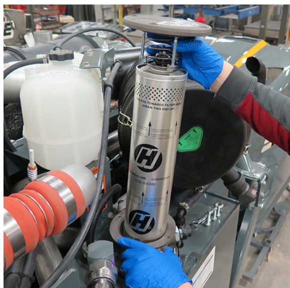
Spätný filter (Nachádza sa vo vnútri telesa filtra na hornej strane nádrže na hydraulický olej) - Typický pohľad
