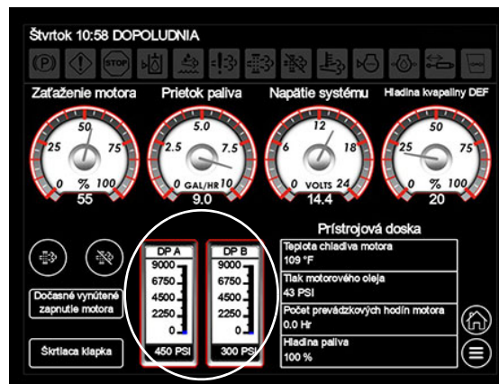
Meracie prístroje DP-A/DP-B (Nachádzajú sa na obrazovke Diagnostika motora)
