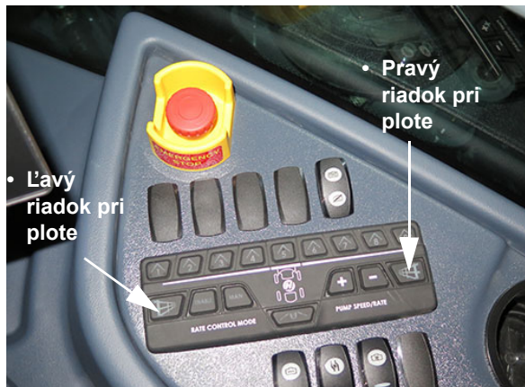
Spínače postrekovacích dýz riadkov pri plote - ľavý/pravý (Nachádza sa na bočnej konzole) - Typický pohľad
