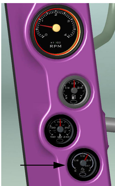
Merací prístroj kvapaliny DEF (Nachádza sa na stĺpiku A kabíny) - Typický pohľad
