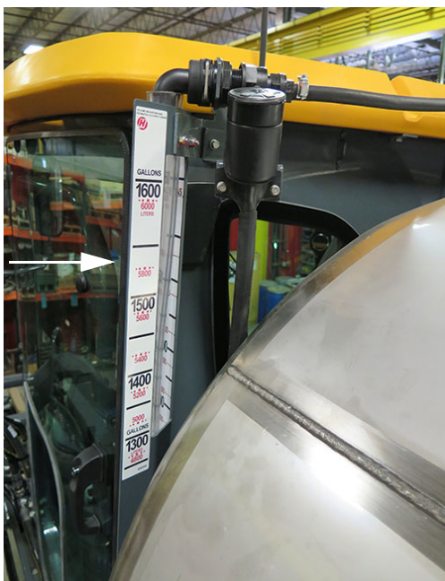
Pozorovacia odmerka nádrže na roztok (Nachádza sa za ľavou zadnou stranou kabíny) - Typický pohľad
