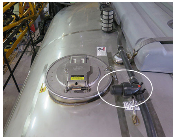
Preplachovací filter nádrže - nádrž z nehrdzavejúcej ocele (Nachádza sa navrchu nádrže na roztok) - Typický pohľad
