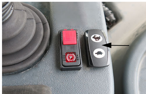
Spínač škrtiacej klapky (Nachádza sa blízko radiacej páky hydrostatického pohonu) - Typický pohľad
