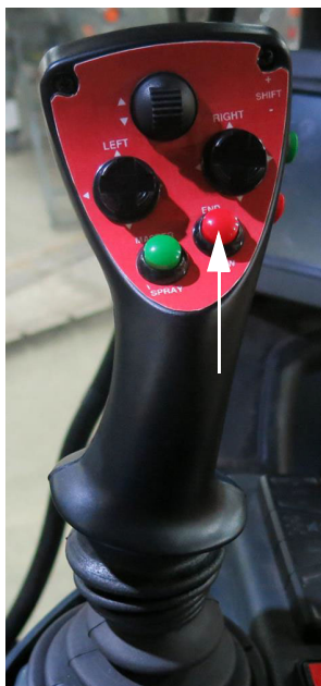
Spínač spravovania koncových riadkov (Nachádzajú sa na radiacej páke hydrostatického pohonu) - Typický pohľad
