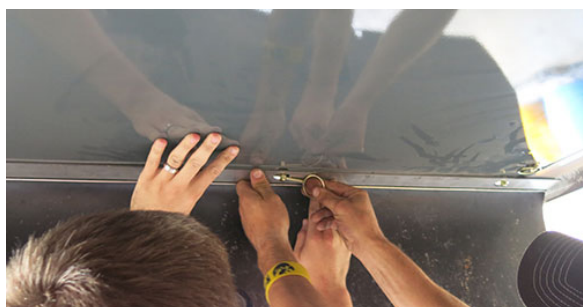
Zaisťovací kolík (Nainštalovaný v závesnom kolíku) - Typický pohľad
