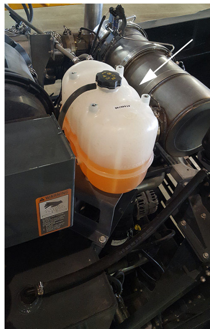
Vyrovnávacia nádrž - STS10/STS12 (Nachádza sa blízko zadnej časti stroja - otvorte kapotu na získanie prístupu) - Typický pohľad
