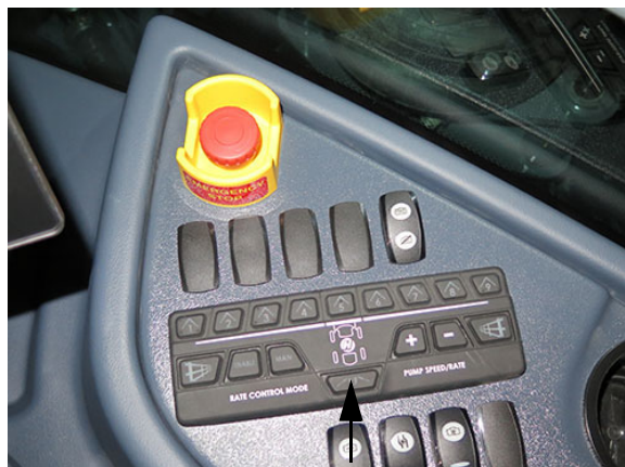
Spínač zadnej dýzy (Nachádza sa na bočnej konzole) - Typický pohľad
