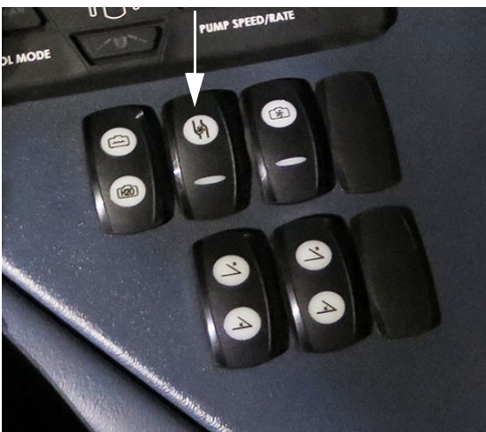
Spínač čerpadla roztoku - primárneho (Nachádzajú sa na bočnej konzole) - Typický pohľad
