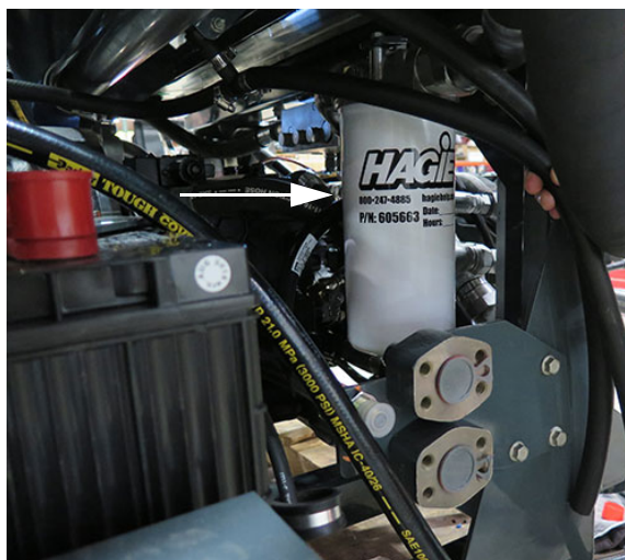
Vypúšťací filter skrine 1 (Nachádza sa na pravej strane stroja v blízkosti batérií) - Typický pohľad
