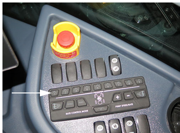
Spínače ventilov roztoku výložníka (Nachádzajú sa na bočnej konzole) - Typický pohľad
