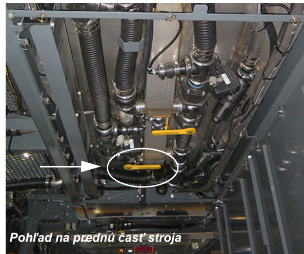
Manuálny uzatvárací ventil nádrže 1 (Nachádza sa pod strednou časťou stroja)
