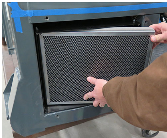
Čistič s aktívnym uhlím (Nachádza sa za vonkajším prevádzkovým panelom na pravej strane kabíny) - Typický pohľad
