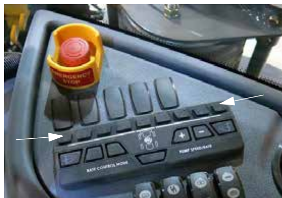
喷杆药液阀 开关 – 喷药段1和9 (位于侧控制台上) - 典型视图
