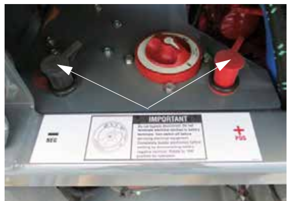
辅助电池充电接线柱 （位于后侧主机架上） - 典型视图
