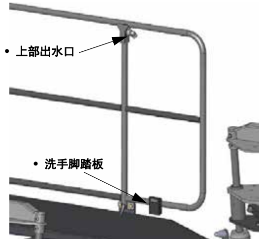
上部出水口/洗手脚踏板 (位于沿机器左侧栏杆) - 典型视图
