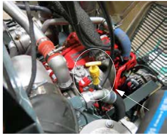
发动机油尺 (位于发动机左手侧 — 打开护罩可以够着) - 典型视图
