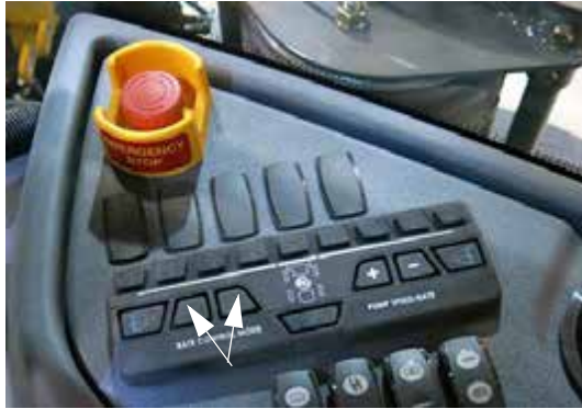
速率控制开关 (位于侧控制台上) - 典型视图
