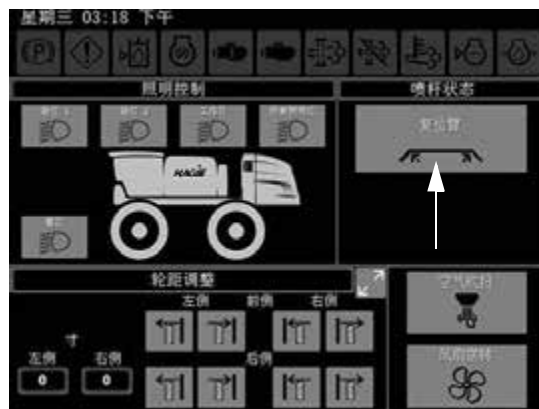
重置分离装置按钮 (位于机器显示屏辅助控制器页面上)
