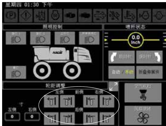
胎面调整按钮 (位于机器显示屏辅助控制器 页面的底部)
