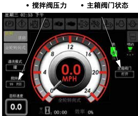
主箱阀门状态和搅拌阀压力指示器 （位于机器显示屏主页 - 田间模式上）
