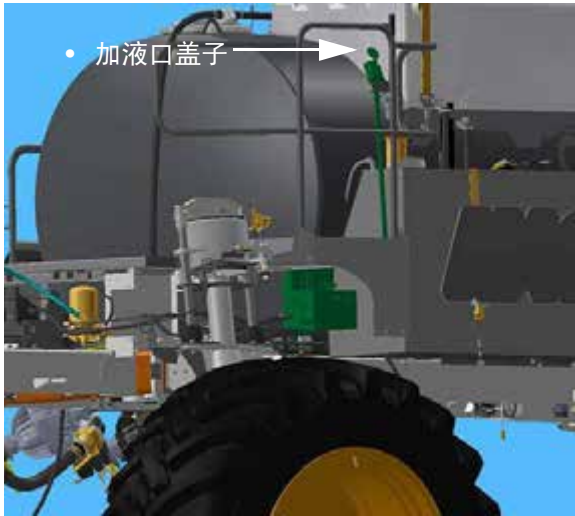
发泡器储存箱加液口 (位于右后侧扶手上) - 典型视图
