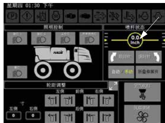
喷杆对准值 (位于辅助控制器页面的右手侧)
