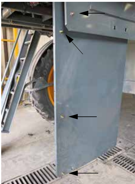
吊杆销 (如图所示, 面板 4 上安装三个销钉, 面板 5 上安装一个销钉) -典型视图
