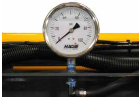
压力表 (安装在喷杆上) - 典型视图
