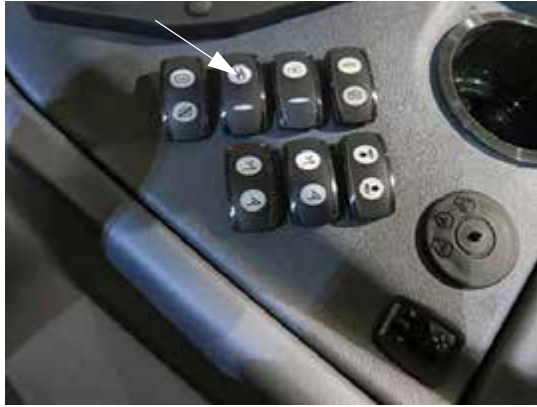
药液泵开关 (位于侧控制台上) - 典型视图
