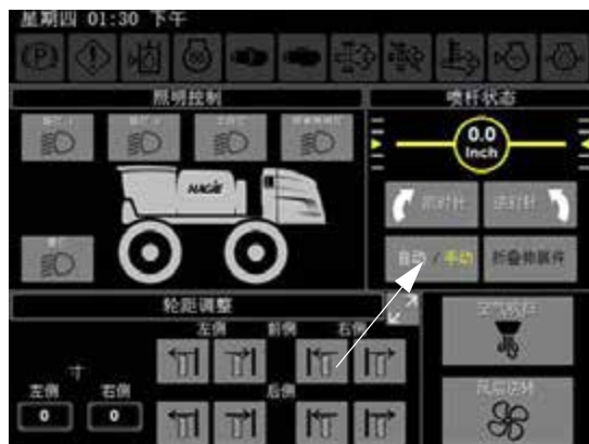
喷杆状态按钮 – 自动/手动 (位于辅助控制器页面上)
