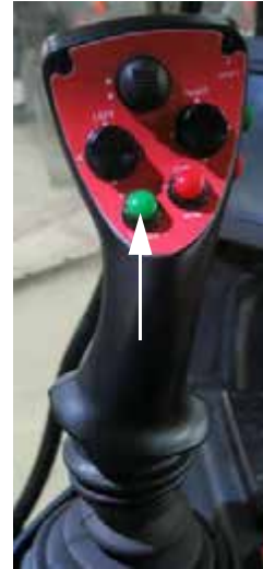
主控开关 (位于静液压驱动手柄的背侧) - 典型视图
