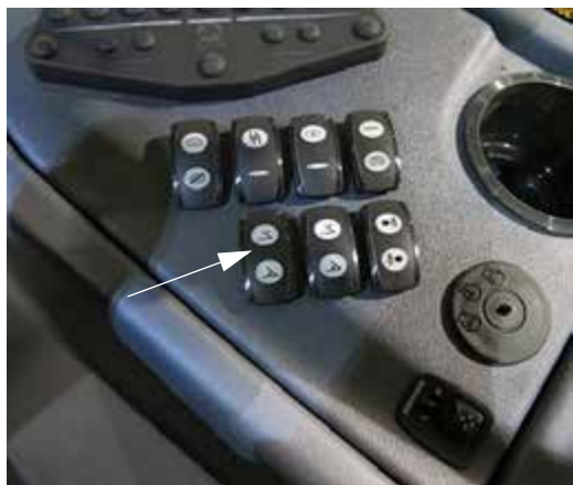
喷杆伸展开关 *90英尺喷杆 (位于侧控制台上) - 典型视图
