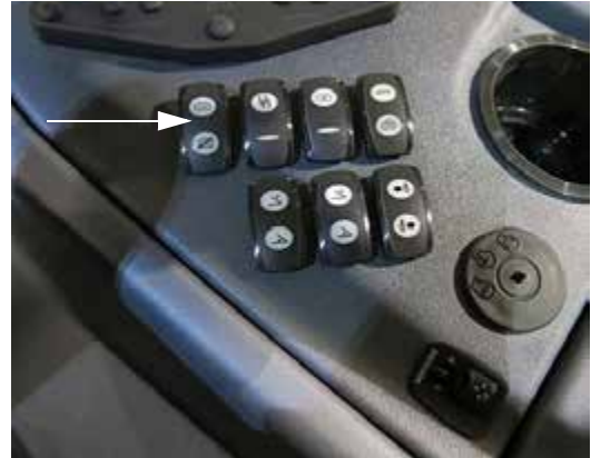
主箱阀门开关 （位于侧控制台上） - 典型视图
