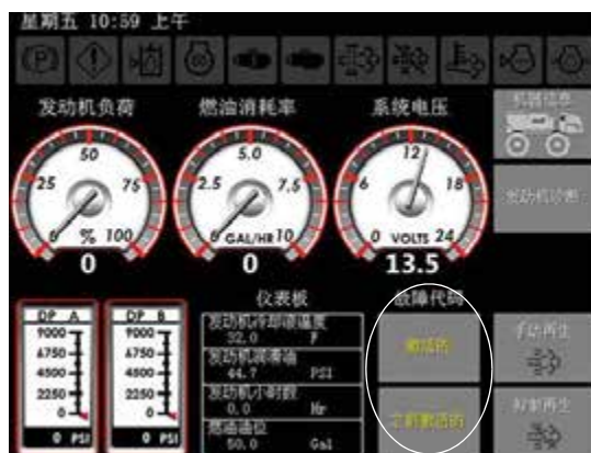
故障代码按钮 （位于机器诊断页面上）
