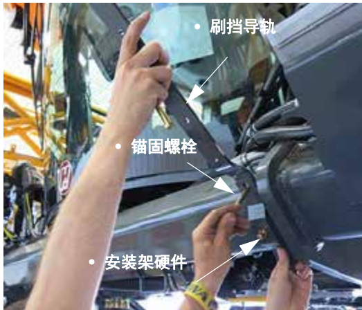
刷挡导轨总成 -典型视图
