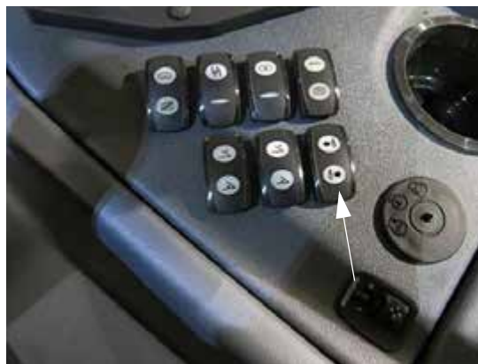
发泡器开关 (位于侧控制台上) - 典型视图
