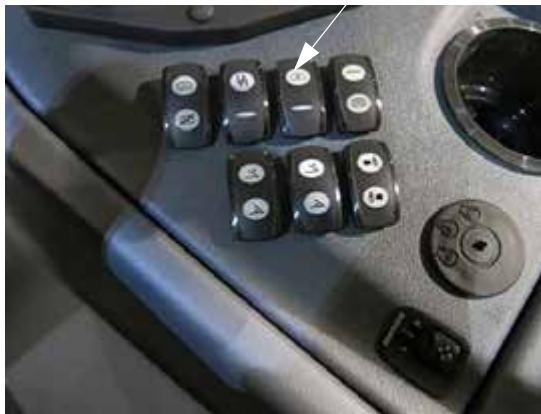
搅拌阀开关 (位于侧控制台上) - 典型视图
