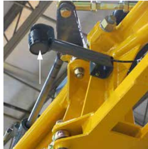
Norac 传感器泡沫垫 （位于各个传感器的底部） - 典型视图
