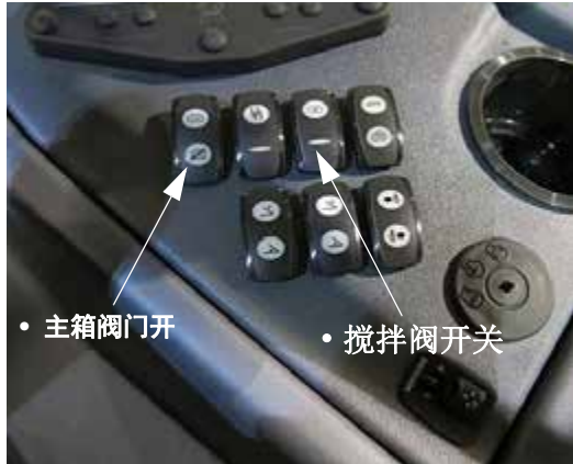
主箱阀门开关和搅拌阀开关 （位于侧控制台上） - 典型视图
