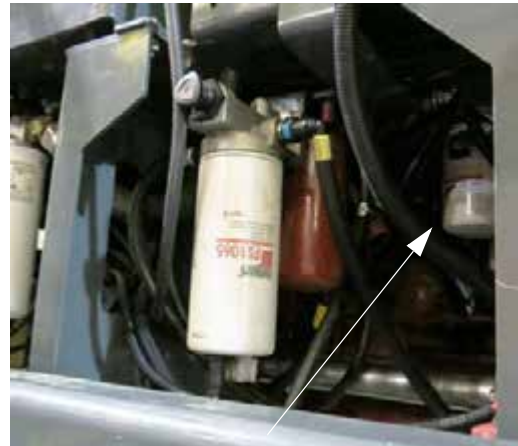
发动机油过滤器 (位于机器左手侧 – 打开罩盖可以够着) - 典型视图
