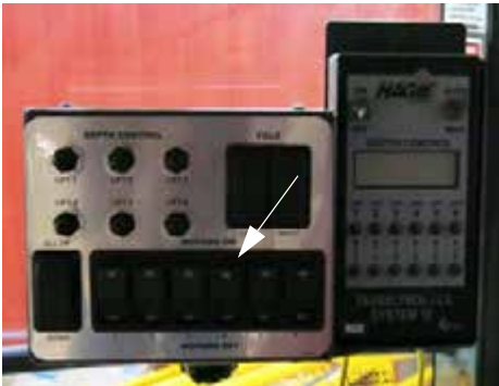
全部向上/向下开关 (位于去雄机控制面板上) - 典型视图
