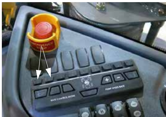
喷杆药液阀开关 1 和 2 (位于侧控制台上) - 典型视图
