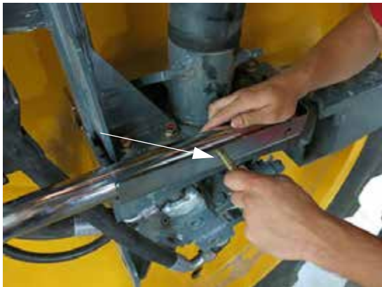
分禾器安装螺栓 -典型视图
