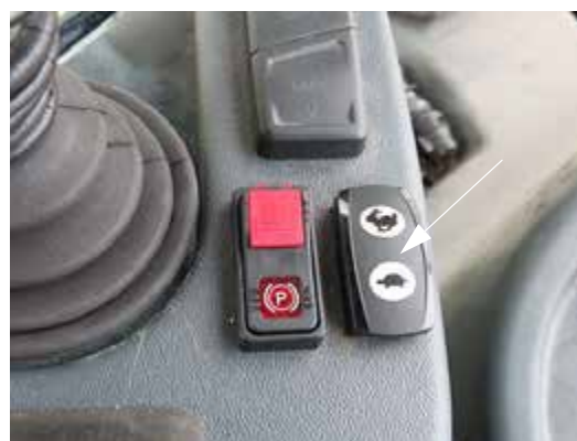
油门开关 (位于静液压驱动控制柄的附近) - 典型视图
