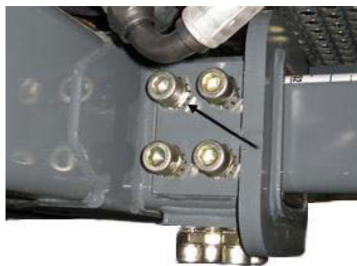
防松螺母 (位于每个胎面调整轴承螺栓上) - 典型视图
