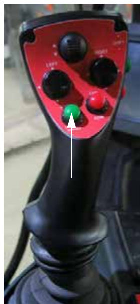
主喷药开关 (位于静液压驱动控制柄背面)
