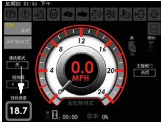
目标速度 (位于主页 – 道路和现场模式的左下侧)
