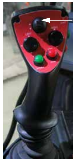
连杆开关- 向上 (位于静液压驱动控制柄上) - 典型视图
