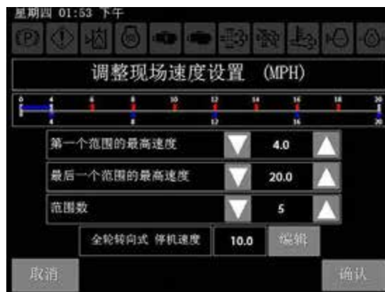
速度设置屏幕 * 显示田间速度设置
