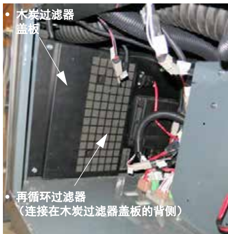
木炭过滤器盖板 (位于驾驶室右侧的室外 检修面板的后侧) - 典型视图
