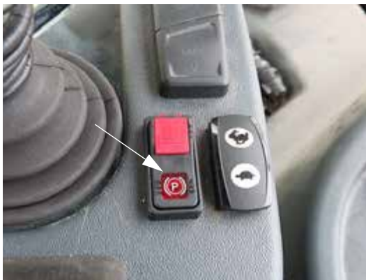
驻车制动器开关 （位于静液压驱动控制柄的附近） - 典型视图
