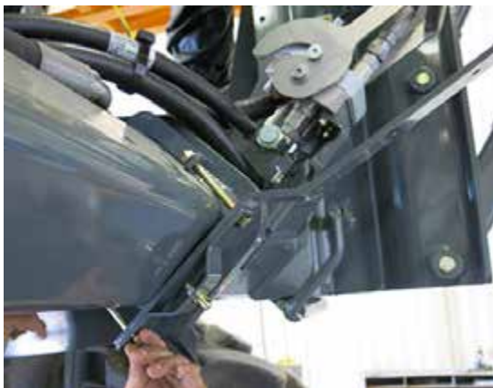
锚固螺栓总成 -典型视图
