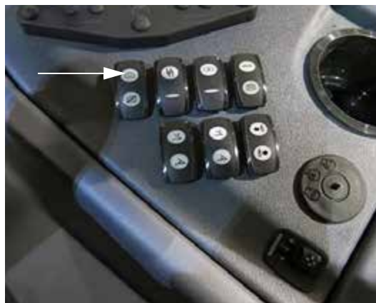
主箱阀开关 (位于侧控制台上) - 典型视图
