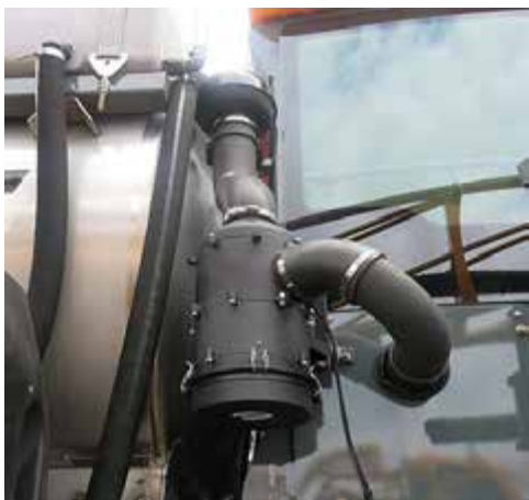
驾驶室过滤系统 (位于驾驶室室外的右手侧) - 典型视图
