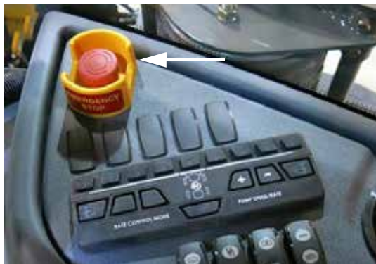
紧急停止按钮 (位于侧控制台上) - 典型视图
