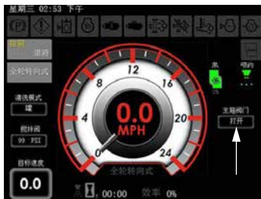
主箱阀状态指示器 (位于机器显示屏主页 - 现场模式右手侧)
