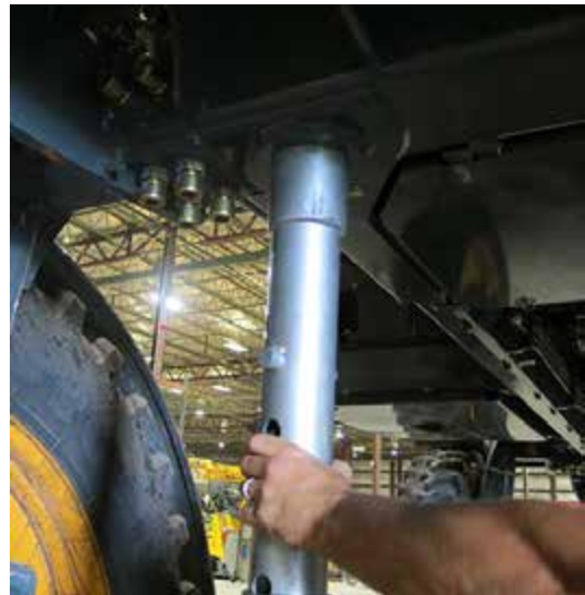
将千斤顶插入提升点包容环中。 - 典型视图
