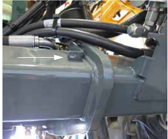
刷挡安装架 (图示为机器左侧) -典型视图
