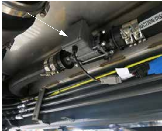
流量计 (位于机械的右侧下方) - 典型视图
