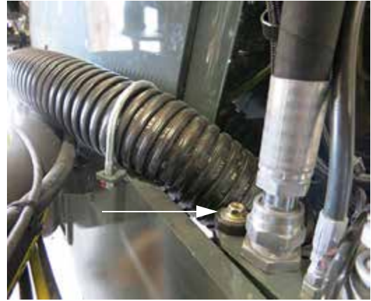
安装螺栓 (2) – 前/后 (位于右侧横梁软管总成安装架上) -典型视图
