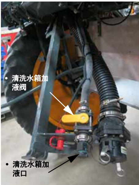
前加液口总成 (图示为降低后的位置) - 典型视图
