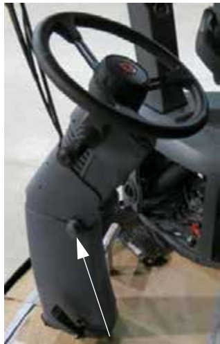
转向柱倾斜调节按钮 (位于转向柱的左手侧) - 典型视图
