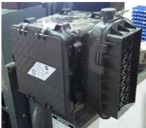
发动机进气过滤器 (位于机器左侧的平台上 - 打开罩盖可以够着) - 典型视图
