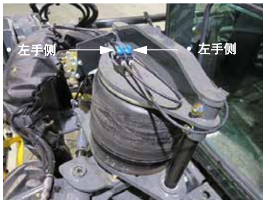
空气悬架阀门 （位于左侧前气囊上） - 典型视图
