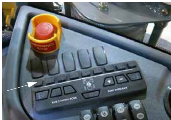
喷杆药液阀开关 (位于侧控制台上) - 典型视图
