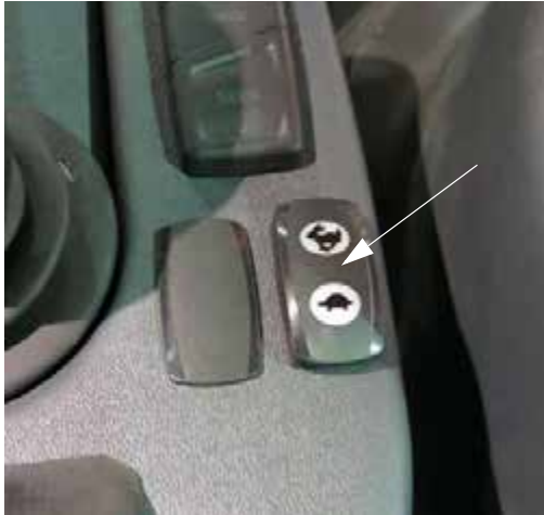
油门开关 (位于靠近静液压驱动控制柄) - 典型视图
