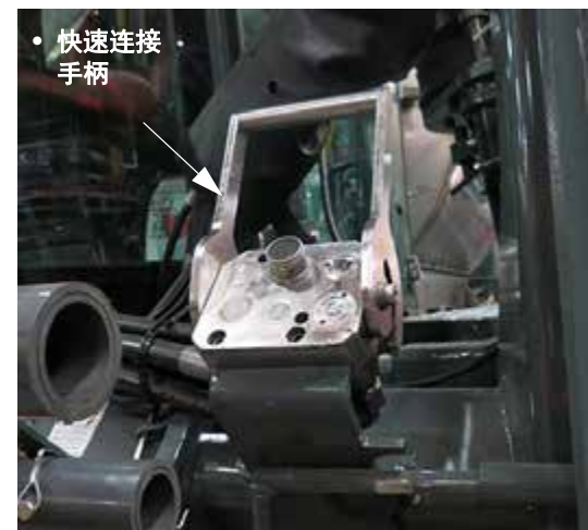
快速连接 手柄 液压/电力多功能联结器总成 (位于机器左前侧)
