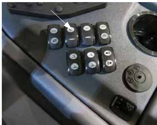
药液泵开关 (位于侧控制台上) - 典型视图
