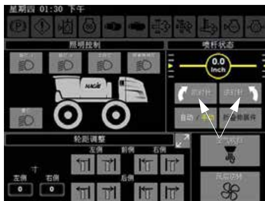
转动命令按钮 (CW/CCW) (位于机器显示屏辅助控制器页面上)
