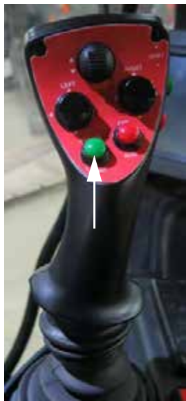
总喷药开关 (位于静液压驱动控制柄上) - 典型视图
