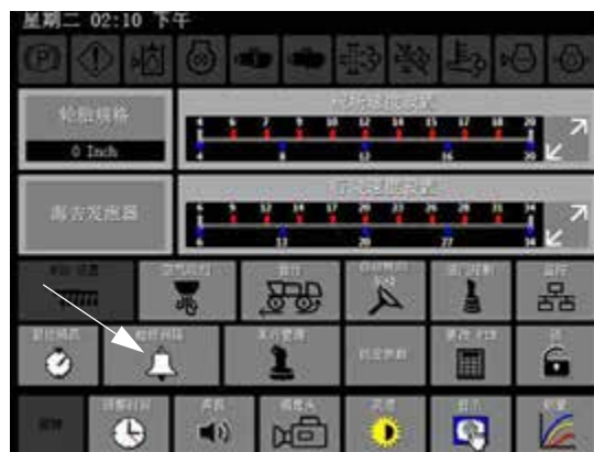
检修间隔按钮 (位于设置页面上)
