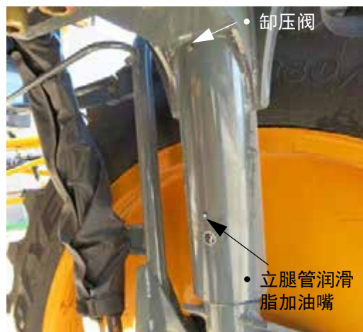
立腿管润滑油加油嘴和卸压阀 (位于前后立腿) - 典型视图
