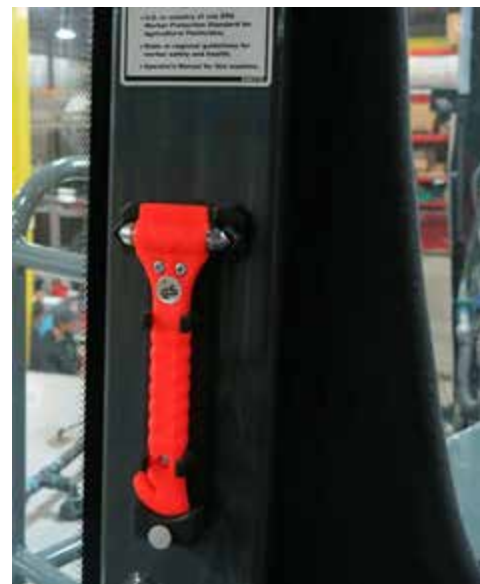
紧急出口工具 (位于驾驶室后方右侧) - 典型视图
