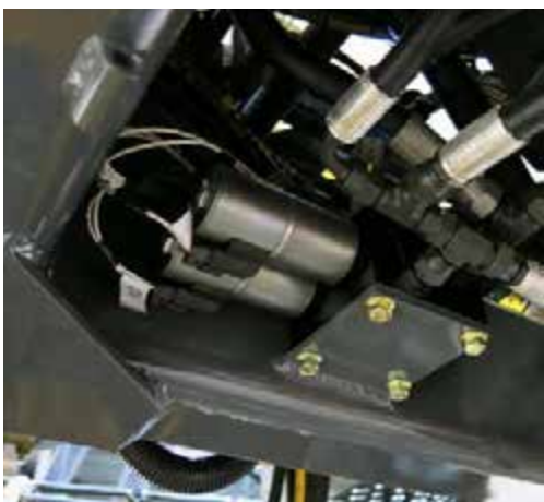
歧管阀 (位于机器的下方) - 典型视图
