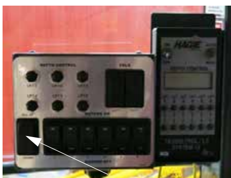
全部向上/向下开关 (位于去雄控制面板上) - 典型视图
