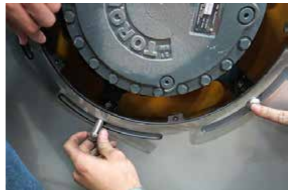
安装车轮盖安装螺栓 -典型视图
