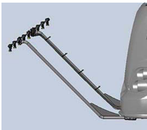
后侧喷杆安装 - 典型视图
