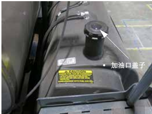
发动机加油口 (位于机器右侧燃油箱下方) 典型视图
