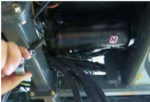
加液泵过滤器 (位于驱动泵之下) - 典型视图
