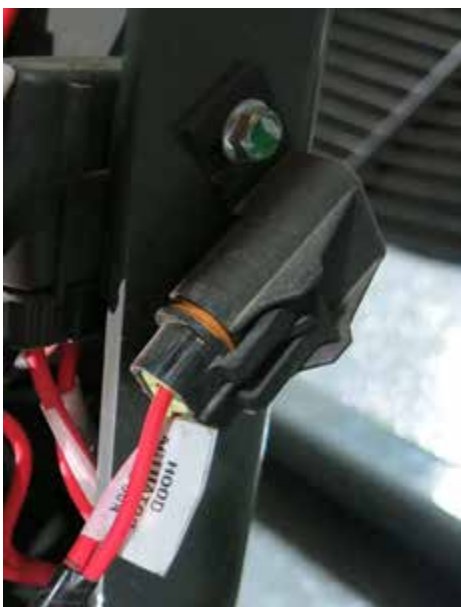
护罩致动器熔丝 (位于机器后方左侧附近 - 打开机罩即可够着) - 典型视图
