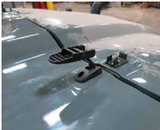
罩锁扣 (2) (位于顶罩两侧) - 典型视图
