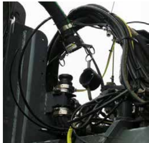
药液连接 (位于机器右前侧) - 典型视图
