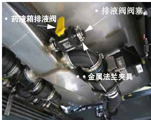
药液箱排液阀总成 (位于机器下面的药液箱的下方) - 典型视图
