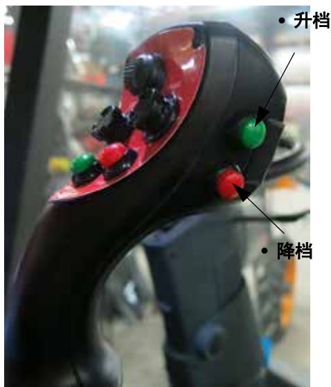
升档/降档开关 (位于静液压驱动控制柄的侧面) - 典型视图
