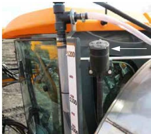
挡风玻璃洗涤液储箱 (位于驾驶室左手侧之后) - 典型视图
