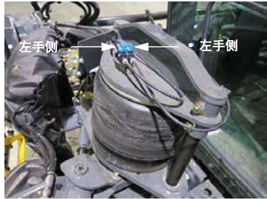
空气悬架阀门 (位于左侧前气囊上) - 典型视图 *左侧前气囊
