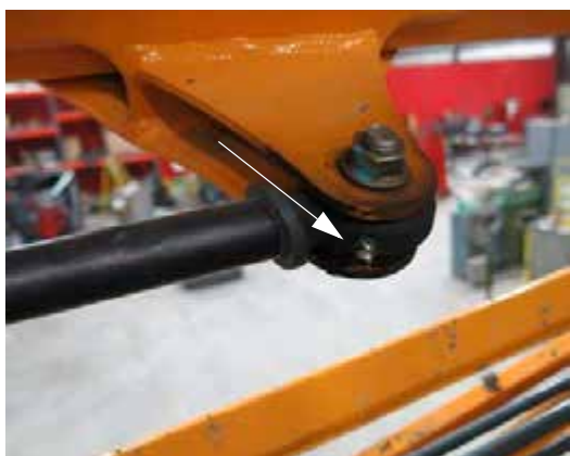
喷杆分离油缸杆端 - 典型视图
