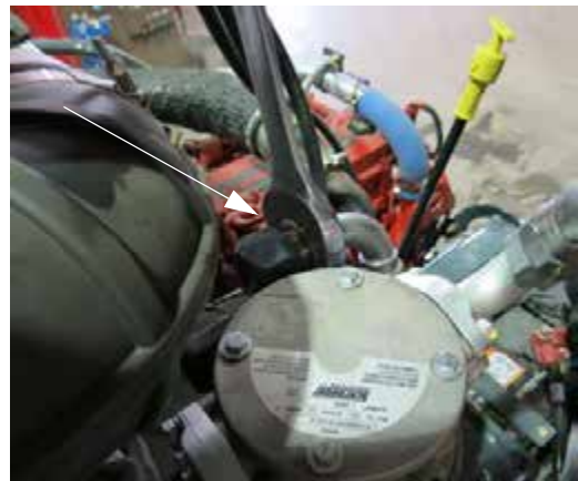
箱体排油管 (位于靠近液压储箱顶部) - 典型视图
