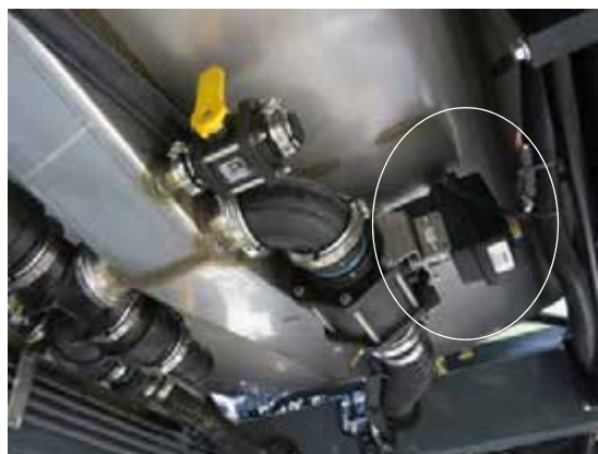
药液箱阀 (位于机器下面的药液箱的下方) - 典型视图
