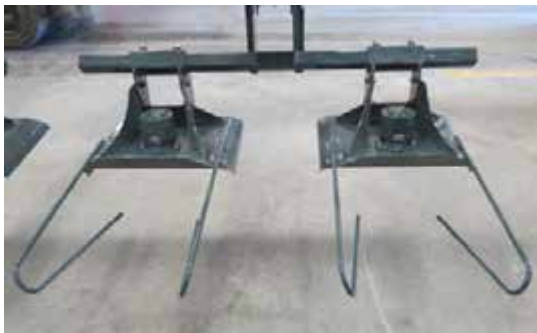
秸秆导向杆安装 - 典型视图
