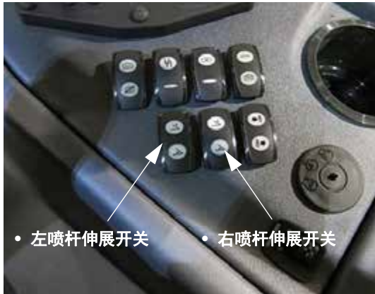
左/右喷杆伸展开关 (位于侧控制台上) - 典型视图
