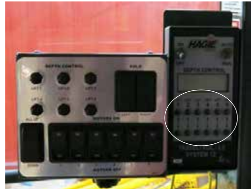
向上提升/下降开关 （位于 Tasseltrol 控制面板） - 典型视图
