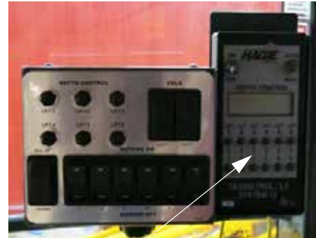
Tasselrol/LS System 12 控制面板 - 典型视图
