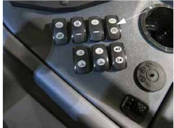
清洗开关 (位于侧控制台上) - 典型视图
