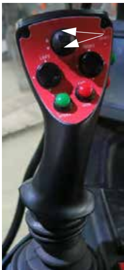
全部向上/向下开关 (位于静液压驱动控制柄上) - 典型视图
