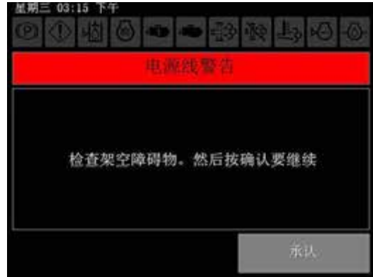
电线警告信息 (位于机器显示屏上)
