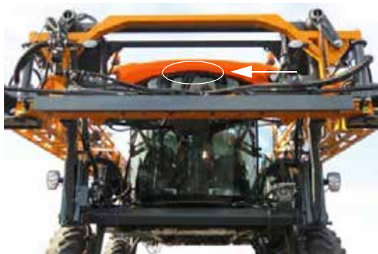
挡风玻璃洗涤液喷嘴 (位于靠近驾驶室顶部的地方) - 典型视图
