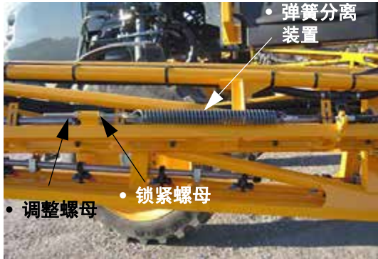
弹簧分离装置调整/锁紧螺母 (位于弹簧分离装置的外端) - 典型视图
