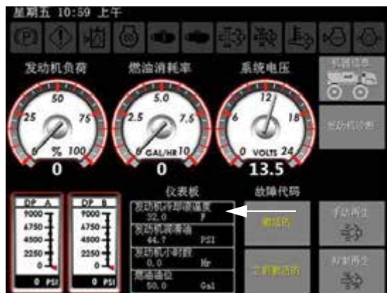
发动机冷却液温度计 (位于机器诊断页面上)
