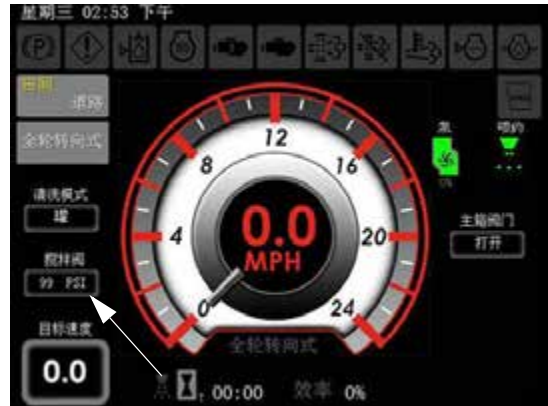
搅拌阀压力指示器 (位于机器显示屏主页 - 现场模式上)
