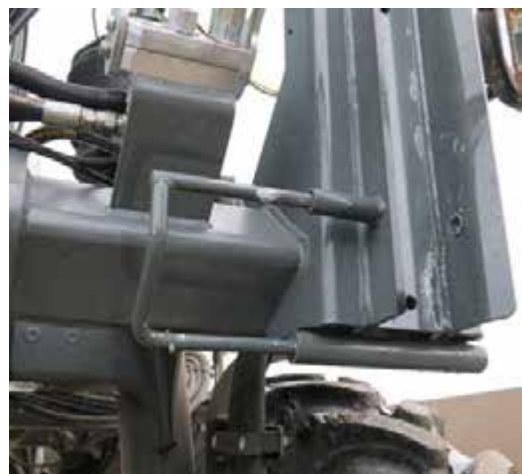
锁销 (位于机器左前侧和右前侧) - 典型视图 *展示解开位置
