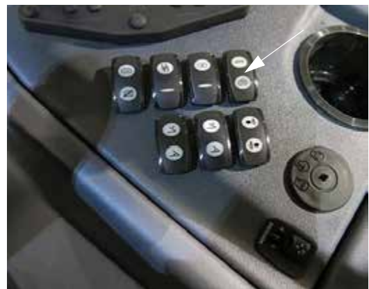
清洗开关 (位于侧控制台上) - 典型视图
