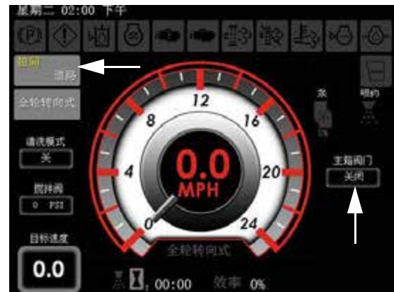
主箱阀门状态指示器 （位于机器显示屏主页 – 田间模式上） - 典型视图
