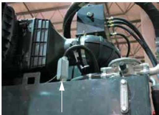
油位/温度传感器 (位于液压油箱的顶部) - 典型视图
