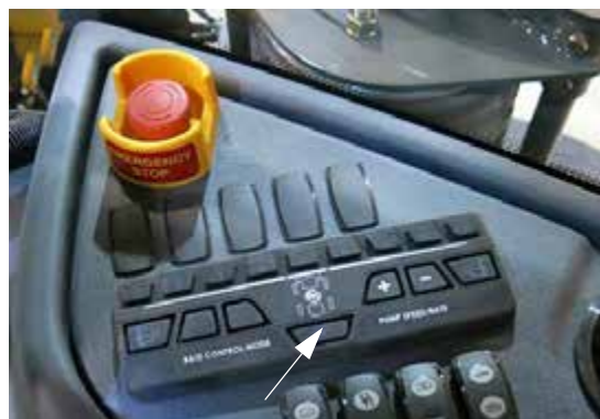
后喷嘴开关 (位于侧控制台上) - 典型视图
