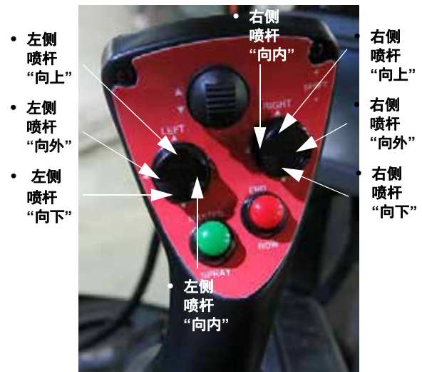
左侧和右侧喷杆开关 (位于静液压驱动控制柄上) - 典型视图
