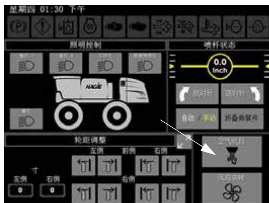
空气吹扫按钮 (位于辅助控制器页面上)
