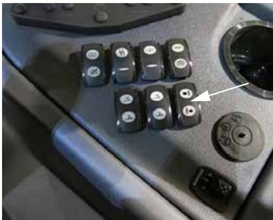
发泡器开关 (位于侧控制台上) - 典型视图
