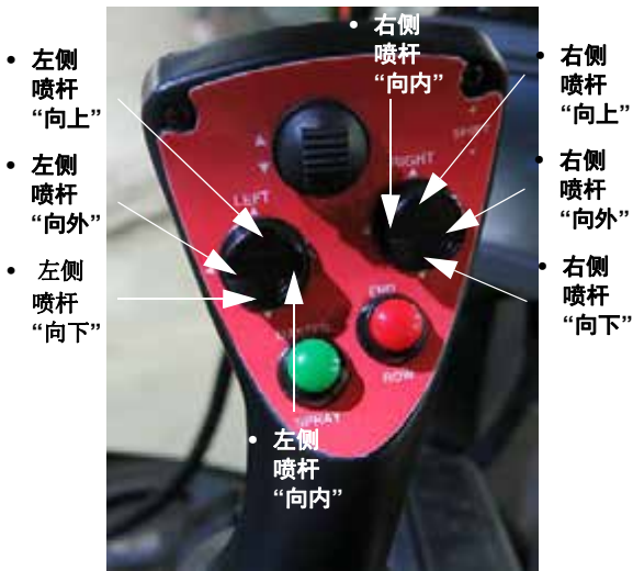
左侧和右侧喷杆开关 (位于静液压驱动控制柄上) - 典型视图
