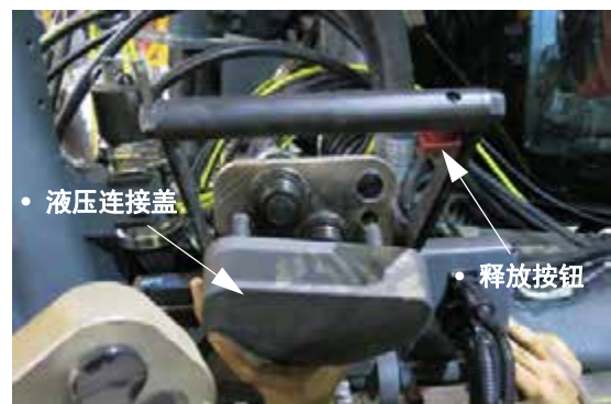
液压连接盖和释放按钮 (图示为机器右手侧) - 典型视图
