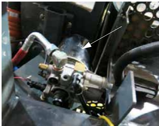
空气干燥器 （位于机器右侧之下） - 典型视图
