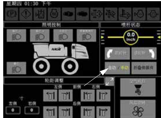
喷杆状态按钮 – 自动/手动 (位于机器显示屏辅助控制器页面上)
