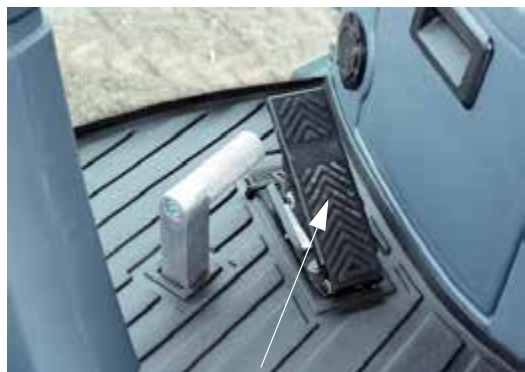
减速踏板 (位于转向柱的右下侧) - 典型视图
