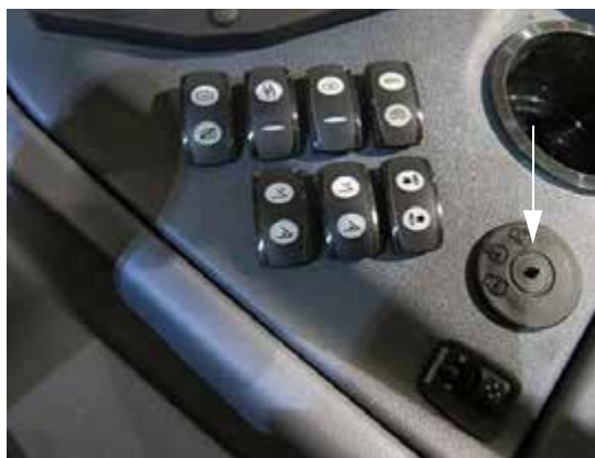
点火开关 (位于侧控制台上) - 典型视图
