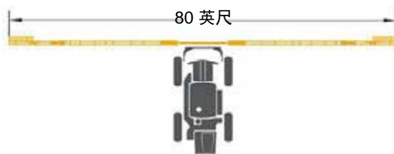
60/80/90 英尺的喷杆系统， 外侧伸展件手动向前折叠。
