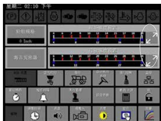
调节按钮 - 现场/道路模式速度设置 (位于设置页面上)
