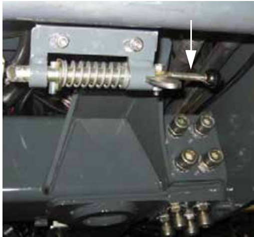
前加油口释放杆 (位于机器前端下方) - 典型视图
