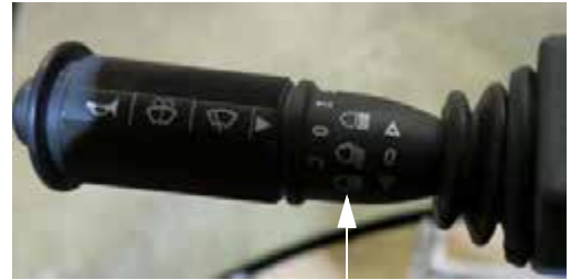
远光灯 (位于转向信号操纵杆上) - 典型视图
