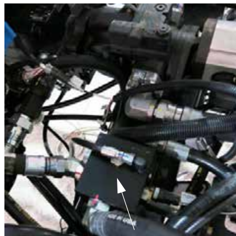
药液泵控制歧管 (位于机器中心附近) - 典型视图 * 机器上方的俯视图
