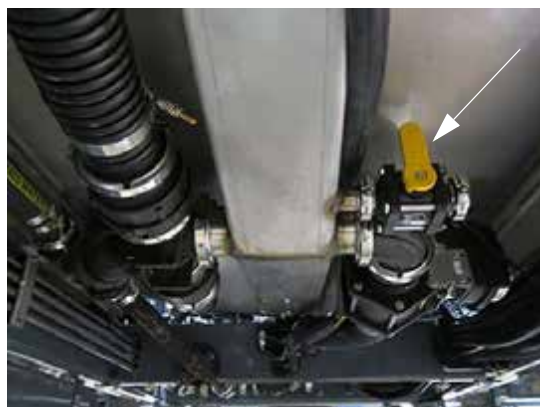
药液箱排液阀 (位于机器下面的药液箱的下方) - 典型视图
