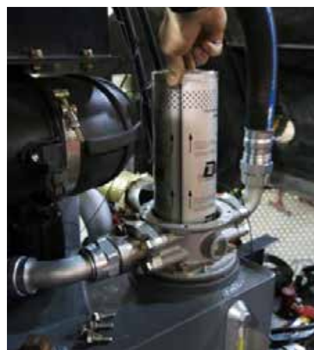
回油过滤器 (位于过滤器外壳内部) - 典型视图
