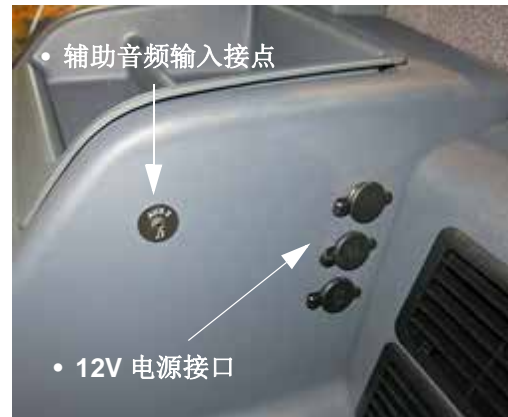
12 伏电源接口和 Aux 2 音频输入接点位于 侧控制台面板内侧 - 典型视图
