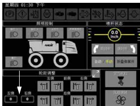
左/右胎面宽度指示器 - 后立腿 (位于机器显示屏辅助控制器页面上)
