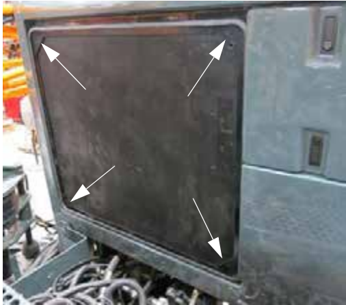
散热器护屏插销 (位于护屏每个拐角处) - 典型视图
