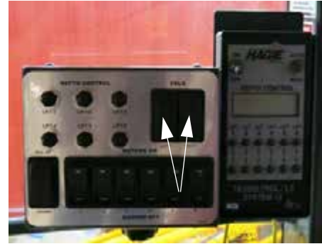
左/右折叠开关 （位于去雄控制面板上面） - 典型视图
