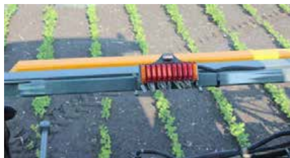
喷杆药液阀指示器 (位于连杆中央) - 典型视图
