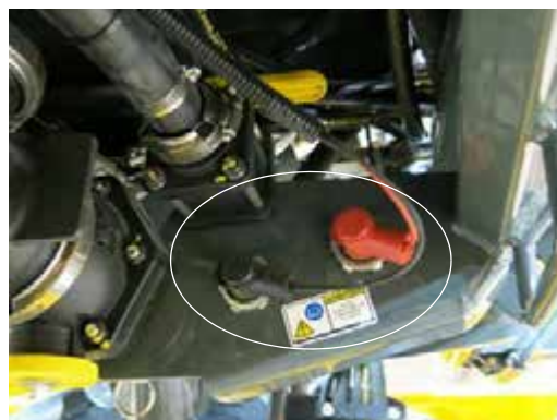
电源接口 (位于前加液口总成附近) - 典型视图
