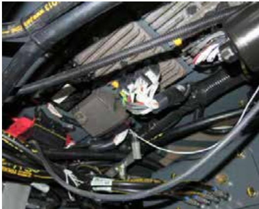
断路器/熔丝 (外部) (位于驾驶室下方 - 拆除面板 后可以够着) - 典型视图
