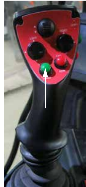
总喷药开关 (位于静液压驱动控制柄背面) - 典型视图
