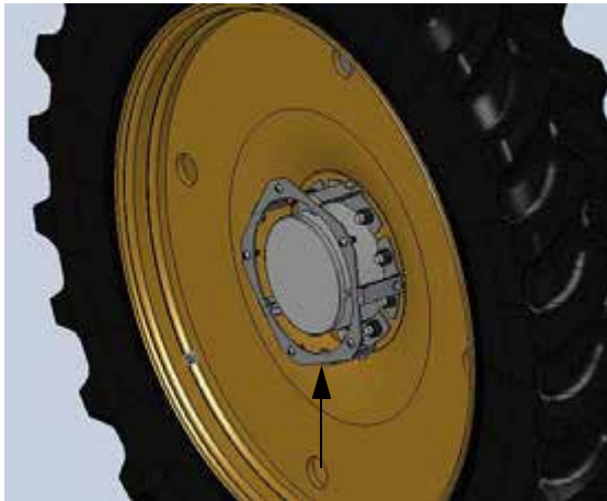
毂盖转接焊件 -典型视图
