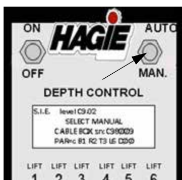
自动/手动开关 (位于 Tasseltr01 控制面板上)
