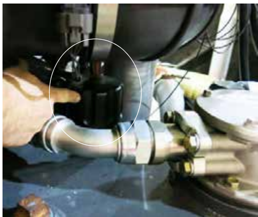
通气盖 (位于机器左手侧靠近回油过滤器外壳) - 典型视图
