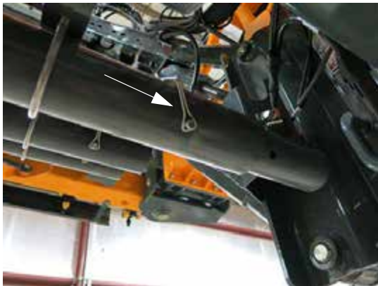
刷挡调整夹（位于每个管端） -典型视图
