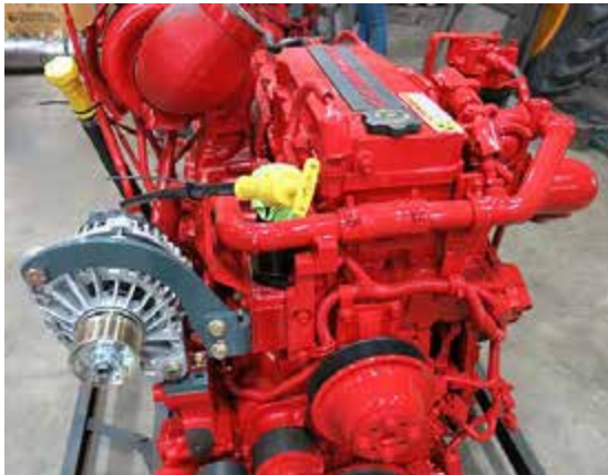
Tier 4 最终版排放标准的柴油发动机 (位于机器后侧附近 - 打开罩盖可以够着) - 典型视图
