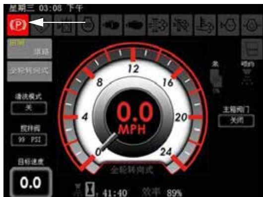
驻车制动器指示器 (位于每个机器显示屏页面的左上方)
