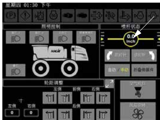
喷杆对准值 (位于辅助控制页面 右侧)
