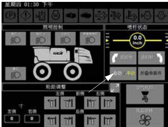
喷杆状态按钮 - 自动/手动 (位于机器显示屏辅助控制器页面)
