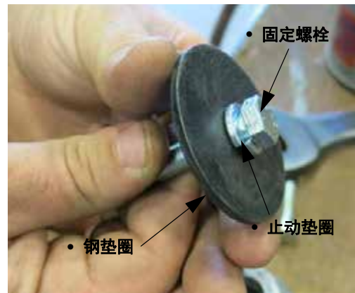
切刀螺栓/垫圈组件 - 典型视图
