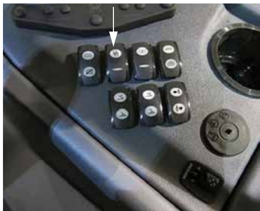
药液泵开关 (位于侧控制台上) - 典型视图
