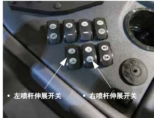
左/右喷杆伸展开关 (位于侧控制台上) - 典型视图
