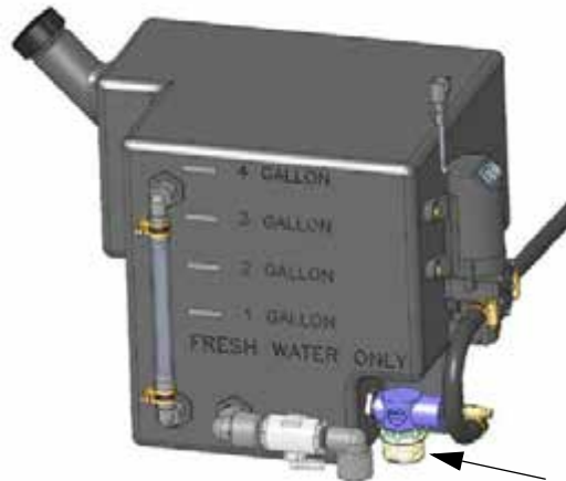
洗手水滤网 (位于靠近洗手水箱底部) - 典型视图
