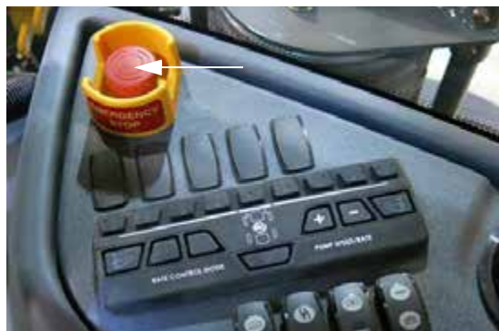
紧急停止开关 (位于侧控制台上) - 典型视图
