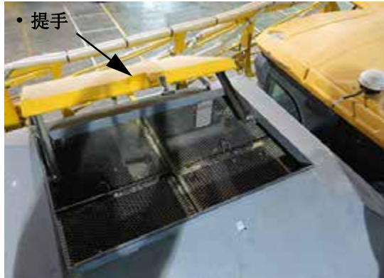
干燥箱箱盖 (打开位置如图所示) - 典型视图
