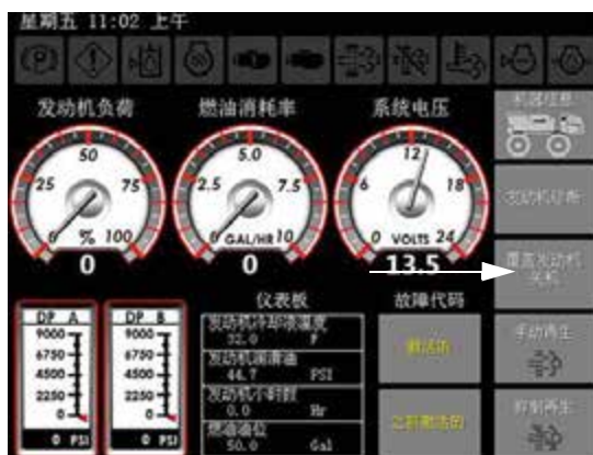
超驰发动机停机按钮 (位于机械诊断页面上)
