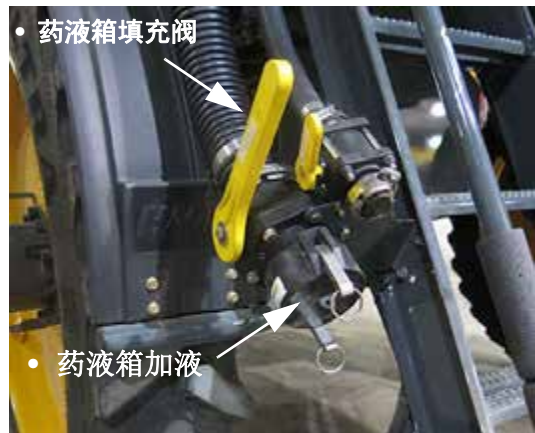
后加液口总成 (位于左后轮后面) - 典型视图
