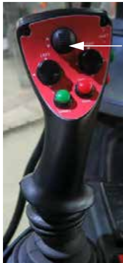
连杆开关- 向下 (位于静液压驱动控制柄上) - 典型视图
