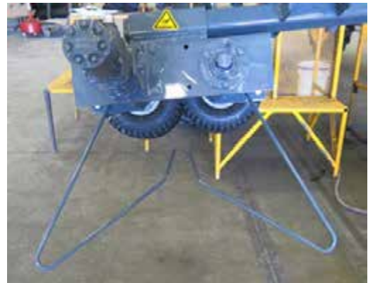
秸秆导向杆安装 - 典型视图
