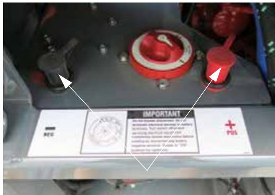
辅助电池充电接线柱 (位于后侧的主机架上) - 典型视图
