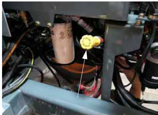
远程灌注发动机油 (位于机器左手侧 — 打开护罩后可以够着) - 典型视图
