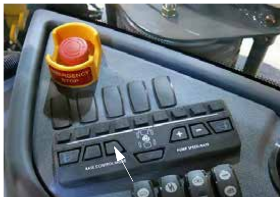
手动“MAN”速率控制开关 (位于侧控制台上) - 典型视图
