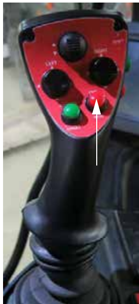
末行管理开关 (位于静液压驱动控制柄上) - 典型视图
