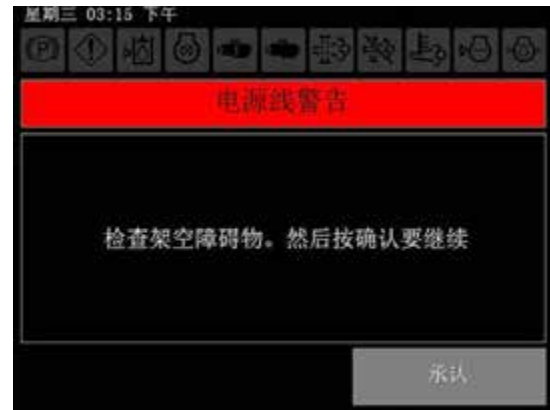
电线警告信息 (位于机器显示屏上)
