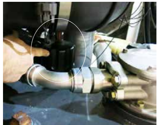
通气盖 (位于机器左侧回油过滤器外壳的附近) - 典型视图
