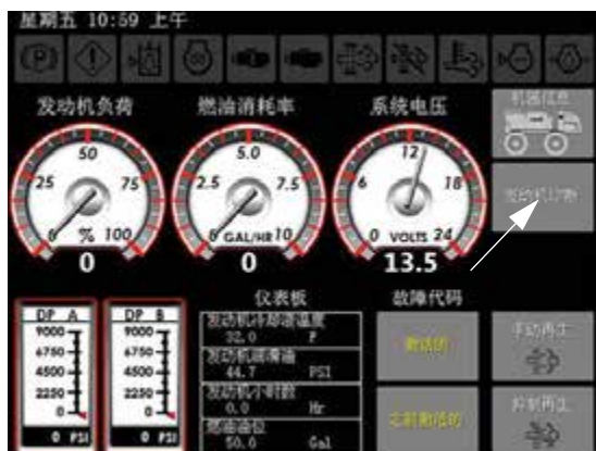
发动机诊断按钮 (位于机器诊断页面上)
