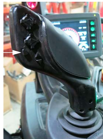
末行管理开关 (位于静液压驱动控制柄上) - 典型视图
