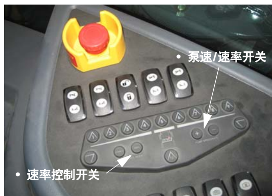
速率控制和 泵速/速率开关 (位于侧控制台上) - 典型视图
