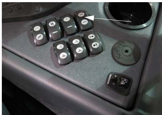
清洗开关 (位于侧控制台上) - 典型视图
