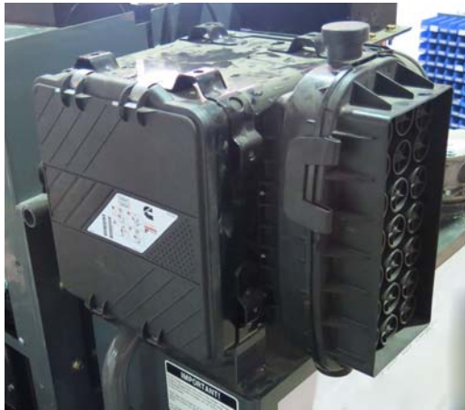
发动机进气过滤器 （位于机器左手侧通道—打开护罩后可以够着） - 典型视图
