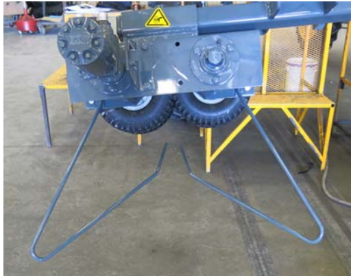
秸秆导向杆安装 - 典型视图
