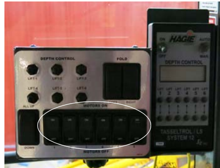
电机控制开关 (位于去雄控制面板上面) - 典型视图
