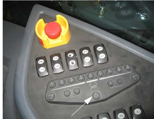
后喷嘴开关 (位于侧控制台上) - 典型视图
