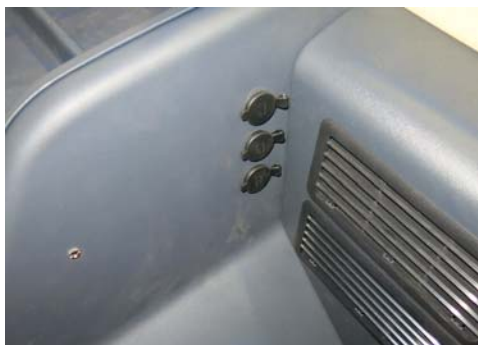
12V 电源接口 - 图示为典型安装
