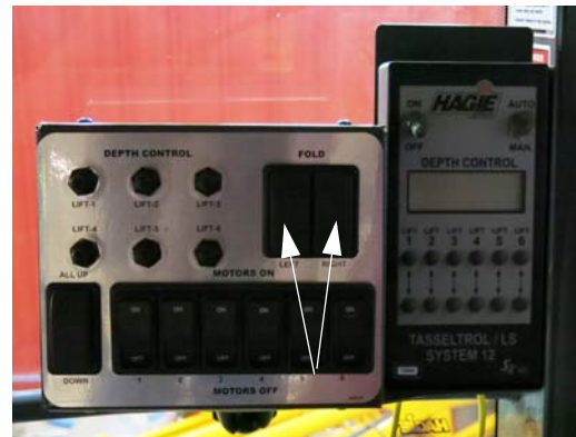
左/右折叠开关 （位于去雄控制面板上） - 典型视图
