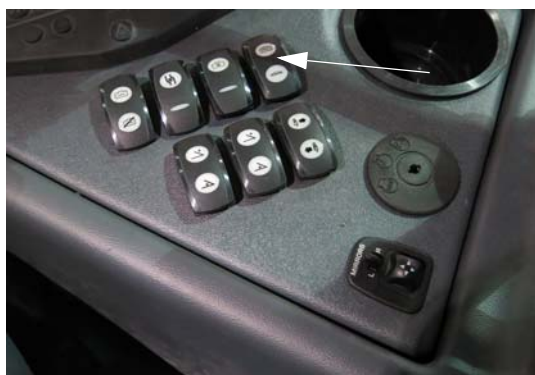
清洗开关 (位于侧控制台上) - 典型视图
