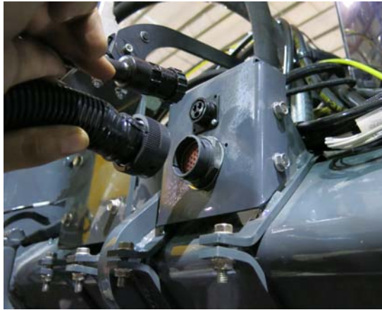
电气连接 (图示机器右手侧) - 典型视图
