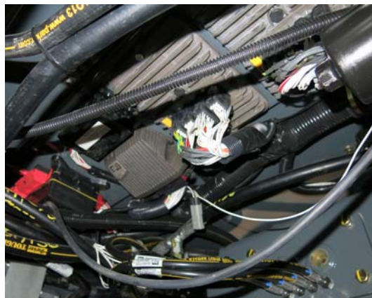
断路器/熔丝 (外部) (位于驾驶室下方 - 拆除面板后 后可以够着) - 典型视图
