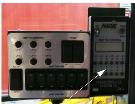
Tasselrol/LS System 12 控制面板 - 典型视图
