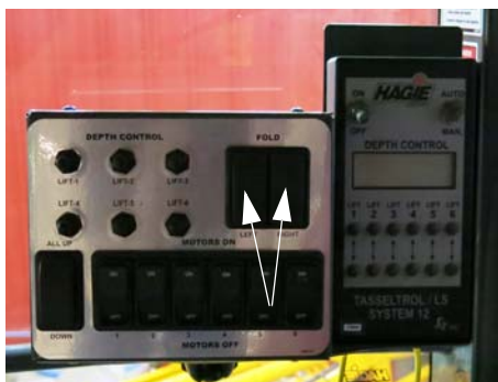
左/右折叠开关 (位于去雄控制面板上) - 典型视图
