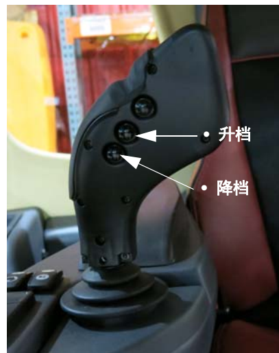
升档/降档开关 （位于静液压驱动控制柄的背侧） - 典型视图
