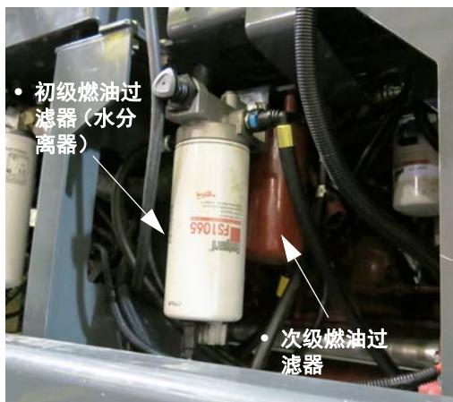
初级和次级燃油过滤器 (位于沿机器左手侧) - 典型视图
