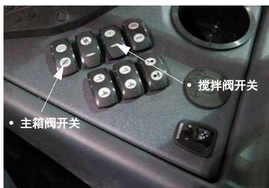
主箱和搅拌阀开关 (位于侧控制台上) - 典型视图
