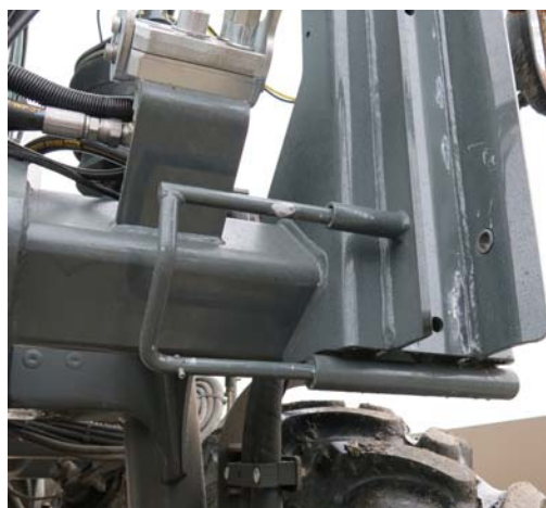
锁销 (位于机器左前侧和右前侧) - 典型视图 *展示解开位置
