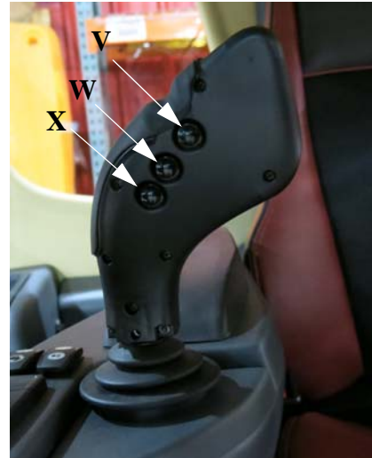
静液压驱动控制柄 “后视图” - 典型视图
