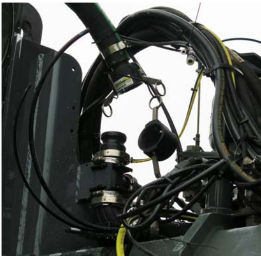
药液连接 （位于机器右前侧） - 典型视图
