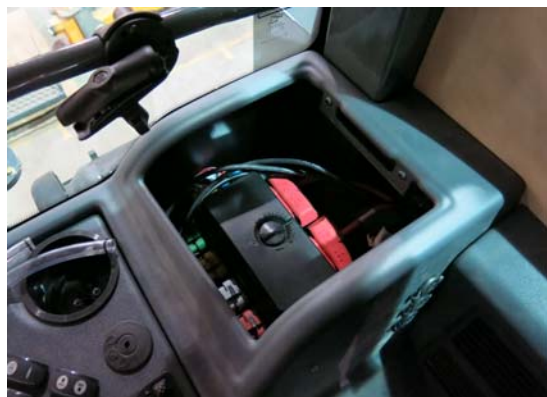
断路器/熔丝（内部） （位于侧控制台的后侧 – 拆除托 盘后可以够着） - 典型视图
