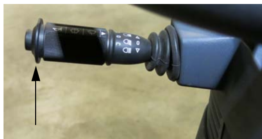
挡风玻璃洗涤器开关 (位于转向信号操纵杆的端部) - 典型视图
