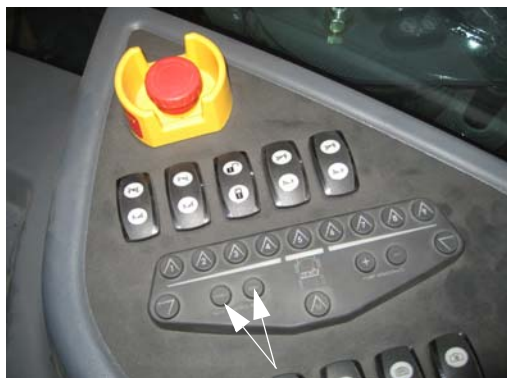
速率控制开关 (位于侧控制台上) - 典型视图
