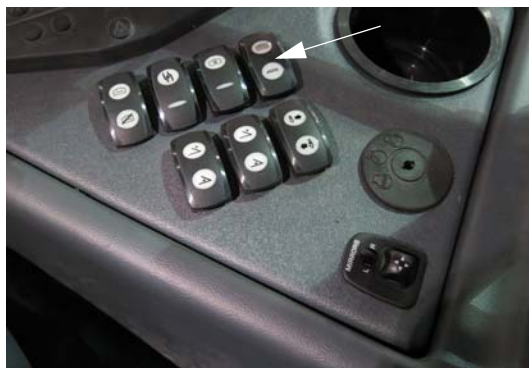
清洗开关 （位于侧控制台上） - 典型视图
