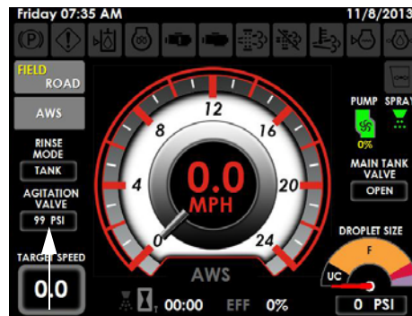
搅拌阀压力指示器 （位于机器显示屏主页 – 现场模式上）
