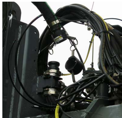
药液连接 (位于机器右前侧) - 典型视图
