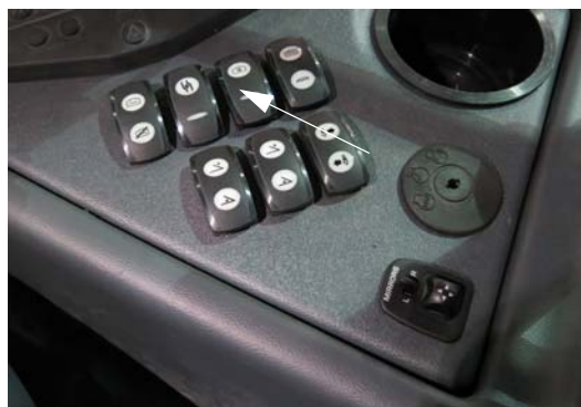
搅拌阀开关 (位于侧控制台上) - 典型视图
