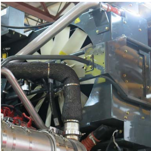
可逆转风扇 (位于机器后侧附近 - 打开罩盖可以够着) - 典型视图
