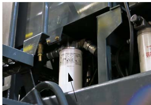
箱体排油过滤器 (位于机器左手侧) - 典型视图
