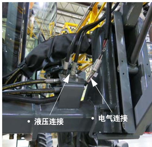
液压/电气连接 - “标准” (位于机器左前侧) - 典型视图
