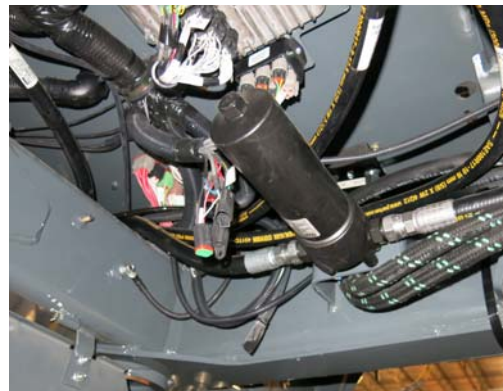
压力式过滤器 (位于机器右手侧 - 降低金属护板可以够着) - 典型视图
