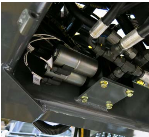
歧管阀 (位于机器的下方) - 典型视图
