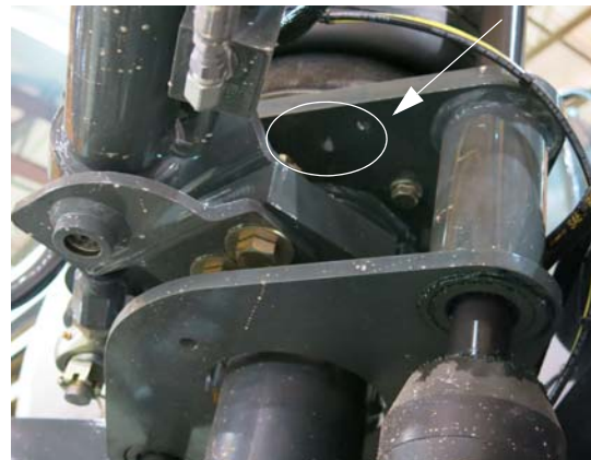
衬圈润滑脂加油嘴 (位于每个气囊座板之下) - 典型视图
