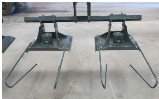
秸秆导向杆安装 - 典型视图
