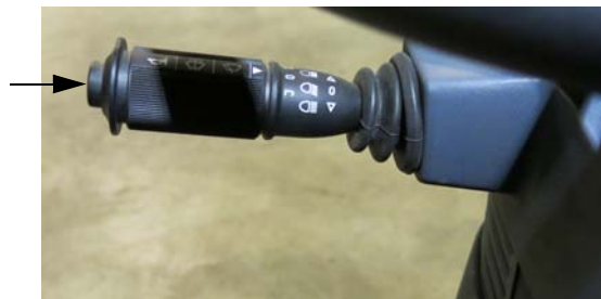
喇叭按钮 (位于转向信号操纵杆的端部) - 典型视图
