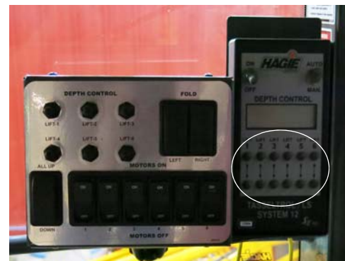
向上提升/下降开关 (位于 Tasselrol 控制面板) - 典型视图
