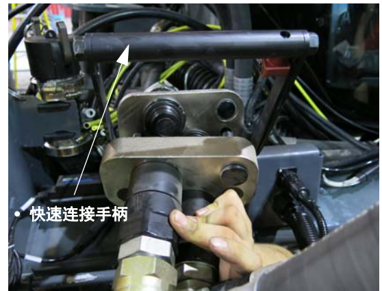
液压多功能联结器总成 (图示机器右手侧) - 典型视图
