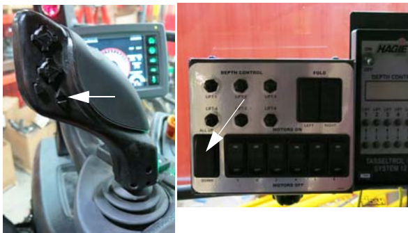
全部上升/下降开关 (位于静液压驱动控制柄或去雄控制面板上) - 典型视图
