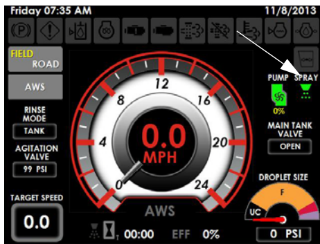
主喷药指示器 (位于机器显示屏主页 - 现场模式右上侧)
