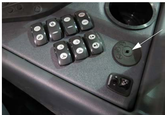
点火开关 (位于侧控制台上) - 典型视图
