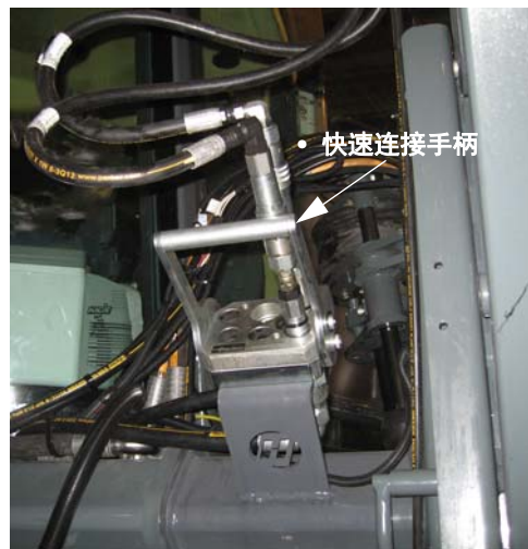
液压/电力多功能联结器总成 - “如已配置” (位于机器左前侧)
