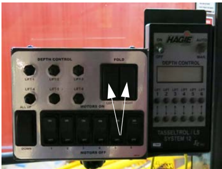
左/右折叠开关 (位于去雄控制面板上面) - 典型视图
