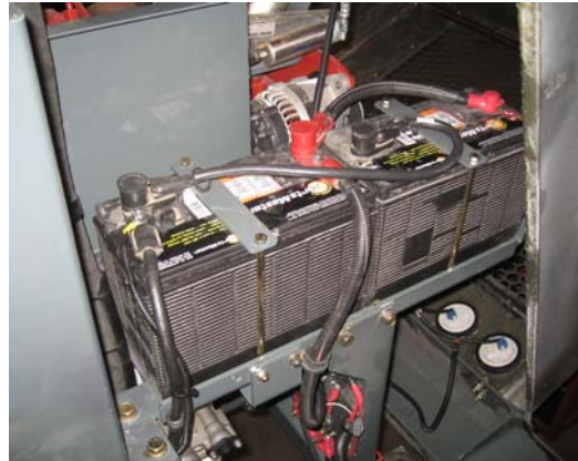
电池入口 (位于机器左手侧 – 打开罩盖可以够着) - 典型视图
