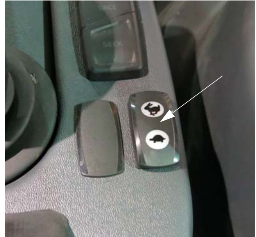
油门开关 (位于靠近静液压驱动控制柄) - 典型视图
