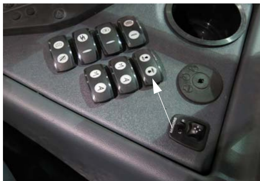
发泡器开关 (位于侧控制台上) - 典型视图
