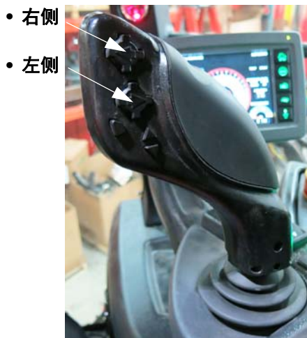
左侧和右侧喷杆开关 （位于静液压驱动控制柄上） - 典型视图
