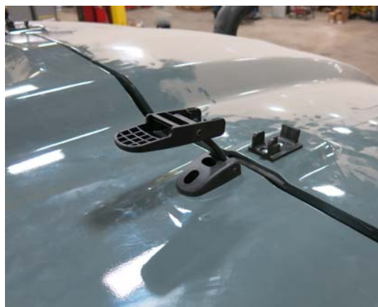
罩锁扣 (2) (位于顶罩两侧) - 典型视图
