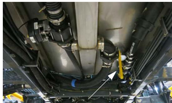
液箱阀 (位于机器右手侧药液箱下方) -典型视图
