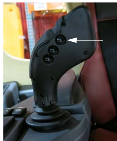
主喷药开关 (位于静液压驱动控制柄背面)
