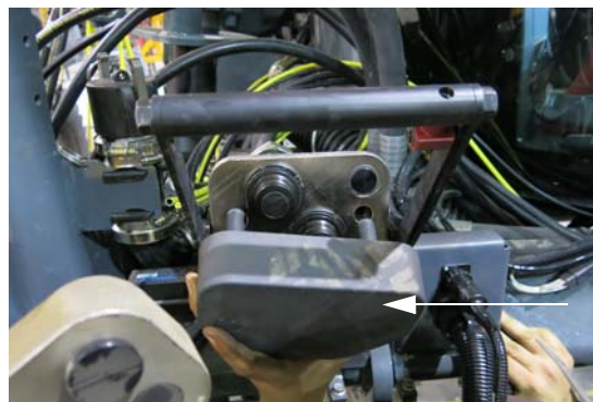
液压连接盖 (图示机器右手侧) - 典型视图
