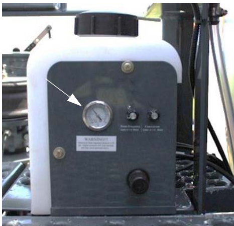
泡沫压力表 (位于发泡器箱侧边， 安装于机器右侧) - 典型视图
