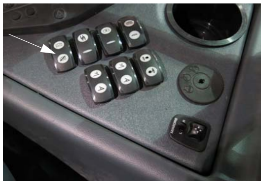
主箱阀门开关 (位于侧控制台上) - 典型视图
