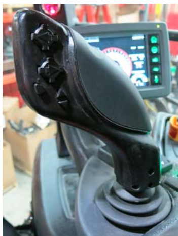
静液压驱动控制柄 (位于侧控制台上) - 典型视图
