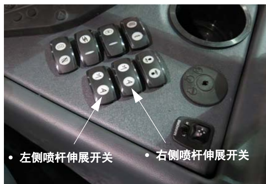
左/右喷杆伸展开关 (位于侧控制台上) - 典型视图
