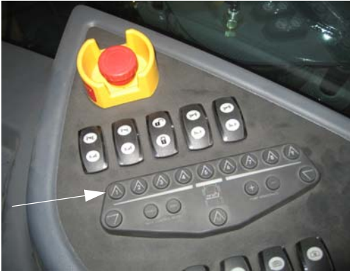
喷杆药液阀开关 (位于侧控制台上) - 典型视图
