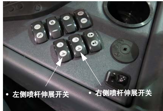
左/右喷杆伸展开关 (位于侧控制台上) - 典型视图
