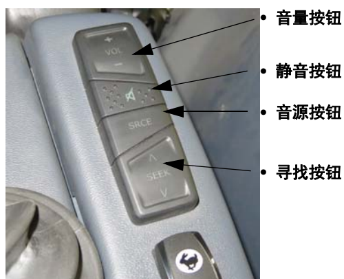
远程立体声系统控制器 (位于静液压驱动控制柄的附近) - 典型视图
