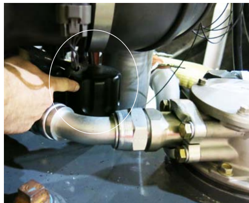
通气盖 (位于机器左手侧回油过滤器外壳的附近) - 典型视图
