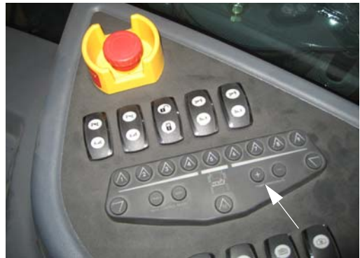
“+”泵速/速率开关 (位于侧控制台上) - 典型视图
