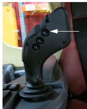
主喷药开关 (位于静液压驱动控制柄背面) - 典型视图
