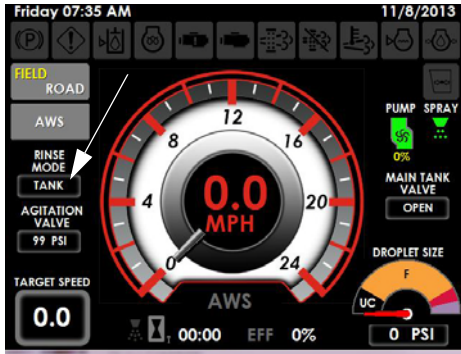
清洗模式指示器 (位于机器显示屏主页 - 现场模式上)
