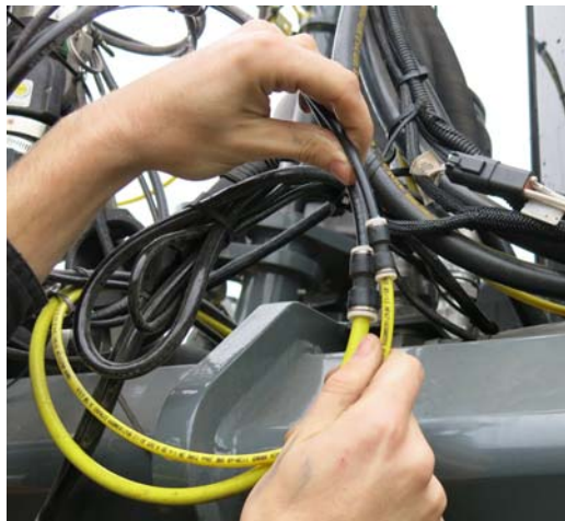
发泡器连接 (位于机器右前侧) - 典型视图
