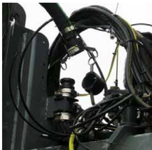
Permetezőszer vezeték csatlakoztatása (a gép elülső jobb oldalánál helyezkedik el) –Tipikus nézet
