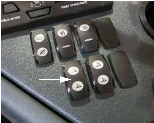
Gém/NTB toldalék kapcsoló (oldalkonzolon) - Tipikus nézet
