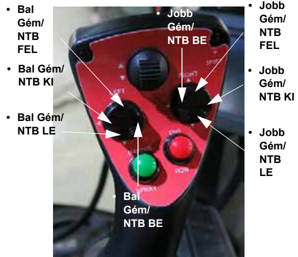
Bal és jobb gém/NTB kapcsolók (a hidrosztatikus vezérlést irányító karon) - Tipikus nézet
