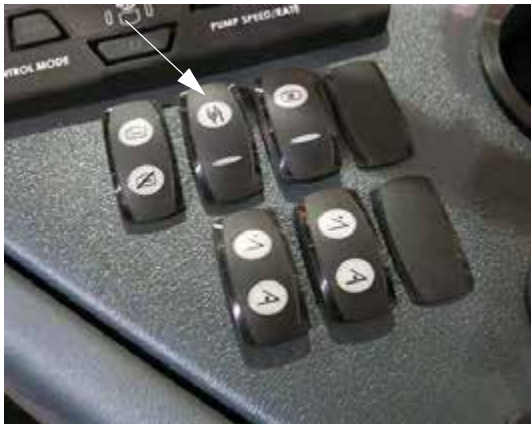
Permetlé szivattyú kapcsolója (oldalsó vezérlőpulton) - Tipikus nézet
