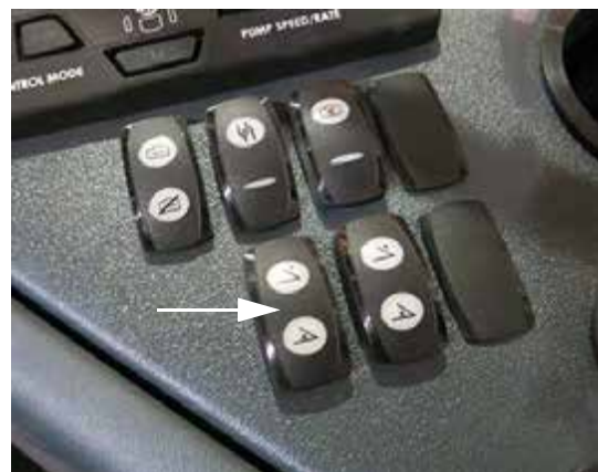
Gém/NTB toldalék kapcsoló (oldalkonzolon) - Tipikus nézet
