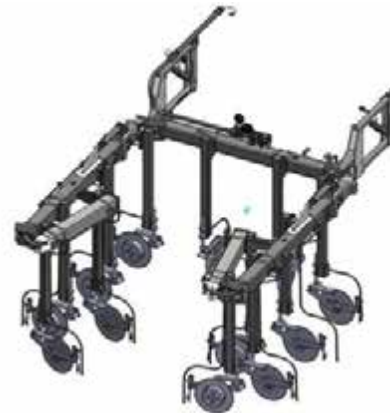
40 láb hosszú NTB csuklópontjai (Behajtott pozíciót mutatja) - Tipikus nézet
