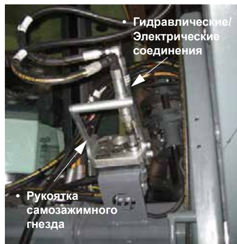
Узел комбинированной гидроэлектрической муфты (расположен на передней левой стороне машины) – стандартный вид
