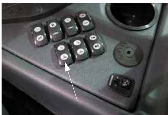
Переключатель выдвижения штанги/ Инструментальной оправки для азота (расположен на боковой панели) – стандартный вид
