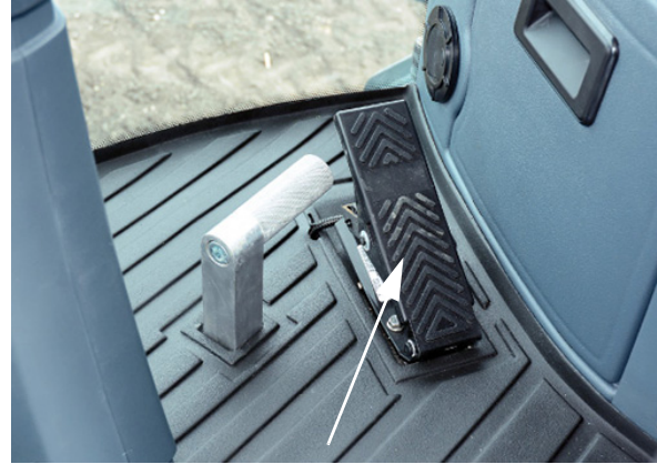
Pedal de desaceleración (ubicado en el lado inferior derecho de la columna la dirección) -Vista típica
