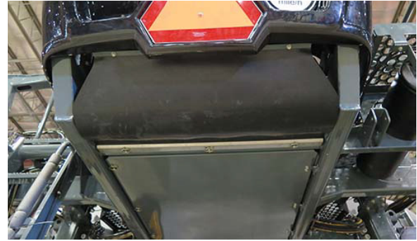
Instalación de cortina de escobillas -Vista típica
