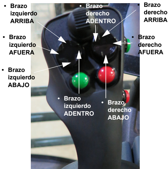
Interruptores de los brazos izquierdo y derecho (ubicados en la manilla de control de la transmisión hidrostática) - Vista típica
