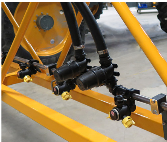
Tamices de sección (ubicados a lo largo de cada sección del brazo) -Vista típica
