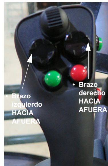
Interruptores del brazo izquierdo y derecho (ubicados en la manilla de control de la transmisión hidrostática) - Vista típica
