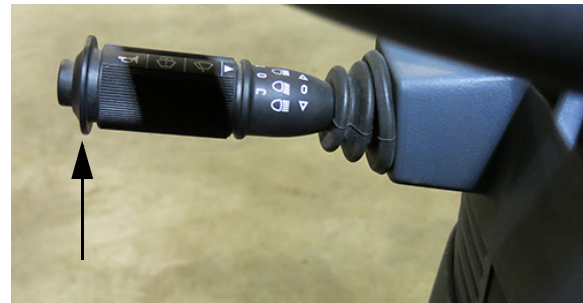
Botón del lavaparabrisas (ubicado en el extremo final de la palanca de luces direccionales) -Vista típica
