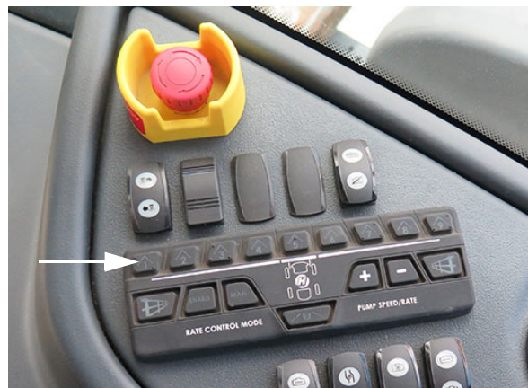
Interruptores de las válvulas de solución del brazo (ubicados en la consola lateral) - Vista típica
