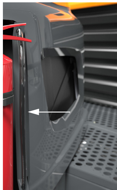
Visor del tanque de lavado (ubicado a un lado del tanque de lavado) -Vista típica
