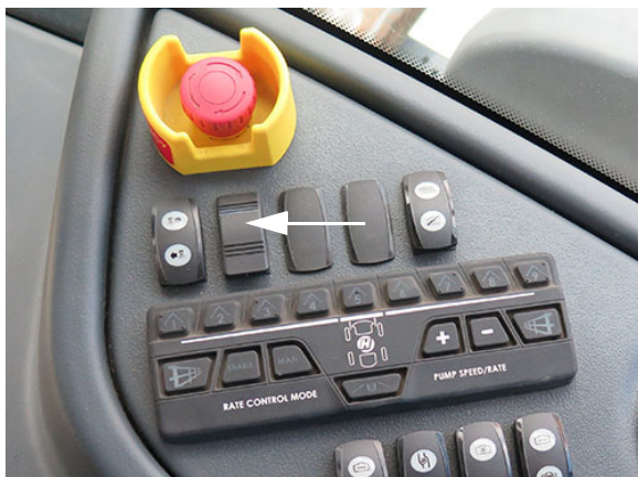
Interruptor de luces de plataforma (ubicado en la consola lateral) - Vista típica
