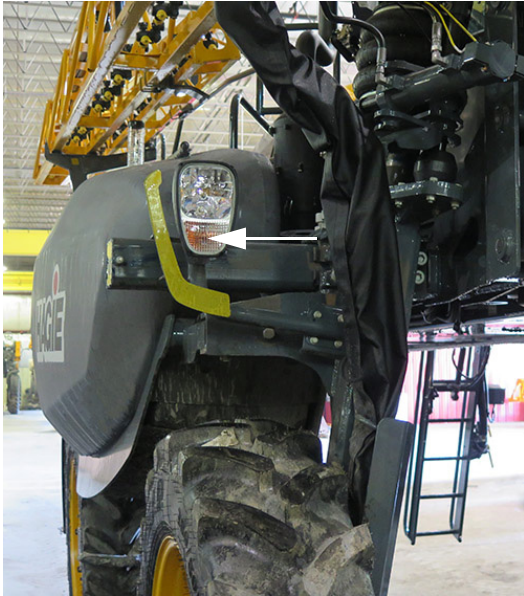
Luces intermitentes delanteras de peligro/advertencia (2) -Vista típica
