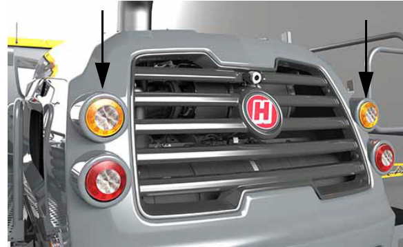
Luces intermitentes traseras de peligro/advertencia (2) -Vista típica
