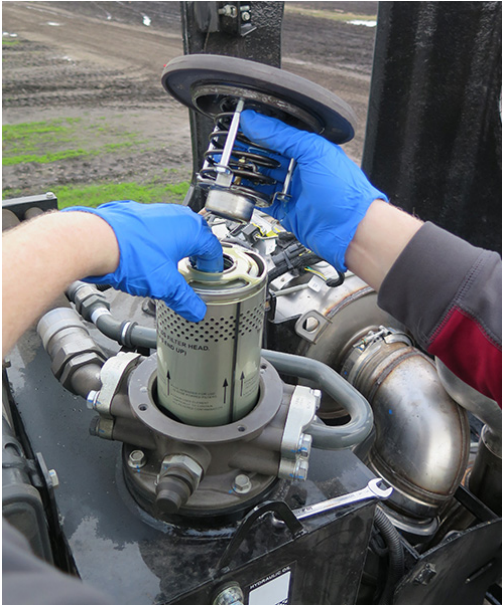
Filtro de retorno (ubicado dentro del alojamiento del filtro encima del depósito de aceite hidráulico, abra el capó para tener acceso) -Vista típica
