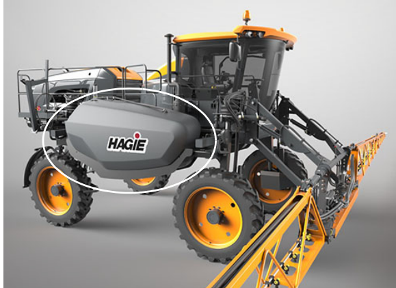
Tanque de solución -Vista típica
