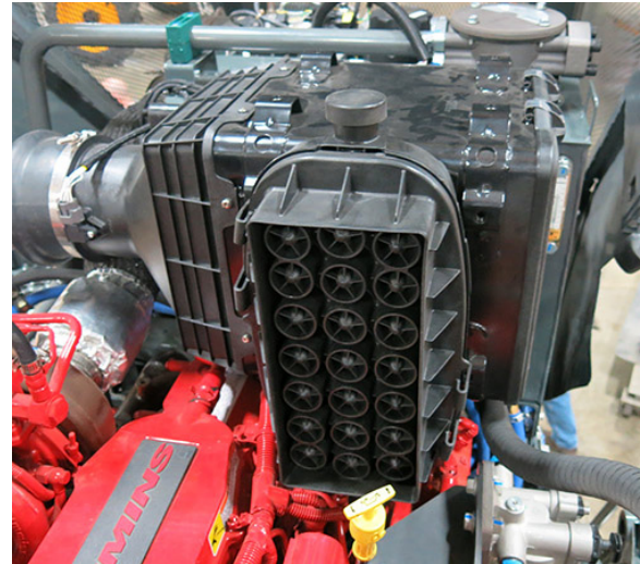
Filtro de admisión de aire del motor filtro (ubicado a lo largo de la plataforma en el lado izquierdo de la máquina - abra el capó para tener acceso) -Vista típica
