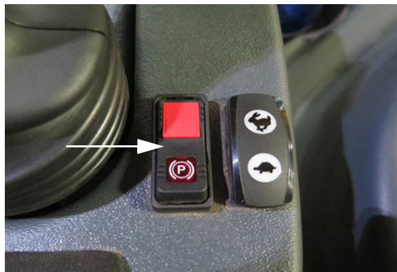
Interruptor del freno de estacionamiento (ubicado cerca de la manilla de control de la transmisión hidrostática) -Vista típica
