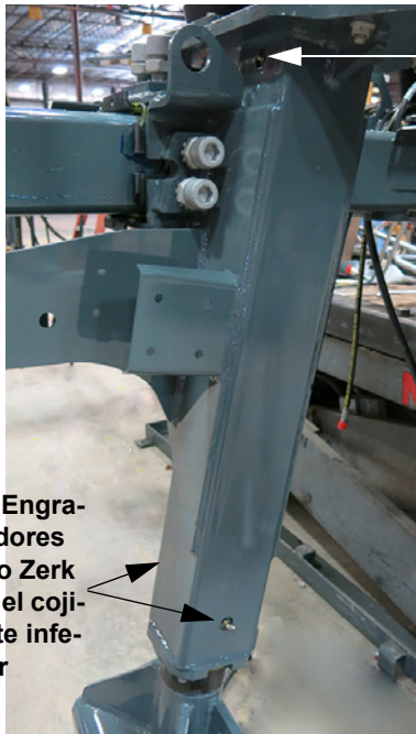
Engrasadores tipo Zerk en los cojinetes de las patas -Vista típica
