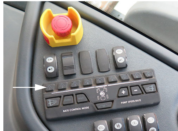
Interruptores de las válvulas de solución de los brazos (ubicados en la consola lateral) -Vista típica
