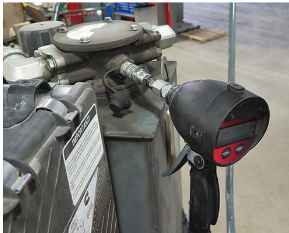
Llenado del tanque a través del puerto de llenado de aceite hidráulico -Vista típica
