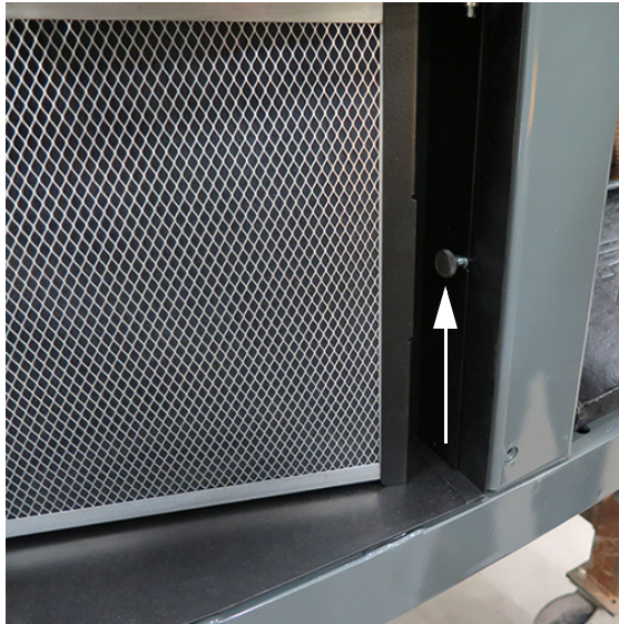
Tornillo de seguridad (Ubicado a lo largo del interior del compartimento del filtro) -Vista típica
