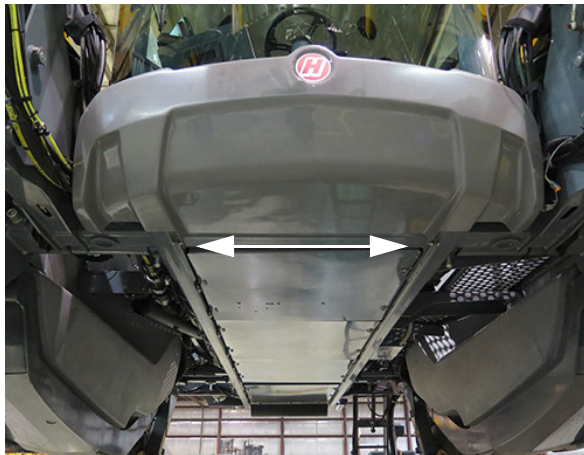
Tuercas/pernos de montaje (2) (ubicados debajo del extremo delantero de la máquina) -Vista típica
