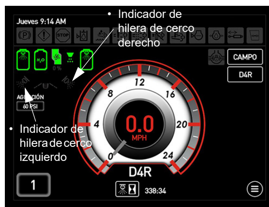
Indicadores de hilera de cerco – izquierdo/derecho (ubicados en la página principal de la pantalla de la máquina – modo de campo)
