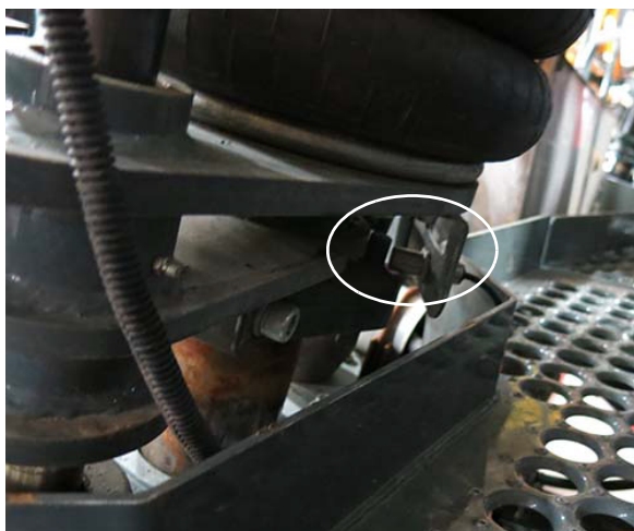
Sensor de proximidad externo -Vista típica
