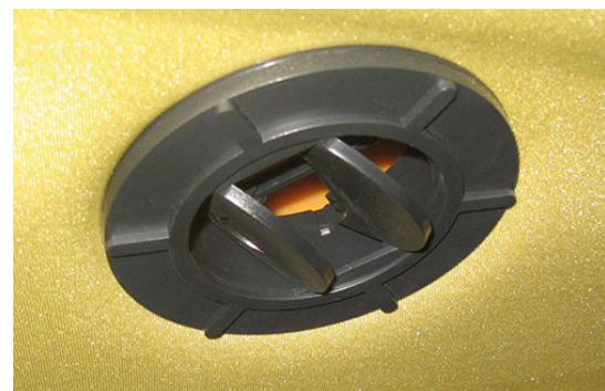
Conducto de ventilación de cabina -Vista típica
