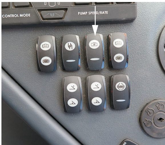
Interruptor de la válvula de agitación (ubicado en la consola lateral) -Vista típica
