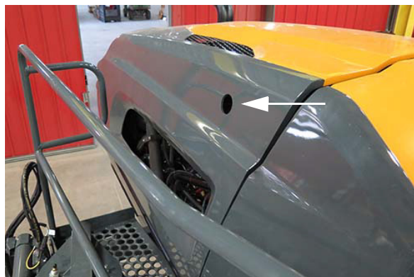
Visor de nivel de refrigerante (ubicado en la parte posterior derecha de la máquina) -Vista típica
