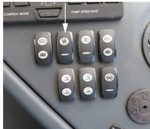
Interruptor de la bomba de solución (ubicado en la consola lateral) -Vista típica
