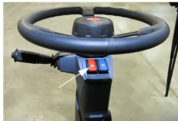
Interruptor de luces de peligro/advertencia (ubicado en la columna de dirección) -Vista típica
