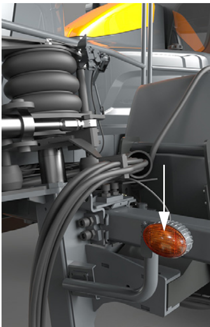
Luces intermitentes traseras de peligro/advertencia (2) -Vista típica
