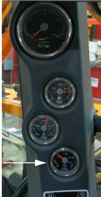
Medidor de DEF (ubicado en la columna A de la cabina) -Vista típica
