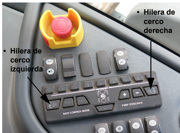
• Hilera de cerco izquierda • Hilera de cerco derecha Interruptores de hilera de cerco - Izquierda/derecha (ubicados en la consola lateral) -Vista típica
