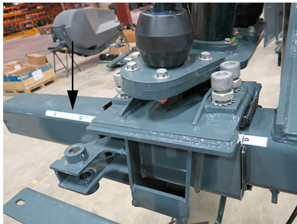
Indicador de ajuste de la distancia entre neumáticos (ubicado en la corredera deslizante) - Vista típica
