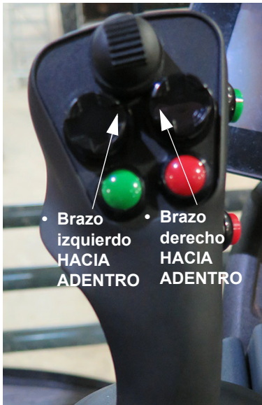
Interruptores de los brazos izquierdo y derecho (ubicados en la manilla de control de la transmisión hidrostática) - Vista típica
