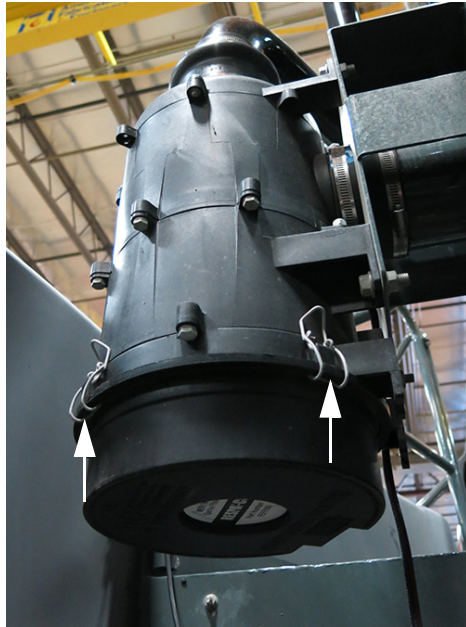
Retenes del filtro -Vista típica
