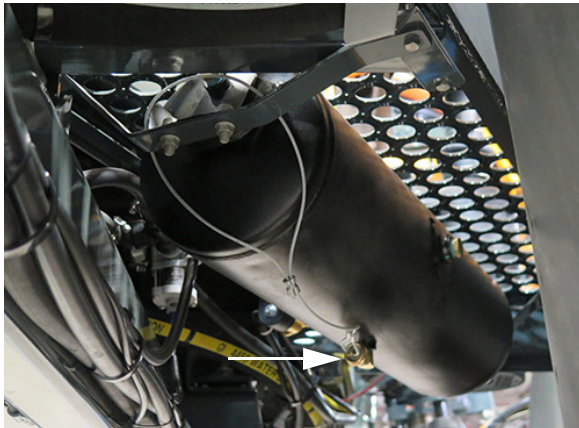
Válvula de drenaje del tanque (Purga de aire) (ubicada debajo de la plataforma cerca del lado derecho central de la máquina) * Hale HACIA ABAJO para abrir -Vista típica
