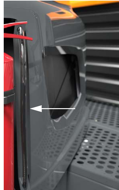
Jauge de niveau du réservoir de rinçage (située sur le côté du réservoir de rinçage) - Vue typique
