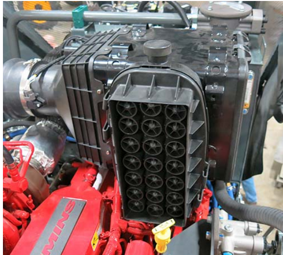
Filtre de l'admission d'air du moteur (situé le long de la plate-forme sur le côté gauche de la machine - ouvrez le capot pour y accéder) - Vue typique
