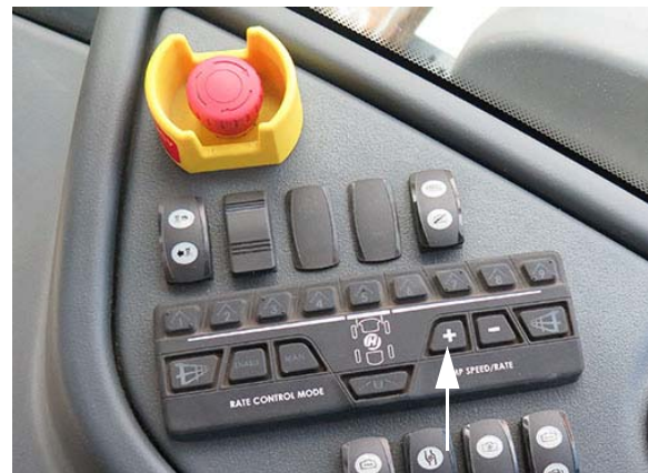
Commutateur « + » de vitesse de la pompe/du débit d'application (situé sur la console latérale) - Vue typique
