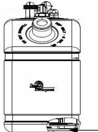
Crépine d'aspiration du fluide d'échappement diesel (située près du fond du réservoir de fluide d'échappement diesel) - Vue typique
