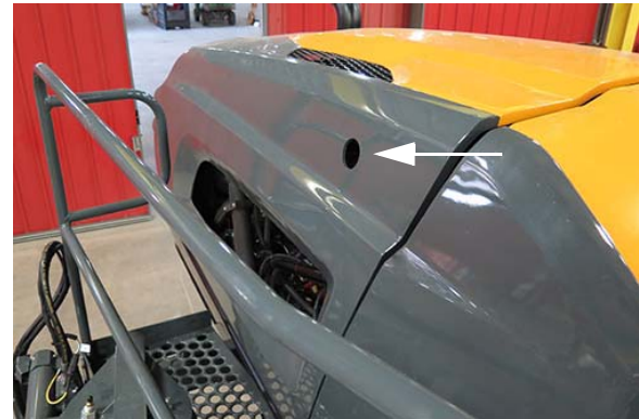
Jauge de niveau du liquide de refroidissement (située dans la partie arrière droite de la machine) - Vue typique
