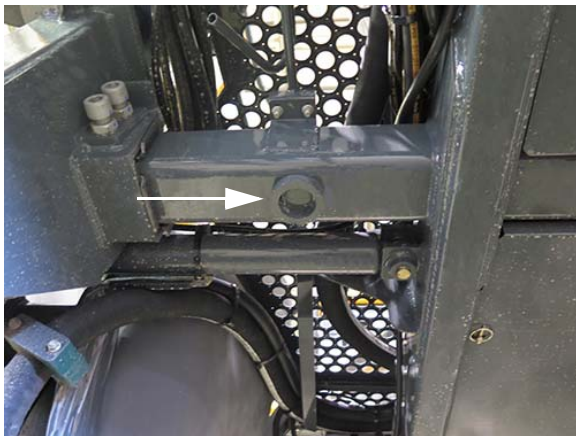
Anneau de rétention du point de levage (situé sur le châssis, près de chaque jambe) - Vue typique
