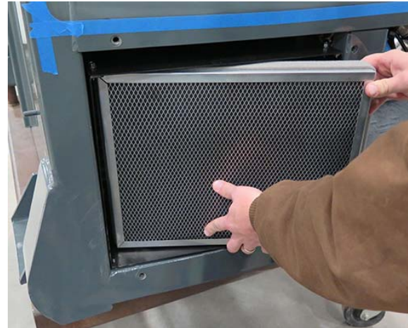
Filtre à charbon actif - Vue typique
