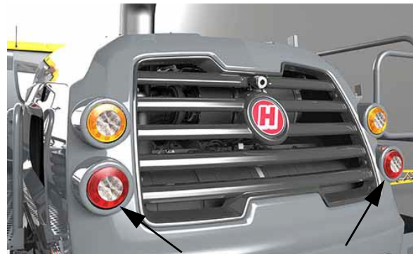
Feux arrière (2) - Vue typique
