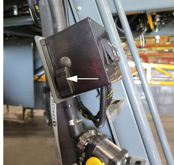
Interrupteur des projecteurs de la plate-forme (situé sur le boîtier de commutation, près de l'échelle) - Vue typique
