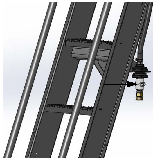
Vanne de lave-mains (échelle) - Vue typique
