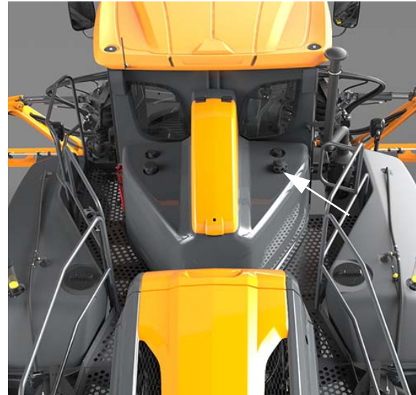
Bouchon de remplissage de carburant (situé sur le haut du module de rinçage du carburant) - Vue typique
