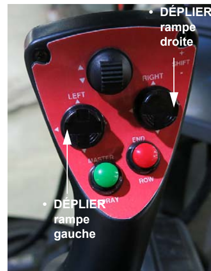
Commutateurs des rampes gauche/droite (situés sur le levier de commande de l'entraînement hydrostatique) - Vue typique
