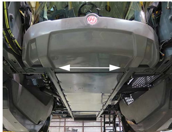
Écrous/boulons de fixation (2) (situés sous la partie avant de la machine) - Vue typique
