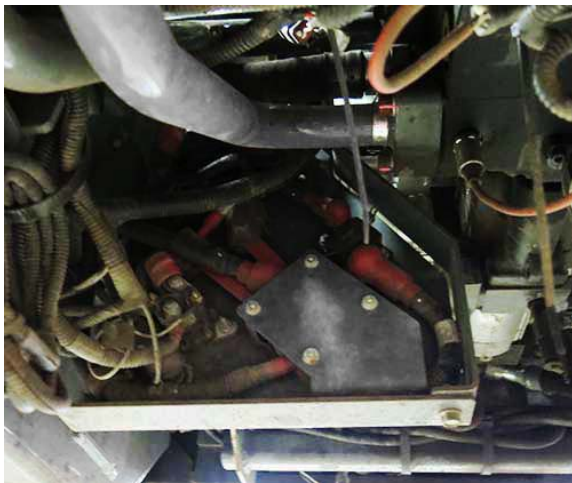
Bloc de fusibles et relais du moteur Tier 4 Final (situé en dessous de la batterie, dans la partie arrière droite de la machine) - Vue typique
