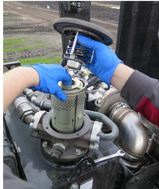
Filtre de retour (Situé à l'intérieur du boîtier de filtre, sur le dessus du réservoir d'huile hydraulique - ouvrez le capot pour y accéder) - Vue typique
