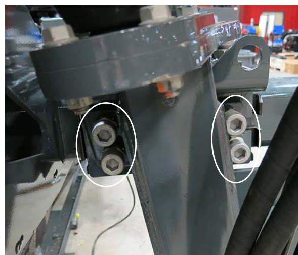
Boulons du palier de réglage de la voie - haut/côté (situés sur chaque jambe de la machine) - Vue typique
