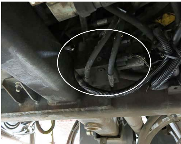
Collecteur de commande des vannes (situé sur le dessous de la machine) - Vue typique
