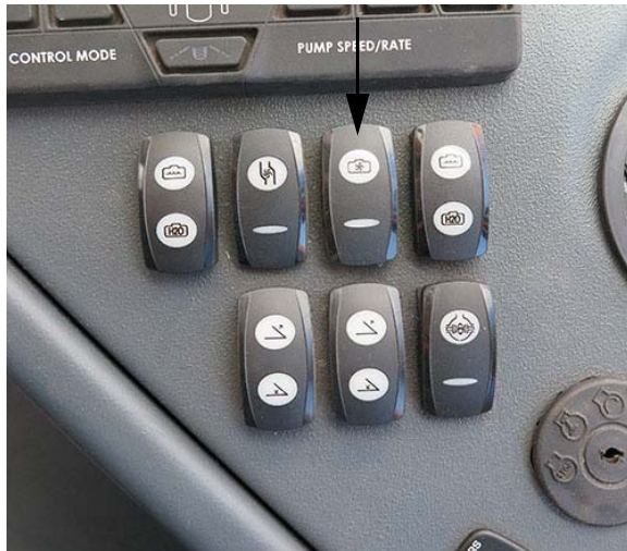
Commutateur de la vanne de brassage (situé sur la console latérale) - Vue typique
