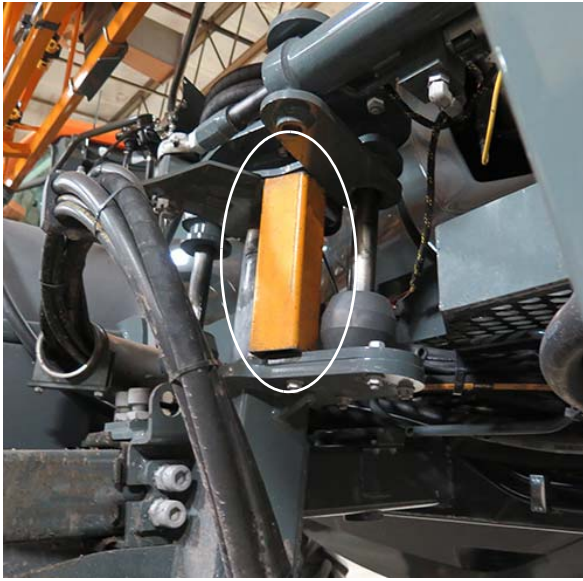
Tube en acier installé en dessous de la plaque de montage du coussin d'air - Vue typique
