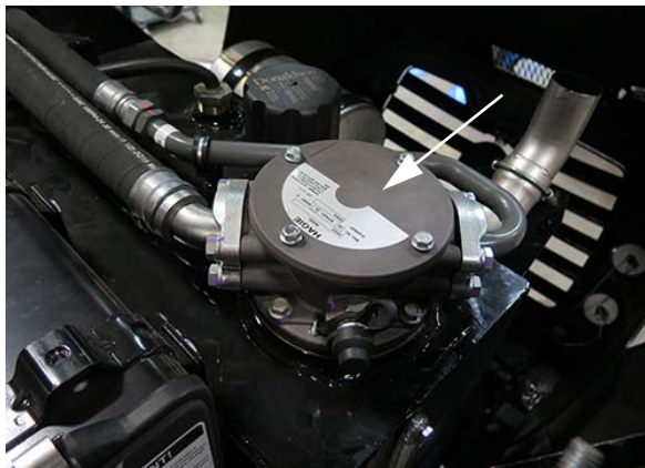
Boîtier du filtre de retour (situé sur le dessus du réservoir d'huile hydraulique) - Vue typique
