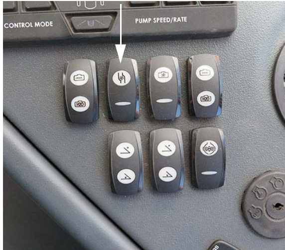
Interrupteur de la pompe à solution (situé sur la console latérale) - Vue typique
