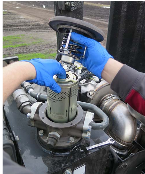
Filtre de retour (situés à l'intérieur du boîtier de filtre à air, sur le dessus du réservoir d'huile hydraulique) - Vue typique
