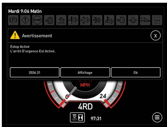
Message d'avertissement de bouton d'arrêt d'urgence activé (situé sur l'afficheur de la machine)
