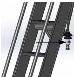
Vanne de lave-mains (sur l'échelle) - Vue typique
