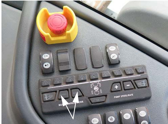
Commutateurs de contrôle du dosage (situés sur la console latérale) - Vue typique
