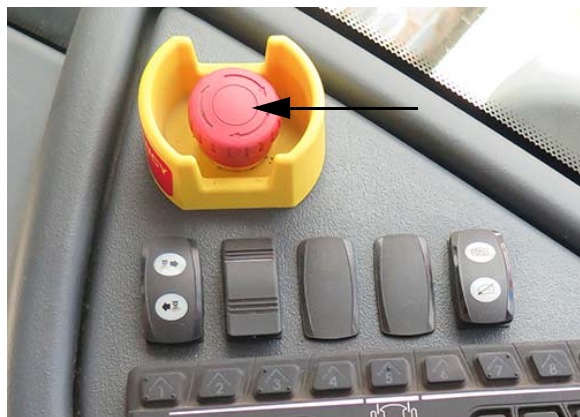
Bouton d'arrêt d'urgence (situé sur la console latérale) - Vue typique
