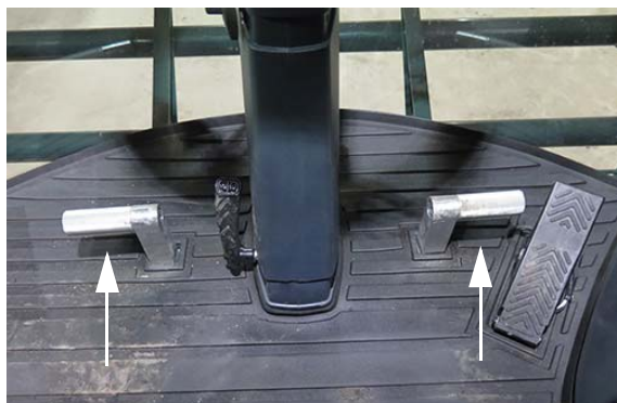
Repose-pieds (situés de chaque côté de la colonne de direction) - Vue typique
