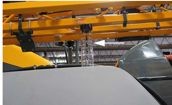
Jauge de niveau du réservoir de solution (2) (située en haut de chaque réservoir de solution) - Vue typique
