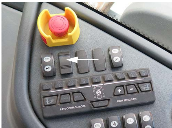
Interrupteur des projecteurs de la plate-forme (situé sur la console latérale) - Vue typique
