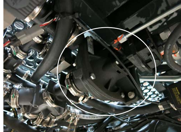
Pompe à solution (située sous la partie centrale de la machine) - Vue typique
