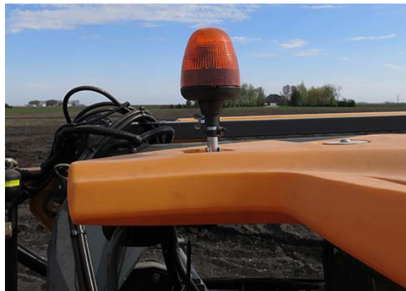
Gyrophare (situé sur la partie avant du toit de la cabine) - Vue typique
