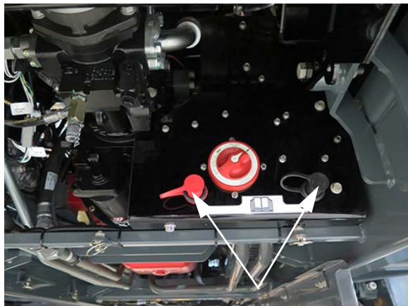
Bornes de charge de la batterie auxiliaire (situées sur le châssis principal arrière) - Vue typique
