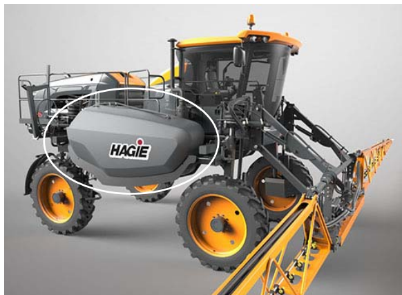
Réservoir de solution - Vue typique
