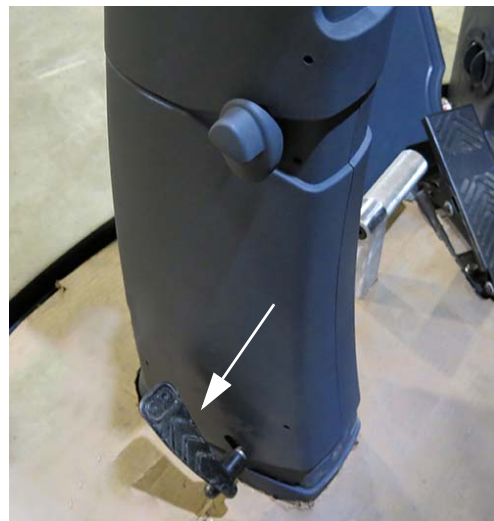
Pédale de dégagement de la colonne de direction (située dans la partie inférieure gauche de la colonne de direction) - Vue typique
