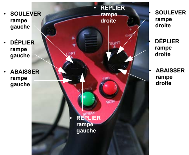
Commutateurs des rampes gauche/droite (situés sur le levier de commande de l'entraînement hydrostatique) - Vue typique
