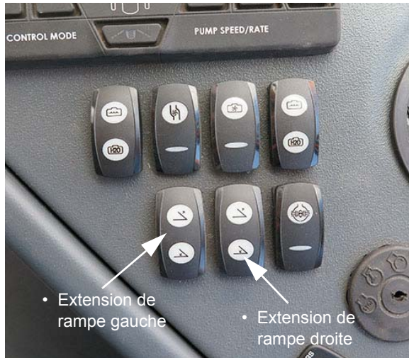
Commutateurs des extensions de rampe de gauche/droite (situés sur la console latérale) - Vue typique
