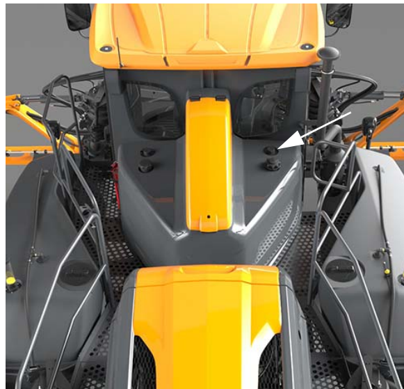
Remplissage du réservoir de liquide de lave-glace (situé sur la partie supérieure du FRM de droite) - Vue typique
