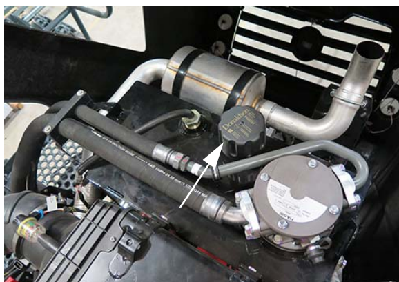
Bouchon du reniflard du réservoir (situé sur le dessus du réservoir d'huile hydraulique - ouvrez le capot pour y accéder) - Vue typique
