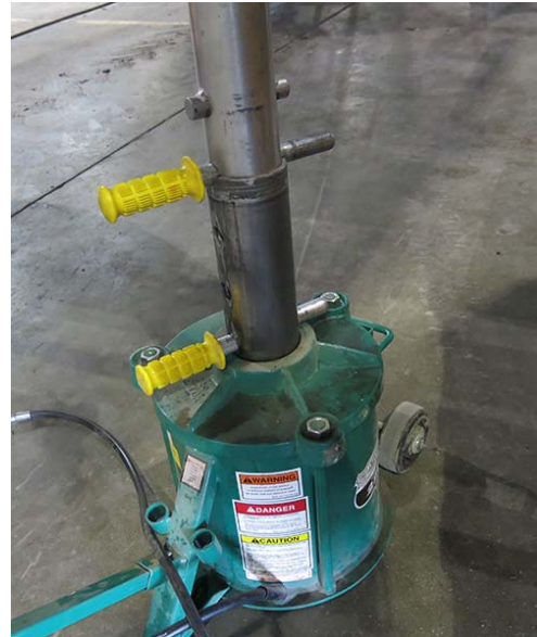
Installation des goupilles de blocage - Vue typique
