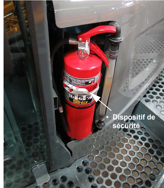
Extincteur d'incendie (situé derrière la partie gauche de la cabine) - Vue typique
