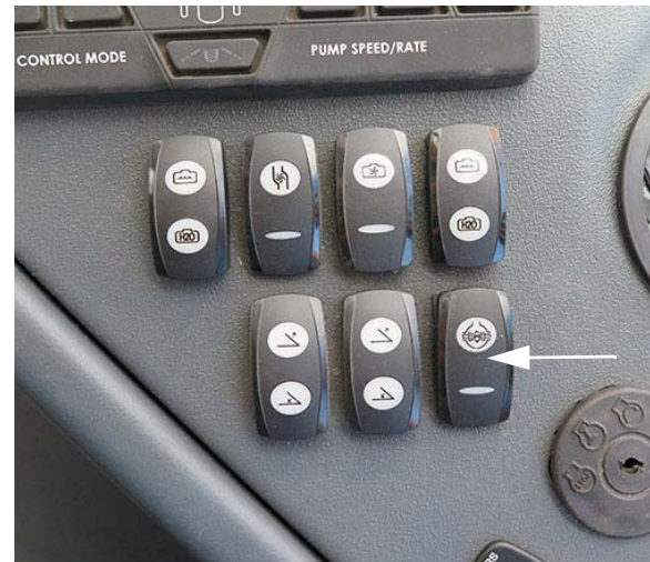
Commutateur du système d'antipatinage (situé sur la console latérale) - Vue typique
