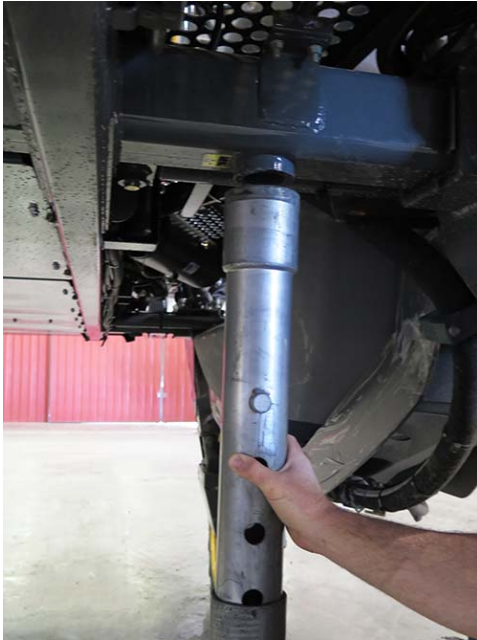
Insérez le cric dans l'anneau de rétention du point de levage - Vue typique
