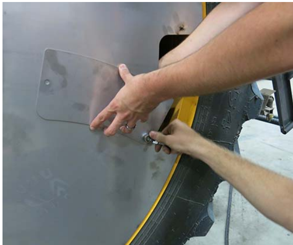
Panneau d'accès à la tige de valve de chambre à air - Vue typique
