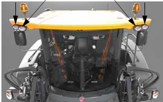
Projecteurs de champ (situés à l'avant de la cabine) - Vue typique
