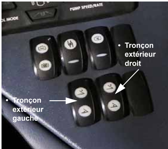
Commutateurs des extensions de rampe de gauche/droite (situés sur la console latérale) - Vue typique
