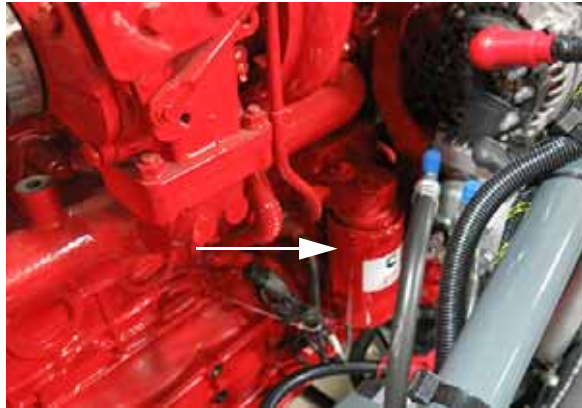
Filtre à huile moteur (situé sur le côté droit du moteur et accessible par l'ouverture d'accès pour l'entretien) - Vue typique
