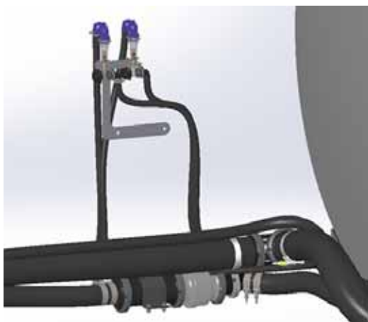
Indicateurs de débit (situés sur le côté extérieur droit de la machine) - Vue typique
