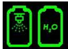
Voyants du réservoir de rinçage et des réservoirs de solution de rinçage
