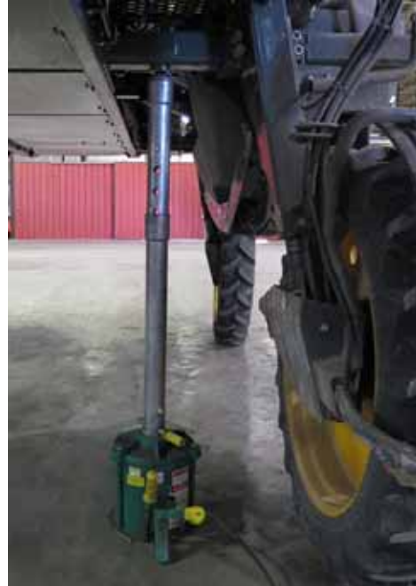
Alignez le cric avec l'anneau de rétention du point de levage - Vue typique
