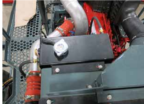
Radiateur (situé sur la partie arrière de la machine - ouvrez le capot pour y accéder) - Vue typique
