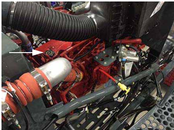
Remplissage d'huile moteur (situé près de la partie supérieure du moteur, ouvrez le capot pour y accéder) - Vue typique
