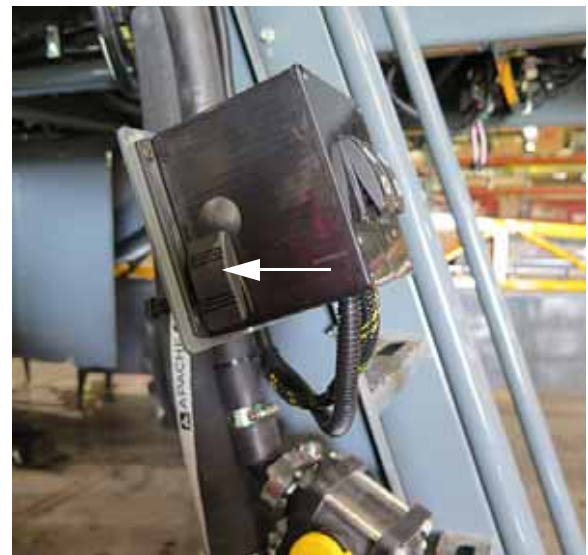
Interrupteur de pulvérisation de nuit (situé sur le boîtier de commutation, près de l'échelle) - Vue typique
