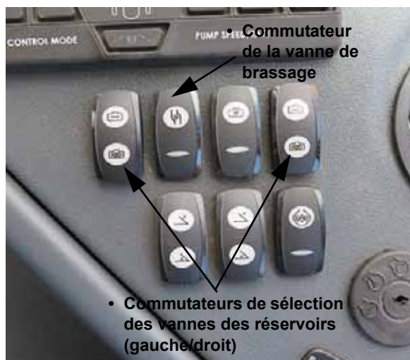
Commutateurs de sélection des vannes des réservoirs et de la vanne de brassage (situés sur la console latérale) - Vue typique
