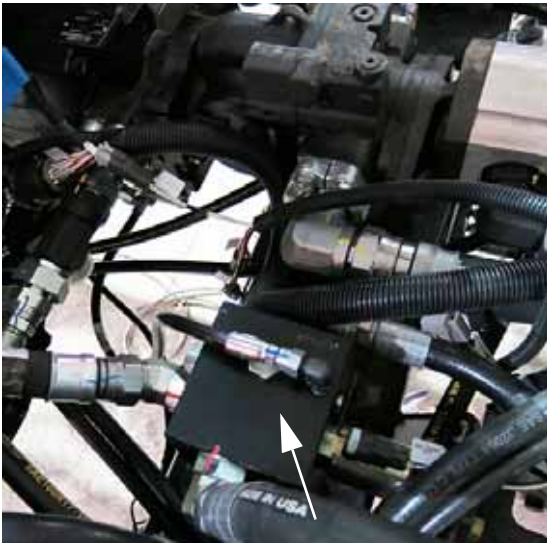
Collecteur de commande de la pompe à solution (situé dans la partie centrale de la machine) - Vue typique
