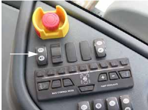
Commutateur du marqueur à mousse (situé sur la console latérale) - Vue typique
