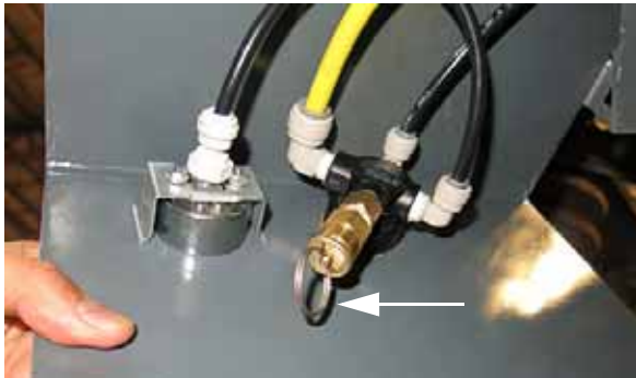
Anneau de traction de décharge de la pression (situé sur la partie arrière du régulateur de pression de la mousse) - Vue typique
