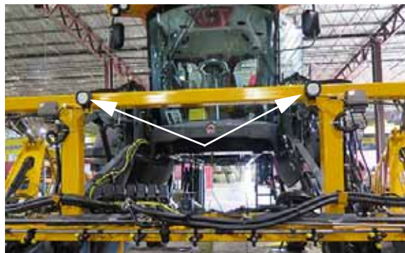
Projecteurs de l'accessoire (situés à l'avant de la traverse) - Vue typique
