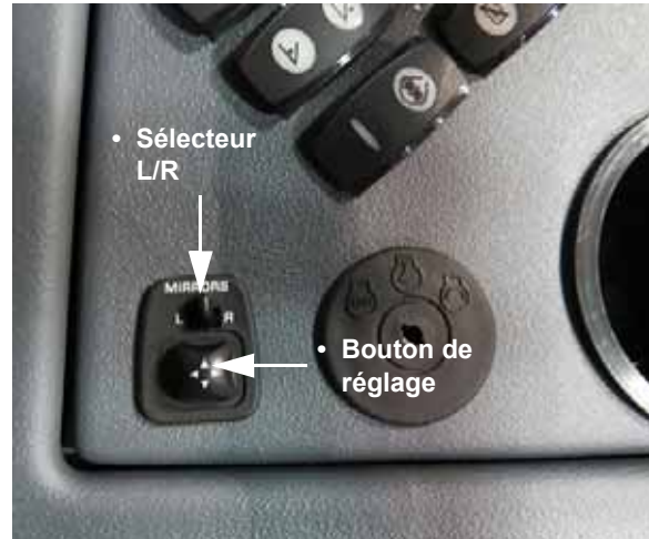
Bouton de réglage des rétroviseurs à commande électrique (situé sur la console latérale) - Vue typique
