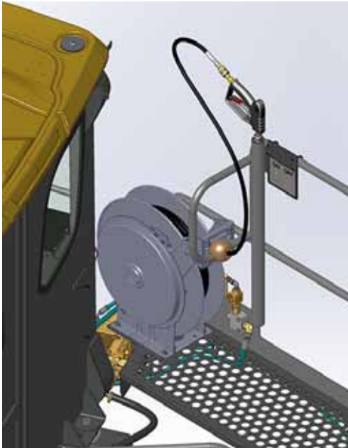
Lance du nettoyeur haute pression et enrouleur de tuyau (situés derrière le côté droit de la cabine) - Vue typique
