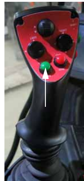
Interrupteur du pulvérisateur principal (situés sur le levier de commande de l'entraînement hydrostatique) - Vue typique
