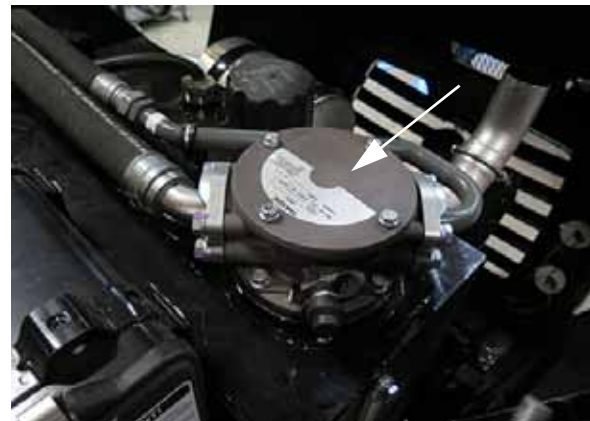
Boîtier du filtre de retour (situé sur le dessus du réservoir d'huile hydraulique) - Vue typique
