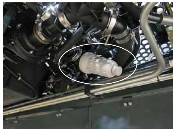
Crépine de la conduite de solution (située sous la partie centrale de la machine) - Vue typique
