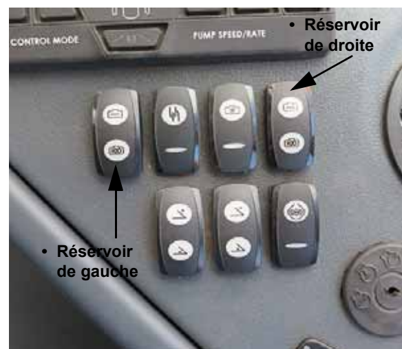
Commutateurs de sélection des vannes des réservoirs (gauche/droit) (situé sur la console latérale) - Vue typique
