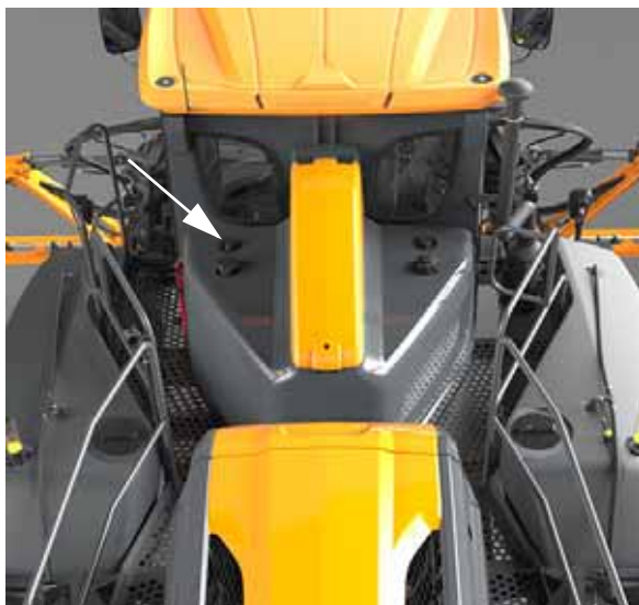
Orifice de remplissage du réservoir de marqueur à mousse (situé sur la partie avant gauche du module de rinçage du carburant(FRM)) - Vue typique
