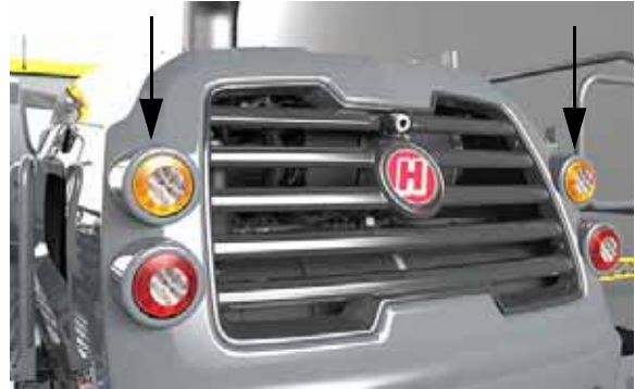
Feux de détresse / feux d'avertissement arrière (2) - Vue typique
