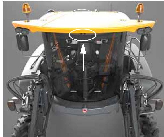
Buse de pulvérisation de liquide lave-glace (située près de la partie supérieure de l'extérieur de la cabine) - Vue typique
