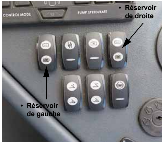
Commutateurs de sélection des vannes des réservoirs (gauche/droit) (situés sur la console latérale) - Vue typique
