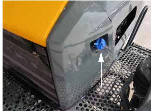
Bouchon de remplissage de fluide d'échappement diesel (situé sur le côté gauche du capot) - Vue typique
