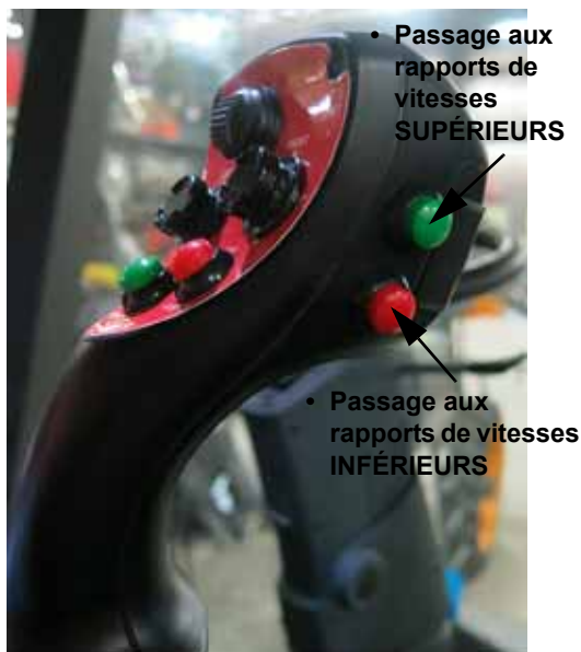
Commutateurs de passage aux rapports de vitesses supérieurs/inférieurs (situés sur le côté du levier de vitesse de la transmission hydrostatique) - Vue typique
