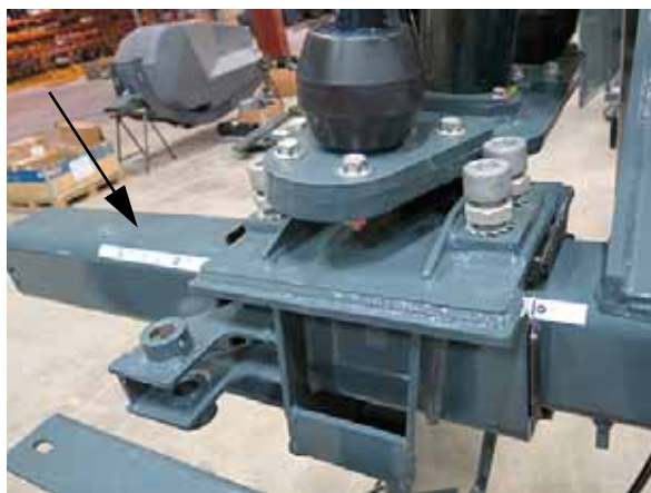
Rail de coulissement du palier de réglage de la voie (situé sur chaque jambe de la machine) - Vue typique
