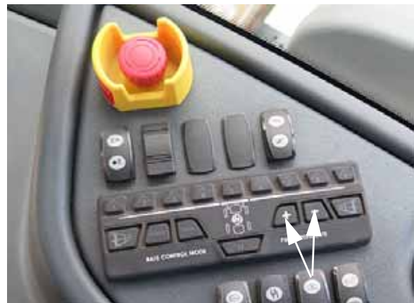
Commutateurs de vitesse/ de débit de la pompe (situés sur la console latérale) - Vue typique
