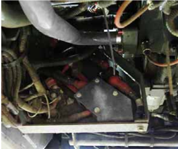
Bloc de fusibles et relais du moteur Tier 4 Final (situé en dessous de la batterie, dans la partie arrière droite de la machine) - Vue typique
