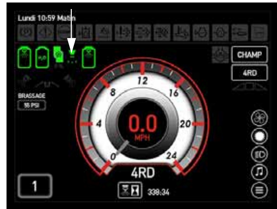
Indicateur du pulvérisateur principal (situé sur la page d'accueil de l'afficheur de la machine - mode Champ)
