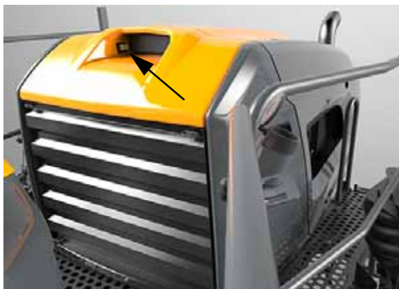
Bouton d'ouverture du capot (situé près du capot avant, au-dessus de la calandre) - Vue typique
