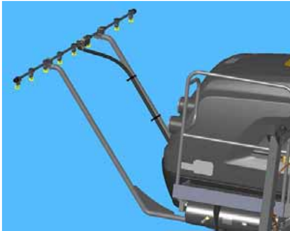
Installation de la rampe de pulvérisation arrière - Vue typique
