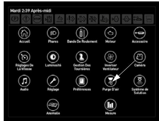
Touche Purge à air (située sur la page Menu principal)
