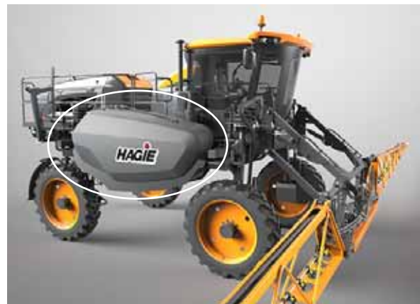
Réservoir de solution - Vue typique
