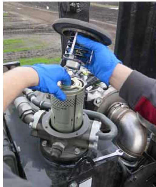
Filtre de retour (Situé à l'intérieur du boîtier de filtre, sur le dessus du réservoir d'huile hydraulique - ouvrez le capot pour y accéder) - Vue typique
