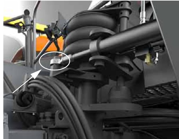
Embout de graissage de la rotule de la biellette de direction (situé sur chacune des jambes avant*) - Vue typique
