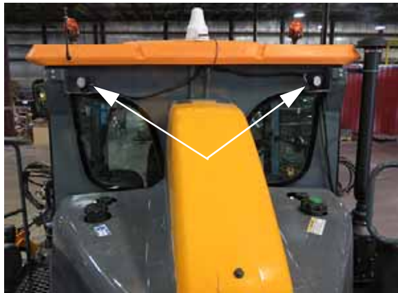
Projecteurs de pulvérisation de nuit (2) (situés à l'arrière de la cabine) - Vue typique
