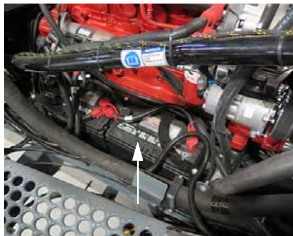
Batterie (située dans la partie arrière droite de la machine) - Vue typique
