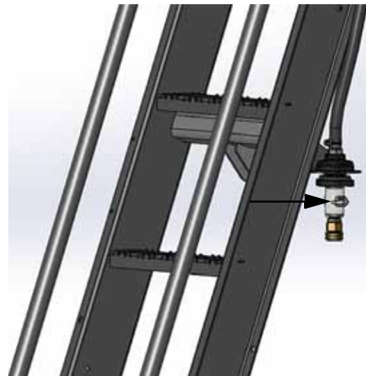
Vanne de lave-mains (échelle) - Vue typique
