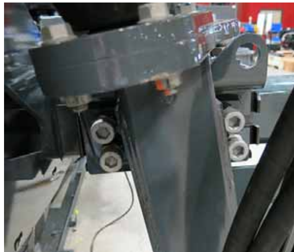
Boulons du palier de réglage de la voie - haut/côté (situé sur chaque jambe de la machine) - Vue typique
