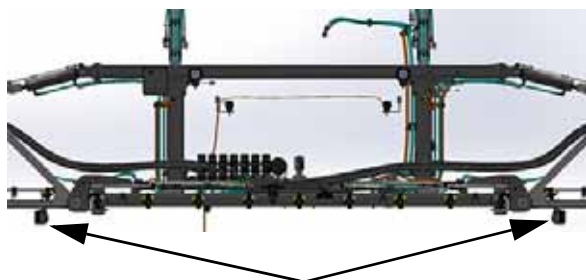
Projecteurs de pulvérisation de nuit (2) (situés de chaque côté du tronçon de la section principale de la rampe) - Vue typique
