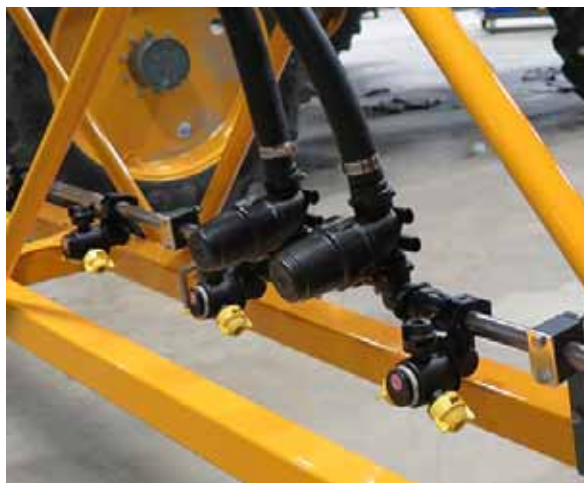
Crépines de sections (Situées tout au long des diverses sections de la rampe) - Vue typique
