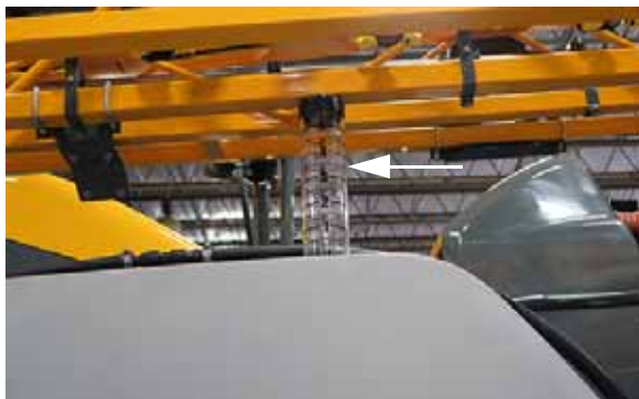
Jauge de niveau du réservoir de solution (2) (située en haut de chaque réservoir de solution) - Vue typique
