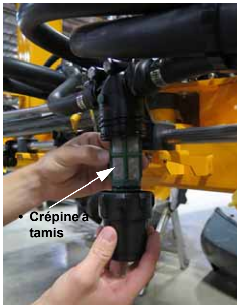
Crépines des tronçons (situées sur les divers tronçons de la rampe) - Vue typique
