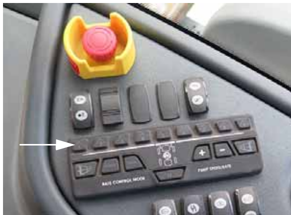
Interrupteurs des vannes de solution de la rampe (situé sur la console latérale) - Vue typique
