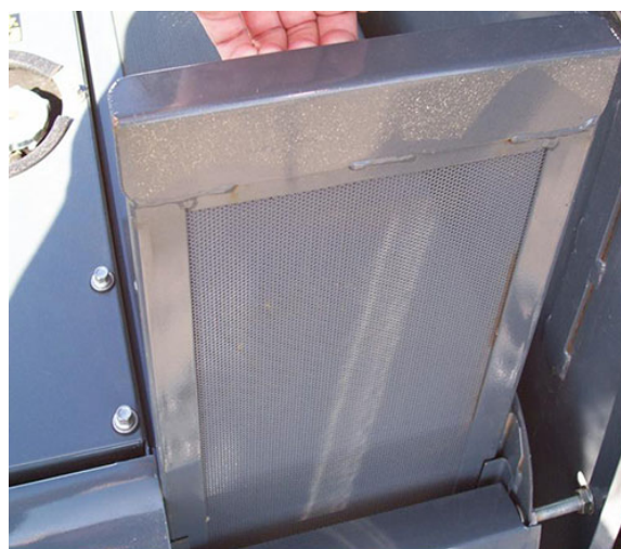
Pantalla de la parrilla lateral (deslizar hacia fuera del alojamiento del radiador para sacarla) -Vista típica
