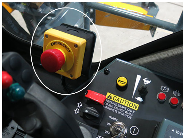
Interruptor de parada de emergencia (ubicado cerca de la consola lateral) - Vista típica
