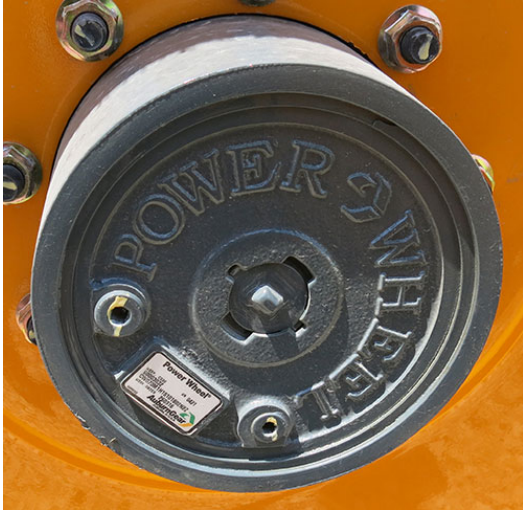
Placa de identificación del cubo planetario de la rueda -Vista típica
