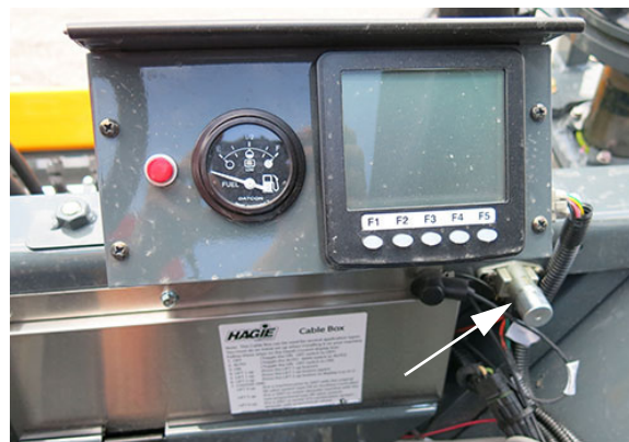
Interruptor de la válvula de tracción - delantera (ubicado cerca de la parte delantera del puesto del operador) -Vista típica
