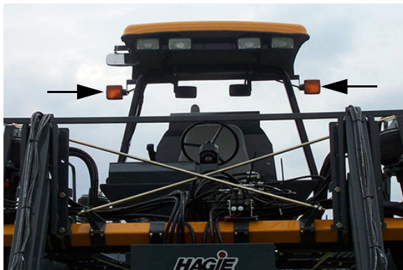
Luces de manejo/carretera (ubicadas a ambos lados del puesto del operador) -Vista típica
