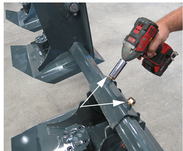
Pernos del cabezal de corte (ubicados sobre cada tubo de montaje de los cabezales de corte) -Vista típica
