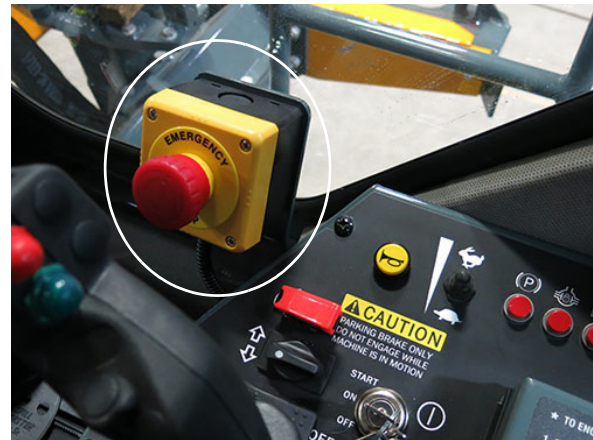
Botón de parada de emergencia (ubicado cerca de la consola lateral) -Vista típica
