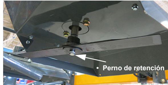
Conjunto de cuchilla de corte (montado en el lado inferior del cabezal de corte) -Vista típica
