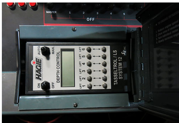
Panel de control Tasselrol/LS System 12 (ubicado en la consola lateral, levantar la tapa para acceder al panel) -Vista típica
