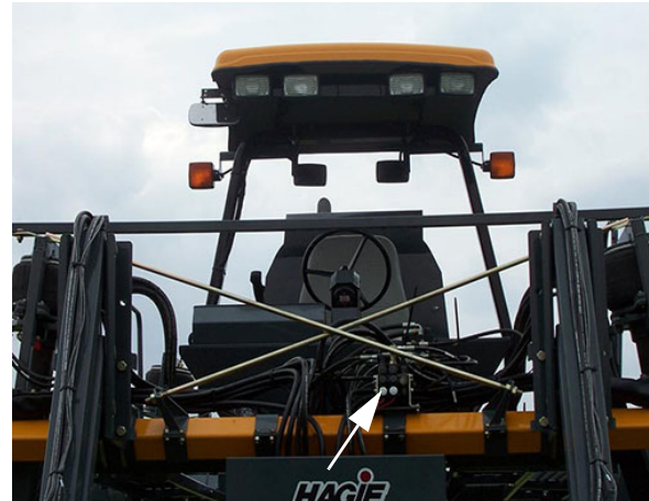
Válvula de replegado hidráulico (ubicada en la barra de herramientas central) -Vista típica
