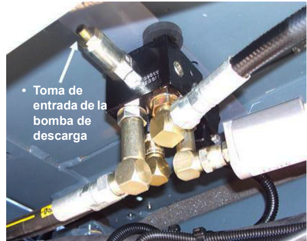
Válvula de descarga (ubicada debajo del asiento del operador) -Vista típica
