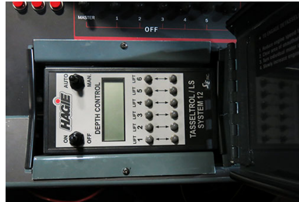
Panel de control Tasseltról/LS System 12 (ubicado en la consola lateral, levantar la tapa para acceder al panel) -Vista típica
