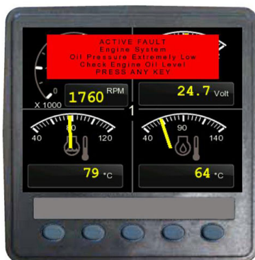
Advertencia de falla activa - Vista típica
