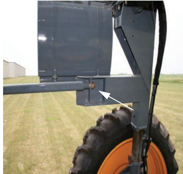
Contratuerca trasera (ubicada en la abrazadera de la pata) -Vista típica
