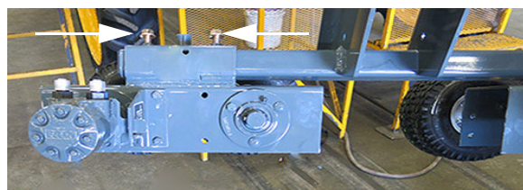
Pernos del extractor cuádruple (ubicados en cada tubo de montaje del extractor cuádruple) -Vista típica
