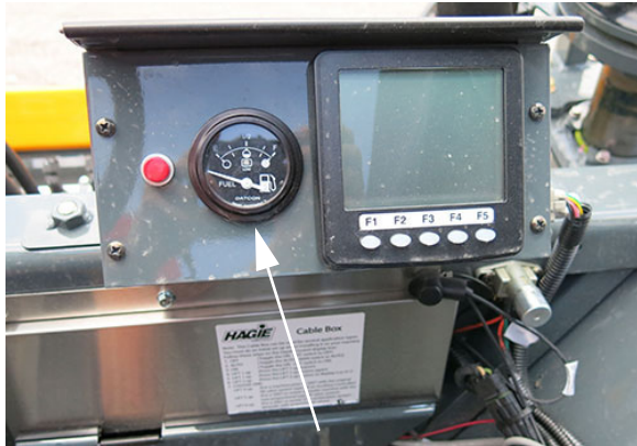
Indicador de combustible (ubicado cerca de la parte delantera del puesto del operador) -Vista típica
