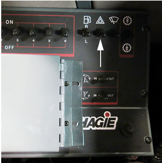
Interruptor de las luces de advertencia/peligro (ubicado en la consola lateral) -Typical View
