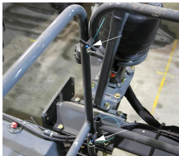
Штифты ограждения (сверху и снизу оградительной приставки) – стандартный вид
