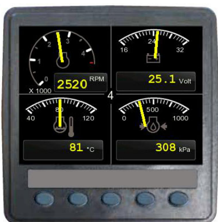
Экран счетверенного аналогового датчика – стандартный вид
