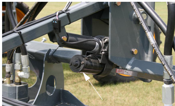
Привод управления глубиной (расположен на трубке подъемной головки инструментальной оправки) – стандартный вид
