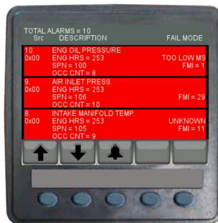
Экран активных аварийных сигналов – стандартный вид
