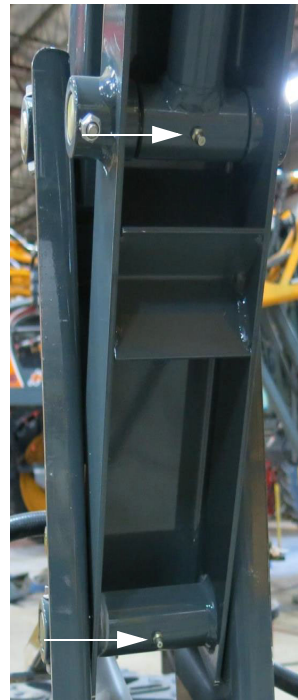
Узел подъемного рычага – середина – стандартный вид
