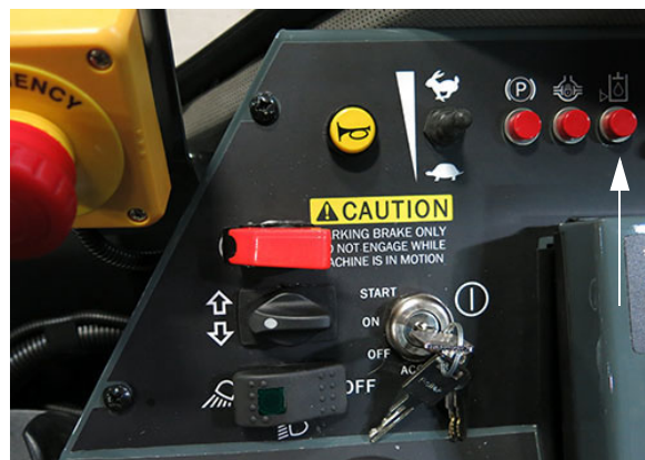
Указатель низкого уровня масла для гидравлических систем (расположен на боковой панели) – стандартный вид
