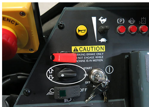
Переключатель сигналов поворота (Находится на боковой панели) – стандартный вид
