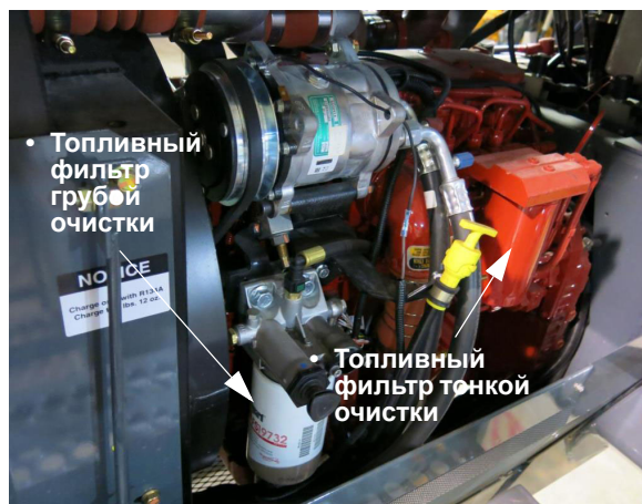
Топливные фильтры грубой и тонкой очистки (расположены с левой стороны двигателя – для доступа откройте капот) – стандартный вид
