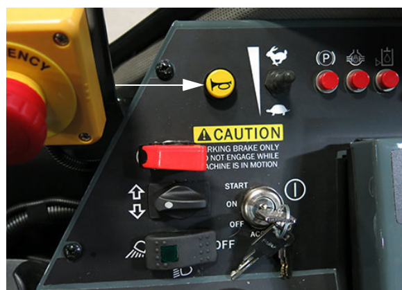
Кнопка клаксона (расположена на боковой панели) – стандартный вид
