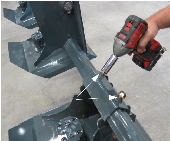
Болты режущей головки (расположены на каждой опорной трубе режущей головки) – стандартный вид
