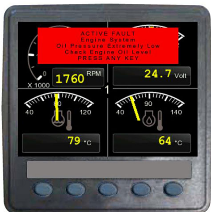
Активное предупреждение о неисправности – стандартный вид
