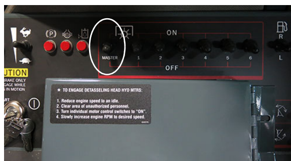
Главный переключатель механизма удаления метелок кукурузы (Находится на боковой панели) – стандартный вид
