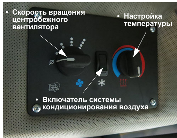
Климат-контроль (расположен на карнизе кабины) – стандартный вид
