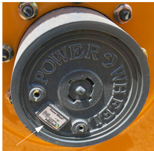
Идентификационная табличка ступицы колеса планетарной передачи – стандартный вид
