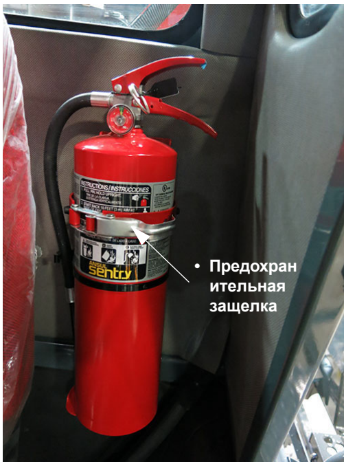
Огнетушитель (сбоку сиденья оператора) – стандартный вид
