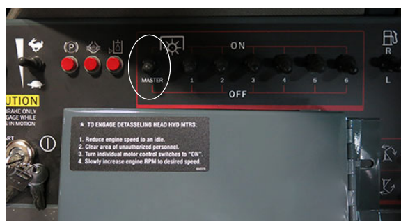
Главный выключатель машины для удаления метелок кукурузы (расположен на боковой панели) – стандартный вид
