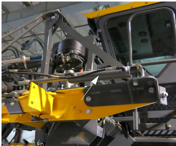
Цилиндр гидравлического складывания (прикреплен к выносной опоре и центральной инструментальной оправке) – стандартный вид
