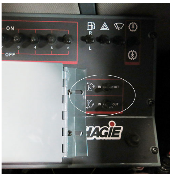
Переключатели гидравлического складывания выносных опор (расположен на боковой панели) – стандартный вид
