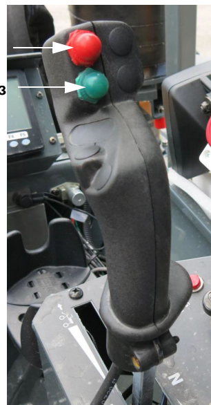
Переключатели «Все вверх/вниз» (расположены на Рукоятке управления гидростатическим приводом) – стандартный вид
