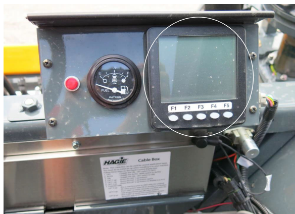
Дисплей монитора работы двигателя (расположен спереди рабочего места оператора) – стандартный вид
