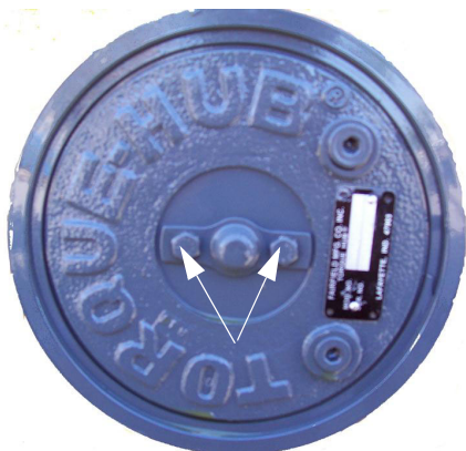
Крышечные болты – стандартный вид
