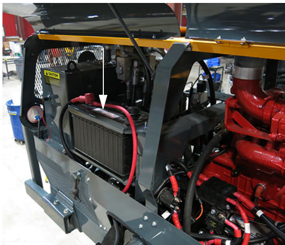
Доступ к батарее (сзади справа машины, для доступа откройте капот) – стандартный вид
