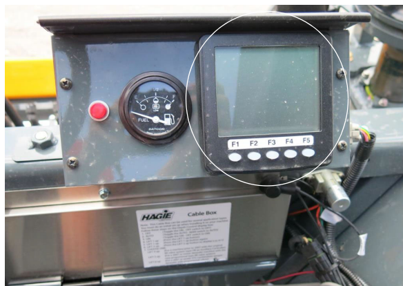
Монитор работы двигателя (расположен спереди рабочего места оператора) – стандартный вид
