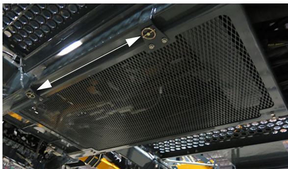
Стопорные штифты сетчатой панели (Находятся на передней сетчатой панели) – стандартный вид * Вид сзади машины
