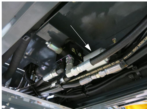
Напорный проходной фильтр (Находится под машиной — для доступа опустите переднюю сетчатую панель) – стандартный вид
