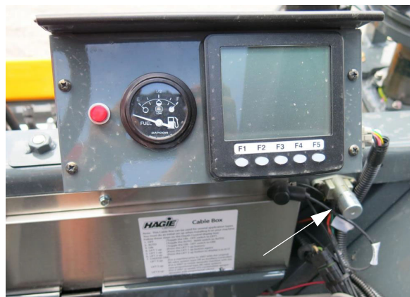
Переключатель клапана сцепления - передний (расположен спереди рабочего места оператора) – стандартный вид
