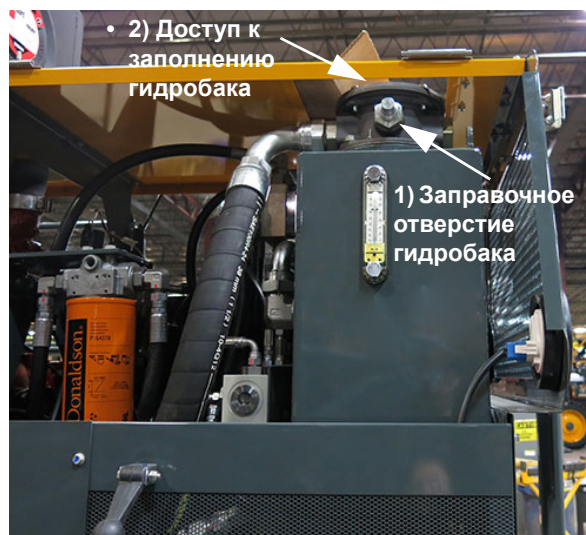
Способы заполнения гидробака – стандартный вид
