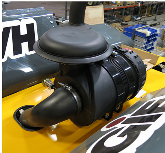
Фильтр впуска воздуха в двигатель (расположен в задней части машины – для доступа снимите пробку воздухоочистителя) – стандартный вид
