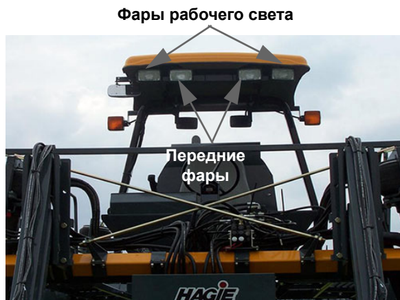
Передние фары/фары рабочего света – стандартный вид
