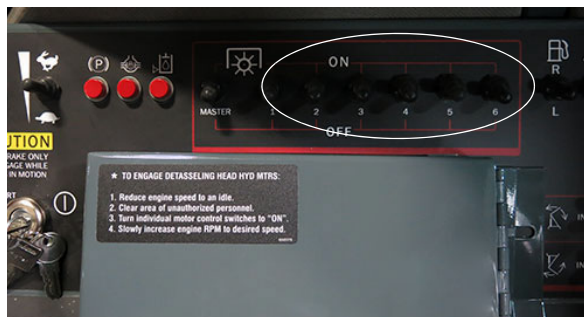
Контрольные выключатели электродвигателя головки удаления метелок кукурузы (расположены на боковой панели) – стандартный вид
