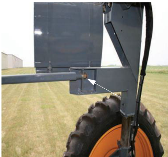
Задняя контргайка (расположена на подкосе опоры) – стандартный вид
