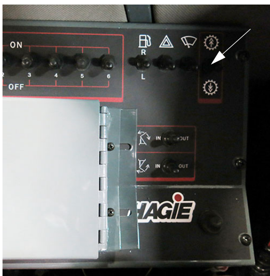
Переключатель передач (расположен на боковой панели) – стандартный вид
