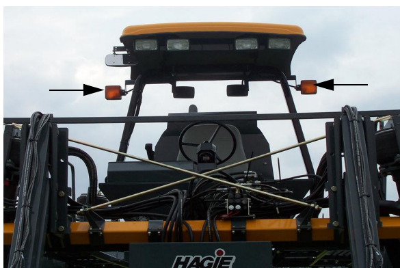
Шосейные ходовые огни (расположены спереди и сзади рабочего места оператора) – стандартный вид
