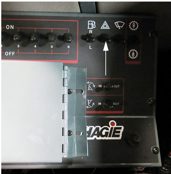
Переключатель аварийной сигнализации (расположен на боковой панели) – стандартный вид
