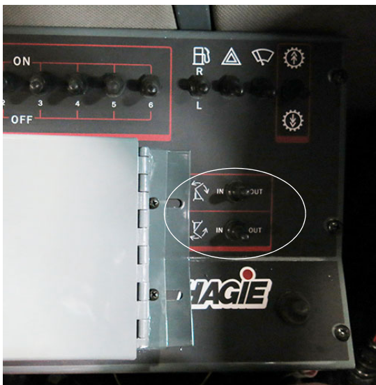
Переключатели гидравлического складывания выносных опор (расположен на боковой панели) – стандартный вид
