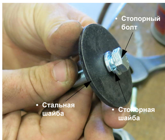
Болт режущей пластины с шайбой – стандартный вид
