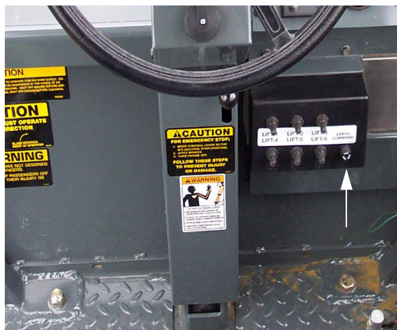
Предохранитель управления глубиной (расположен на Панели с переключателем управления глубиной спереди рабочего места оператора) – стандартный вид
