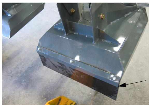
Выдвижной закрылок режущей головки – стандартный вид
