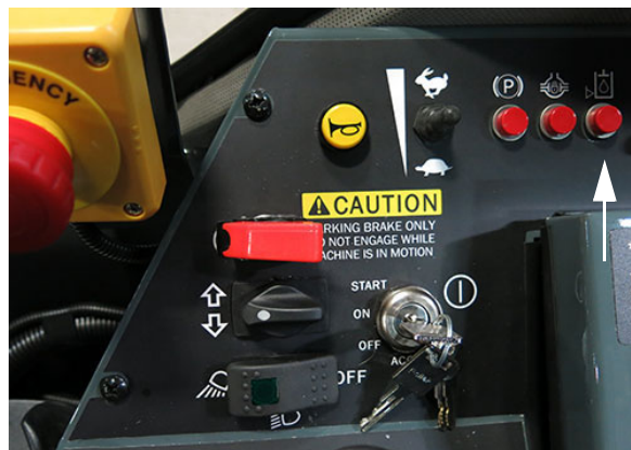
Индикаторная лампочка низкого уровня масла для гидравлических систем (Находится на боковой панели) – стандартный вид
