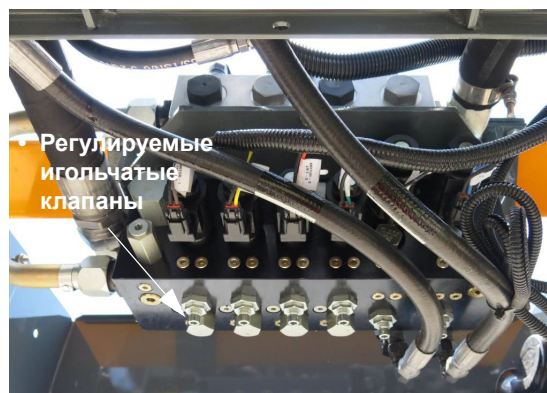
Клапаны управления двигателем – стандартный вид
