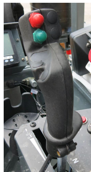
Рукоятка управления гидростатическим приводом (расположен на боковой панели) – стандартный вид
