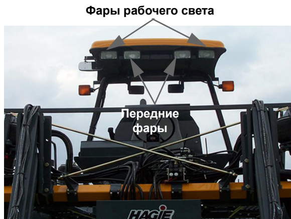
Передние фары/фары рабочего света – стандартный вид
