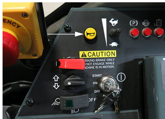
Кнопка клаксона (расположена на боковой панели) – стандартный вид
