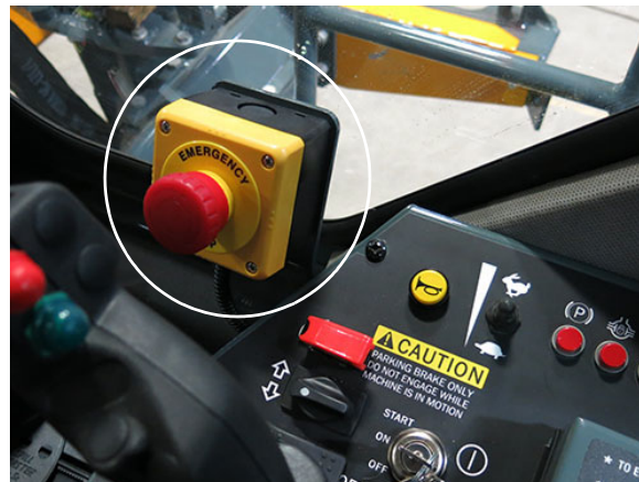
Кнопка аварийного останова (расположена возле боковой панели) – стандартный вид
