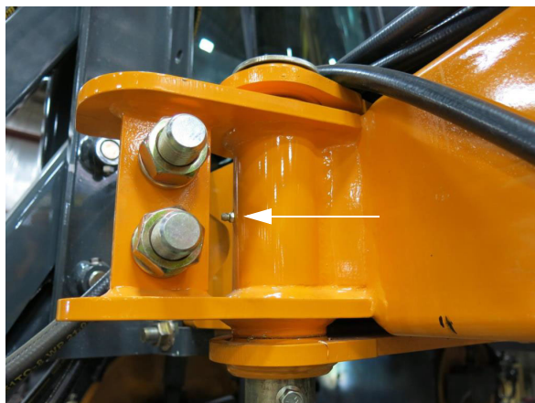
Сгиб выносной опоры – стандартный вид
