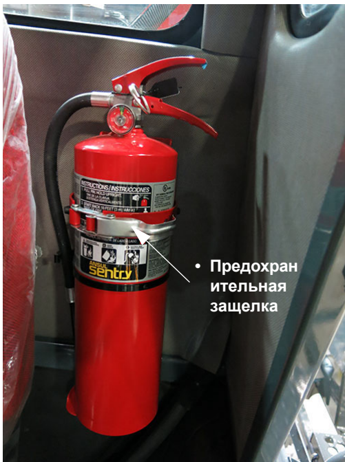
Огнетушитель (сбоку сиденья оператора) – стандартный вид
