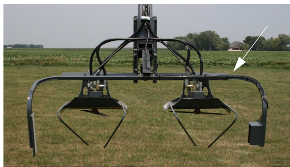
Система LS/Управление глубиной – стандартный вид
