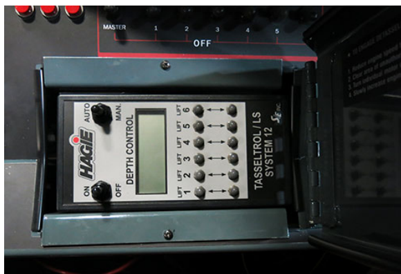
Пульт управления Tasselrol/LS System 12 (расположен на боковой панели – для подхода поднимите крышку) – стандартный вид
