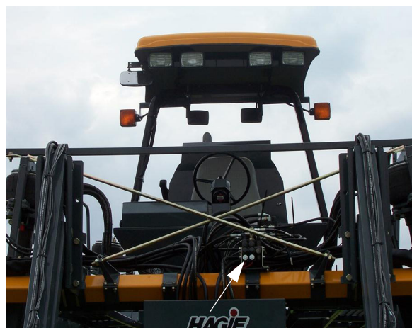
Клапан гидравлического складывания (расположен на центральной инструментальной оправке) – стандартный вид
