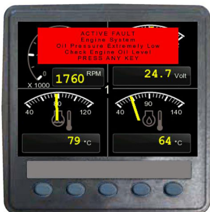
Активное предупреждение о неисправности – стандартный вид
