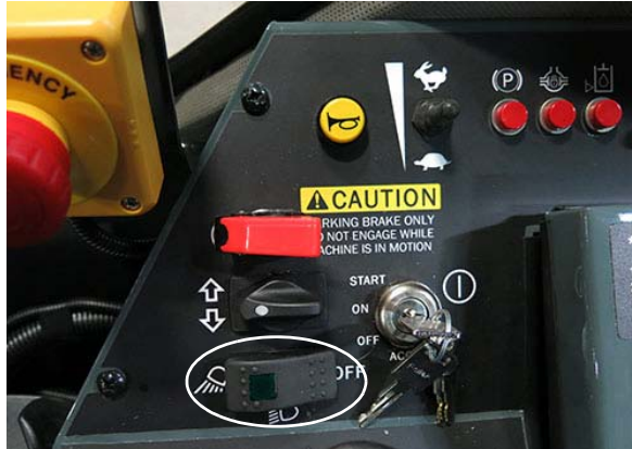
Interruptor de las luces (ubicado en la consola lateral) -Vista típica
