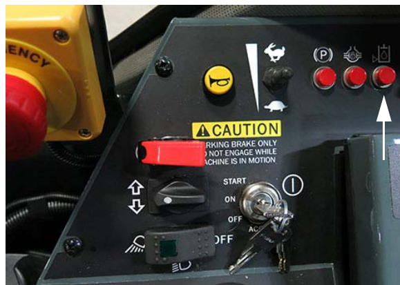
Indicador de nivel bajo de aceite hidráulico (ubicado en la consola lateral) - Vista típica
