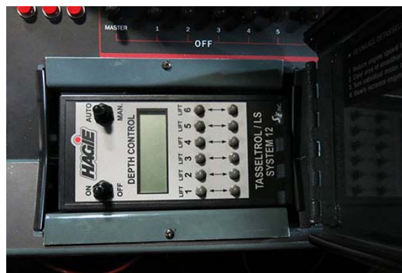
Panel de control Tasseltrol/LS System 12 (ubicado en la consola lateral, levantar la tapa para acceder al panel) -Vista típica
