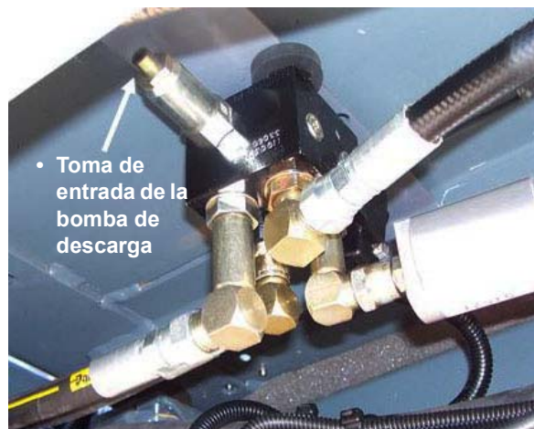
Válvula de descarga (ubicada debajo del asiento del operador) -Vista típica
