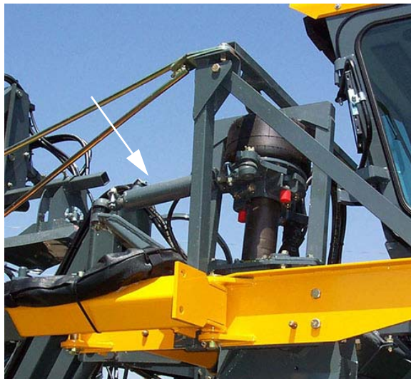
Cilindros de dirección (ubicados en ambos brazos de dirección delanteros y las ensambladuras soldadas de las patas exteriores) -Vista típica
