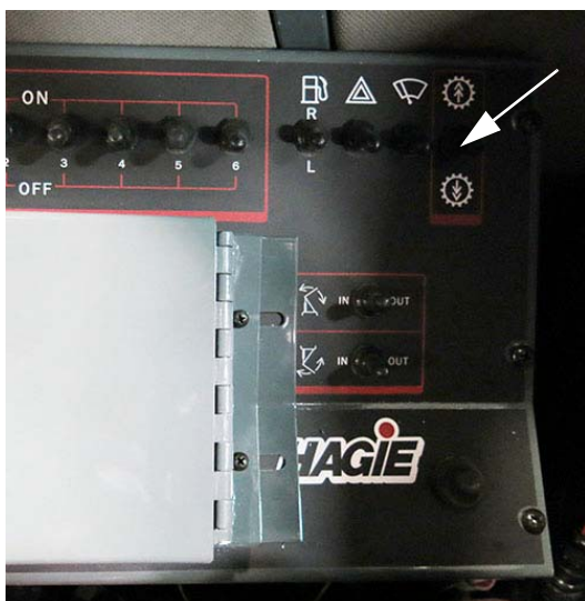
Interruptor selector de marchas (ubicado en la consola lateral) -Vista típica
