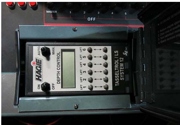
Panel de control Tasselrol/LS System 12 (ubicado en la consola lateral-levante la tapa para acceder al panel) -Vista típica
