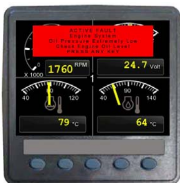
Advertencia de falla activa - Vista típica
