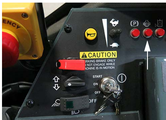
Indicador de válvulas de tracción (Ubicado en la consola lateral) -Vista típica
