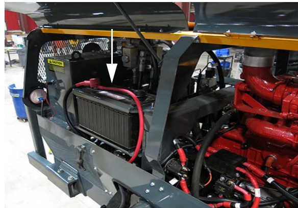
Acceso a la batería (ubicada cerca del lado derecho de la parte trasera de la máquina - abra el capó para acceder a la batería) -Vista típica
