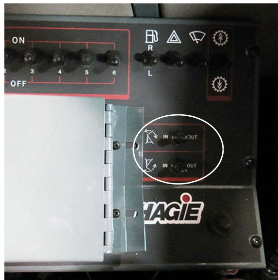
Interruptores para desplegar/replegar los estabilizadores hidráulicos (ubicados en la consola lateral) -Vista típica
