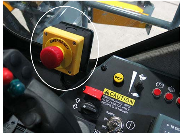
Interruptor de parada de emergencia (ubicado cerca de la consola lateral)
