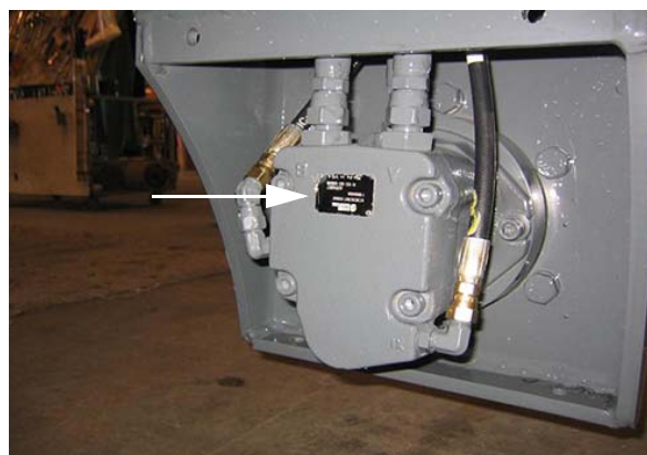
Placa de identificación (con sensor) del motor de la rueda trasera derecha -Vista típica
