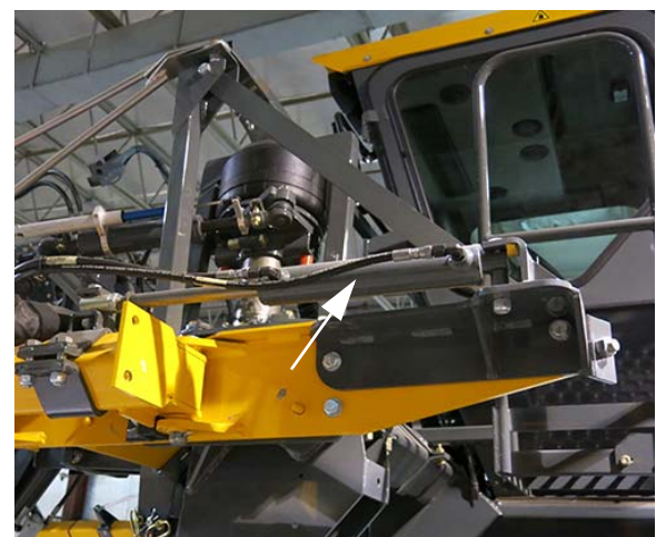
Cilindro de replegado hidráulico (unido al estabilizador y la barra de herramientas central) -Vista típica
