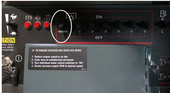
Interruptor principal de la despenachadora (ubicado en la consola lateral) -Vista típica
