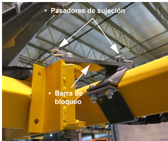
Conjunto de la barra de bloqueo/ pasadores de sujeción (ubicado entre el estabilizador y la barra de herramientas central) -Vista típica
