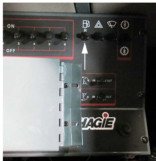
Interruptor selector de depósito de combustible (ubicado en la consola lateral) -Vista típica
