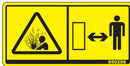
PRECAUCIÓN FLUIDO O GAS PRESURIZADOS. MANTÉNGASE A UNA DISTANCIA SEGURA DEL PELIGRO.
