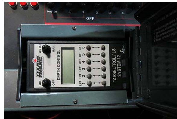
Panel de control Tasselrol/LS System 12 (ubicado en la consola lateral - levante la tapa para acceder al panel) -Vista típica
