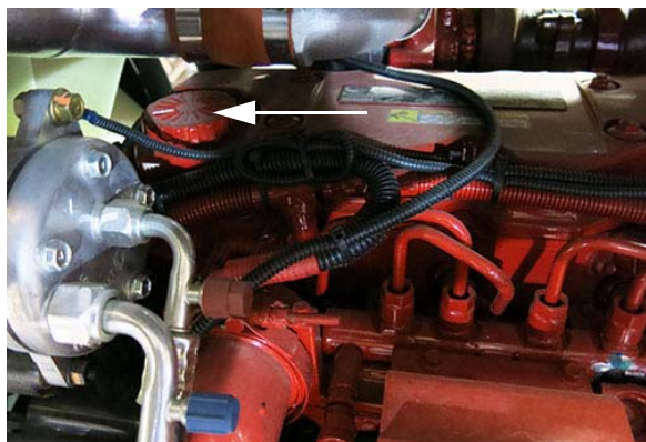
Boca de llenado de aceite del motor (ubicada en el lado izquierdo del motor, abra el capó para acceder a la boca) -Vista típica
