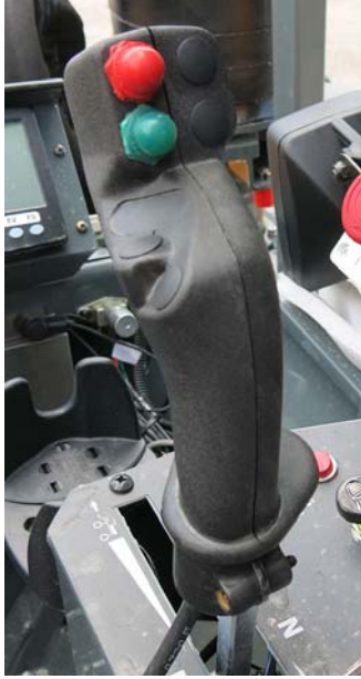
Palanca de control de la transmisión hidrostática (ubicado en la consola lateral) -Vista típica
