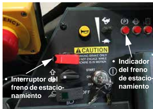
Interruptor/indicador del freno de estacionamiento (ubicado en la consola lateral) -Vista típica
