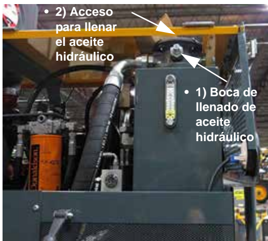
Opciones para llenar el aceite hidráulico - Vista típica
