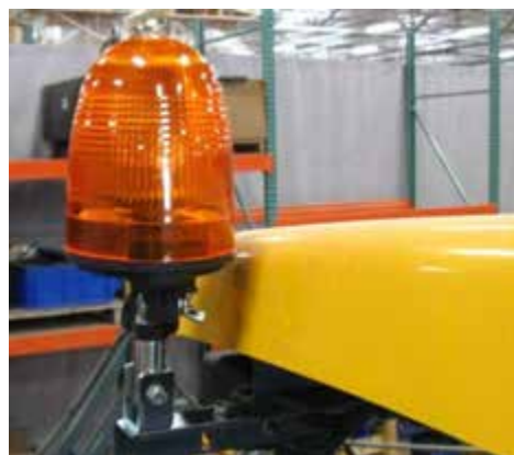
Faro giratorio (ubicado en el lado izquierdo del puesto del operador) -Vista típica
