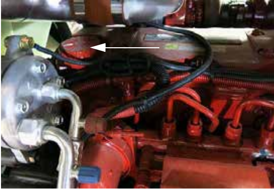
Boca de llenado de aceite del motor (ubicada en el lado izquierdo del motor, abra el capó para acceder a la boca) -Vista típica
