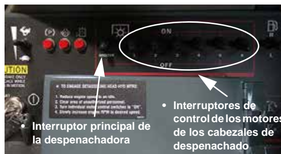
Interruptor principal de la despenachadora e interruptores de control de los motores de los cabezales de despenachado (ubicados en la consola lateral) -Vista típica
