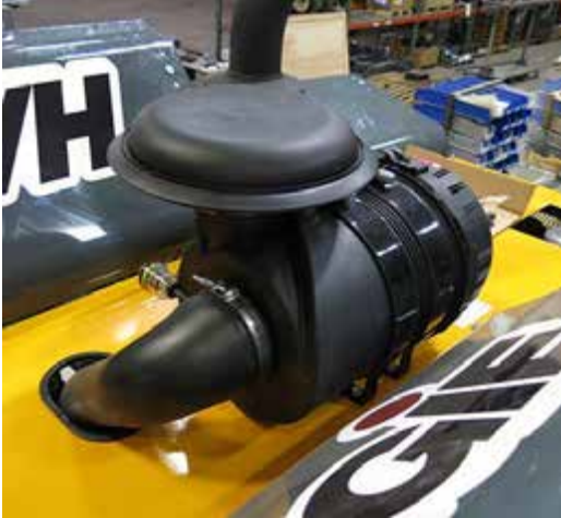
Filtro de la admisión de aire del motor (ubicado cerca de la parte trasera de la máquina, quite la tapa de cierre del filtro de aire para acceder al filtro) -Vista típica
