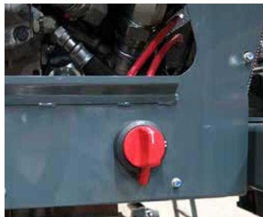
Interruptor de desconexión de la batería (ubicado en el bastidor trasero) -Vista típica
