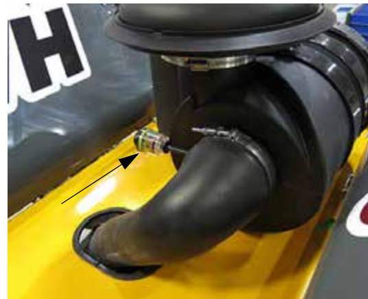
Controlador de filtro (ubicado cerca del alojamiento del filtro de la admisión de aire del motor) -Vista típica
