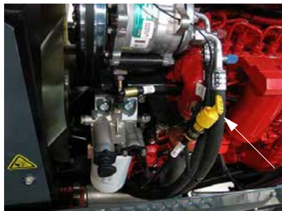
Varilla medidora de nivel de aceite del motor (ubicada en el lado izquierdo del motor, abra el capó para acceder a la varilla medidora) -Vista típica
