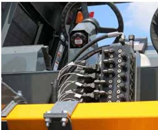
Válvulas electro-hidráulicas (ubicadas en la parte delantera de la barra de herramientas) -Vista típica
