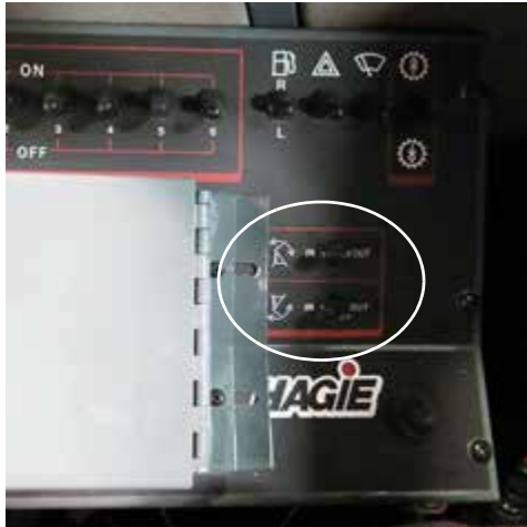
Interruptores para replegar los estabilizadores hidráulicos (ubicados en la consola lateral) -Vista típica
