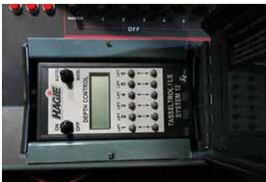
Panel de control Tasselrol/LS System 12 (ubicado en la consola lateral, levantar la tapa para acceder al panel) -Vista típica
