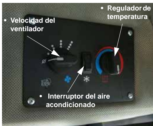
Climatizadores (ubicados en el techo interior de la cabina) -Vista típica
