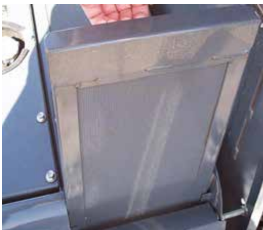
Pantalla de la parrilla lateral (deslizar hacia fuera del alojamiento del radiador para sacarla) -Vista típica
