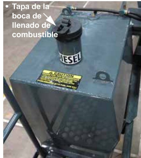
Boca de llenado de combustible del motor (ubicada en la parte superior del depósito de combustible en cada lado de la máquina) - Vista típica
