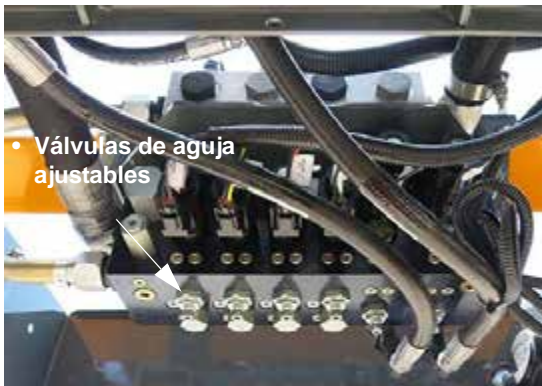
Válvulas de control de los motores -Vista típica
