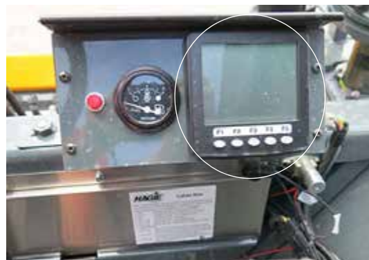
Monitor del motor (ubicado cerca de la parte delantera del puesto del operador) -Vista típica
