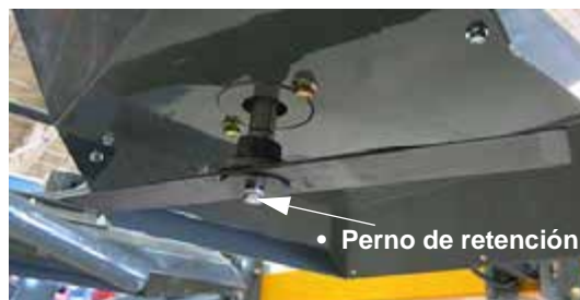
Conjunto de cuchilla de corte (montado en el lado inferior del cabezal de corte) -Vista típica
