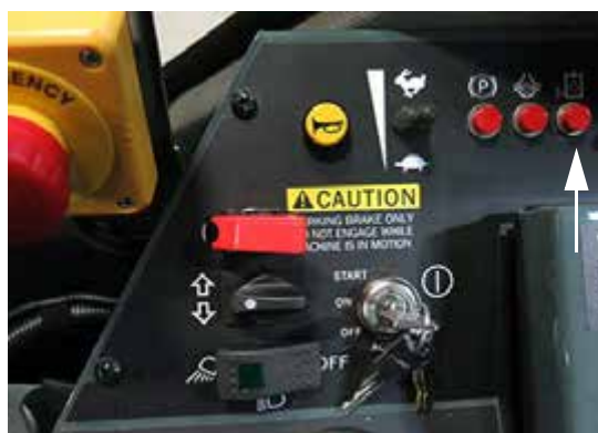
Indicador de nivel bajo de aceite hidráulico (ubicado en la consola lateral) -Vista típica
