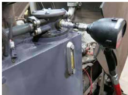
Llenar el tanque por la boca de llenado de aceite hidráulico - Vista típica
