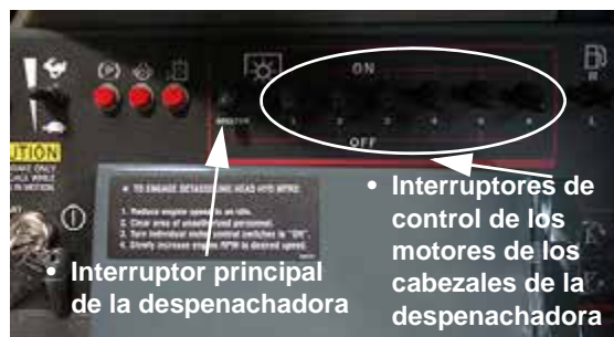
Interruptor principal de la despenachadora e interruptores de control de los motores de los cabezales de la despenachadora (ubicados en la consola lateral) -Vista típica
