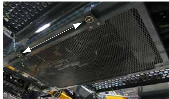
Pasadores de sujeción del panel de la pantalla (ubicados en el panel delantero de la pantalla) - Vista típica
