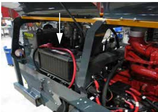
Доступ к батарее (сзади справа машины, для доступа откройте капот) – стандартный вид
