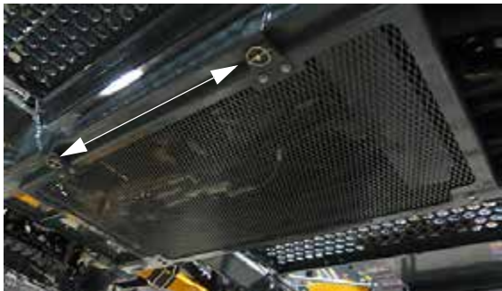
Закрепляющие штифты щита (находятся на переднем щите) – стандартный вид
