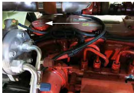
Заправочное отверстие для моторного масла (с левой стороны двигателя – для доступа откройте капот) – стандартный вид
