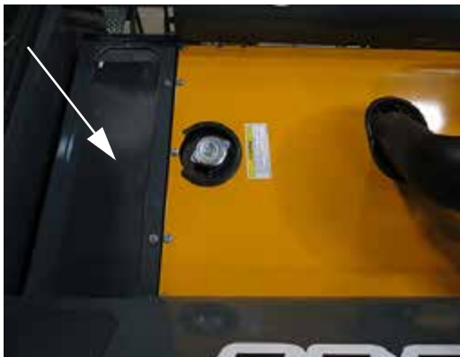
Верхнее жалюзи решетки (для доступа извлеките два болта панели радиатора и снимите панель) – стандартный вид
