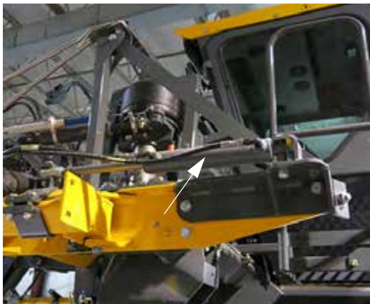
Цилиндр гидравлического складывания (прикреплён к выносной опоре и центральной инструментальной оправке) – стандартный вид
