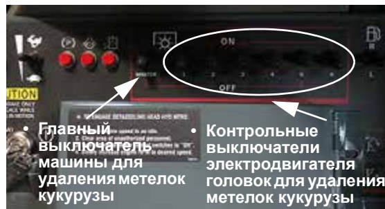
Главный выключатель машины и контрольные выключатели электродвигателя головок для удаления метелок кукурузы (на боковой панели) – стандартный вид
