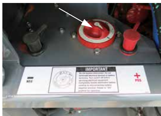
Выключатель массы батареи (находится на задней раме) – стандартный вид
