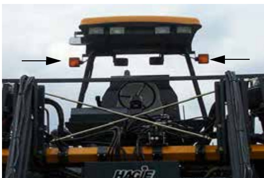
Шосейные ходовые огни (с каждого бока рабочего места оператора) – стандартный вид
