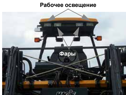
Фары/рабочее освещение – стандартный вид
