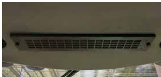
Доступ к фильтру притока воздуха в кабину (расположен в карнизе кабины) – стандартный вид
