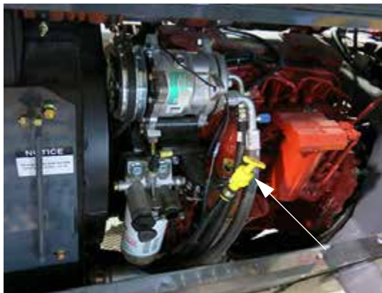
Масляный щуп двигателя (с левой стороны двигателя – откройте капот для доступа) – стандартный вид
