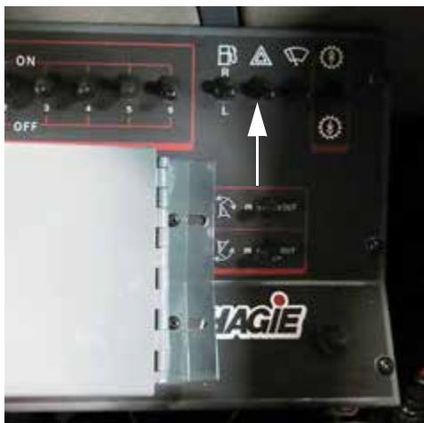
Переключатель аварийной/ предупредительной сигнализации (расположен на боковой панели) – стандартный вид
