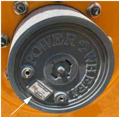
Идентификационная пластина ступицы колеса планетарной передачи – стандартный вид
