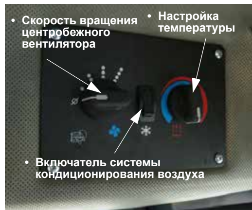
Климат-контроль (расположен на карнизе кабины) – стандартный вид
