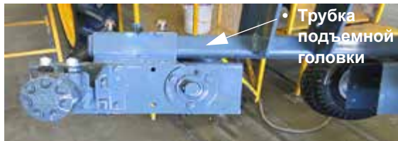
Счетверенный корчеватель – стандартный вид
