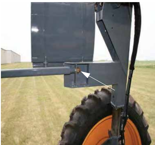
Задняя контррайка (расположена на подкосе опоре) – стандартный вид
