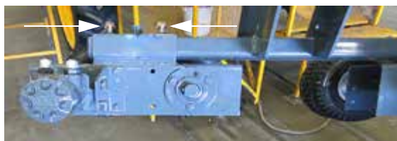
Болты счетверенного корчевателя (на каждой опорной трубе корчевателя) – стандартный вид
