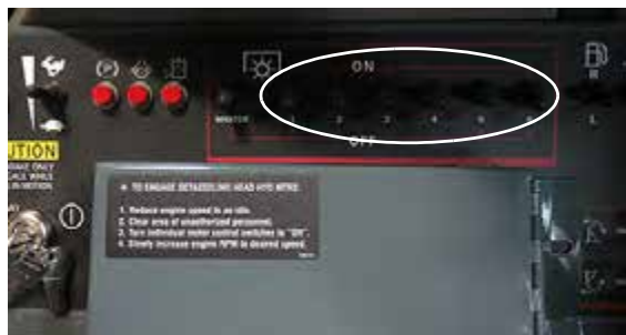
Контрольные выключатели электродвигателя головок для удаления метелок кукурузы (расположены на боковой панели) – стандартный вид
