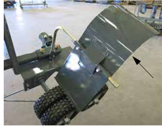
Отклоняющий щиток – стандартный вид
