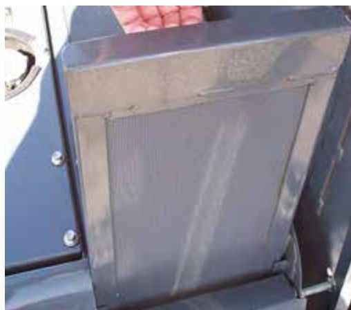
Боковое жалюзи решетки (выдвиньте и извлеките радиатор из корпуса) – стандартный вид
