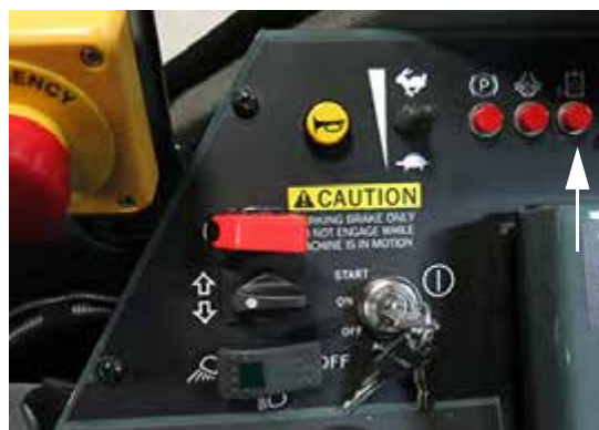
Указатель низкого уровня масла для гидросистем (находится на боковой панели) – стандартный вид
