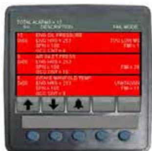
Экран активного аварийного сигнала – стандартный вид
