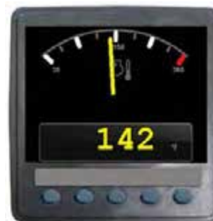
Одинарный аналоговый измерительный экран – стандартный вид
