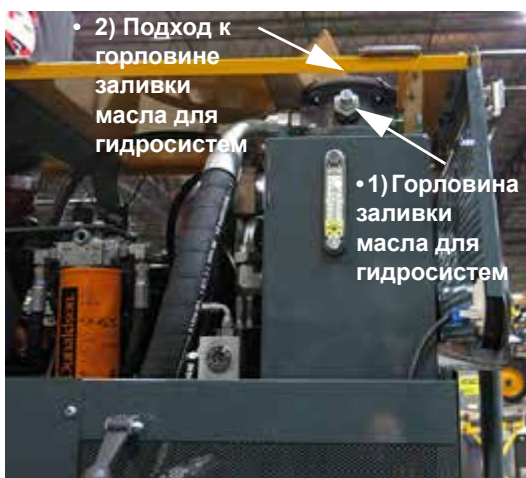
Варианты заливки масла для гидросистем – стандартный вид
