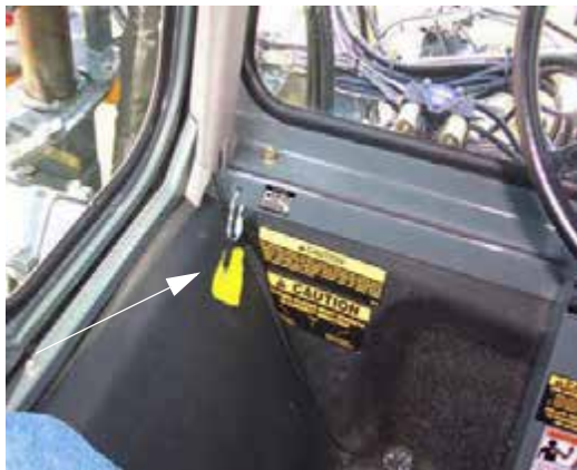
Herramienta de salida de emergencia (ubicada cerca del lado izquierdo de la cabina) -Vista típica
