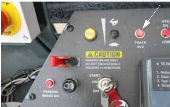
Indicador de válvulas de tracción (Ubicado en la consola lateral) -Vista típica
