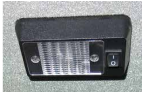
Luz de trabajo interior (ubicada en el techo interior de la cabina) -Vista típica
