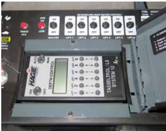
Panel de control Tasselrol/LS System 12 (ubicado en la consola lateral, levantar la tapa para acceder al panel) -Vista típica
