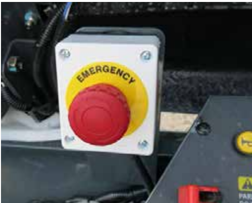
Interruptor de parada de emergencia (ubicado cerca de la consola lateral) - Vista típica
