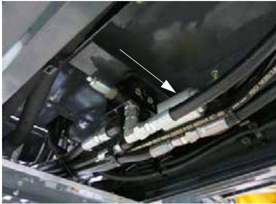
Filtro en línea de alta presión (ubicado debajo de la máquina, deslice la pantalla protectora hacia fuera para acceder al filtro) -Vista típica
