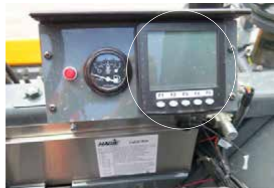
Monitor del motor CANtrak (ubicado cerca de la parte delantera del puesto del conductor) -Vista típica
