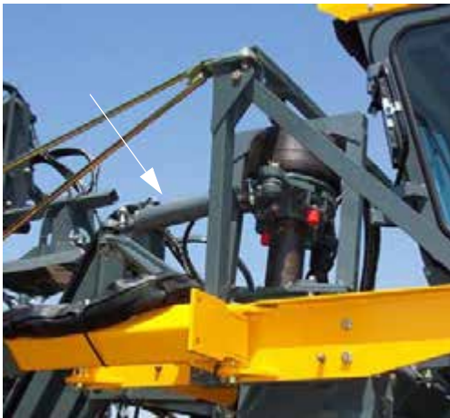
Cilindros de dirección (ubicados en ambos brazos de dirección delanteros y las ensambladuras soldadas de las patas exteriores) -Vista típica
