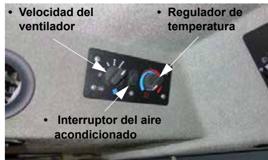
Climatizadores (ubicados en el techo interior de la cabina) -Vista típica
