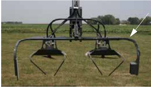
Sistema LS/control de profundidad -Vista típica
