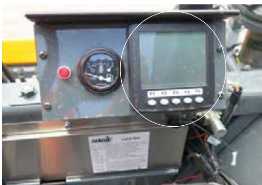
Monitor del motor CANtrak (ubicado cerca de la parte delantera del puesto del operador) -Vista típica
