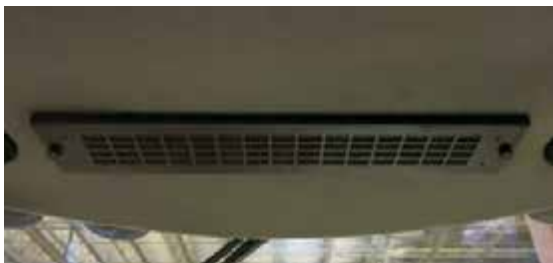
Acceso a los filtros de aire fresco de la cabina (ubicados en el techo interior de la cabina) -Vista típica
