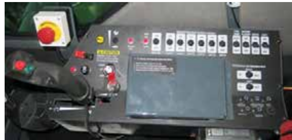
Acceso a los interruptores automáticos (ubicados debajo de la consola lateral - Quite los tornillos del panel de la consola lateral y la palanca de control de la transmisión hidrostática para tener acceso) -Vista típica
