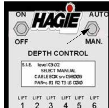
Interruptor manual/automático (ubicado en el panel de control Tasseltrol)
