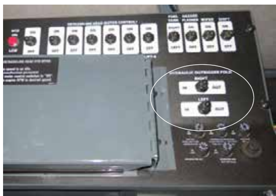
Interruptores para replegar los estabilizadores hidráulicos (ubicados en la consola lateral) -Vista típica
