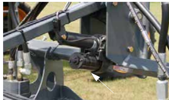
Actuador del control de profundidad (ubicado en el tubo del cabezal de elevación de la barra de herramientas) -Vista típica
