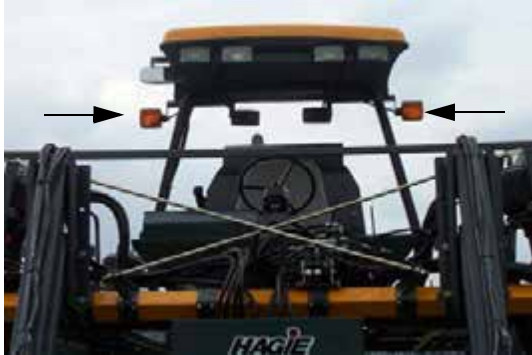
Luces de manejo/carretera (Ubicadas en la parte delantera y trasera del puesto del operador) -Vista típica
