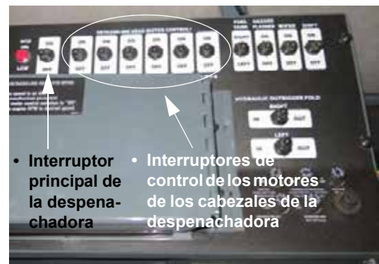
Interruptor principal de la despenachadora e interruptores de control de los motores de los cabezales de la despenachadora (ubicados en la consola lateral) -Vista típica
