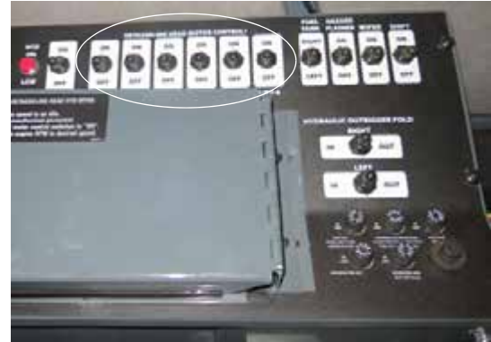
Interruptores de control de los motores de los cabezales de despenchado (ubicados en la consola lateral) -Vista típica
