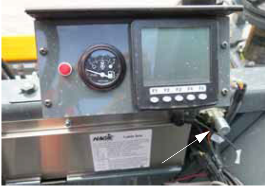
Comutator supapă de tracțiune - față (lângă partea frontală a stației operatorului) - Vedere tipică
