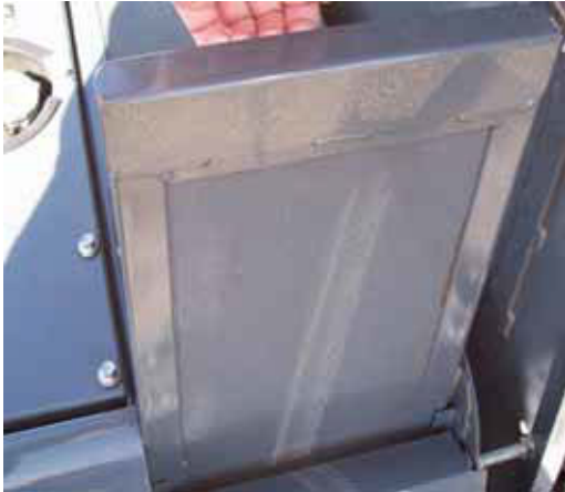
Sită grilaj lateral (glisați afară din carcasa radiatorului pentru a îndepărta) - Vedere tipică
