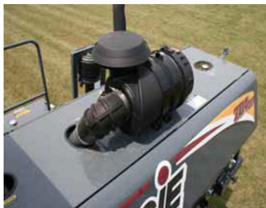
Filtrul pentru aerul de admisie al motorului (lângă partea din spate a utilajului - scoateți capacul filtrului de aer pentru acces) - Vedere tipică
