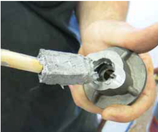
Aplicarea lubrifianțului antigripant - Vedere tipică
