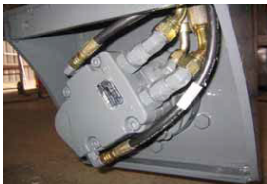
Motoare de roți spate față și stânga spate - Vedere tipică
