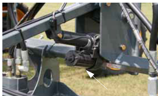
Actuator comandă de adâncime (pe tubul capului de ridicare a barei pentru unelte) - Vedere tipică
