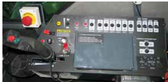
Accesul la siguranța circuitului (sub consola laterală - scoateți maneta de comandă a transmisiei hidrostactice și șuruburile panoului superior pentru acces) - Vedere tipică
