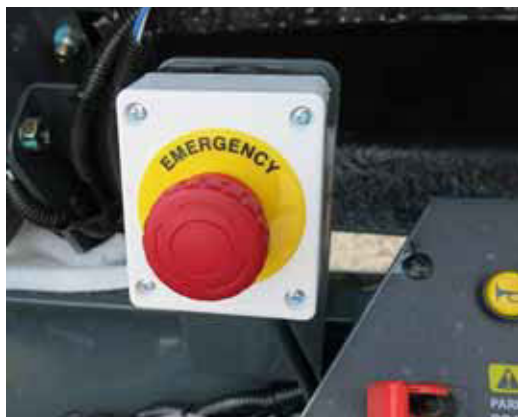
Comutator E-Stop (lângă consola laterală) - Vedere tipică
