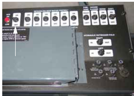
Comutator principal mașină de castrat porumb (pe consola laterală) - Vedere tipică
