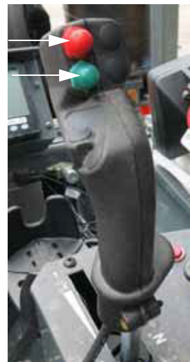
Comutatoare Toate sus/jos (pe maneta de comandă a transmisiei hidrostactice) - Vedere tipică
