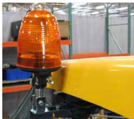
Girofar (pe partea stângă a stației operatorului) - Vedere tipică
