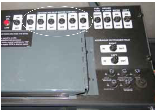
Comutatoare de control motor cap de castrare a porumbului (pe consola laterală) - Vedere tipică
