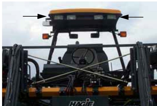
Lumini de lucru (pe partea din față și din spate a stației operatorului) - Vedere tipică
