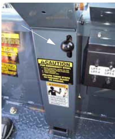
Maneta de blocare a înclinării coloanei de direcție (amplasat în apropierea centrului coloanei de direcție) - Vedere tipică
