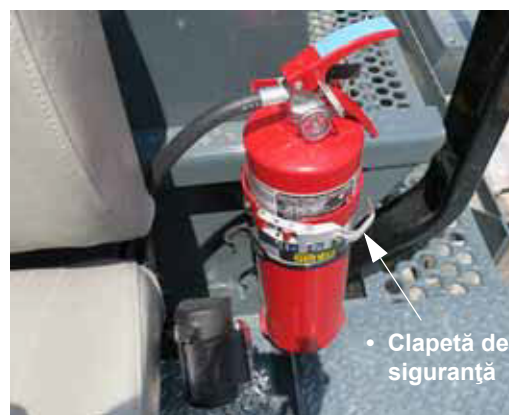
Extingtor (de-a lungul scaunului operatorului) - Vedere tipică
