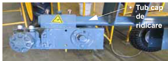
Dispozitiv de tragere cu patru role - Vedere tipică
