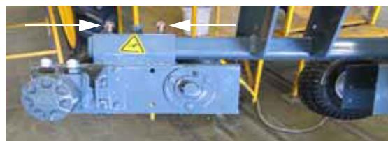
Șuruburi dispozitiv de tragere cu patru role (pe fiecare tub de montare a dispozitivului de tragere cu patru role) - Vedere tipică
