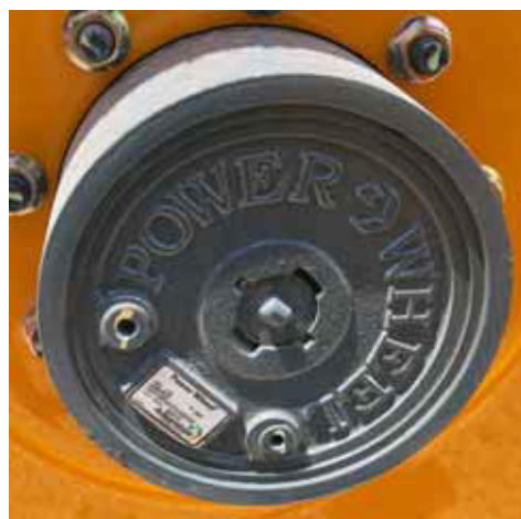
Butuci de roată planetari (cu frâne) - Vedere tipică
