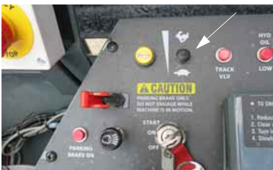
Comutator Accelație (pe consola laterală) - Vedere tipică
