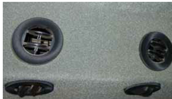
Orificii de ventilare - Vedere tipică
