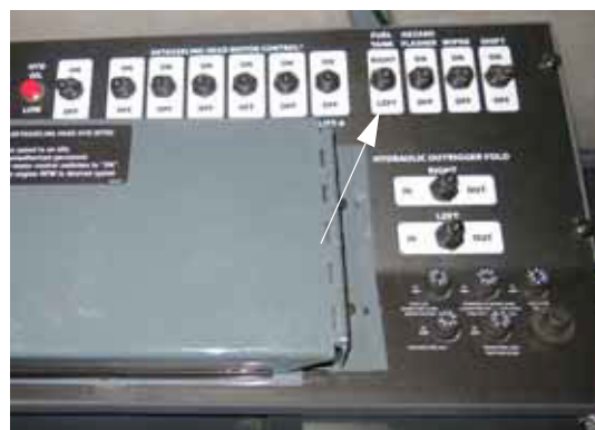
Comutator selector rezervor de combustibil (pe consola laterală) - Vedere tipică
