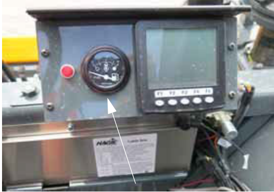
Indicador combustibil (lângă partea frontală a stației operatorului) - Vedere tipică
