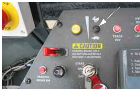
Comutator Accelerație (pe consola laterală) - Vedere tipică
