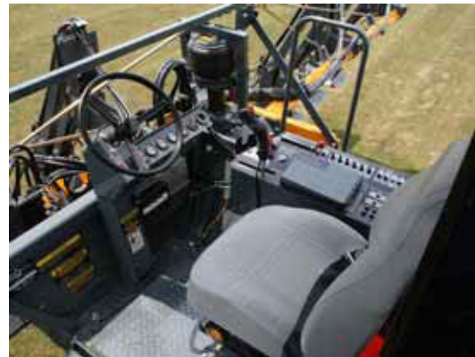
Comutator de detectare a prezenței operatorului (în interiorul scaunului operatorului) - Vedere tipică
