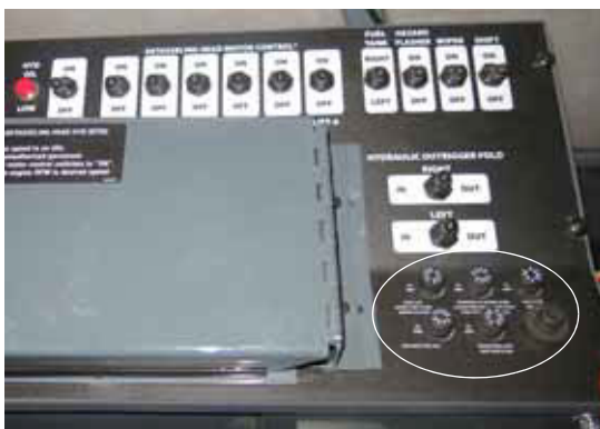
Siguranțe (pe consola laterală) - Vedere tipică
