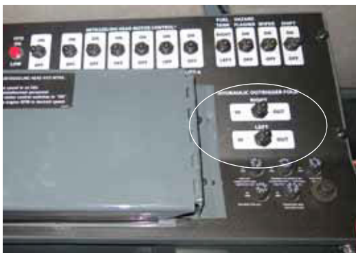
Comutatoare de pliere consolă hidraulică (pe consola laterală) - Vedere tipică
