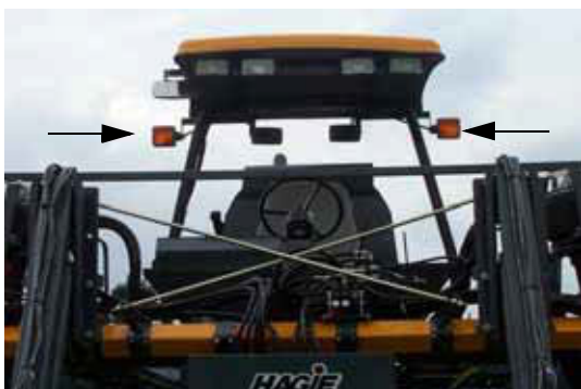
Lumini de poziție pentru drumuri publice (pe partea din față și din spate a stației operatorului) - Vedere tipică
