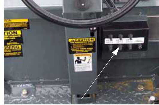
Comutatoare comandă de adâncime (lângă partea frontală a stației operatorului) - Vedere tipică
