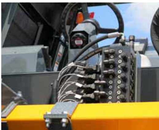
Supape electrohidraulice (pe partea din față a barei pentru unelte) - Vedere tipică
