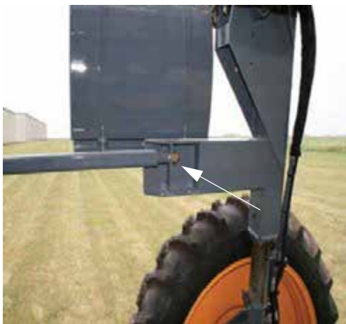
Piulițe de blocare spate (pe colierul piciorului) - Vedere tipică
