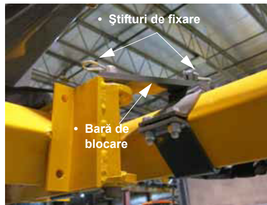
Ansamblu știft de fixare/bară de blocare (între consolă și bara pentru uneltele centrală) - Vedere tipică
