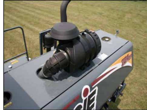
Motor légszűrő (Vegye le a légszűrő zárósapkát a hozzáféréshez)
