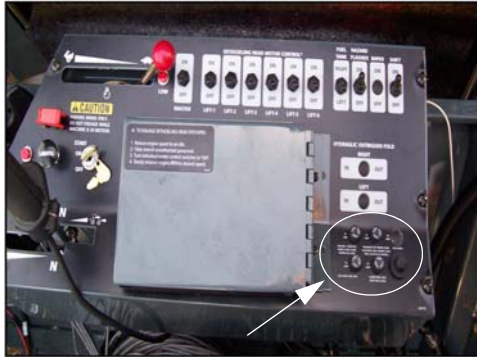
Biztosítékok (Az oldalkonzolon található) -Jellemző nézet
