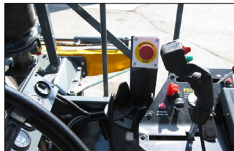
Vész-állj kapcsoló (Az oldalkonzol mellett található) -Jellemző nézet
