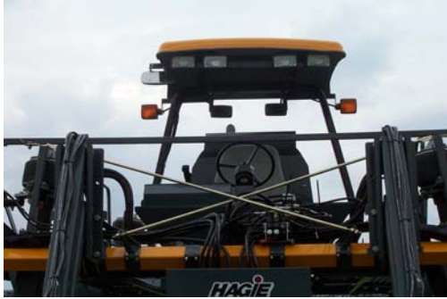
Munkalámpák (A védőtető vagy fülke első és hátsó részén található) -Jellemző nézet
