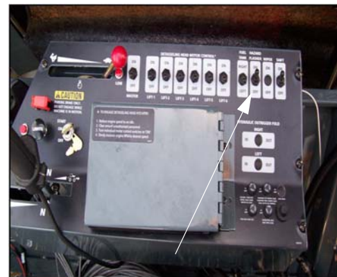
Villogó vészjelző kapcsoló (Az oldalkonzolon található) -Jellemző nézet
