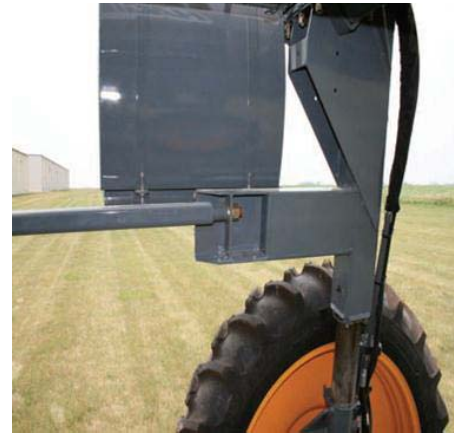
Hátsó rögzítőanya (A lábtartón található) -Jellemző nézet
