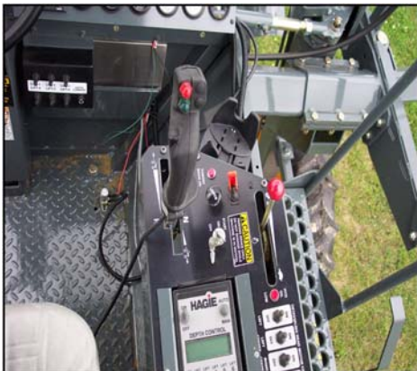
Munkalámpa kapcsoló (Az oldalkonzolon található) -Jellemző nézet
