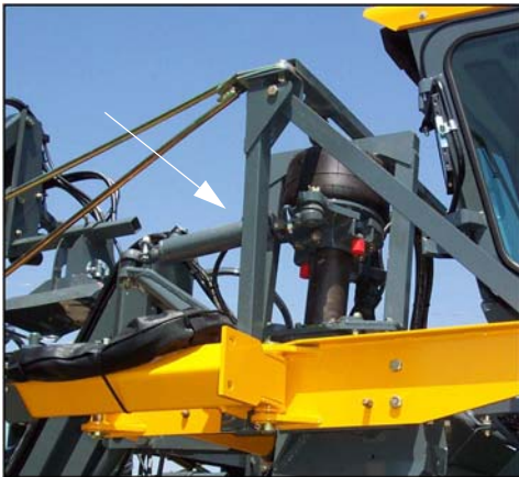
Kormány munkahengerek (Mindkét kormányösszekötő rúdra és külső lábszerkezetre rögzítve) -Jellemző nézet
