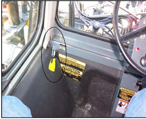
أداة أنقذني (مثبتة على دعامة مانع الانقلاب) - موضحة التركيب القياسي
