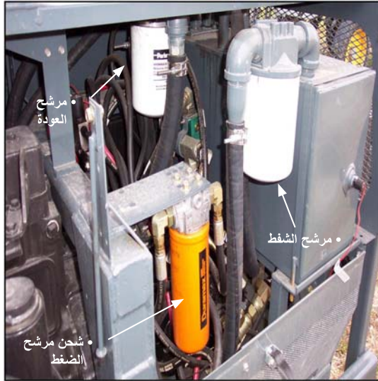
فلاتر الشفط والضغط المشحون والعودة (تقع يسار الجانب الخلفى للماكينة) - توضيح تثبيت نموذجي
