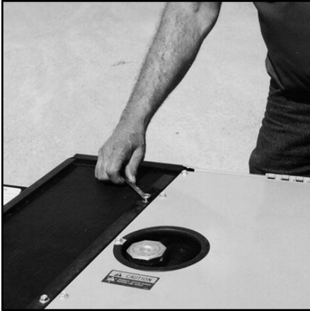
شاشة الشبكة العليا (قم بإزالة مسماري لوحة المشعاع/اللوحة للوصول) - عرض نموذجي.
