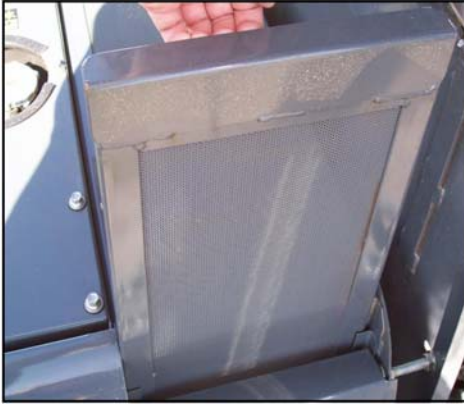
شاشة الشبكة الجانبية (أزّلها للخارج عن موضعها لنزعها) - عرض نموذجي.
