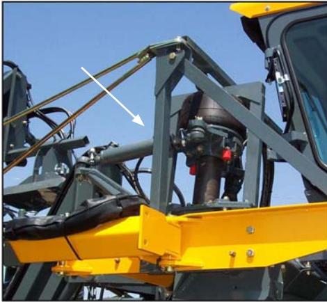
اسطوانات القيادة (المرفوعة على كلا ذراعي القيادة الأمامي ولحامات العصا الخارجية) - عرض نموذجي.
